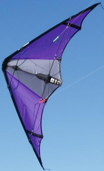
Beim Design geht Tiedtke kein Risiko ein und bleibt bei den beiden bekannten, bewährten per geschlossener Kappnaht zusammengefügt Paneelen pro Segelhälfte. Nur so viele Nähte wie absolut nötig und sinnvoll. Wir sprechen hier von einem Speedkite. Unser Testmodell kam im Powertuch Chikara und bietet mit Dunkelgrau innen und Violett außen einen klasse Blickfang am Himmel.
