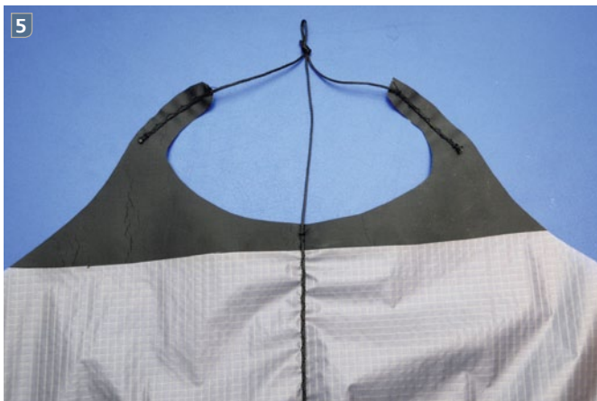
Die Waagekonstruktion am Kopf
