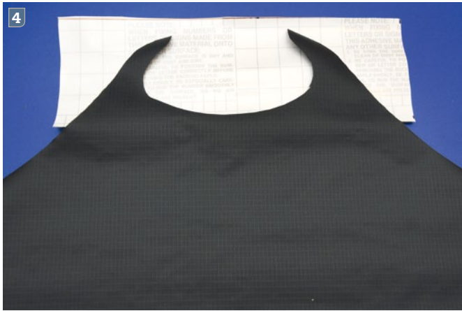
Klebespinnaker dient als Verstärkung im Kopfbereich
