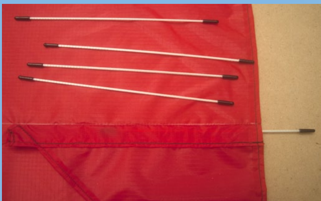
GFK-Stäbe versteifen die Auftriebsfläche
