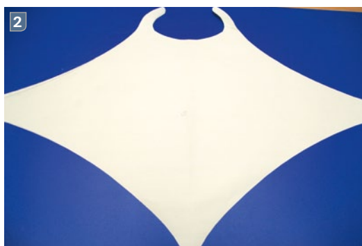
Übertragen der Formgebung auf die Papierschablone (1). Symmetrisch muss die aufgeklappte Vorlage für den Zuschnitt sein (2). Viele solcher Segel benötigt die Tetraederbauweise: 4, 10, 20 oder 35 Zellen ergeben eine gleichseitige Dimension (3)
