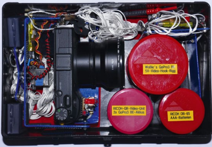
KAP-Schatzkiste: Erste-Hilfe-Kasten mit KAP-Ausrüstung für die horizontale und vertikale Ausrichtung, ohne optionalen 40-MHz-Sender
