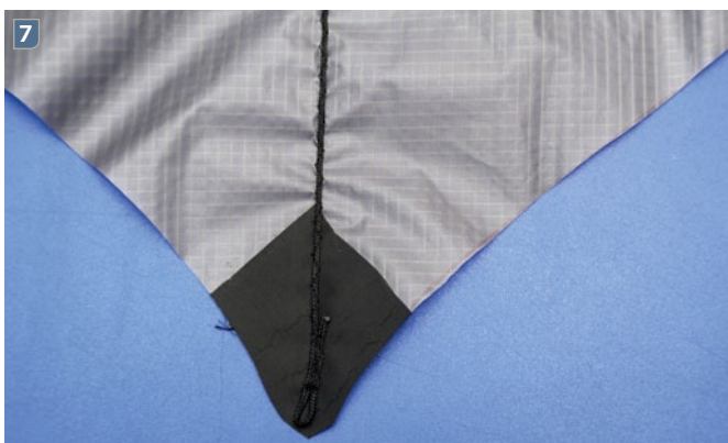
Verstärkungsschnur mit abschließender Schlaufe am Segelende
