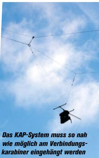
**Das KAP-System muss so nah wie möglich am Verbindungskarabiner eingehängt werden**
