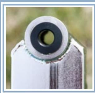
**Lenkkopfbuchse an der robust ausgelegten Deichsel**
