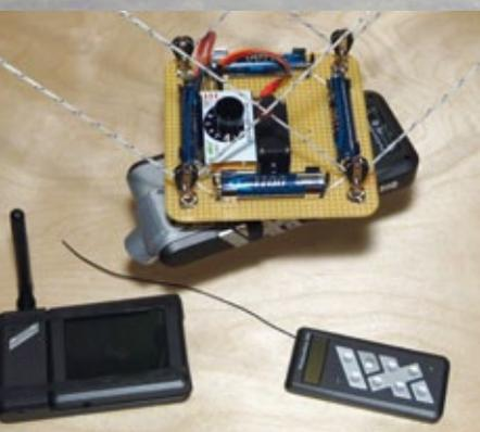
**FlyCam am Auto-KAP-Rigg mit 5,8-GHz-Videoemitter-Set und 433-MHz-LinX-Steuersender**
