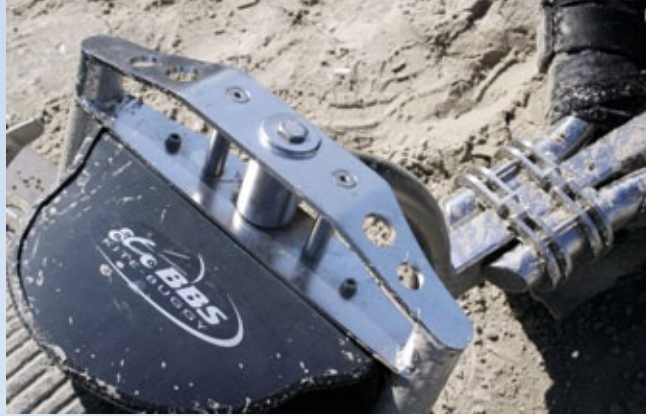
Solide Vorderradgabel mit kugelgelagertem 12-Millimeter-Bolzen
