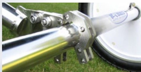
Klemmung der Seitenholme mit der Deichsel
