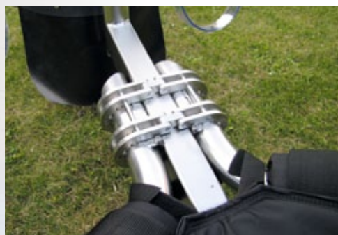
Klemmung der Seitenholme mit der Deichsel
