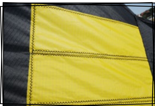
Applikationen mit einfachem Zickzackstich
