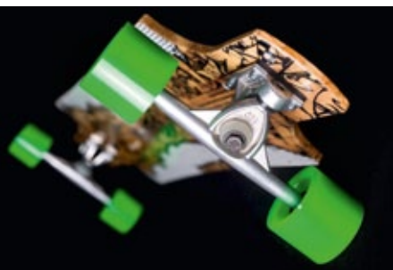
Top-Mount-Montage der Achsen am Flyersurfer-Longboard
