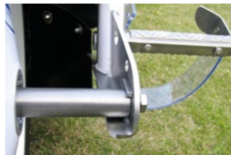
Schlaues Novum: Montagehilfe für das Vorderrad
