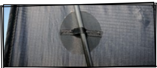
So werden die Spreizstäbe auf dem Segel geführt
