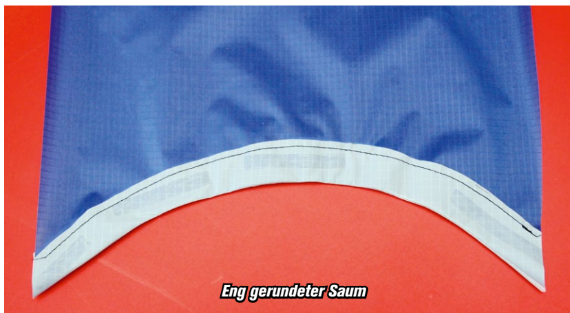
Mittels Saumhilfe wird der Rundbogen gefertigt, von dem zwei Exemplare ausgeschnitten werden
