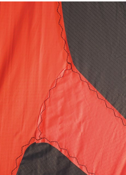
Sauber vernähte Paneele in Segelmachertechnik
