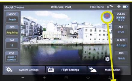
**Touchscreen am Sender zur Bildüberwachung. Über das rote „Auge“-Symbol rechts oben geht es zu den Follow-Me- und Tracking-Funktionen**
