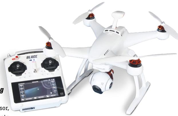
**Mit einem Schieberegler lässt sich die Kameraneigung stufenlos steuern. Der rote Knopf dient zum Ein- und Ausschalten der Motoren, darüber ist der Auslöse-Taster für die Fotofunktion**
