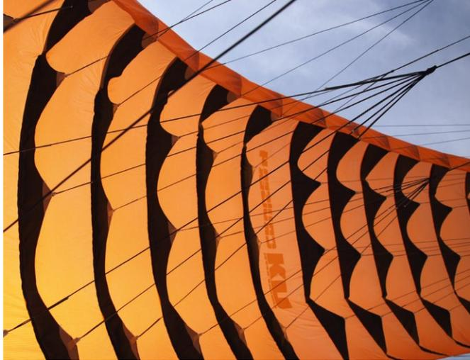
**An kurzen Kielen ist die Waage aufgehängt**
