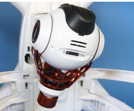
**Zauberwerk: Kamera mit Gimbal und Slot für bis zu 32-Gigabyte-Micro-SD-Karten**
