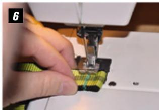
**6** Nun näht man zunächst eine Durchführung für den Anschlagtampen in das lang umgeschlagene Gurtbandstück. Auch hier nähe ich – wie gehabt – mit einem Zickzackstich mehrmals hin und zurück, sodass man später das farbige Nähgarn gut sehen und erkennen kann
