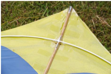
**Die Rückseite mit Längsstab aus Bambus und Querspreize aus flexibler Glasfaser**
