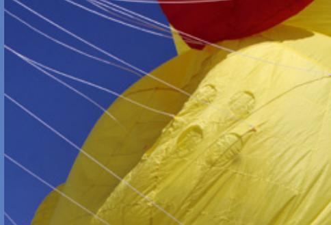
*Die acht Löcher im ventilerten Einlass der 300er-Ente lassen diese gut und optisch unauffällig befüllen*
