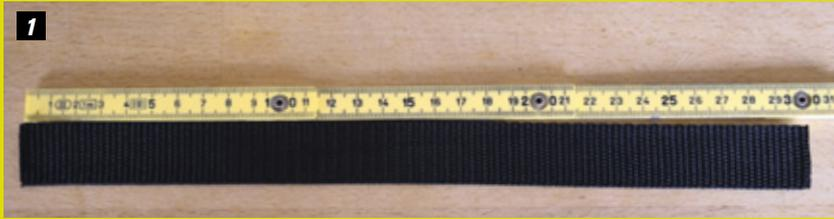
Man schneidet ein Stück Gurtband auf eine Länge von 30 Zentimeter zu. Dabei sollte man nach Möglichkeit heißschneiden, damit die Schnittkante nicht ausfasert. Wer hierfür keinen Heißschneider oder Lötkolben zur Hand hat, kann einfach die Klinge eines Cutter-Messers erhitzen
