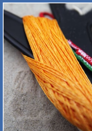
Bei der dünnen 50er-Leine (links) ist die Flechtung deutlich sichtbar, die 70er-Skyline zeigt eine glatte Oberfläche
