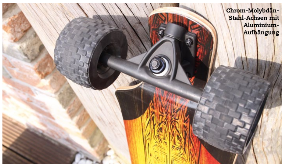
Die profilierten Räder sind rund 1,5 Zentimeter breiter
