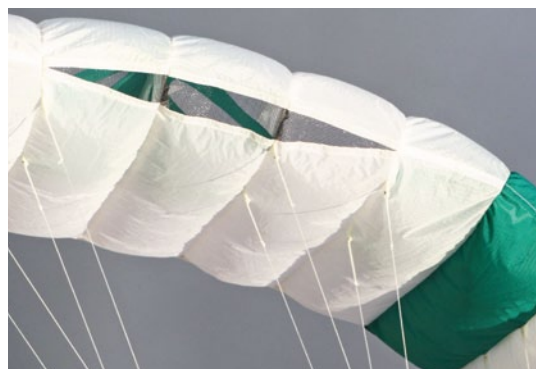
Im Inneren befinden sich Diagonalprofile
