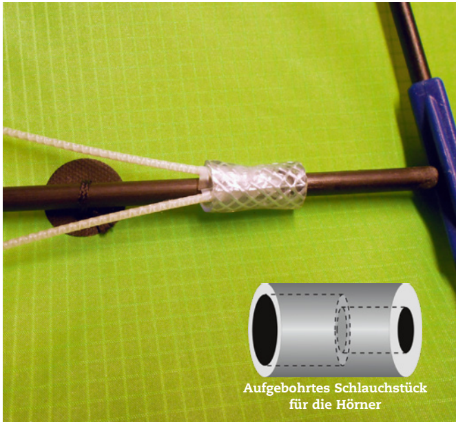
Bild 21: Höreransatz mit Verbinder
