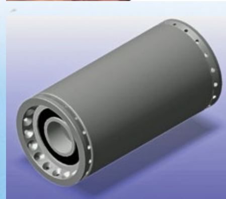
Die Nabe mit asymmetrischer Lageraufnahme
