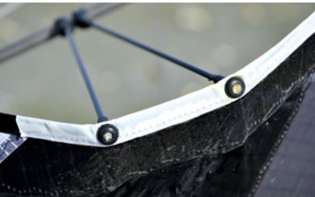
Verschraubte Stand-Offs am glatten Segel
