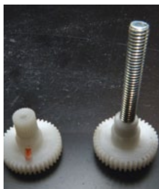
Modifikationen am Getriebegrad für die 360-Grad-Endlosrotation (links: Plastikstopper, rechts: 4 mm-Senkkopfschraube)
