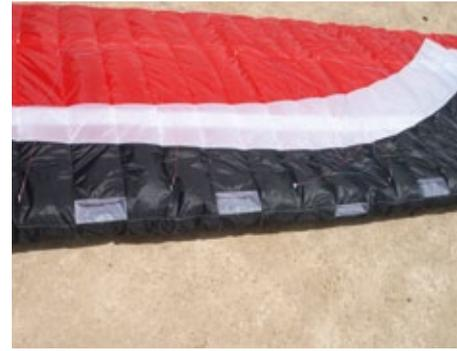
■ **Flügelausformung durch Ventile und dünne Metallfedern**
