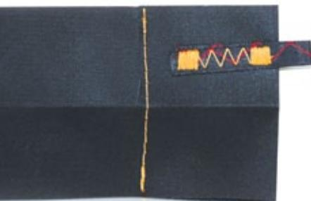
**Für die Leitkantenabspannung Dacronband einschlagen und festnähen, dann eine Lasche aus vierfach gefaltetem Saumband feststeppen**
