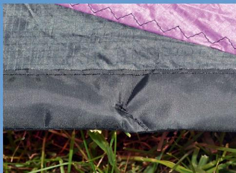
**Die in die Segelspitzen geschobenen Leitkantenstäbe werden mit dieser Naht arretiert**
