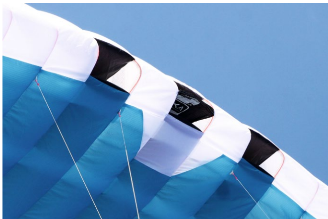
An den Profilen neben den Einlassventilen sind die Verstärkungsstäbe deutlich erkennbar
