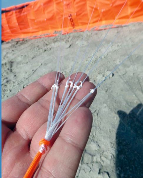
Typisch für die Lycos: feine, ungemantelte Dyneemawaage
