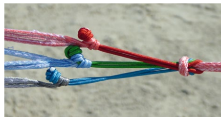
Die Knoten der Verstellwaage
