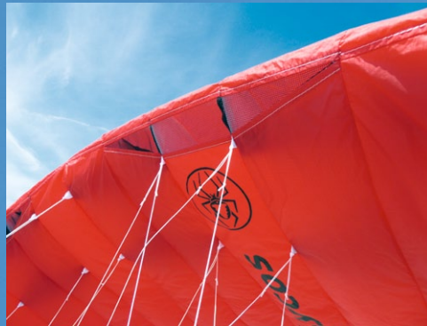
Die Lufteinlässe in der sauber ausgeformten Flügel Nase
