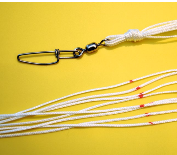
Achtschenklige Waage mit Knoten am Wirbel und Markierung
