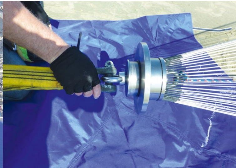
Der Wirbel mit Sicherheitsauslösung ist extrem aufwändig gebaut
