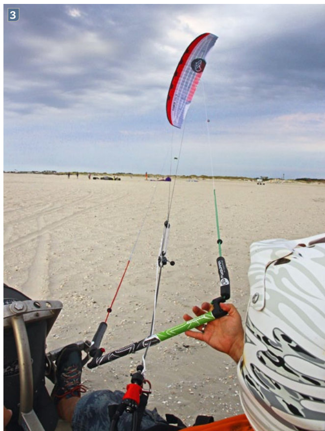
Auf dem Buggy testeten wir die mittigen linestofly-Leinen 201/161 in 15 Metern (1). Die Testschnüre in typischen Farben: Blau und Weiß mit 0,83 Millimeter sowie Grau mit 1,1 Millimeter Durchmesser (2). Im Einsatz an der Bar präsentiert sich ein direktes Ansprechverhalten (3)
