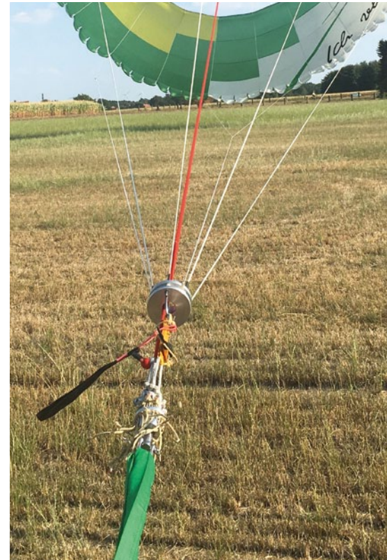
Wirbel und Bolzen-Auslösemechanismus von Jörg
