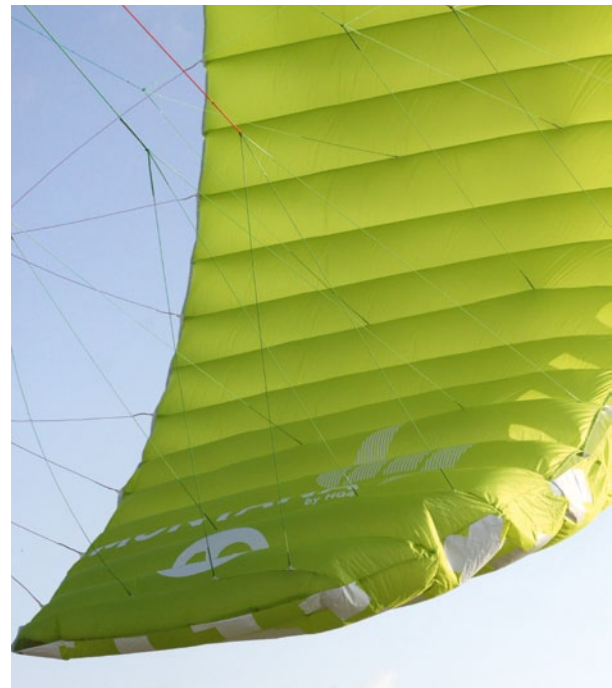
Sauber vernähte Waage aus ummanteltem Material
