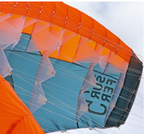
„Profile“ mit Kielen, Diagos und flexiblen Stäbchen
