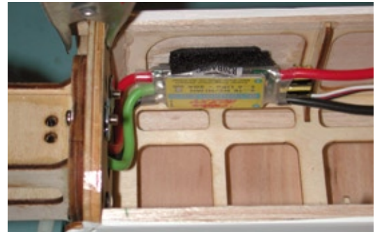
An dieser Stelle ist die Reglermontage vorgesehen
