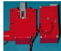
Der Klassiker unter den elektrischen Einziehfahrwerken (Firma Giezendanner) ist etwas in die Jahre gekommen. Es hat noch Endanschlagsschalter. Gegen Überlastung schützt eine eingebaute Rutschkupplung. Die kürzlich aufgelegte Nachfolgeversion wird auch eine elektronische Steuerung haben
