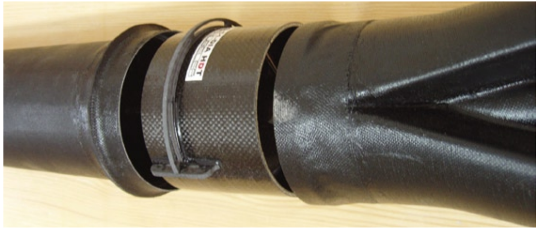
Luftführung mit Hosenrohr (links), eingebautem DS-51-DIA HDT-Impeller (Mitte) und Düse (rechts)
