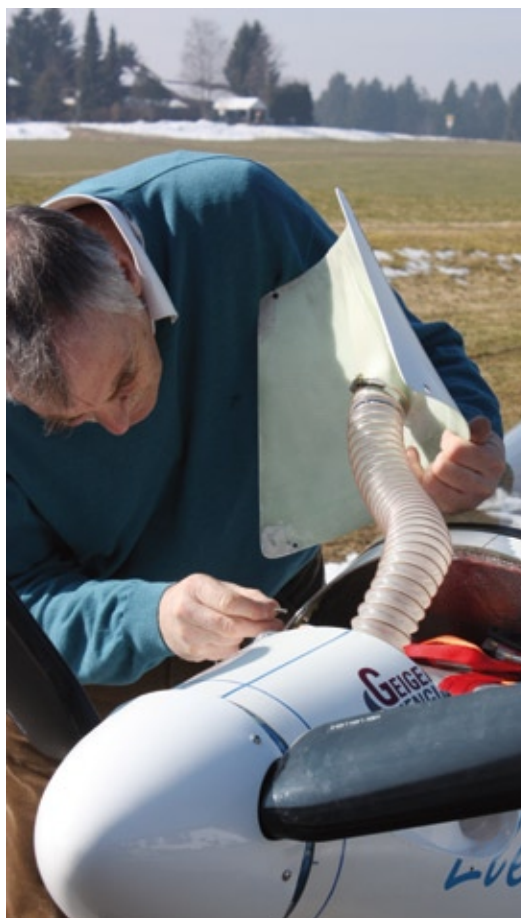
Wer gut kühlt, der gut fliegt! Am Batterieraumdeckel befindet sich der Luftereinlass für den Motorcontroller
