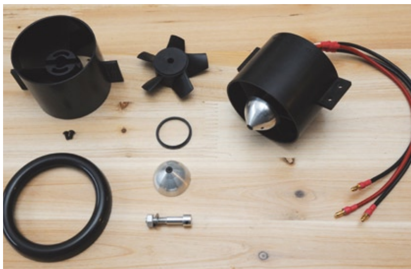
WeMoTec Mini Fan pro – Gehäuse (oben links), Einlaufklappe (unten links), Läufer, Spinner und Mitnehmer (Mitte) sowie der fertig montierte Impeller (rechts)
