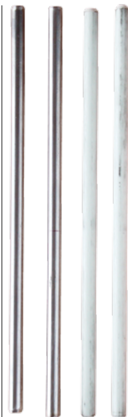
Da lassen sich 130 Gramm sparen. Die zum Anstecken der Außenflügel wirklich überdimensionierten 8-Millimeter-Verbindungsstähe wurden gegen leichtere aus GFK (im aero-naut-Programm) ausgetauscht
