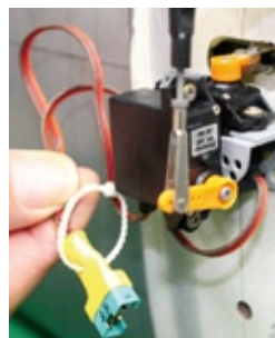
Die Leitwerke im Heck sind verdeckt angesteuert. Relativ kleine Servos genügen
