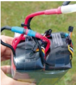
Die beiden zu einem 12s-Pack geschalteten 6s ThunderPower Pro Lite V2 mit einer Kapazität von 5.500 Milliamperestunden
