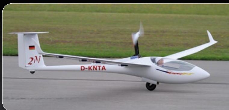
Eine ASW 27 B mit Elicker-Triebwerk beim Start. Elicker verwendete eine starre Luftschraube, dadurch wirkt das Triebwerk sehr vorbildgetreu
