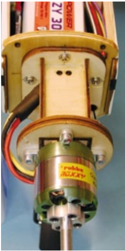
Motorträger mit montiertem Außenläufer Roxxy 4250-07 von robbe. Der Akku muss hier aus Schwerpunktgründen ganz nach vorne
