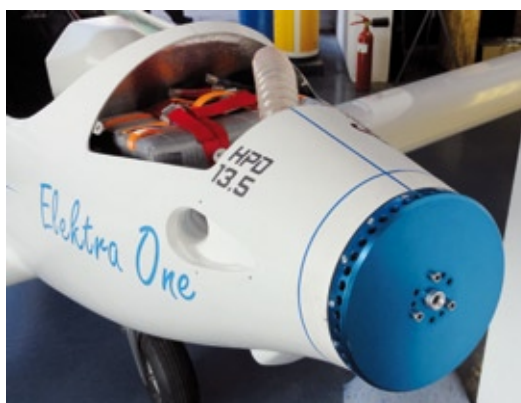
Der rückseitenmontierte Außenläufer von Geiger Engineering leistet kurzzeitig 16 Kilowatt
