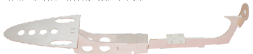
Fertiges Rumpferippe – links (vorne) werden später die Akkus platziert, rechts (hinten) ist der Motorträger erkennbar
