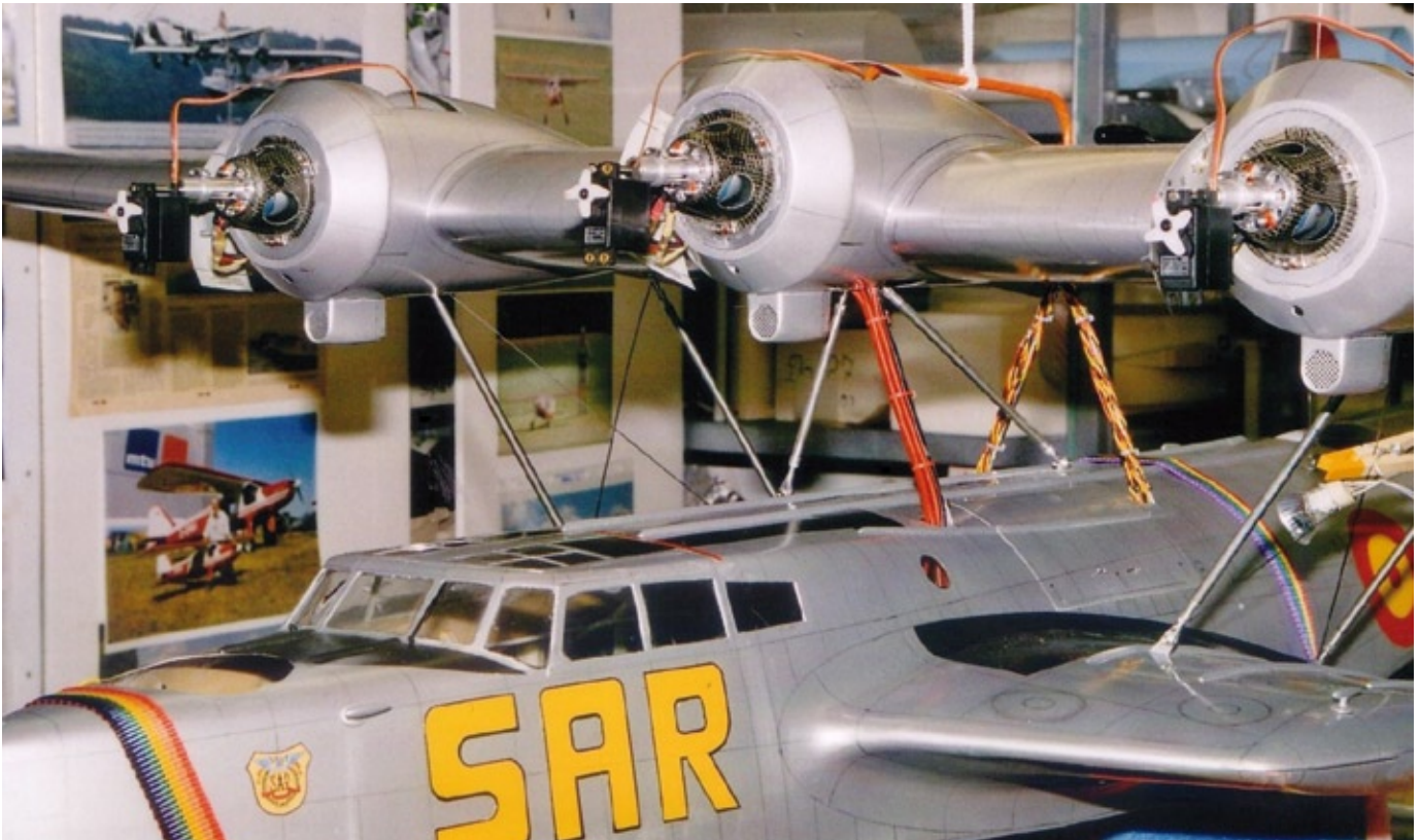
Die Motorensteller werden nicht direkt programmiert. Servos zeigen die Stellung des Gassticks während der Programmierung an. Sie werden natürlich später entfernt
