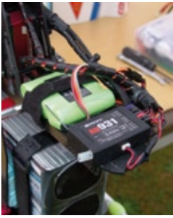
Ganz vorn im RC-Vorbau sitzt der Hauptempfänger, dahinter ein vierzelliger Pufferakku für die Bordstromversorgung, der permanent über den Regulator aufgeladen wird
