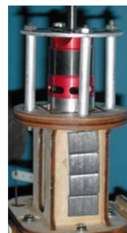
Das Getriebeaggregat KIRA 480-34 von Kontronik bekam frontseitig eine Montagescheibe aus 2-Millimeter-Alu, und stützt sich auf 4-Millimeter-Abstandshalter ab
