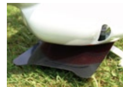
In Verlängerung zum hinteren Kufenbügel befindet sich eine CFK-Platte, die im Hochgeschwindigkeitsflug als Spoiler wirkt und die Geradeauslaufefigenschaften verbessern soll
