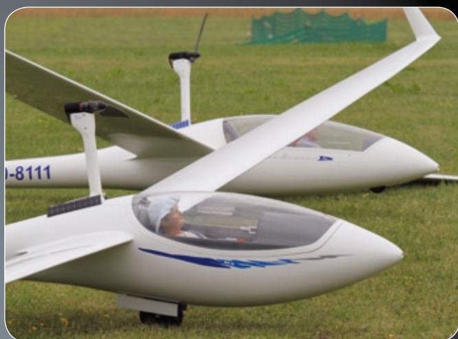
Die AFT-Triebwerke von Schambeck eignen sich vor allem für Modelle ab Maßstab 1:3 oder größer. Für die Triebwerke charakteristisch ist der Einblattpropeller
