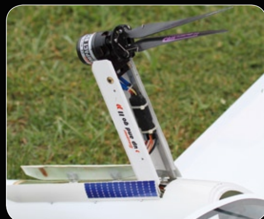
Das Graupner-Triebwerk „up and go II“ wird mittels Spindelantrieb ein- und ausgefahren. Spindelantrieb und Antriebsmotor gehören zum Lieferumfang
