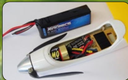
Im Micro Excel sorgt der Innenläufer Magic-Ammo für einen ökonomischen Stromverbrauch und lange Motorlaufzeiten
