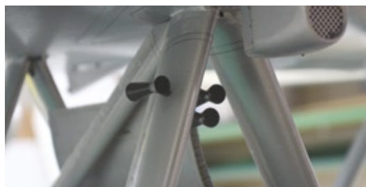
Die drei Venturidüsen erzeugten beim Original den Unterdruck für die entsprechenden Anzeigeinstrumente
