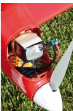
Die Antriebskomponenten sind über die abgenommenen Unterteile der Comet-Motorgondeln zugänglich
