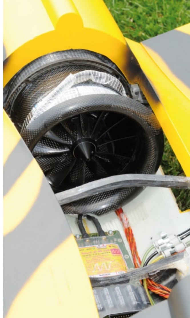
In dieser Hawker Hunter von HT Modellbau wurde statt der vorgesehenen Turbine ein Schübeler-Impeller eingebaut
