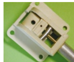
Der Mitnehmerzapfen aus 4-Millimeter-Alu im Fly Fly Electric Retract System kann sich verbiegen
