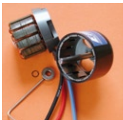
Der simple Aufbau von Brushlessmotoren macht sie zugleich robust
