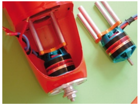
Brushlessmotoren sind problemlos auf Linkslauf umstellbar
