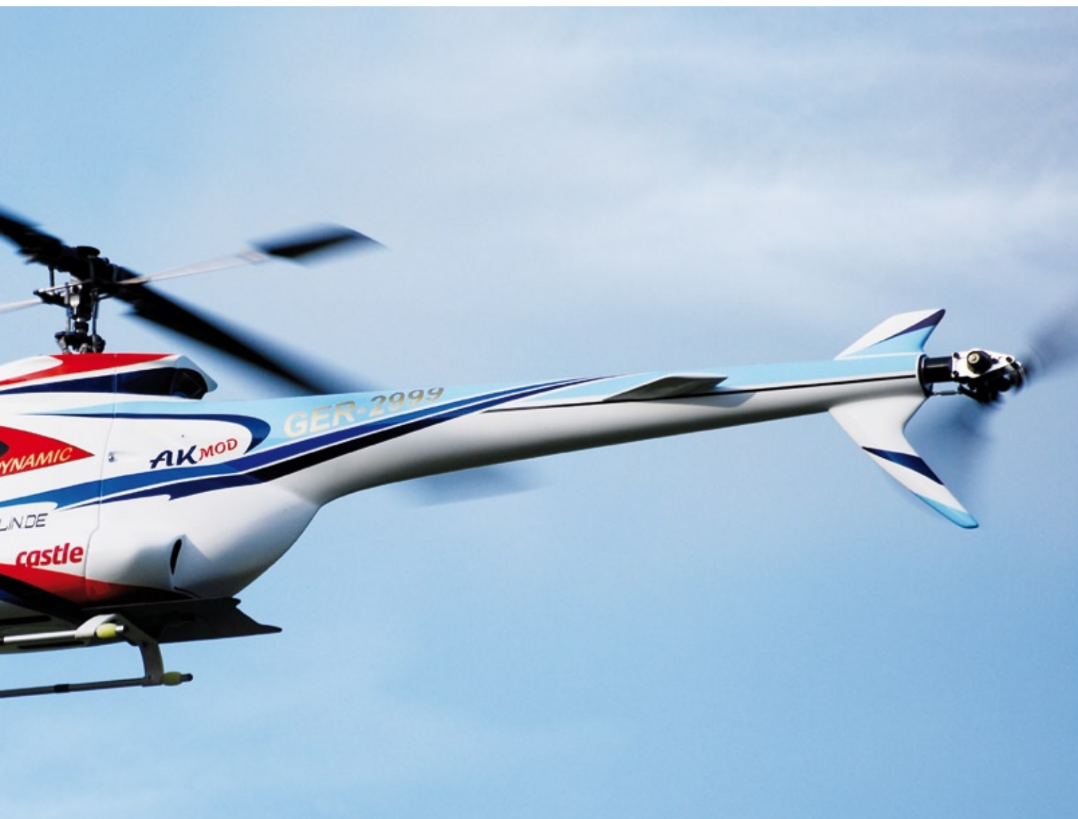
In Verlängerung zum hinteren Kufenbügel befindet sich eine CFK-Platte, die im Hochgeschwindigkeitsflug als Spoiler wirkt und die Geradeauslaufefigenschaften verbessern soll
