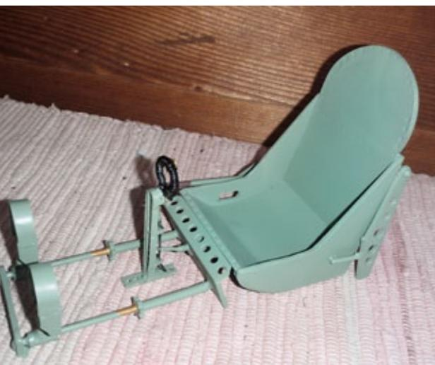
***Der Pilotensitz mit den Fußpedalen und dem Stick ist fertig zum Einbau***
