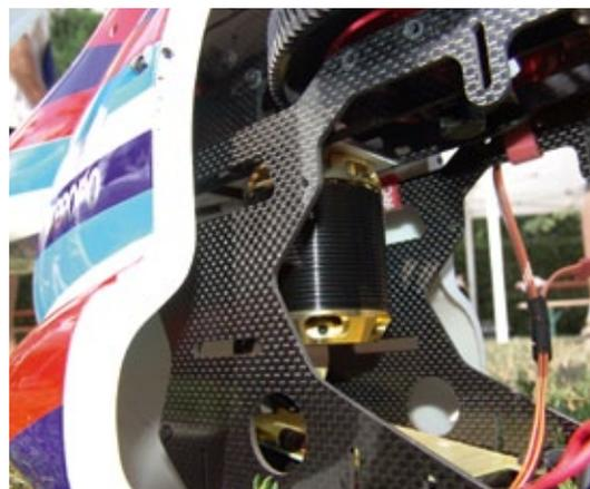
Der Außenläufer Scorpion HK4035-560 im hinteren Bereich der Mechanik
