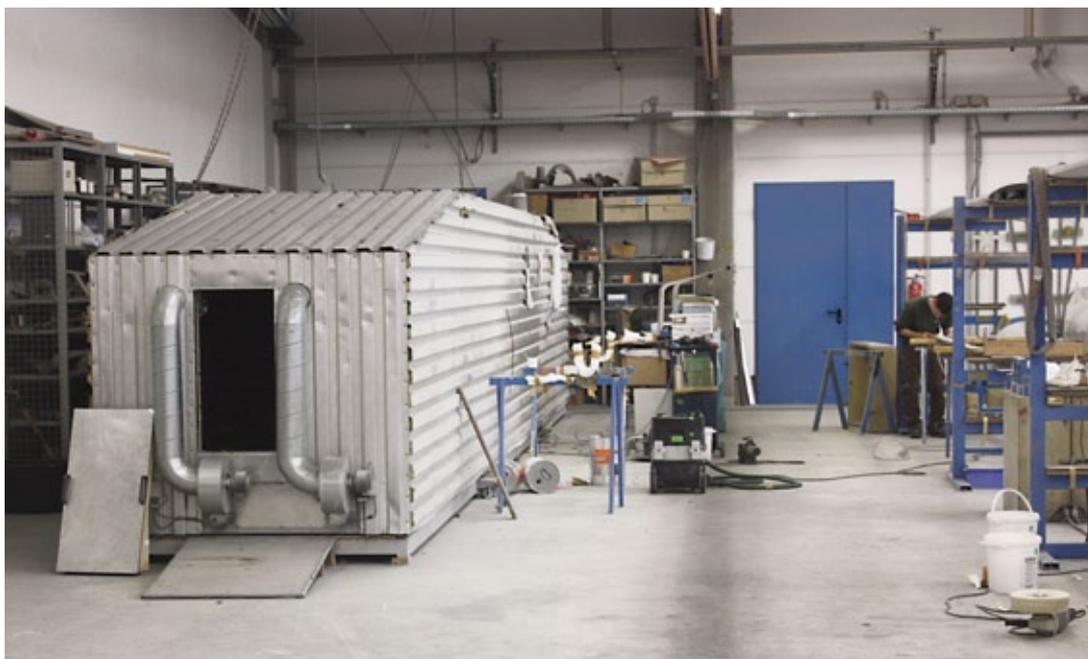
*In der Wärmekammer werden die Faserverbundwerkstoffe ausgehärtet*
