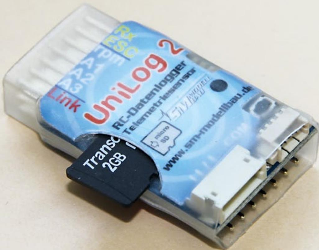
**D**er UniLog 2 ist intern mit einem Druck- und einem Temperatursensor ausgestattet. Die interne Temperatur und die Flughöhe werden daher ohne weitere Sensoren aufgezeichnet. Ebenfalls im Grundgerät mit dabei ist ein Einzelzellenanschluss für LiPo-Akkus mit bis zu sechs Zellen. Dessen
