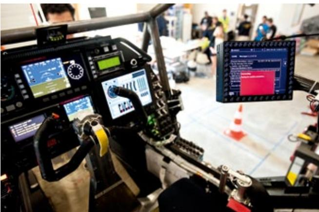
**Die Cockpit-Anzeigen informieren den Piloten über ein Onboard-System über die wichtigsten Parameter und stellt sie parallel der Bodencrew zur Verfügung**
