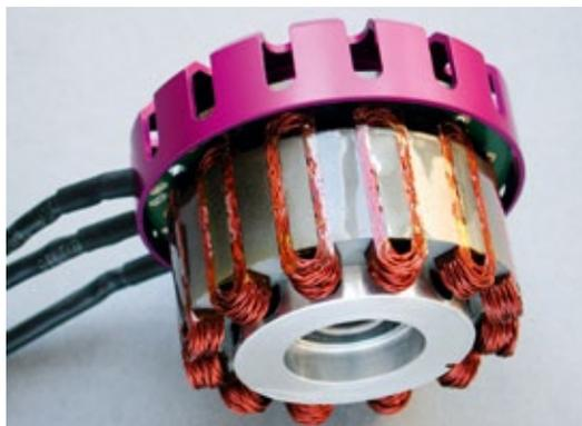
Weil die Wicklungen offen liegen, muss die multifilare Wicklung in sich verdreht sein. Der Stator besteht laut Angabe von Hans Lehner aus einem Spezialschnitt aus 0,2-Millimeter-Blechen
