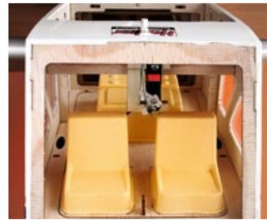
*Der Einbau einer Schleppkupplung ist sehr gut möglich*
