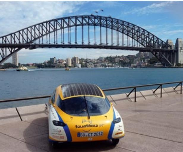
*Der SolarWorld GT ist der Nachfolger des SolarWorld No.1. Das Solarauto ist mit einer 3 Quadratmeter großen Solarfläche ausgerüstet und befindet sich zurzeit auf einer Reise um die Welt*
