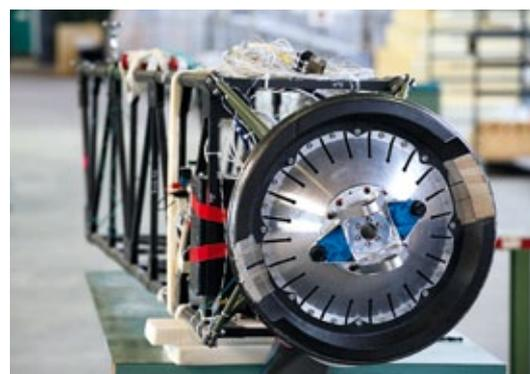
**Angetrieben wird die Solar Impulse von vier Elektromotoren mit einer maximalen Gesamtleistung von 29,5 Kilowatt**
