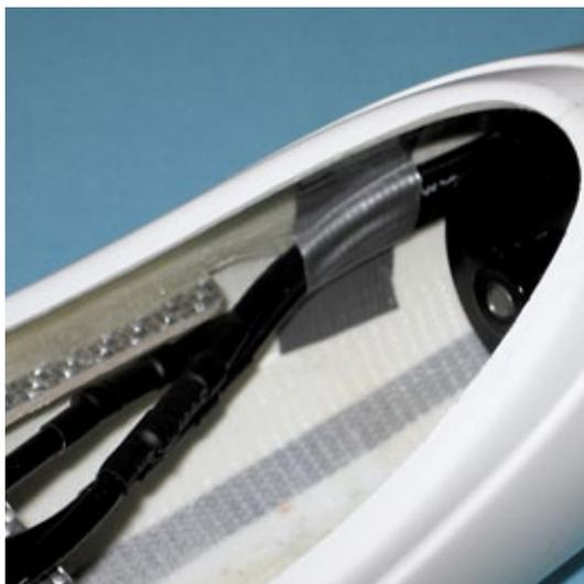
**Bei den Außenläufern ist dringend darauf zu achten, dass die Motorkabel an der Rumpfsseitenwand entlanggeführt werden und nicht am Motorscheuern können**
