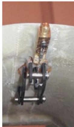
*Der Verschluss der der Akkuschachtklappe wird über die Tanköffnung des Originals betätigt. Einfach, wirkungsvoll und betriebsicher*
