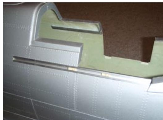
***Die Führungsschienen für die Schiebehaut sind eingesetzt***
