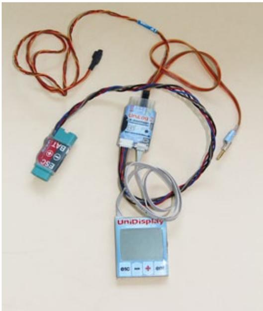
*Oben werden der Temperatur- und der Drehzahl-sensor angeschlossen, unten der Spannungs-Strom-Sensor und das UniDisplay*
