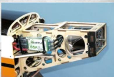
*Brushlessmotor Thrust 50, Regler Quantum 65A und 2 × 3s-LiPos sorgen für den brachialen Vortrieb der Extra MX 58*
