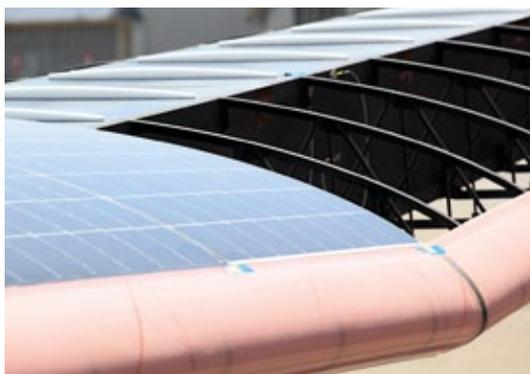
**Fast 12.000 photovoltaische Zellen aus monokristallinem Silizium sind auf der Solar Impulse verbaut. Diese haben eine Stärke von 145 Mikrometer**
