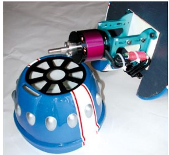
*Die vorgesehe Motorbefestigung durch vier Dis-tanzhülsen wurde durch diese perfekt einstellbare Motorhalterung ersetzt. Das unterlegte, schräg geschliffene Sperrholzbrett sorgt für die gewünschte Sturz- und Seitenzugeinstellung des Motors*
