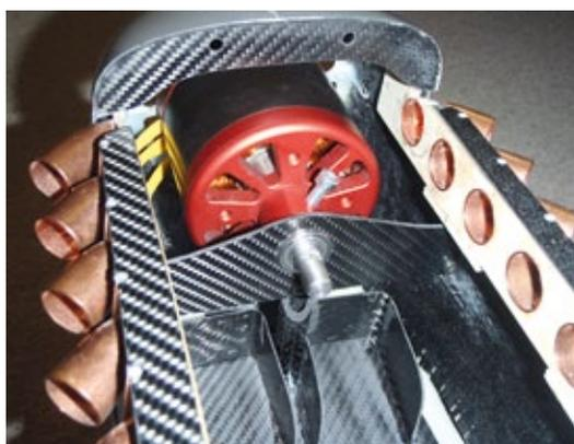
*Die Kupfer-Auspuffattrappen sorgen für eine gute Abführung der Kühlluft. Darunter sind die CFK-GFK-Akkuschalen erkennbar*
