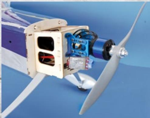
*Die Motormontage an der Edge-540 von Kyosho ist dank des cleveren Tragegestells eine Sache von Minuten*
