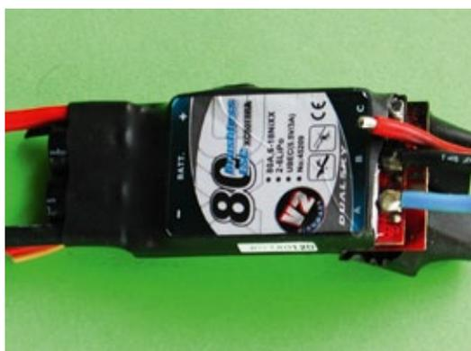
**Leider verkraften nicht alle Regler das, was draufsteht. Wenigstens die Stromkabel sollten einen adäquaten Querschnitt aufweisen. Dieses Kabel hat sich selbst abgelötet**
