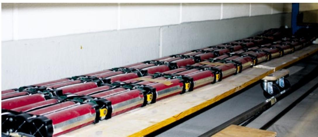
Die Lithium-Ionen-Akkustangen von SAFT, fertig zum Einschub
