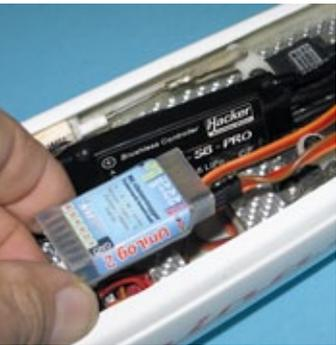
**Die Antriebsmessungen wurden mit dem UniLog2 und einem 80-Ampere-Strom-Spannungssensor durchgeführt**
