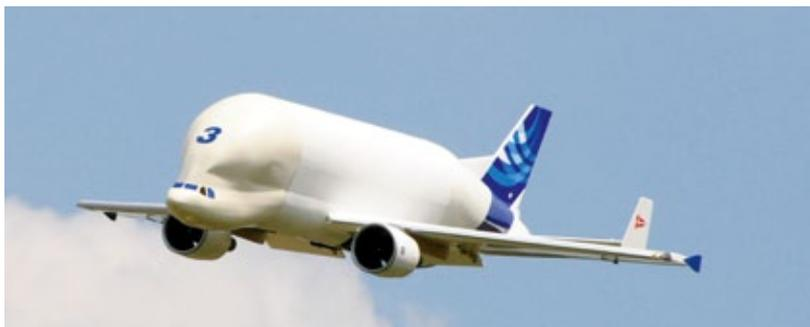
**Abbildung 16:** Bei diesem Beluga sorgten ursprünglich Propeller für Vortrieb, die später gegen Impeller getauscht wurden (Foto: Peter Kaminski)
