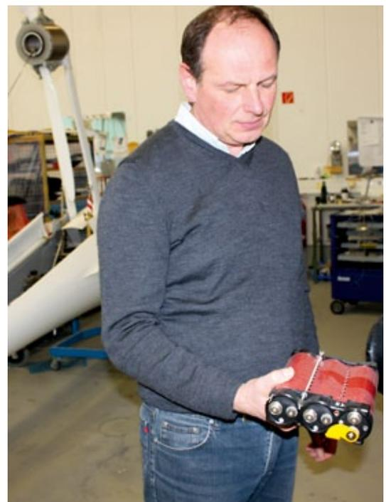
**Axel Lange mit einem Dreier-Element der Batteriestange. Die roten Überzüge sind Heizfolien, um die Zellen auch bei Temperaturen unter 15 Grad Celsius bei Laune zu halten**
