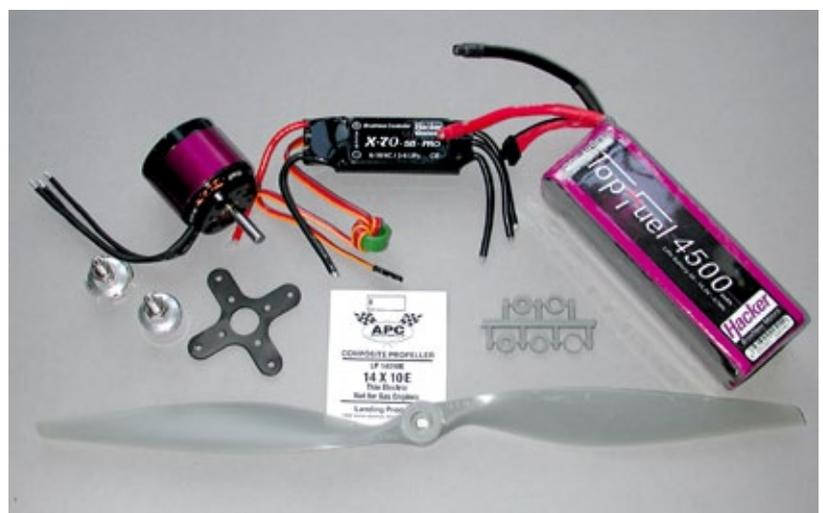
Über zehn Minuten Flugzeit sind mit dem Hacker-Setup aus 4.500er-LiPo, Motor A40-12S V2 und Regler X-70-SB-pro möglich
