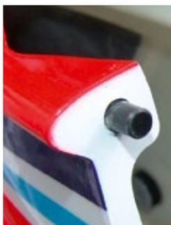
**Vier Passstifte aus Kohlefaser sorgen dafür, dass die Haube in montiertem Zustand perfekt sitzt**
