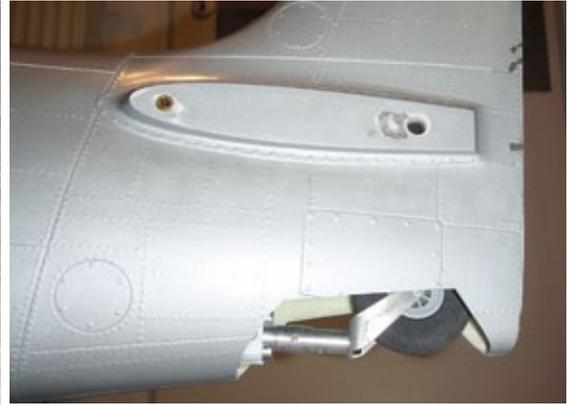
**Das Heckfahrwerk wird mit einem Festo-Zylinder betätigt und fährt vorbildlich ein und aus**
