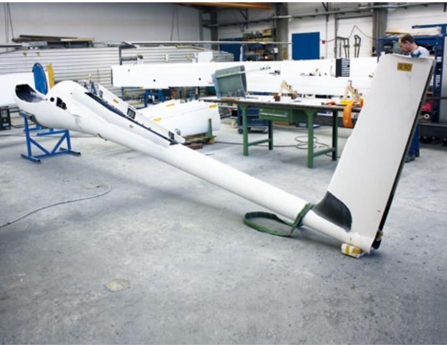
*Der nahezu komplett aus Kohlefaser bestehende Rumpf wiegt laut Konstrukteur Axel Lange inklusive Sicherheitszelle gerade mal 42 Kilogramm*
