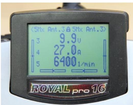
*Alle Antriebsdaten auf einen Blick auf dem Display der Royal pro 16 von Multiplex: Spannung, Strom und Drehzahl*
