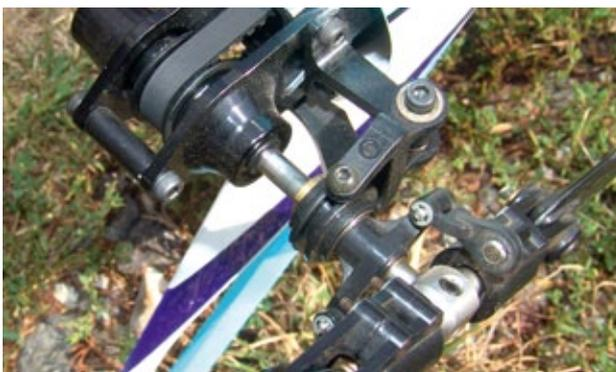
Der Antrieb des Heckrotors erfolgt über einen hochbelastbaren Zahnriemen. Die Pitch-Schiebehülse ist doppelt angelenkt
