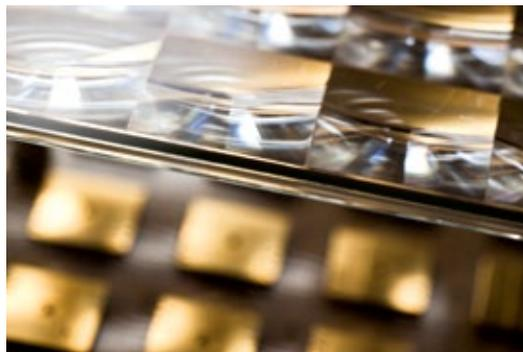
*Konzentratorphotovoltaik: Stufenlinsen bündeln das Licht 500fach auf eine winzige höchsteffektive Mehrschichtsolarelle*
