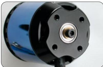
*Ab Werk leider nur für Rückwandmontage geeignet, doch die Inbusschraube lässt sich durch Rechtsdrehen lösen*
