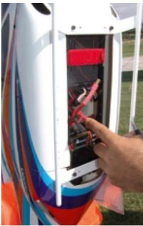
Die Anschlusskabel der Akkus sind auch bei montierter Haube durch die Bodenöffnung zugänglich, zum Beispiel wie hier für eine Spannungsmessung unmittelbar nach einem Zehn-Minuten-Flug (44,82 Volt)
