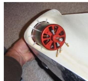
*Der Motor wurde mittels einer Blechhalterung an den Kopfspannt geschraubt*
