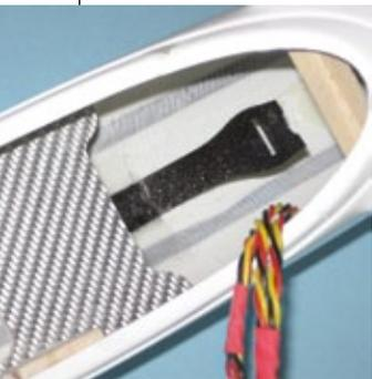
*Der Akku wird unter dem Servobrett hindurch geschoben, stößt vorne an den Rumpfservos an und wird im hinteren Bereich durch ein Klettband in Position gehalten*
