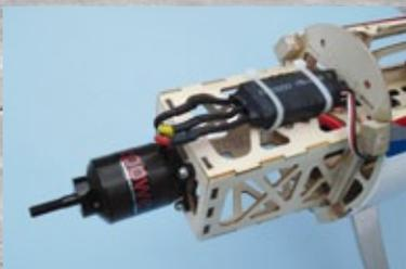
*Der ePower-Elektromotor passt nach einigen Anpassungen nahezu ideal auf den vorgebohrten Motordom des Raver*
