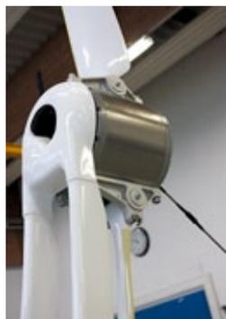
**Am Außenläufermotor sind die Propellerblätter beweglich gelagert. So lassen sie sich leichter im Rumpf verstauen**
