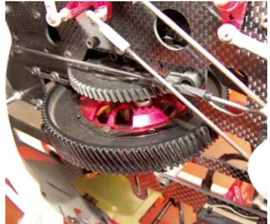
*Das gefräste Hauptzahnrad und das darüber liegende Heckrotor-Abtriebszahnrad sind jeweils schrägverzahnt. Das bringt enorme Laufruhe mit sich und hält höchsten Belastungen stand*
