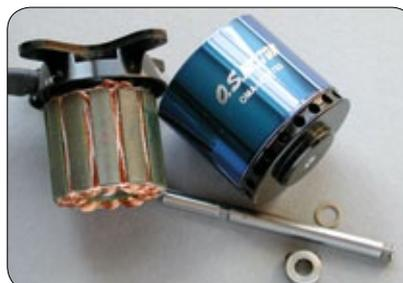
*Bei den kleineren Motoren ist die Welle nur durch einen Ring (rechts unten) gesichert und leicht austauschbar*
