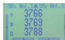
*Einzelzellenspannungen von drei LiPo-Zellen werden in Millivolt angezeigt. Selbstverständlich lassen sich Alarmer programmieren, um bei Unterschreiten eines Werts rechtzeitig zu landen*
