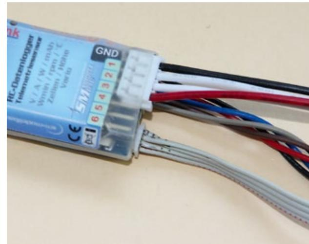
*Über den stirnseitigen Anschluss lassen sich die Balancerkabel im EHR-Format direkt anschließen und so die Einzelzellen des Akkus überwachen*
