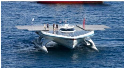
*Das Oderdeck der PlanetSolar besteht aus 537 Quadratmeter Sonnenkollektoren. Mit ihnen fährt das Schniff emissionsfrei und hat keine Reichweitenbeschränkung*
