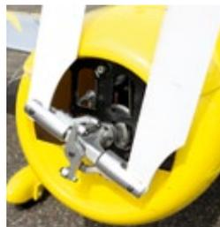
**Abbildung 17:** Eigenbau-Verstellpropeller an einem 11 Kilogramm wiegenden Elektro-Kunstflugmodell
