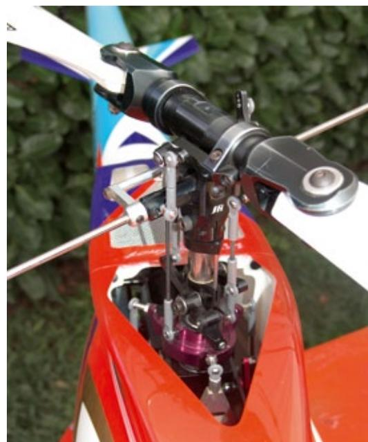
**Der Sylphide-Hauptrotorkopf mit untenliegender Hilfsrotorebene. Ganz vorn an der Taumelscheibe ist der Nickhebel erkennbar, der gleichzeitig zur Taumelscheibenführung dient**
