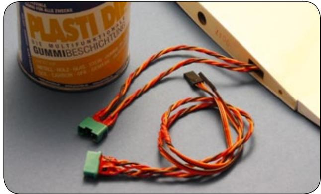
*Mit Flüssiggummi versiegelte Kontakte sind vor Kurzschlüssen sicher*
