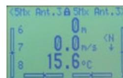
*Die beiden oberen Werte gehören zur Variometerfunktion, darunter die aktuelle Temperatur*
