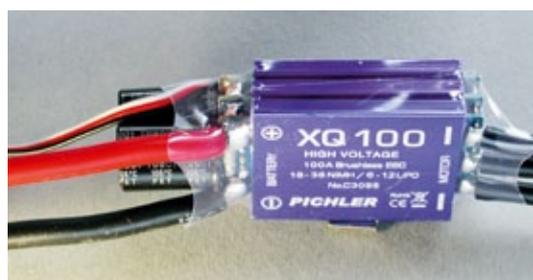
**Dieser Pichler-Regler mit drei-Schicht-Endstufe treibt schon einiges an Kühlaufwand**
