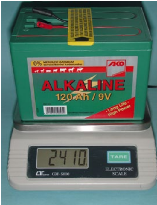
Glaubt man dem Aufdruck auf dieser Weidezaunbatterie, so liegt ihre Energiedichte inklusive Anschlusskabel und Umverpackung bei sensationellen 450 Wattstunden je Kilogramm
