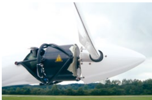
Gut sichtbar die Motoraufhängung. Dahinter der Ausgleichsbehälter für die Kühlflüssigkeit. Der Pitch (Steigungswinkel) des Propellers ist elektrisch verstellbar
