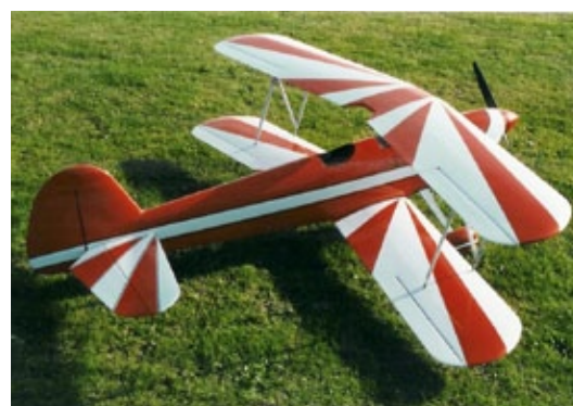
Heinkel He-72 Kadett von Peter Adolfs 1993: Spannweite 2.100 Millimeter, Gewicht 12,5 Kilogramm, Antrieb 2× Plettenberg HP 355/40/7 (Bürstenmotor) mit Eigenbau-Zahnriemengetriebe, Propeller 21 × 13 Zoll Asano, 2 × 30 Zellen Sub-C Sanyo SCR-C 1700, 5.700 Umdrehungen in der Minute bei 70 Ampere Stromaufnahme
