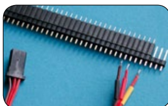
2. Zum Lötten Steckerleiste mit Gegenstück sichern
