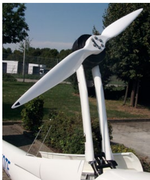
Die Klapptriebwerksmechanik konnte vom Verbrenner-Turbo übernommen werden. Zum Einfahren in den Rumpf bringt die Sensorelektronik den Propeller in eine definierte Parallelposition zum Arm
