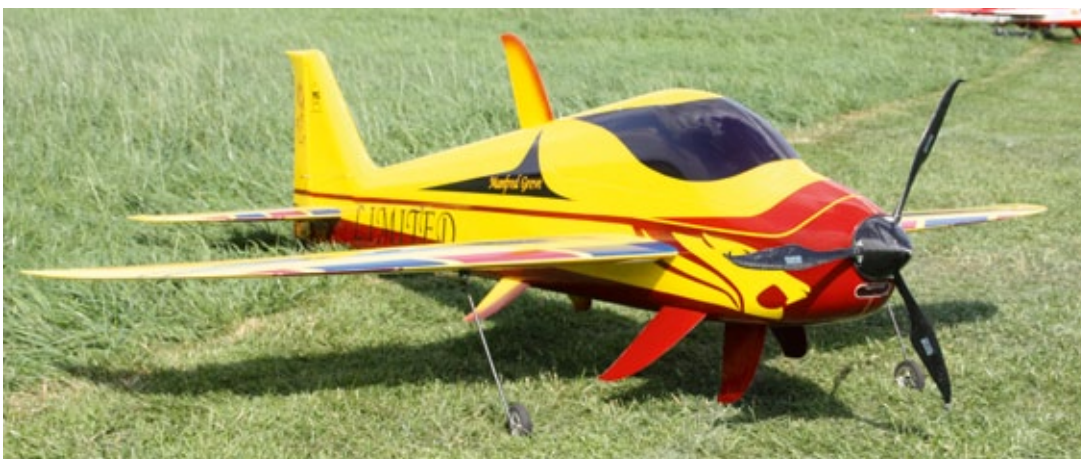
Die neueste Variation des Limited Beluga von Manfred Greve mit sechs Stummelflügeln – der vordere in der Mitte ist mit dem Seitenruder steuerbar – und Dreiblattpropeller Magcad
