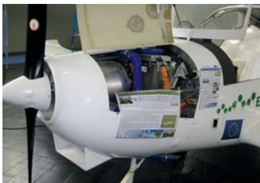
Brennstoffzellenflugzeuge sind schon in Erprobung – hier eine Exponat auf der Aero Friedrichshafen 2011
