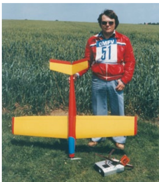
Der Sieger des DMFV-Wettbewerbs 1982, Reinhard Weber, mit seinem Modell. Spannweite 1.400 Millimeter, Gewicht 2.800 Gramm, 22 bis 24 Zellen Sub-C-Größe, Motor Keller 50/14 als Direktantrieb
