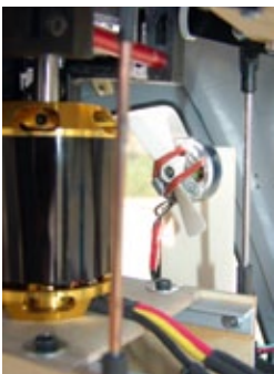
Die einfache Motorträger-Konstruktion – eine Kombination aus miteinander verschraubten Spanten und Alu-Winkeln. Der kleine Zusatzlüfter dient zur Kühlung des Antriebsmotors
