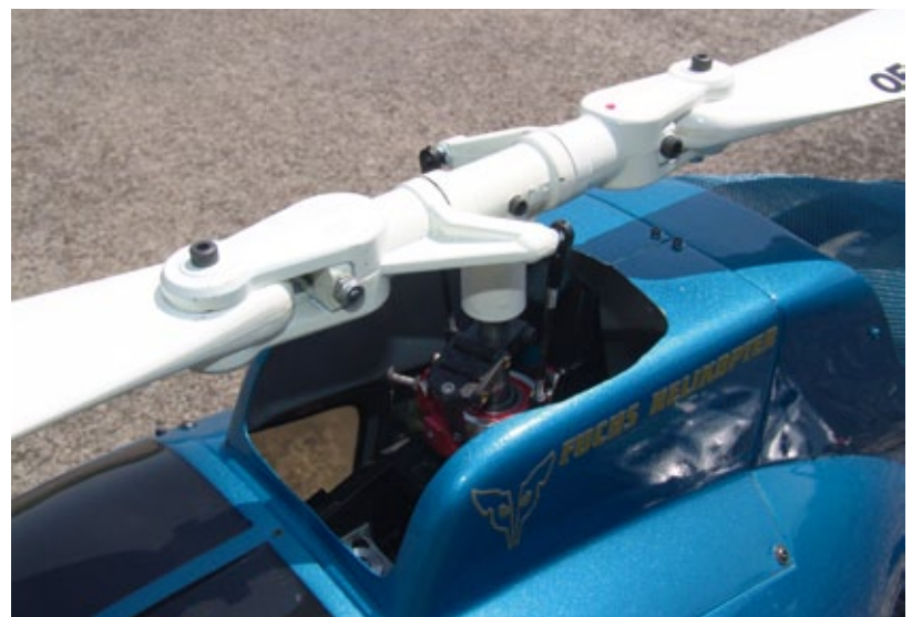
Das linksdrehende OF-Zweiblatt-Rigid-System mit dem Bendix-Zugelement
