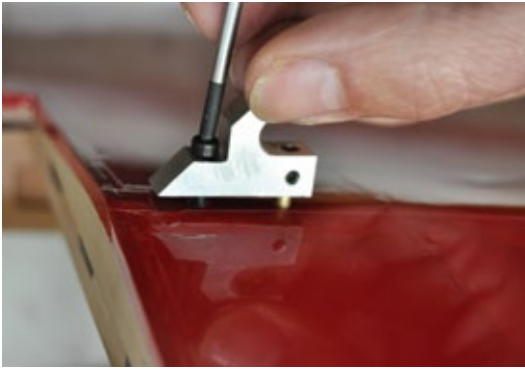
Die robuste Schleppkupplung ist wartungsfreundlich und mit einer Inbusschraube schnell montiert
