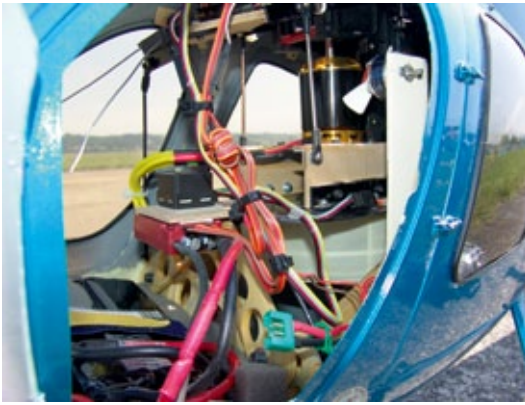
Der Jive-Controller sitzt unterhalb des Gyro-Podests, auf dem der Futaba GY 401 befestigt ist. Der Controller beeindruckt durch sein ausgezeichnetes Regelverhalten im Governor-Mode
