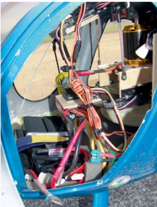
Die beiden 5s-LiPos sowie das 2s-Pack (Zusatzlüfter) sind im Rumpfbauch verstaut
