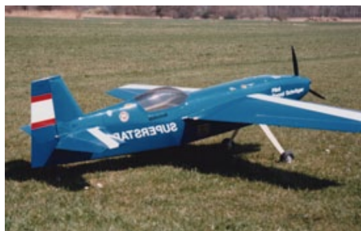
Ratsrepus von Bernhard Schröger. Spannweite 2.400 und Länge 2.000 Millimeter, Gewicht 12,8 Kilogramm, Akkus 3 x 30 NiCd 1.400er-Klasse, Motor Plettenberg Dino
