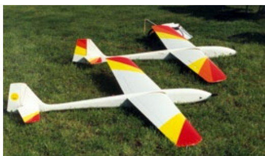
Eine Konstruktion von Dirk Menge. Spannweite 1.800 und Länge 1.600 Millimeter, Gewicht 3.500 Gramm, 20 Sub-C-Zellen, Motor Graupner Ultra 1600, Propeller APC 9 x 7 Zoll, Direktantrieb
