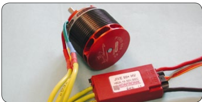
Mit dem Jive 80+ HV wurde gemessen (Autotiming)
