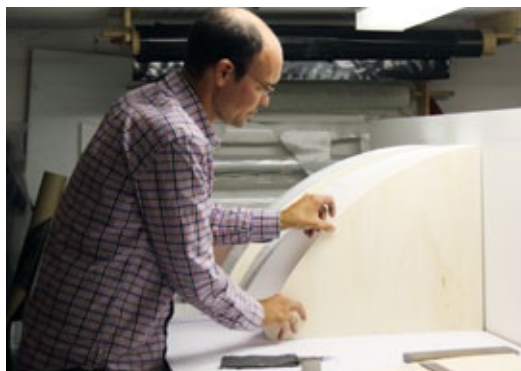
Hier entsteht im Auftrag des DLR für die Deutsche Bahn ein Anströmkörper, der für Windkanaltests vorgesehen ist
