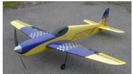
E-Faktor Type SMR99 von Michael Ramel. Spannweite 1.998 und Länge 1.996 Millimeter, Gewicht 4.400 Gramm, Motor Lehner LMT1940/14 mit Getriebe 6:1, Folding-Prop 17 x 12 Zoll, 30 x NiCd RC 2000 bis RC 2400
