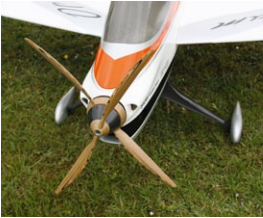
Gegenläufiger Doppelprop-Antrieb von Peter Haase, eingebaut im Opium von Jan Rottmann
