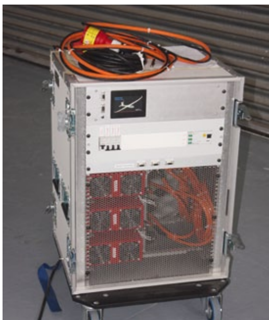
Und damit wird „aufgetankt“: das 7,5-Kilowatt-Drehstromladegerät
