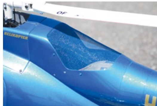
Die große Gitteröffnung im Dombereich ist nicht nur vorbildgetreu, sondern dient auch dazu, dem Gebläserad entsprechende Luftzufuhr zu gewährleisten
