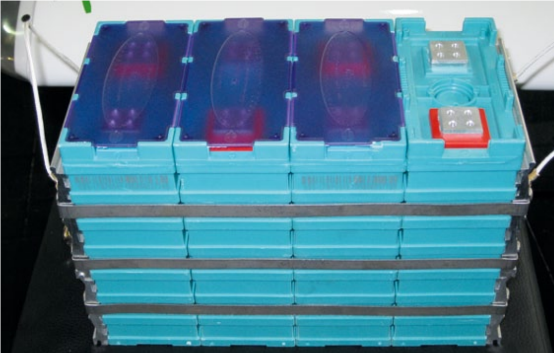
100-Amperestunden-Lithium-Ionen-Batterie mit Lithium-Eisenphosphat-Kathode steht als Pufferbatterie in Kombination mit einer Brennstoffzelle hoch im Kurs. Als alleiniger Energiespeicher gilt sie mit 100 Wattstunden je Kilogramm als zu energiearm
