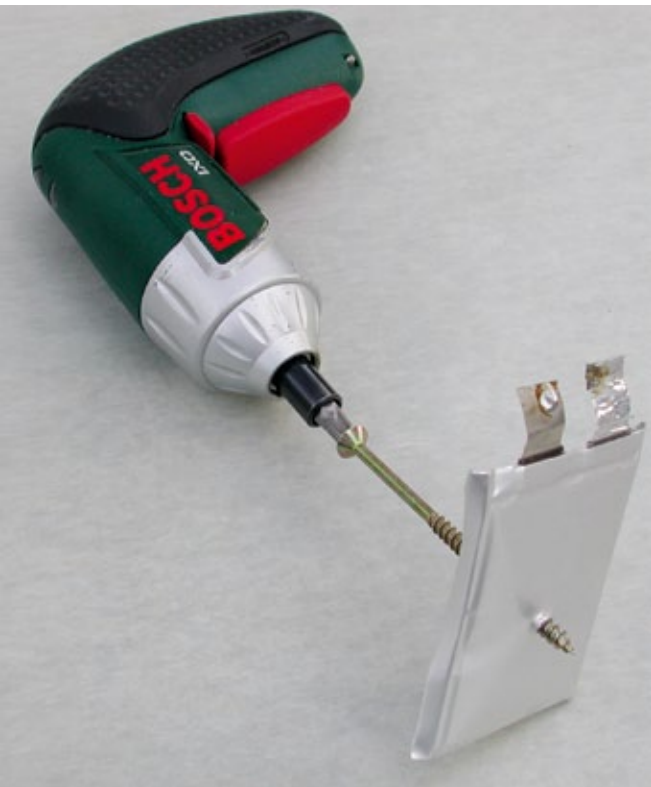
Entladene (!) LiPos lassen selbst solche Misshandlungen zu. Das Bild widerlegt Gerüchte, nach denen ein LiPo zwangsläufig brennen muss, wenn man einen Nagel in ihn hineintreibt
