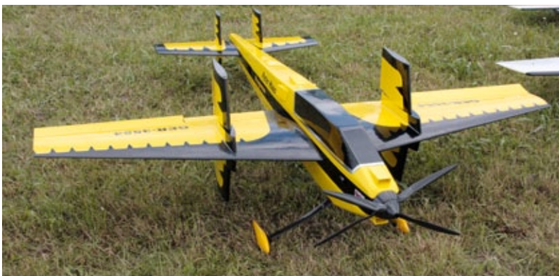
Quergedacht – Progress von Peter Haase. Alle Steuerflächen sind angelenkt. Auch solche Konstruktionen werden mit dem Elektroantrieb realisierbar
