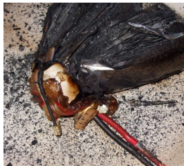
Ergebnis eines überladenen LiPos. Da er sich in einem feuerfesten Behälter befand, ist nichts Schlimmes passiert
