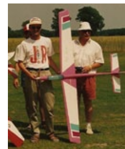
Peter Albert mit seinem PEPP: 22 bis 26 Nickel-Cadmium-Zellen mit 1.400 Milliamperestunden Kapazität, Motor Plettenberg, Propeller Zinger 11 x 7,5 Zoll, Gewicht 3.000 Gramm
