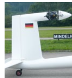
Ungewöhnlicher Einbauort des Antriebsmotors. Bei den ersten Flügen war der noch unverkleidet
