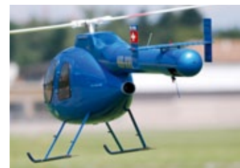
Ungewohntes Bild: die Drehung des Helis übers Heck erfolgt über das NOTAR-System
