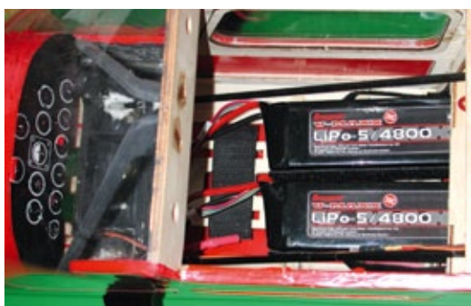
Der vergleichsweise schwere Außenläufer verbannt die Akkus auf die hinteren Plätze
