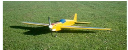
Saphir E von Peter Claus in Styro-Balsa-Bauweise mit Einbein-Einziehfahrwerk. Spannweite 1.740 und Länge 1.640 Millimeter, Gewicht 4.500 Gramm, Motor Plettenberg HP 355/50/8, Akku 30 Zellen Sanyo 1.700 NSCR (SP), Propeller APC 13 x 9 Zoll, Regler Schulze Heli
