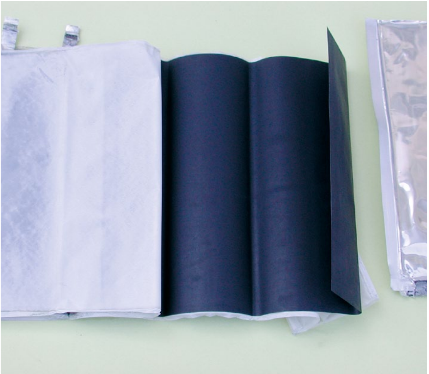
Nach dem Entfernen der Aluhülle einer LiPo-Zelle offenbart sich der Aufbau. Das Weiße ist der Separator. Darunter liegt die Lithium-Metalloxid-Folie und rechts in schwarz ist die Graphitfolie zu sehen. Hier gilt ganz klar die Aufforderung, das Aufschneiden eines LiPos nicht nachzuahmen
