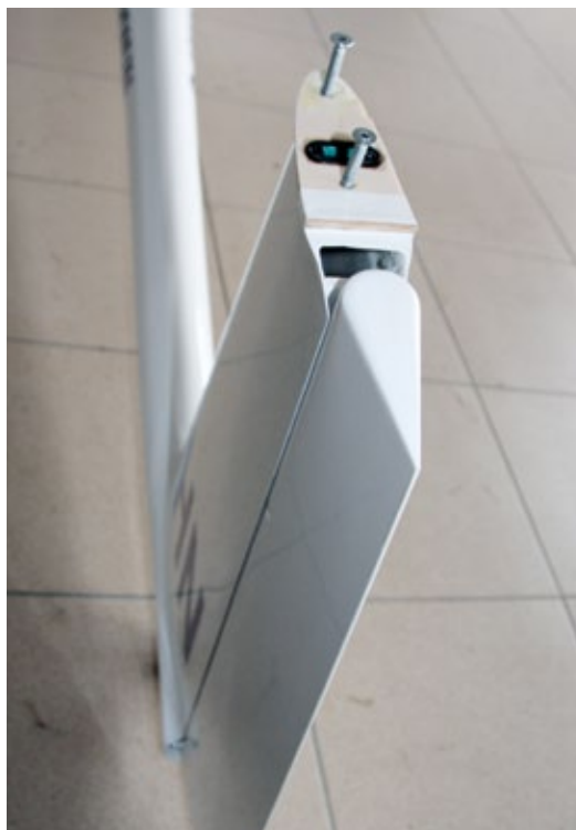
Die Höhenruderrflosse mit den beiden Servos wird einfach mit zwei Stahlschrauben fixiert
