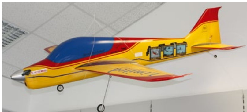
Der Limited Beluga von Bernd Beschorner im Showroom der Firma Plettenberg. Motor Plettenberg Xtra 25/12 im Spinner mit Kokam 10s3p 2.000er-LiPo
