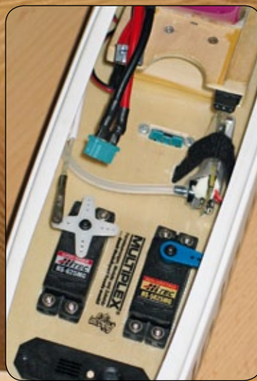
Im geräumigen Alpina-Rumpf ist viel Platz für die RC-Komponenten. Dadurch sind eine Vielzahl verschiedener Antriebskombinationen und großer, kräftiger Servos möglich
