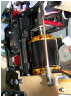
Deutlich zu erkennen ist das obere Stützlager am Ende der verlängerten Motorwelle
