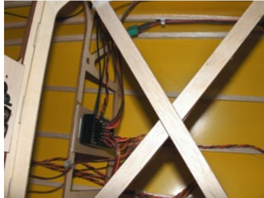
Der Empfänger Jeti Duplex R8 EPC ist mit doppelseitigem Klebeband befestigt. Beide 2,4-Gigahertz-Antennen sind innen im Rumpf montiert, eine schaut senkrecht nach oben, die andere ist parallel zur Rumpflängsachse ausgerichtet
