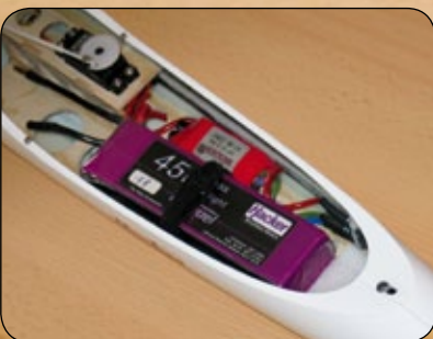
Auch mit 5s-LiPo und leistungsstarkem Elektroantrieb kommt der Luky Sport problemlos unter 4.500 Gramm Abfluggewicht
