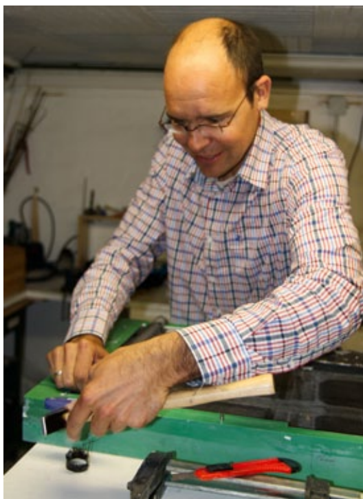
Gelegentlich ist beim Entformen der vorsichtige Einsatz eines Hammers erforderlich
