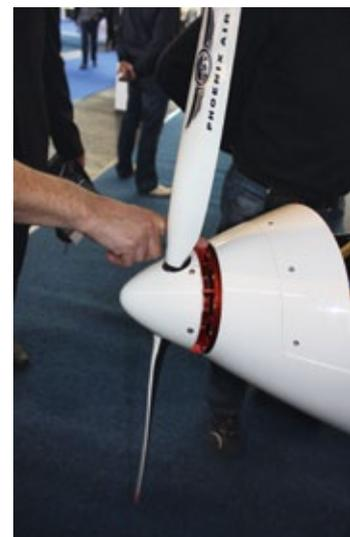
*Elektro-Projekt von Phoenix Air – der Kühlluftauslass des Außenläufermotors liegt hinter der Spinnerkappe*
