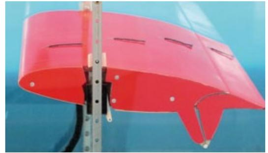
eine zweite Schiene montiert. Über ein Loslager, das das Giermoment auffängt, wird der Schlitten auf dieser Schiene passiv mitbewegt.
