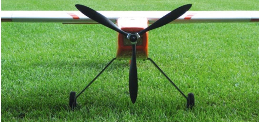
*Der in der Steigung einstellbare Ramoser-Dreiblatt-Propeller mit 19,9-Zoll-Durchmesser und verbautem Plettenberg-Motor*
