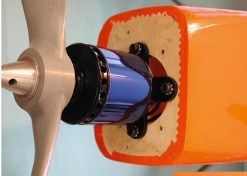
*Der Graupner-Außenläufer wird vor dem Spant eingebaut ...*
