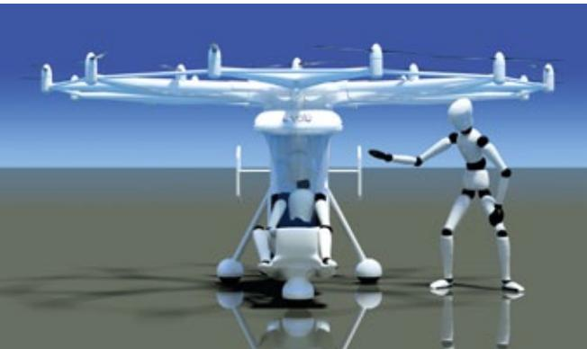
**Der VC Evolution 1P ist als Einsitzer geplant. Der Pushertrieb dient zur Erhöhung der Vorwärtsgeschwindigkeit – ist allerdings optional**
