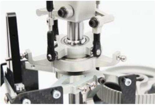
**Oberes Rotorwellenlager, darüber die Alu-Taumelscheibe mit ihrer 120-Grad-Anlenkung und die am Rotorkopf-Zentralstück befestigten Mitnehmerarme**
