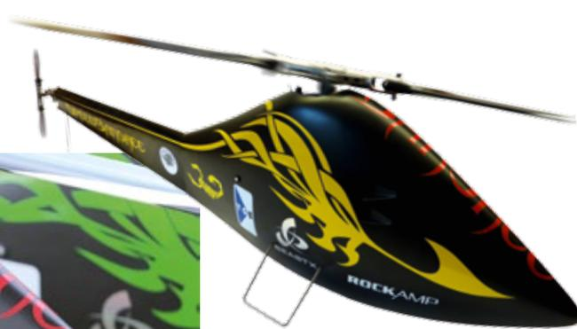
**Unter anderem bekam das Weltrekordmodell gegenüber dem normalen Banshee eine aerodynamisch vollständig überarbeitete Kabinenhaube spendiert. Highlight hier die beiden NACA-Duct-Einlässe zur Zwangsbelüftung des Controllers**
