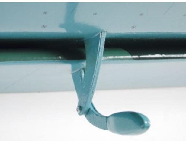
*Liebevoll ausgearbeitete Details sind diese Ausgleichsgewichts-Nachbildungen an den Flettner-Querrudern. Dass sie chronisch bruchgefährdet sind, wird bei ihrem Anblick verständlich. Doch ist das leicht mit beidseitigem Anbohren und einem Stück GFK-Bowdenzugseele als elastischem Verbindungselement zu beheben*
