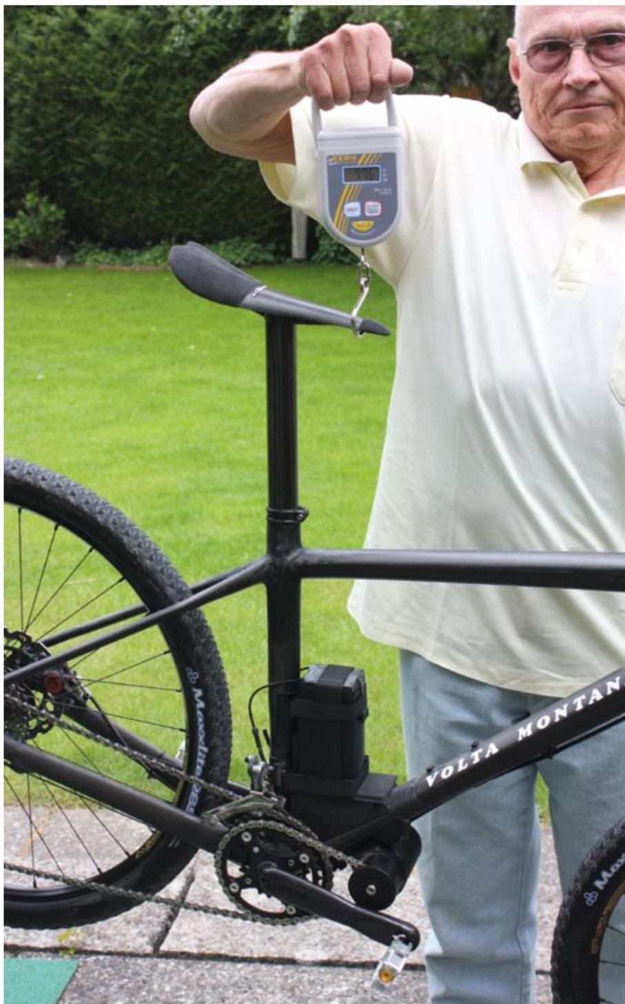
selbstredend aus modernsten Hightech-Materialien wie Karbonfaser und Titan aufgebaut ist, ein Plettenberg-Brushless-Motor erst mal auf ein doppeltes Planetengetriebe, um die Drehzahl des auch bei niedertouriger Auslegung immer noch viel zu schnell drehenden E-Motors zu reduzieren. Ein dort angebrachtes Ritzel treibt über eine kurze Hilfskette ein zusätzliches, großes Kettenblatt an. Heraus kommen bei voller Motorleistung dann etwa 70 Kurbelumdrehungen je Minute, ideal für Mann und Motor.
