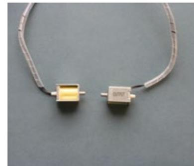
*Die beiden Magnetventile, je eines für Ein- und Ausgang, steuern die Gaszufuhr für die Brennstoffzelle*
