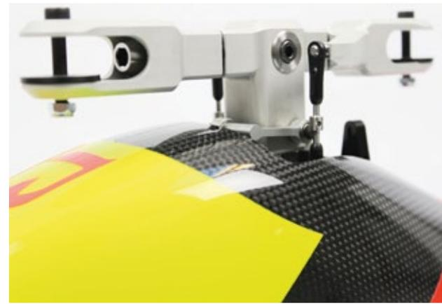
*Das neue Zweiblatt-Rigid-Hauptrotorsystem des Banshee 700. Er zeichnet sich durch einen niedrigen Aufbau aus, um das Mastmoment möglichst klein zu halten*
