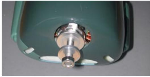
**Die Motorachse kommt etwas unterhalb der Mitte aus der Haubenöffnung**
