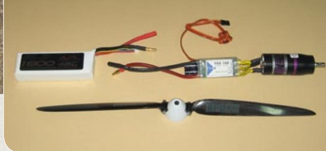
*Optimal auf den Omega ist das Antriebsset aus Lehner-Motor, YGE-Regler und Freudenthaler-Luftschaube abgestimmt*
