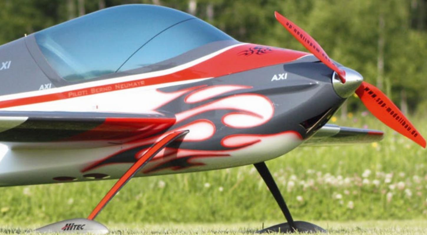
Autor hatte schon immer ein Faible für Rumpfe, die eine gewisse Ähnlichkeit mit der Optik eines Fisches haben – das Extravagante zieht einfach an. Hier ist der hohe Rumpfquerschnitt erforderlich, um in den Messerflugfiguren eine gewisse Tragfähigkeit zu bekommen. Die Möglichkeit, Akkus in mehreren Modellen einzusetzen, erschließt völlig neue Optionen, nämlich neben einem Elektrosegler auch ein Akro-Modell bewegen zu können.
