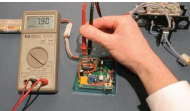
*Die Ausgangsspannung der Brennstoffzelle lässt sich bequem an den Messpunkten in der Regelektronik messen*
