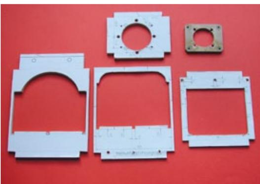
*Die solide ausgeführten Vorderrumpfspanten*
