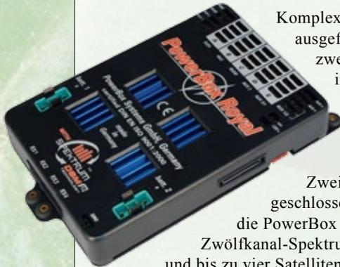
Komplexes Stromversorgungssystem mit komplett redundant ausgeführter Elektronik. Eine Akkuweiche zum Anschluss zweier LiPo-, NiXX- oder LiFePo-Akkus ist integriert. Anschlussmöglichkeit für bis zu 28 Servos, außerdem stellt die PowerBox Royal fünf Matchkanäle bereit, mit denen bis zu 20 Servos bedient werden können.
