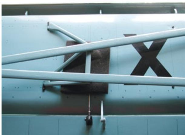
*Transporterleichterung: Es werden nur die Verschraubungen an der Außenfläche und am Rumpf gelöst. Die Flächenverstrebung lässt sich dann zusammenfallen*
