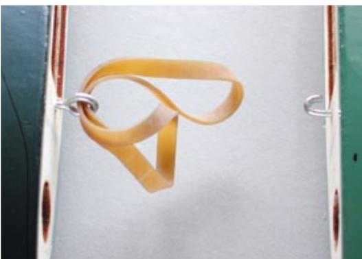
*Die Flächen werden beim Testmodell entgegen der Bauanleitung mit Gummis zusammengehalten. Aus Sicherheitsgründen wurde der hier abgebildete einzelne Gummiring durch ein Bündel aus fünf dünneren Ringen ersetzt*
