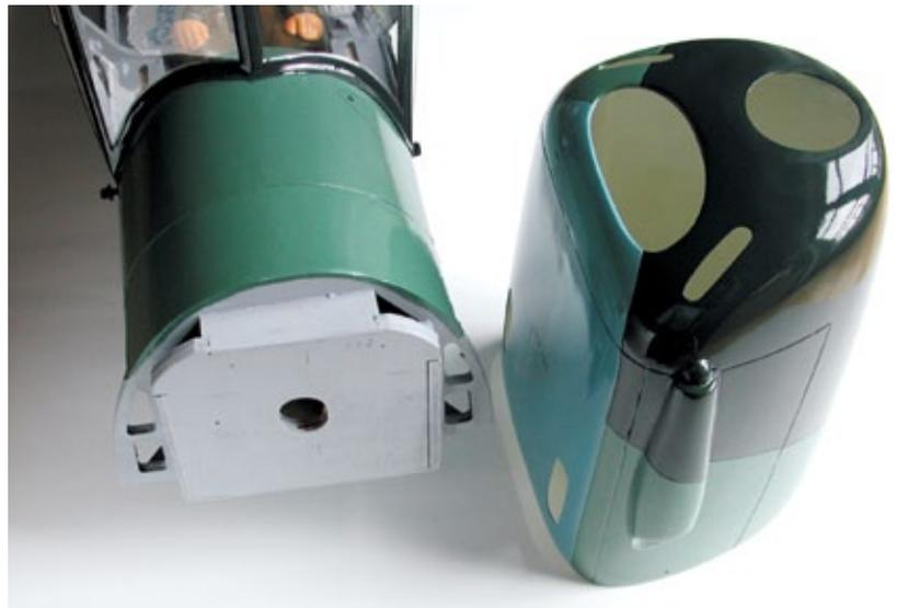
*GFK-Haube und noch unbearbeiteter Motorspant. Sturz und Seitenzug sind hier bereits eingearbeitet*
