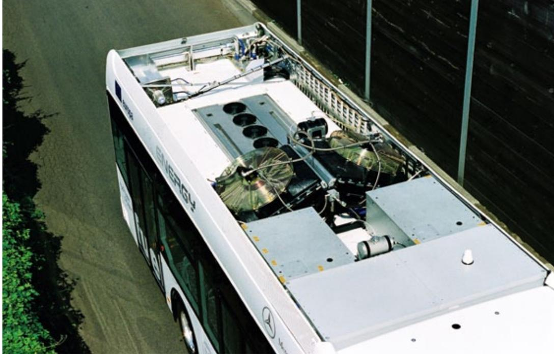
**Mercedes-Benz Citaro Brennstoffzellenbusse: Das Brennstoffzellen-System und die Druckgas-Flaschen sind auf dem Dach der Fahrzeuge untergebracht. Hier wird aus dem Wasserstoff Strom gewonnen, der den 200 Kilowatt starken Elektromotor treibt. Im Bus haben bis zu 70 Passagiere Platz – bei einer Reichweite von rund 200 Kilometern. Die Spitzengeschwindigkeit beträgt 80 Stundenkilometer**
