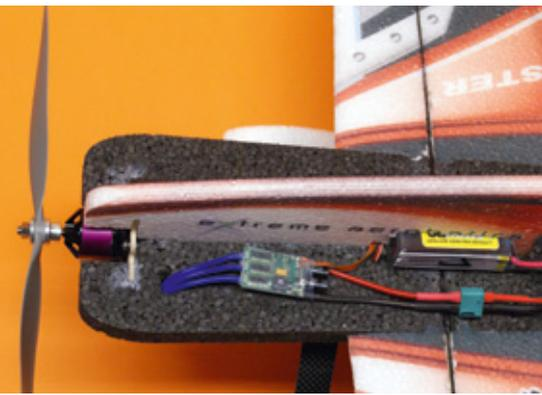
*Gut zu erkennen sind die beim Testmodell gewählten Einbaupositionen von Regler und Antriebsakku. Auf diese Weise wird der vorgegebene Schwerpunkt erreicht und ein sicherer Halt des Akkus gewährleistet*
