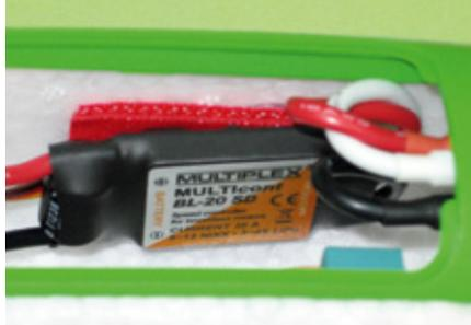
Als Regler kommt ein MULTICont BL-20 SD zum Einsatz. Er bietet eine Belastbarkeit von 20 Ampere, eine Bremse und ein BEC
