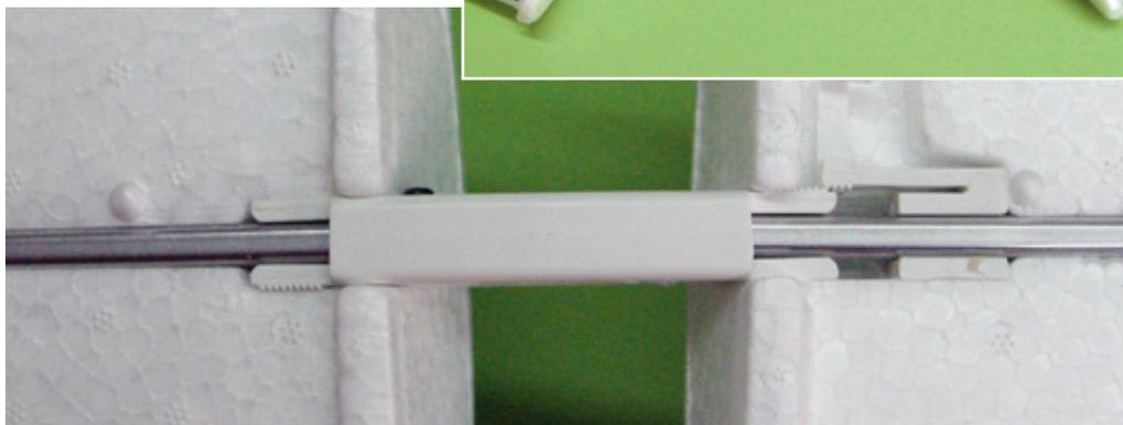
*Die Tragflächen verfügen über einen Holm aus Vierkant-Aluminium. Über ein Kunststoffteil werden die beiden Flügelhälften miteinander verbunden. Eine Rastung sorgt einerseits dafür, dass die Flächen am Rumpf gehalten werden und sich gleichzeitig bei Überlast lösen können*
