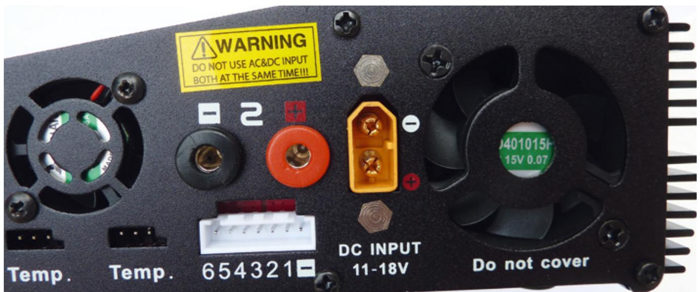
Zwei Lüfter und ein Kühlkörper auf der Gehäuserückseite sorgen auch bei heißen Temperaturen für ausreichend Kühlung
