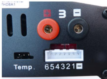
Balancer- und Temperatursensor-Anschluss stehen für jeden Ladeausgang separat zur Verfügung
