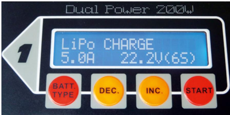
Im Untermenü erfolgen die Auswahl des Ladeprogramms und die Einstellung von Ladestrom und -spannung
