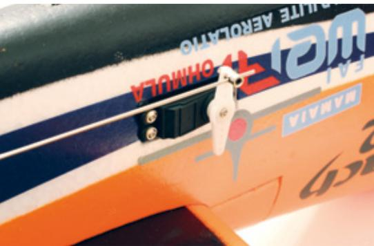
Die Länge des Lenkgestänges lässt sich einfach über eine Madenschraube justieren
