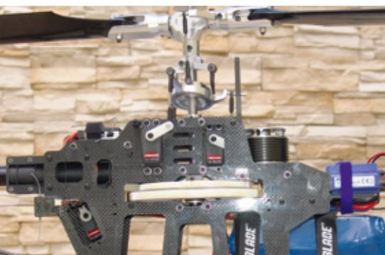
Das Hauptrotorsystem ist komplett aus Alu gefertigt. Die Rotorwelle ist dreifach gelagert, der Heckantrieb erfolgt über Starrwelle
