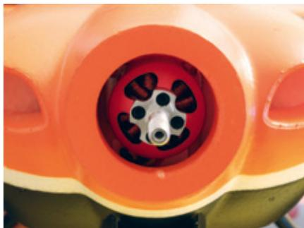
Der Brushlessmotor verfügt über eine spezifische Drehzahl von 650 Umdrehungen pro Minute und Volt. An beiden Seiten sind Kühllöffnungen in der Cowling eingelassen
