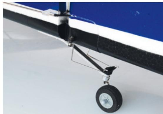
Die Montage des Spornfahrwerks geht schnell vonstatten. Angelenkt wird es über das Seitenruder
