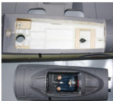
*Der Innenraum ist durch das Abnehmen der Pilotenkanzel erreichbar. Hier ist genügend Platz für die RC-Komponenten*
