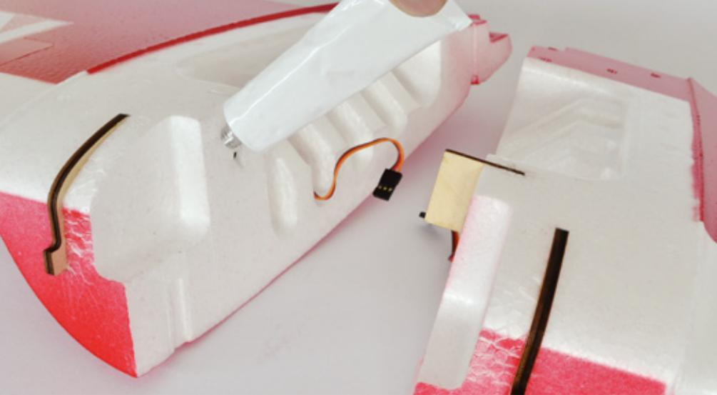
Größter Arbeitsschritt beim Bau: Die Tragflächenhälften müssen mit dem beiliegenden Kleber verbunden werden
