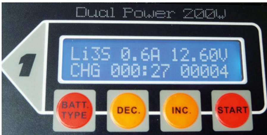
Während des Ladevorgangs behält man leicht den Überblick über alle erforderlichen Informationen und Werte. Bei Verwendung des Balancer-Anschlusses können über die INC.-Taste die einzelnen Zellen Spannungen eingesehen werden
