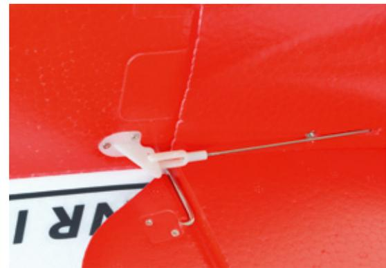
Die Leitwerksmontage ist durchdacht. Das Höhenleitwerk wird mit nur einer Schraube gehalten, das Seitenruder muss man lediglich einklipsen. Die Kunststoffgabelköpfe sind solide und spielfrei ausgeführt
