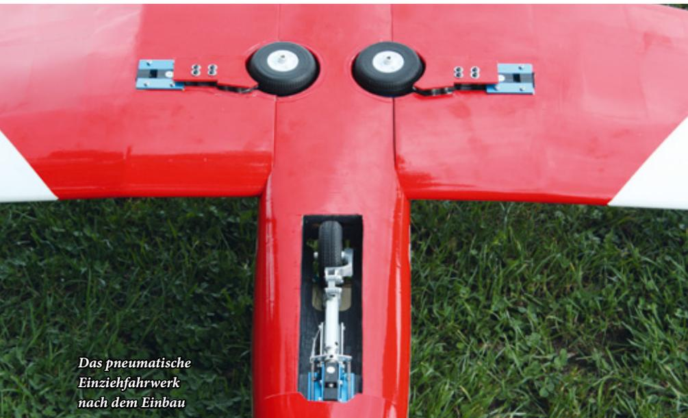
Das pneumatische Einziehfahrwerk nach dem Einbau
