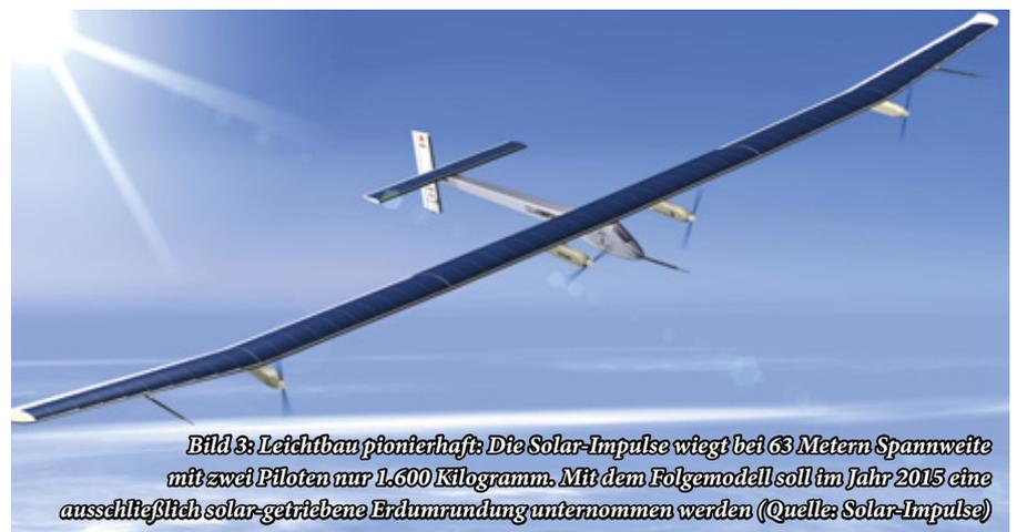
Bild 3: Leichtbau pionierhaft: Die Solar-Impulse wiegt bei 63 Metern Spannweite mit zwei Piloten nur 1.600 Kilogramm. Mit dem Folgemodell soll im Jahr 2015 eine ausschließlich solar-getriebene Erdumrundung unternommen werden (Quelle: Solar-Impulse)
