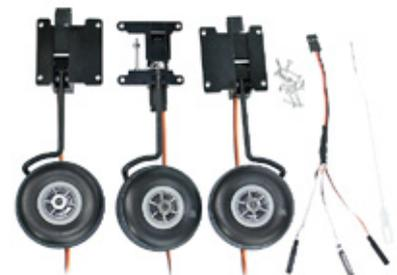
*Elektrisches Fahrwerk von Multiplex*
