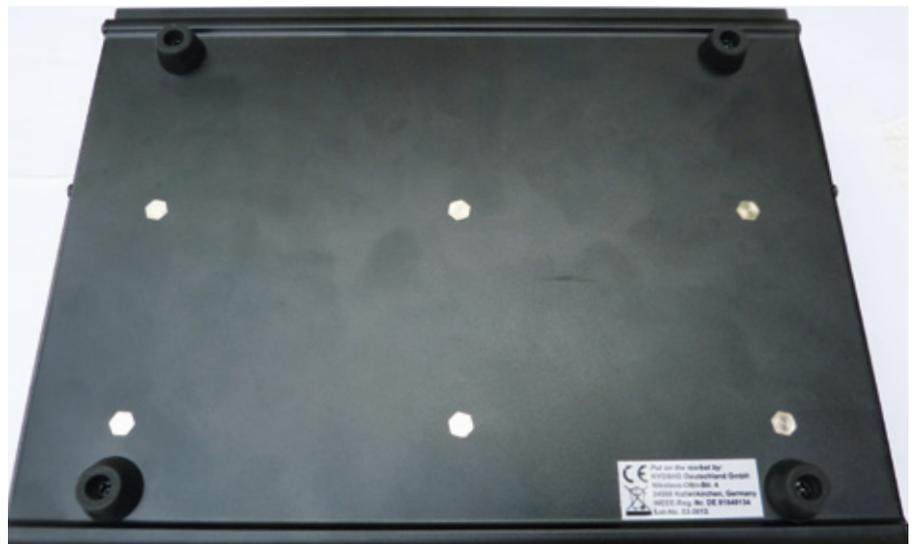
Vier Gummifüße auf der Unterseite des Aluminiumgehäuses gewährleisten einen stabilen Stand. Darin verstecken sich Schrauben, falls man mal an die Innereien heran muss
