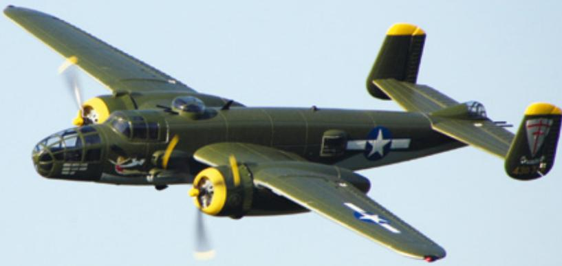
*Bild 1: Für die B25 Mitchell von North American soll die Lande-Anfluggeschwindigkeit von 130 Stundenkilometer maßstäblich im Modell nachempfunden werden. Für einen Maßstab 1:8,5 entsprechend 2.420 Millimeter Spannweite entspricht dies etwa 6 Meter pro Sekunde*
