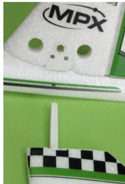
*Das Pendelhöhenruder verbindet sich mittels Vierkantsteckung formschlüssig mit der im Rumpf integrierten Pendelruderspindel*
