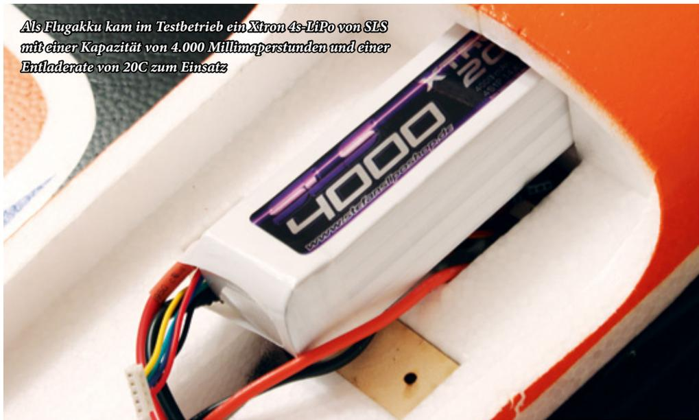
Als Flugakku kam im Testbetrieb ein Xtron 4s-LiPo von SLS mit einer Kapazität von 4.000 Milliamperestunden und einer Entladerate von 20C zum Einsatz
