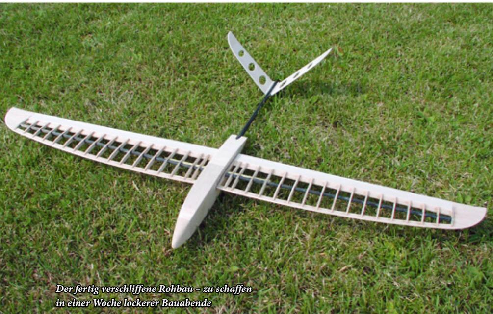
*Der fertig verschliffene Rohbau – zu schaffen in einer Woche lockerer Bauabende*
