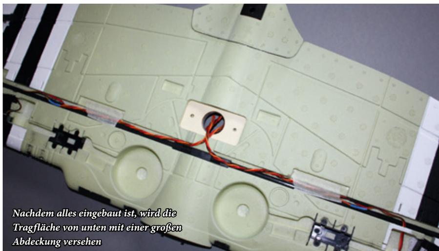
*Nachdem alles eingebaut ist, wird die Tragfläche von unten mit einer großen Abdeckung versehen*
