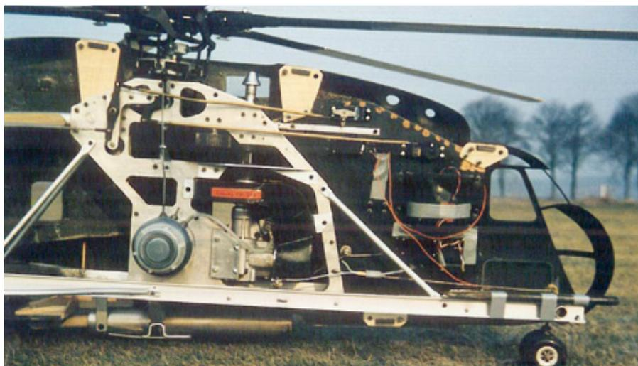
Die erste Rumpfhälfte ist montiert. Die auftretende Hecklastigkeit wird durch einen eingeklebten Meißel erfolgreich beseitigt
