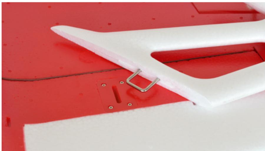
In den schicken Fahrwerksbeinen verstecken sich solide Stahlbügel. Zur Fixierung am Rumpf ist der Einsatz von Klebstoff empfehlenswert, um die benötigte Stabilität zu erhalten
