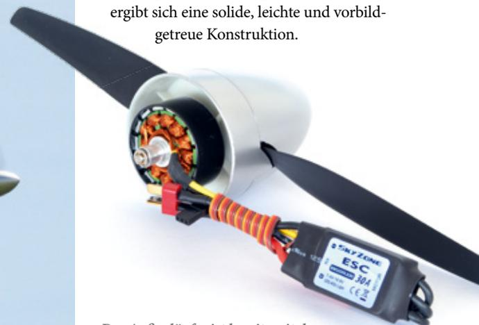
Der Außenläufer ist bereits mit dem Regler verlötet. Der Einbau des gesamten Antriebs dauert nur wenige Minuten
