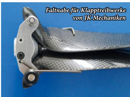
Faltnahe für Klapptriebwerke von JK Mechaniken
