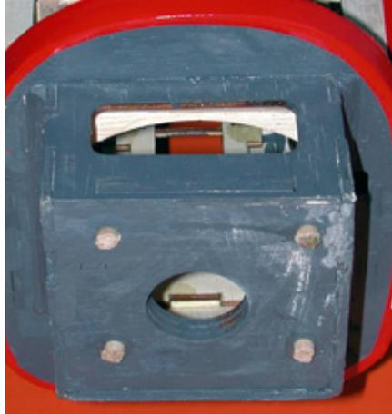
*Die Löcher im Motordom passen nur für die Verbrennerversion. Sie wurden daher mit Buchendübeln verschlossen, um knapp daneben wieder neu gebohrt werden zu können*
