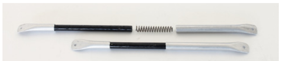
Die charakteristischen Fahrwerksbeine sind keine Attrappen – sie federn auch. Der Lack von den schwarzen Holzelementen geht im Betrieb leider stellenweise ab
