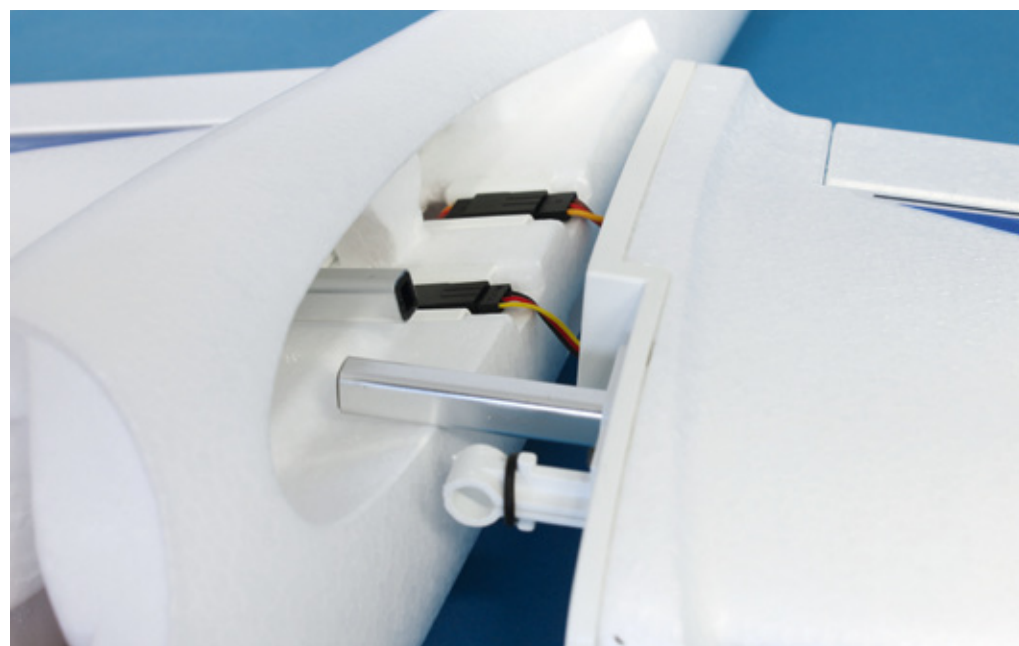
Aluminium-ummantelte CFK-Holmrohre stehen so weit über, dass sie in die jeweils gegenüberliegende Tragfläche greifen
