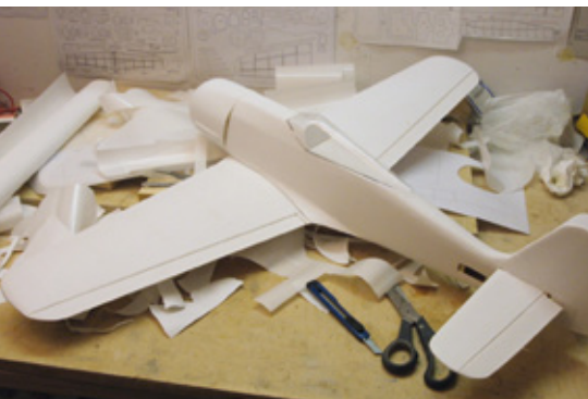
Als Untergrund für die eigentliche Lackierung sind Gewebefolien oder Besspannpapier empfehlenswert
