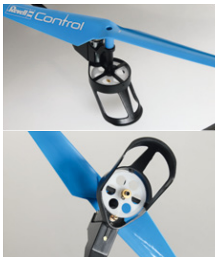
Einfache, solide Bürsten-Getriebe-Antriebe sorgen für gute Flugleistungen. Der Zahnradkorb schützt nicht nur, sondern dient auch als Standfuß – für Landungen im Gras ist er jedoch zu kurz
