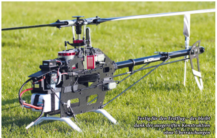
Das kraftvolle Herzstück des Dominator ist der RCM-BL730MX-Außenläufer mit einer spezifischen Drehzahl von 850 Umdrehungen pro Minute und Volt
