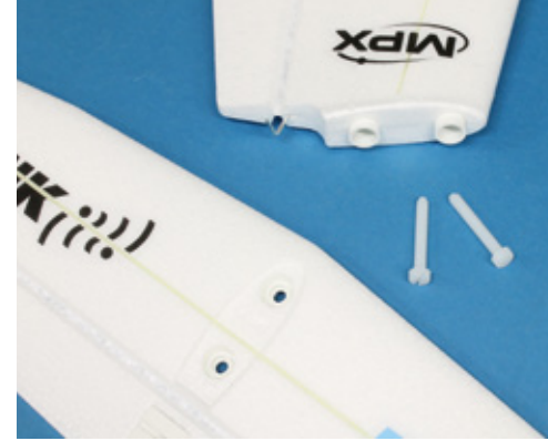
Plug-and-Play-Montage: Gestänge einhängen, zwei Schrauben reindrehen, schon sitzt das Höhenleitwerk
