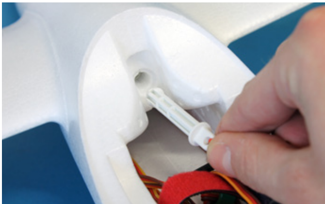
Über diesen selbstsichernden Kunststoff-Stift werden die Tragflächen am Rumpf gehalten
