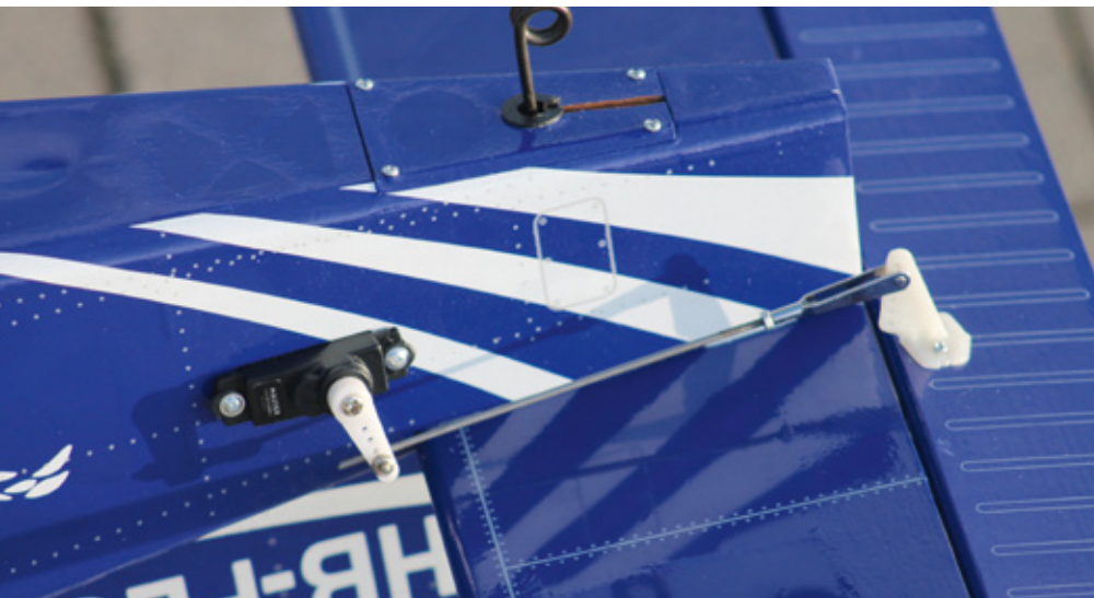
Das Spornrad ist an einem Spant im Rumpf verschraubt. Über eine Holzklappe ist die Mechanik zugänglich
