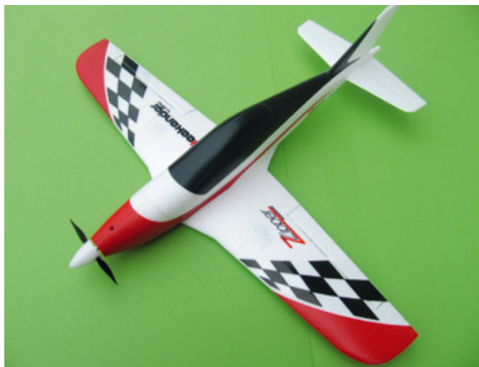
Bei beiden Weekender-Modellen handelt es sich um Zweiachs-Flugzeuge. Der Zipper wird über Höhe und Quer gesteuert, der eHawkEye über Höhe und Seite
