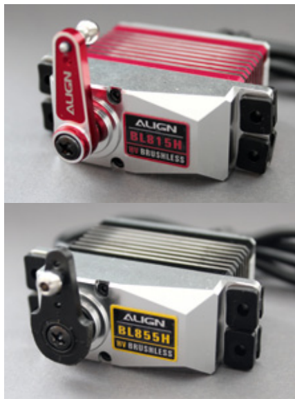
Drei BL815H (oben) sitzen an der Taumelscheibe, das BL855H ist für den Heckrotor zuständig. Alle Servos sind von sehr guter Qualität und arbeiten im Betrieb einwandfrei
