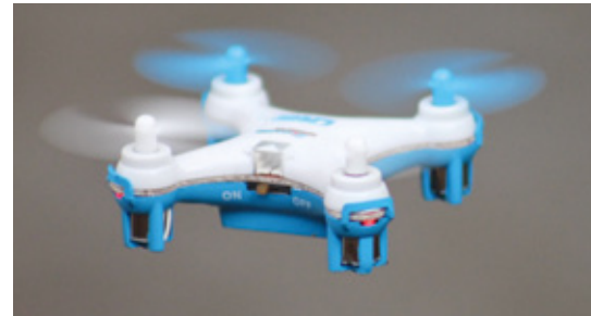
An den Ecken des Modells finden sich vier LED. Wenn sie dauerhaft leuchten, ist der Kopter betriebsbereit. Wenn sie blinken, ist entweder der Akku leer oder der Nano ist bereit zum Binden
