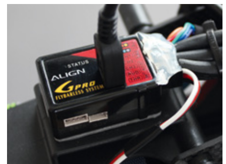
Das Gpro-Flybarless-System wird per USB-Schnittstelle am PC oder via Bluetooth-Modul mit einem Mobilgerät programmiert
