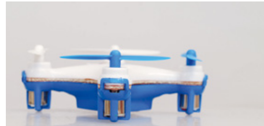
Zwischen den beiden verschraubten und geklippten Gehäusehälften kann man die Platine erkennen
