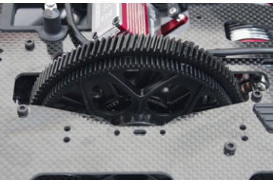
Das 10 Millimeter starke Hauptzahnrad ist schrägverzahnt, was das Betriebsgeräusch minimiert und die Kraftübertragung verbessert
