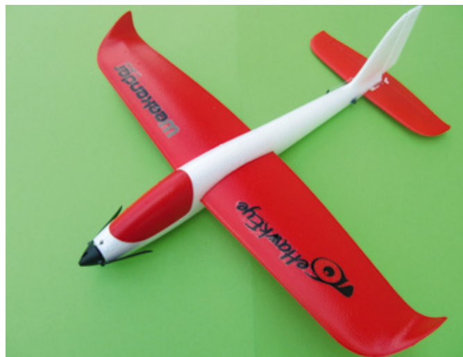
Bei beiden Weekender-Modellen handelt es sich um Zweiachs-Flugzeuge. Der Zipper wird über Höhe und Quer gesteuert, der eHawkEye über Höhe und Seite
