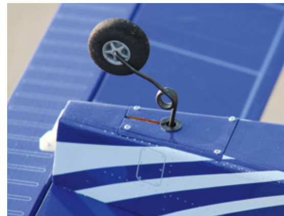
Das Spornrad ist an einem Spant im Rumpf verschraubt. Über eine Holzklappe ist die Mechanik zugänglich
