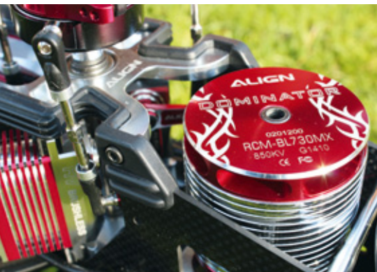
Das kraftvolle Herzstück des Dominator ist der RCM-BL730MX-Außenläufer mit einer spezifischen Drehzahl von 850 Umdrehungen pro Minute und Volt
