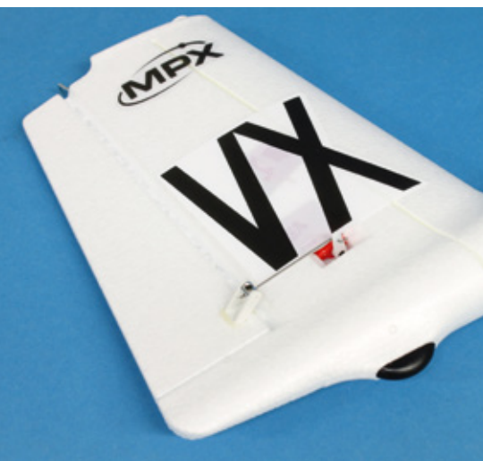
Die beiden Leitwerksservos sitzen direkt in der Seitenflosse
