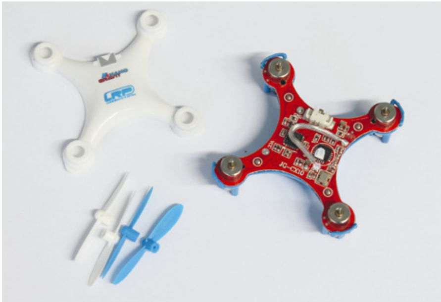
Im Inneren wartet der Nano Gravit mit solider Technik auf. Die vier Motoren werden durch das blau-weiße Gehäuse gehalten
