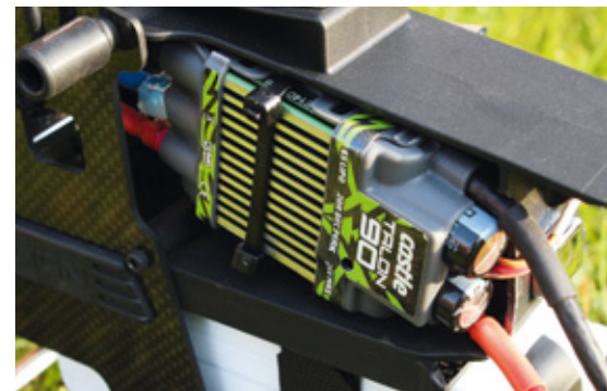
Der 90-Ampere-Regler von Castle Creations versorgt auch die RC-Anlage sicher mit dem integrierten BEC
