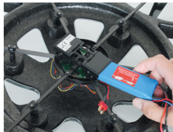
Tragendes Gerüst sind die Vierkant-CFK-Profile. Der Akku ist gut vor harten Landestößen geschützt
