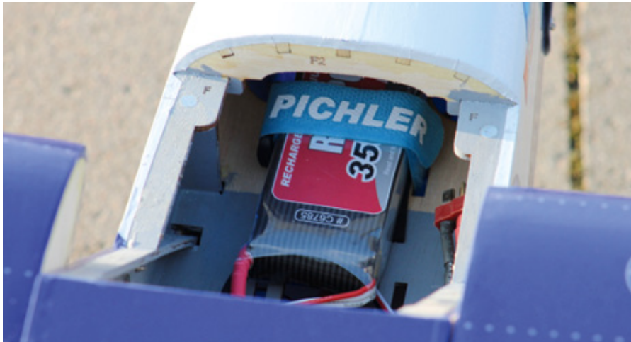
Über die magnetisch gehaltene Kabinenhaube ist der Akku gut zugänglich
