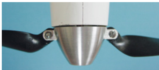
Wenn der Motorspant sauber eingebaut wurde, ergibt sich lediglich ein kleiner Spalt zum Spinner
