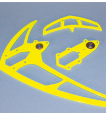
Das unübersehbare Leitwerk beinhaltet teilweise auch gleich das Heckrotorgehäuse
