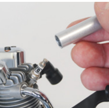
Für die besonders kleinen Zündkerzen mit Glühkerzengewinde liegt ein spezieller Schlüssel bei
