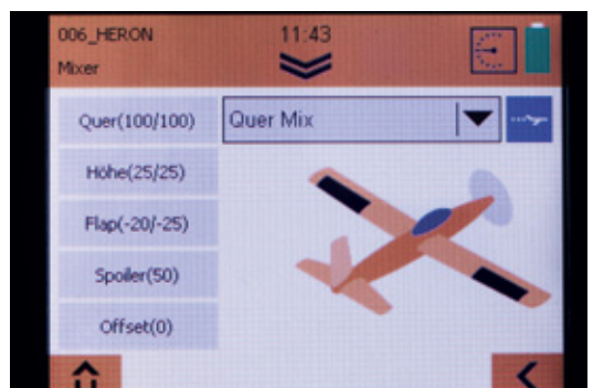
Im Mischermenü stehen rechts oben der jeweilige Mischer für die betroffenen Ruderklappen und links jeweils die Mischanteile dazu
