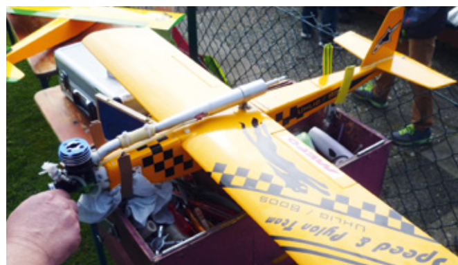
Das Unlimited-Modell des Meisters Harry Boos. Wie bei dieser Eigenkonstruktion von Altmeister Gerd Uhlig werden immer öfter preisgünstige Car-Motoren mit Resonanzschalldämpfer eingesetzt. Den „Tuning-Gelüsten“ sind dabei keine Grenzen gesetzt
