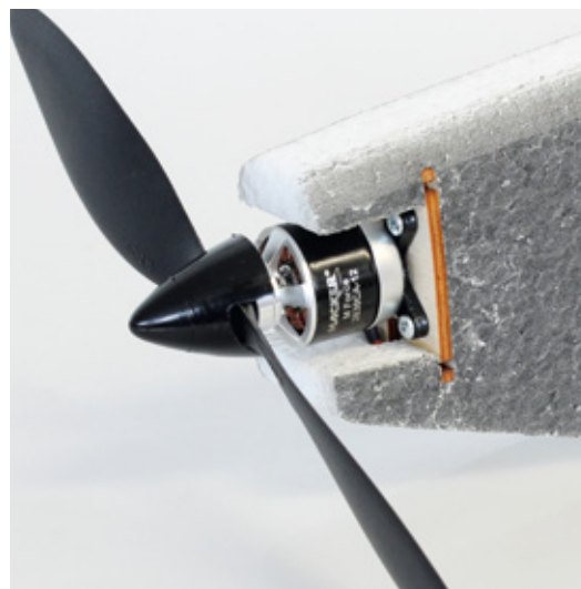
Der 200-Watt-Außenläufer hat genug Power für senkrechte Steigflüge
