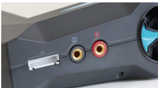
Auf der rechten Gehäusesseite befinden sich die Anschlüsse für die Ladekabel sowie der Balancer-Port
