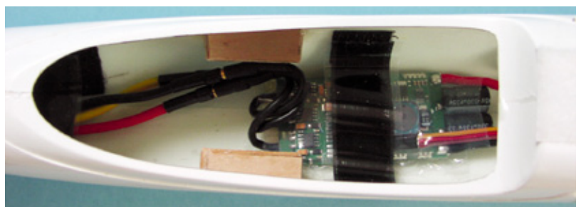
Auf den seitlichen Holzklötzchen wird das Auflagebrett festgeschraubt, der Regler liegt unter dem Brettchen
