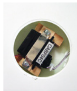
Das im Seitenleitwerk befestigte Höhenruder-Servo
