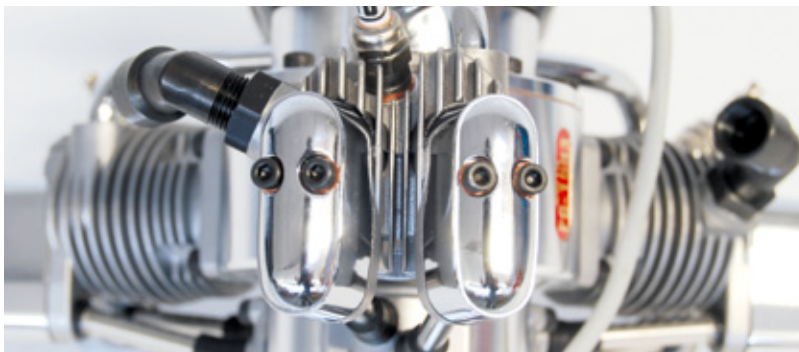
Unter den schicken Chrom-Deckeln verbergen sich die Kipphebel, über die auch das Ventilspiel eingestellt wird
