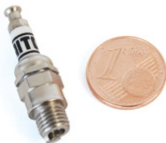
Im Vergleich mit einer 1-Cent-Münze werden die geringen Abmessungen der Zündkerzen deutlich. Ersatz ist leider recht teuer
