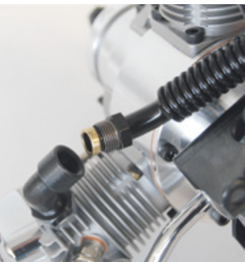
Die Flexrohre, die die Abgase abtransportieren, werden mit den Krümmern verbunden
