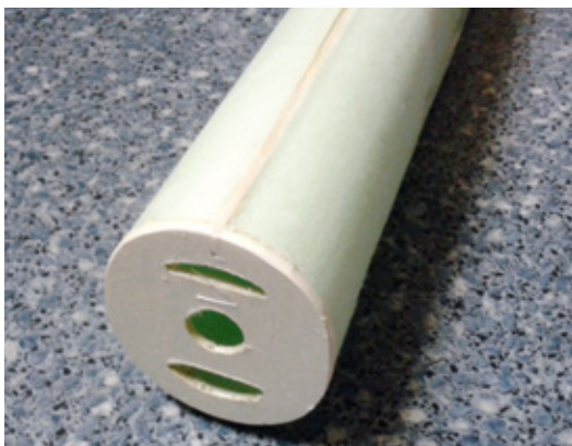
Ein Motorspant aus 4-Millimeter-Sperrholz bildet den Rumpf-Abschluss
