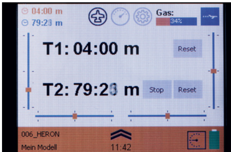
In der Statusansicht werden die beiden Timer sowie die Gasstellung und die Flugphase (rechts oben) angezeigt. Unten stehen links der Modellname und rechts der Status der Sprachausgabe sowie die Senderakkuanzeige
