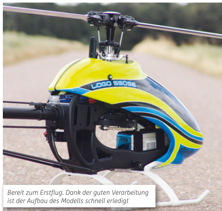
Die Alu-Taumelscheibe wird an drei um 120 Grad versetzten Punkten angelenkt
