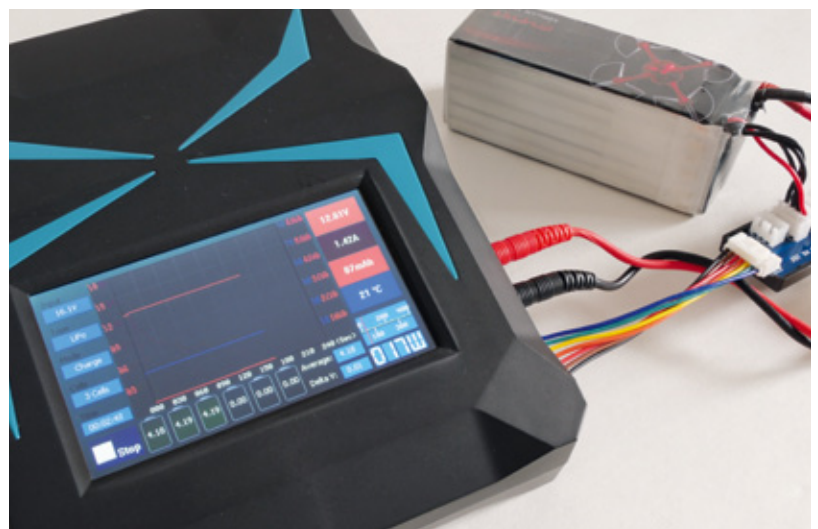
Während des Ladevorgangs werden auf dem Display Ladekurven sowie verschiedene Parameter angezeigt
