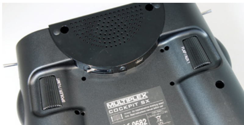
Die beiden Drehgeber auf der Senderunterseite lassen sich sehr gut bedienen
