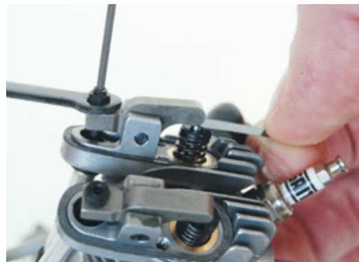
Zum Einstellen des Ventilspiels liegt passendes Werkzeug bei
