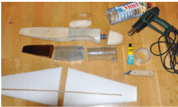
Besonders interessant ist die Herstellung von PET-Rümpfen aus alten Wasserflaschen
