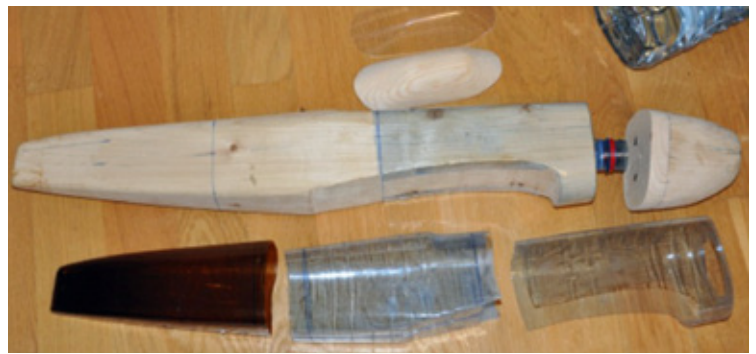
Besonders interessant ist die Herstellung von PET-Rümpfen aus alten Wasserflaschen
