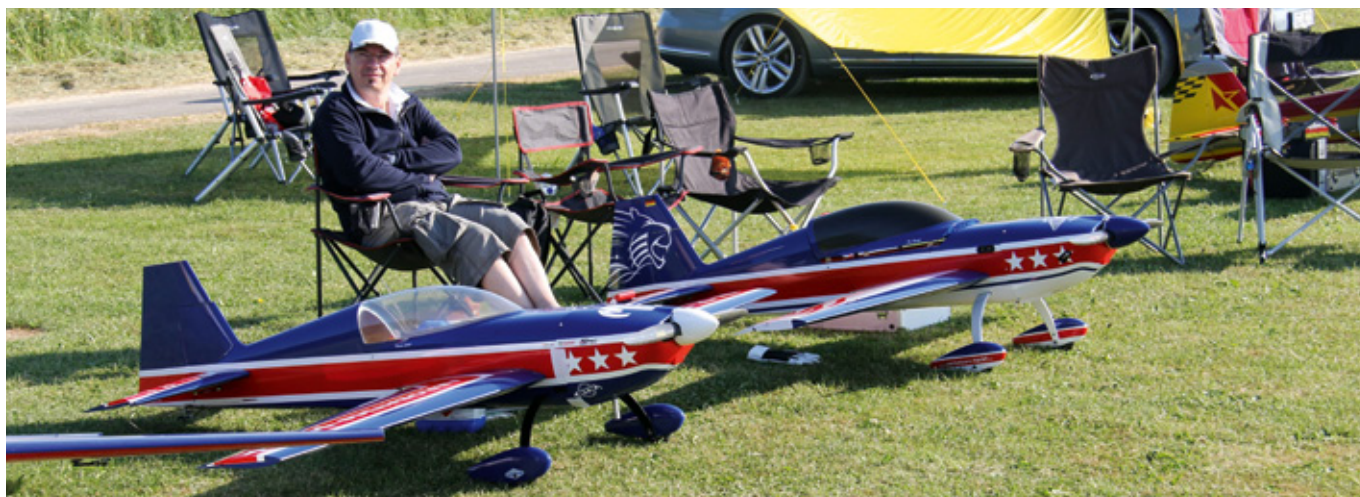
2 Maschinen vom Typ Extra 330 S aus dem Hause CARF – mit 2.000 Millimeter Spannweite erfüllen diese Modelle die Kriterien (Mindestspannweite 2.000 Millimeter) und eignen sich durch ein gutes Preis-Leistungs-Verhältnis sehr gut für den Einstieg in diese Kunstflugklasse
