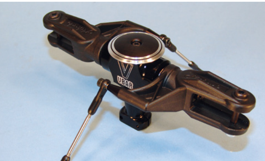
Mikado beweist, dass es nicht immer Alu und CFK sein müssen. Auch Blatthalter aus Kunststoff funktionieren hervorragend
