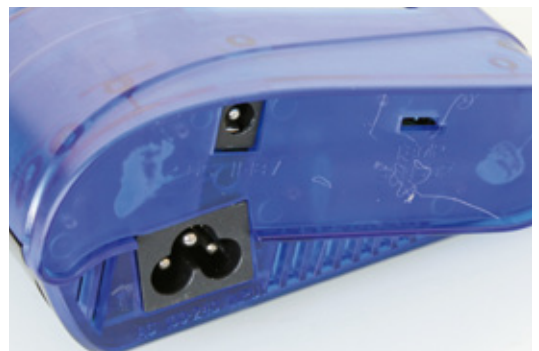
Auf der linken Gehäuseseite befinden sich die Ports zur Stromversorgung des F-100 sowie eine Buchse zum Anschluss eines Temperatursensors
