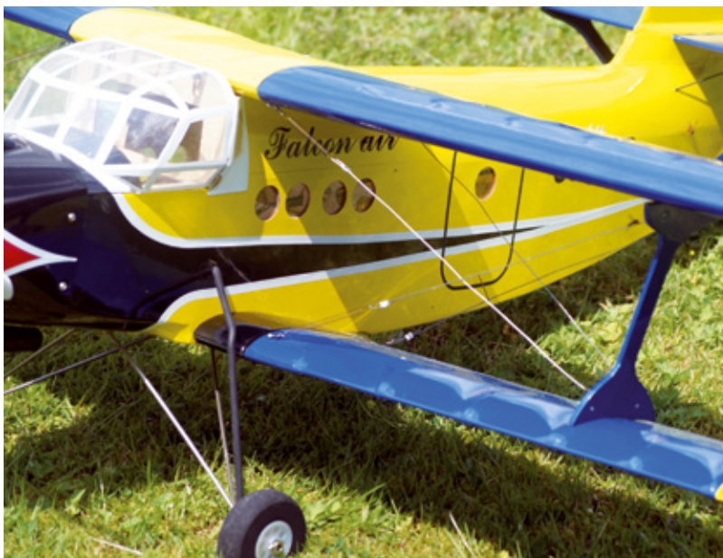
Auch die Verspannung der Tragflächen wurde nicht vergessen
