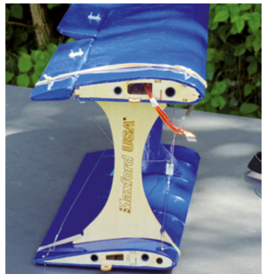
Praktisch ist die Transport-Stütze, die die Flächenpaare untereinander beim Transport stabilisiert
