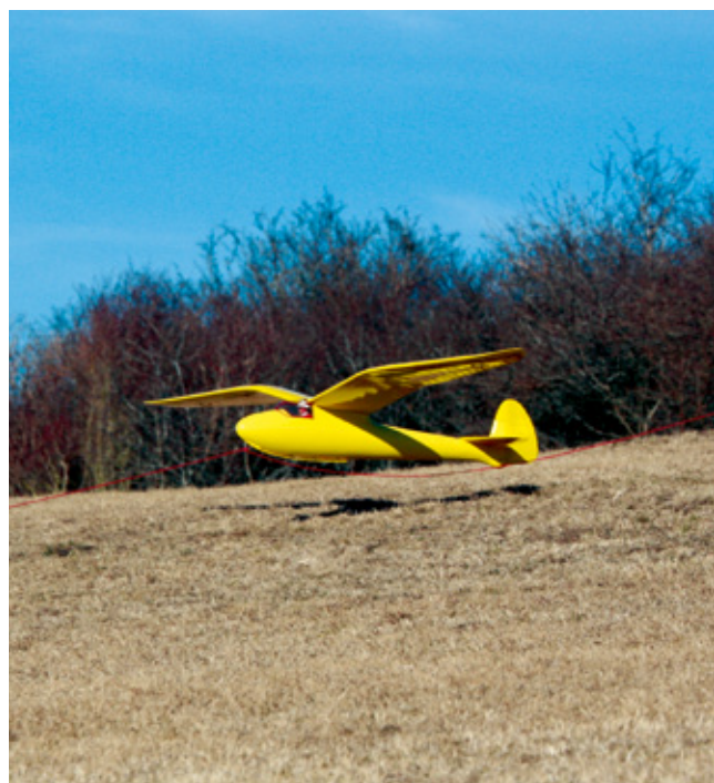
Der Start am Hang ohne kräftigen Starthelfer erfolgt hier mittels Gummiflitsche. Durch den Gummizug wird das Modell sehr schnell beschleunigt und ist dadurch sofort steuerbar
