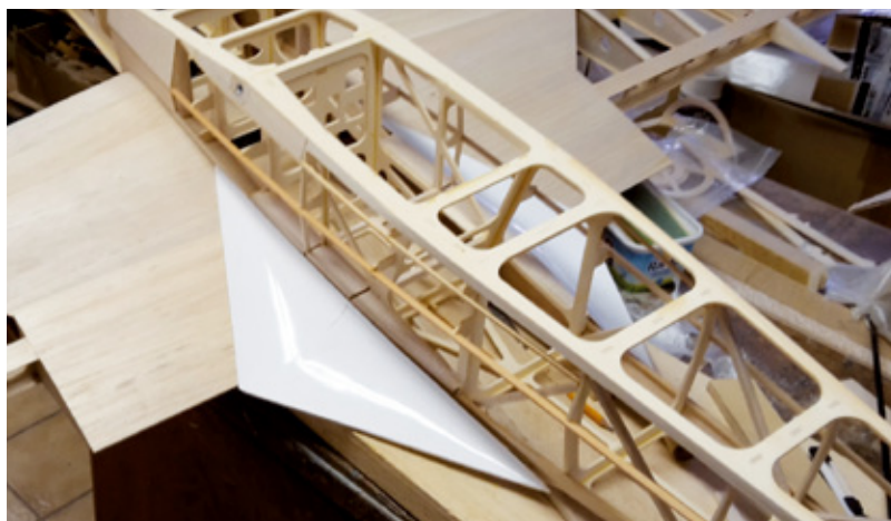
Die Übergänge vom Rumpf zu den Flächen bestehen aus GFK-Formteilen. Die Passgenauigkeit ist erstklassig
