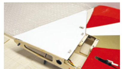
Um die Lage der Zapfen in Rippen und Gurten auf die Beplankung übertragen zu können, ist eine einfache Papierschablone hilfreich
