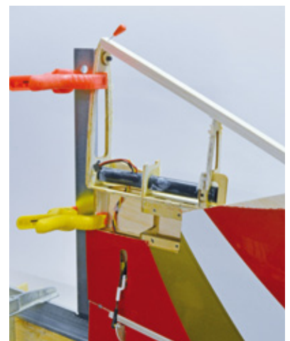
Mit einer Richtschiene wird die Wurzelrippe wieder in Form gebracht
