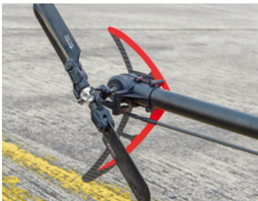
Der neue, komplett gekapselte Heckrotor
