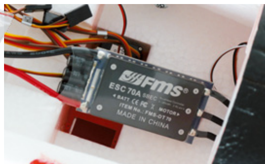
Ein 70-Ampere-Regler speist den Motor mit Energie
