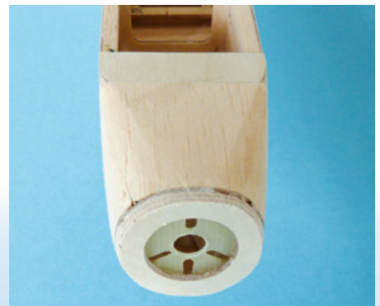
Der Motorträgerbereich fertig verschliffen
