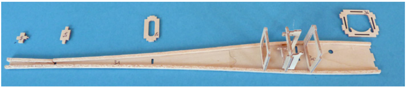
Die Spanten 37 bis 41 werden zuerst eingeklebt, die weiteren Spanten später
