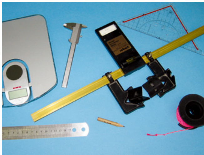
Ein paar Hilfsmittel sind schon notwendig, um das Modell exakt einzustellen
