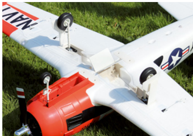
Das Dreibein-Einziehfahrwerk erlaubt auch Starts von kurz gemähten Wiesen
