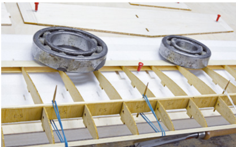
Die Verkastung des Hauptholms ist eingebracht. Die Nasenleiste wird zum Verkleben mit Zahnstochern und Gummis gehalten
