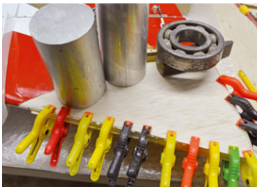
Gewichte und etliche Klammern sorgen für eine feste Verklebung der Beplankung
