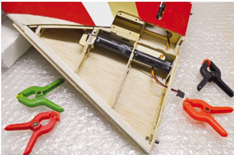
Die obere Beplankung ist bereits wieder aufgebracht
