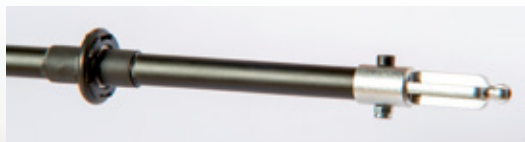
Intelligente Fixierung der Kugellager im Starrantrieb mittels Schrumpfschlauch
