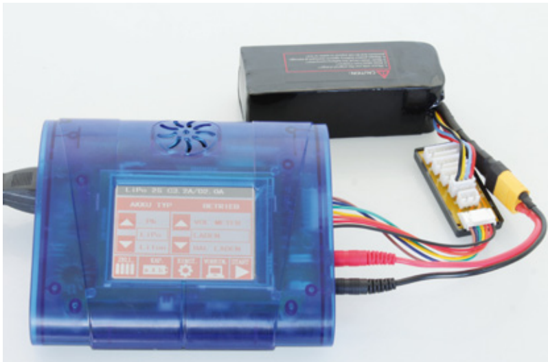
LiPos mit maximal sechs Zellen können mit dem F-100 geladen werden. Das hier abgebildete XT-60-Ladekabel gehört nicht zum Lieferumfang
