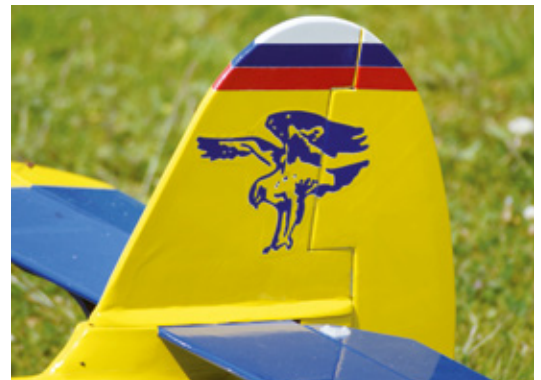
Wie beim Original ist auch beim Modell die Ausgleichsfläche am Seitenruder zu finden
