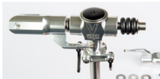
Der neue Hauptrotorkopf im klassischen Aufbau
