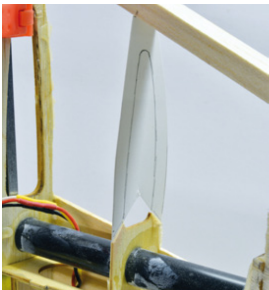
Mit Hilfe einer Papierschablone wird die zerstörte Rippe nachgebaut
