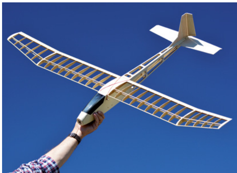
Der Luxx vor dem Aufbringen der Bespannung
