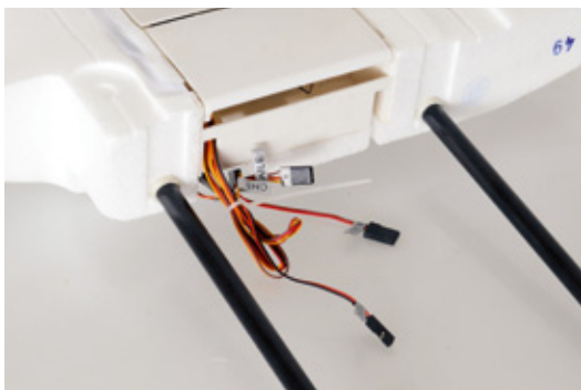
Über zwei CFK-Rohre werden die Tragflächenhälften verbunden
