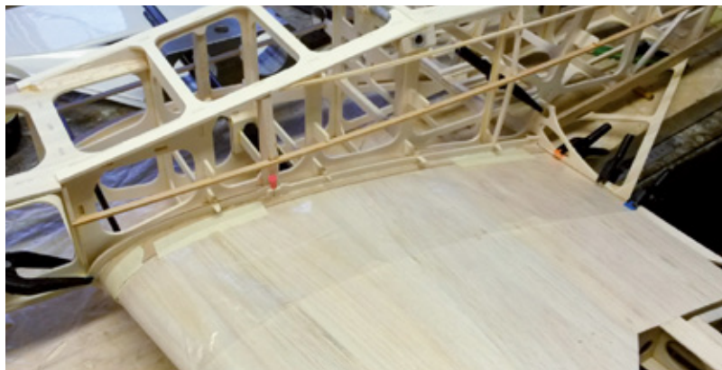
Die Nahtstelle zwischen Tragfläche zum Rumpf wird vorbereitet. Wer hier sauber arbeitet, erhält später einen perfekten Übergang
