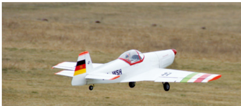
Mit 380 Watt pro Kilogramm Modellgewicht lässt die Motorleistung keine Wünsche offen
