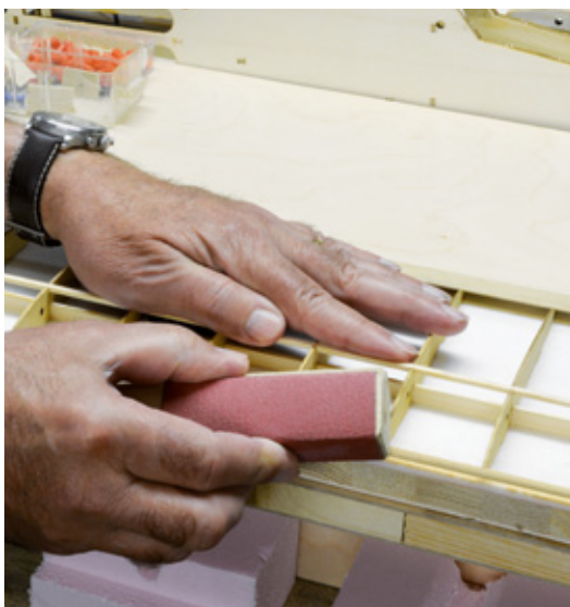
Mit einem Schleifklotz wird die Nasenleiste abgerundet
