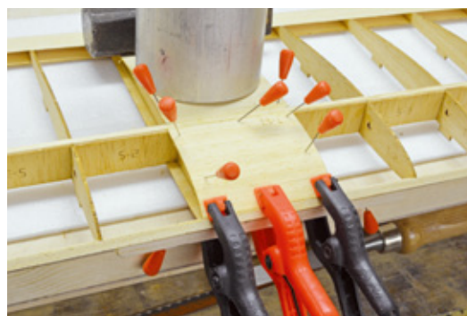
Wie halten Klammern an einer Wölbung? Indem man an der gegenüberliegenden Seite eine Hilfsleiste anbringt
