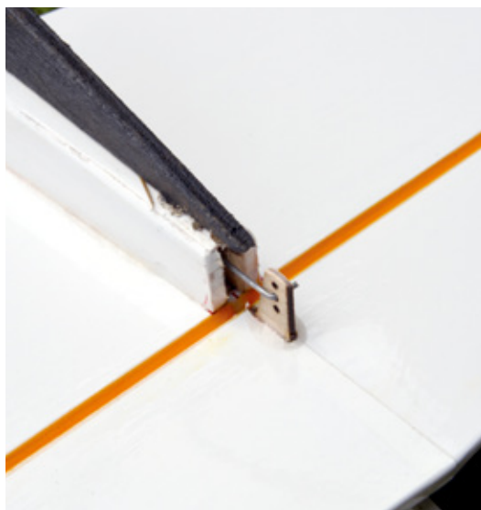
Die einfache aber völlig ausreichende Ruderanlenkung
