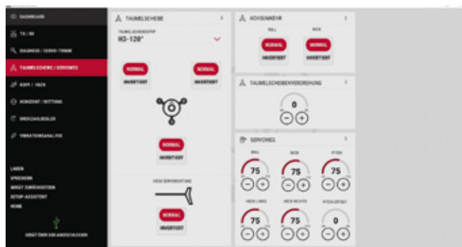
Einstellungen zur Taumelscheibe, Invertierungen und Wegbegrenzung der Servos
