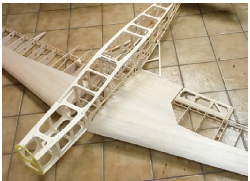
Noch ist der Rumpf nur ein eckiger Kasten. Erst durch den Rumpfrücken wird daraus unverkennbar eine Zlin 526
