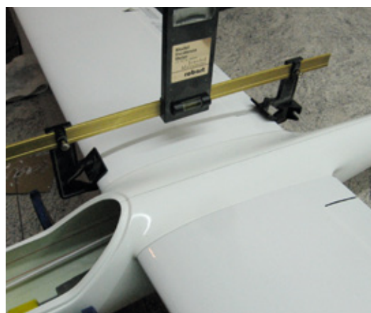
Die Überprüfung der identischen Anstellung beider Tragflächenhälften sollte zum Standardprogramm beim Aufbau eines Modells gehören
