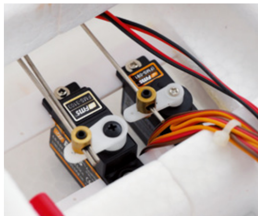
Insgesamt acht solcher 9-Gramm-Servos sind in der Trojan verbaut
