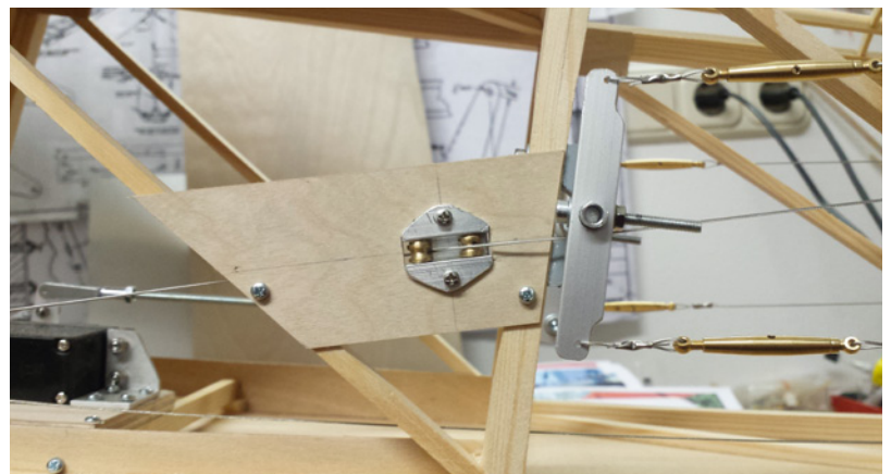
Seitlich aus dem Rumpf treten die Steuerseile für das Leitwerk heraus
