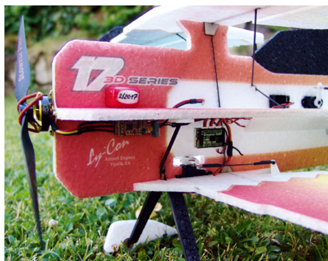
In beiden Indoor-Modellen arbeitet ein 2,5 Gramm Graupner GR12SH+3G Gyro-Empfänger. Ein 6-Ampere-Regler mit BEC ist absolut ausreichend
