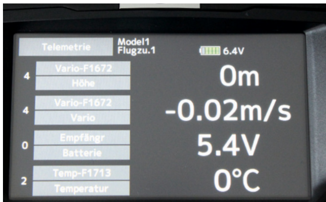
Ist der Sensor über ein Y-Kabel eingelesen, können bis zu vier Telemetriedaten auf dem Display angezeigt werden
