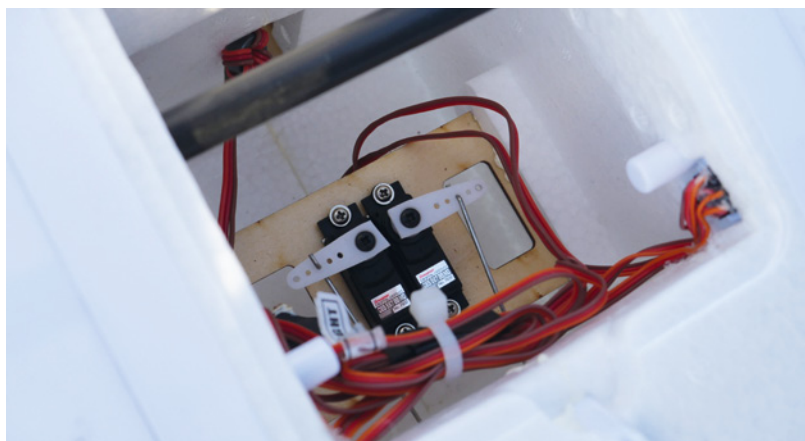
Zwei Graupner DES 587 BB MG-Servos arbeiten am Heck. Die Montage und der Anschluss der Rudergestänge sind schnell erledigt
