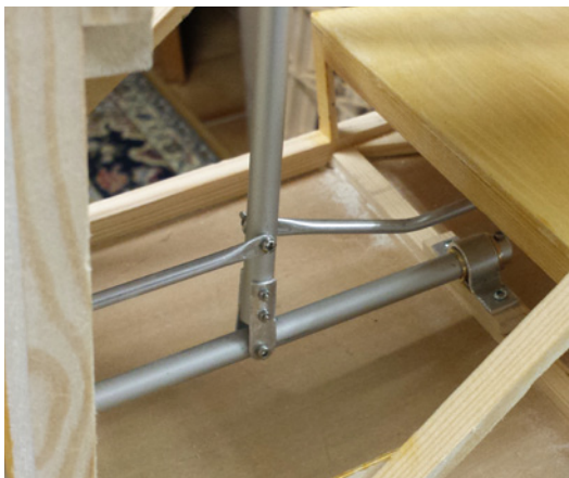
Die Steuerknüppel im Rumpffinneren sind selbstverständlich vorbildgetreu angeschlossen
