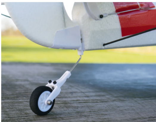
Aufwändig design ist das Spornrad
