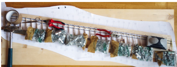
Die Beplankung muss bis zum Aushärten des Klebstoffs flächig beschwert sein
