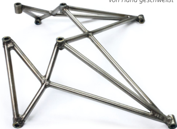
Der Stahl-Motorträger wurde von Hand geschweißt
