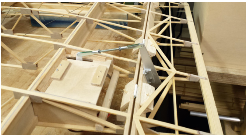
Die Querruder werden über Gewindestangen angelenkt
