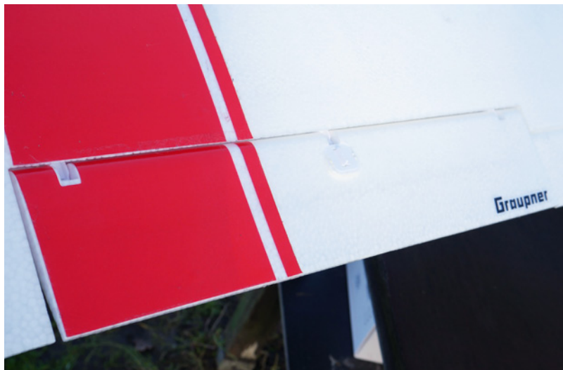
Die Ruderklappen sind alle mit Kunststoffscharnieren angeschlagen, was optimale Leichtgängigkeit garantiert
