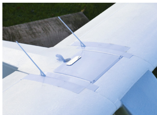
Über die große Kunststoffklappe sind Servos und Empfänger zugänglich. Optional kann die Schleppkupplung genutzt werden
