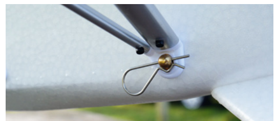
Die Splinte zur Befestigung der Tragflächen-Streben sind leider etwas sehr groß ausgefallen und sitzen recht locker
