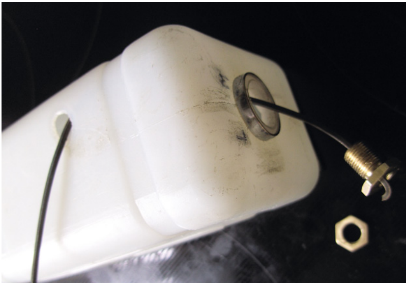
So wird die Schottverschraubung in den Tank eingesetzt
