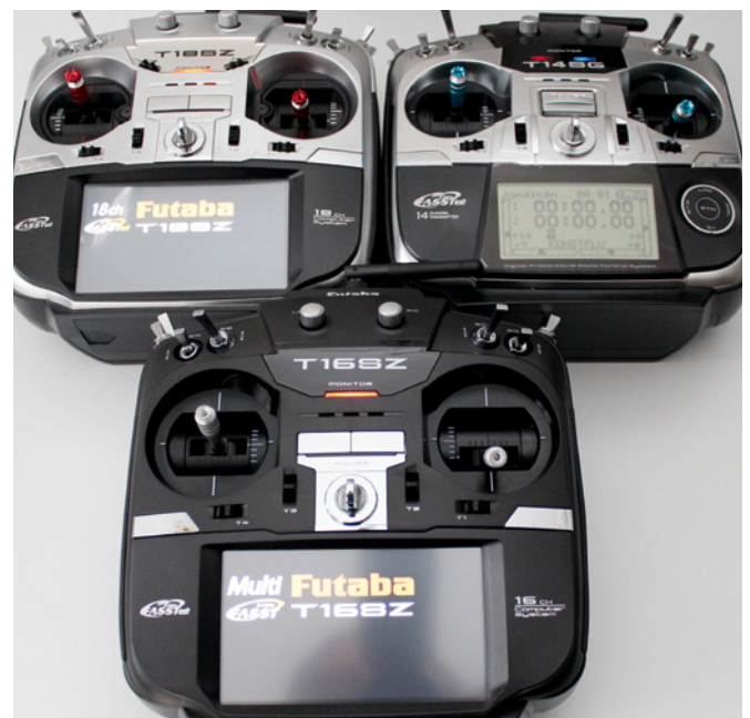
Im Vergleich zur T18SZ (oben links) fehlen der 16er (unten) lediglich zwei Trimmshalter. Die Steuerelemente stammen von der T14SG
