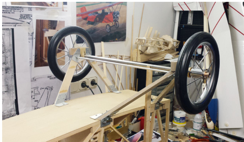
Das gefederte Fahrwerk entstand aus Sperrholz und Aluteilen
