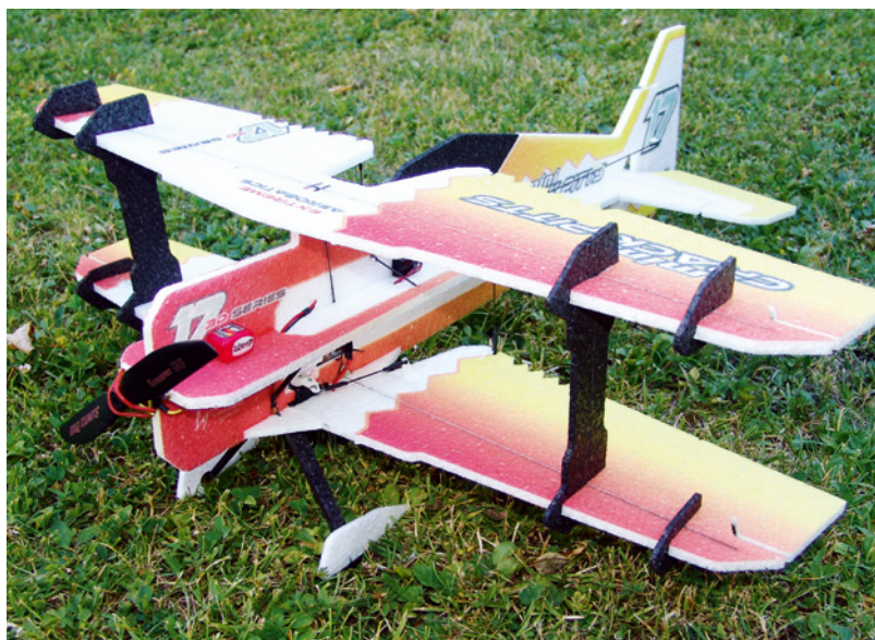
Die Klappen der oberen Tragfläche werden durch Carbon-Stäbe mit den unteren Querrudern gekoppelt
