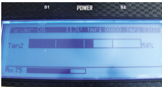
Die Tankanzeige als Telemetriewert im Sender-Display
