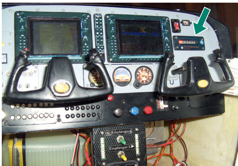
Das Cockpit der Cessna mit Tankanzeige in rot
