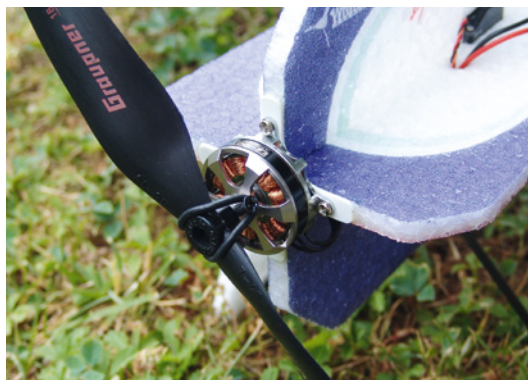
Der T-Motor 2203-Kv1620 ist günstig und besticht durch Top Verarbeitungsqualität. Er steht dem Scorpion in Punkto Leistung nicht nach
