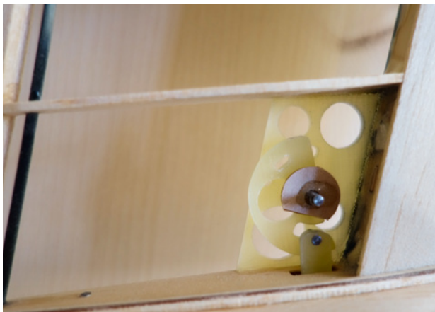
Auch die Winglets sind mit einem Drehverschluss abnehmbar gestaltet
