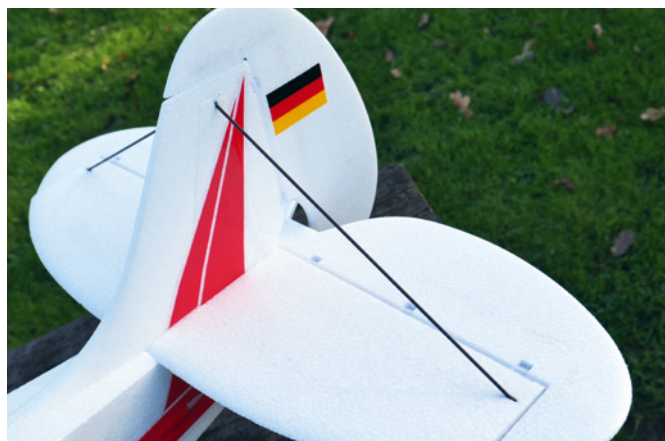
Das Leitwerk ist ruck-zuck verschraubt. Die CFK-Streben werden anschließend mit Sekundenkleber angeklebt
