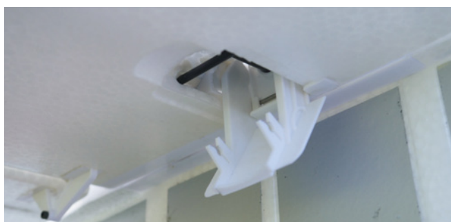
Wirklich sehr clever gemacht ist die Tragflächen-Arretierung: Flügelhälfte aufschieben und einfach auf der Unterseite diese Verriegelung zudrücken – schon hält alles
