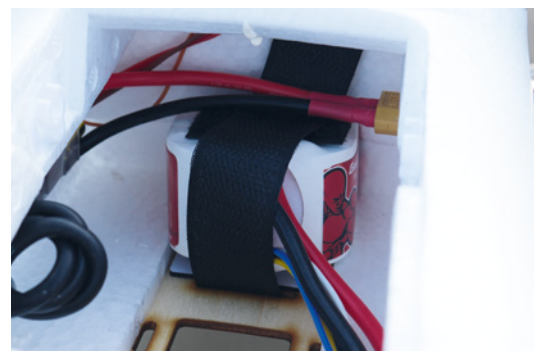
Der Akku wird von vorne in den Rumpf geschoben und mit Klettband fixiert
