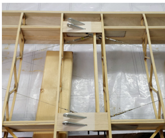
Um die Stabilität und die Vorbildtreue zu erhöhen, befindet sich im Inneren der Tragflächen eine Drahtverspannung
