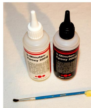
Mit einem verlängerten Pinsel und 5-Minuten-Epoxy, der zuvor etwas angedickt wurde, können die Spanten leicht im Rumpf eingeklebt werden
