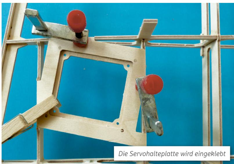
Die Servohalteplatte wird eingeklebt
