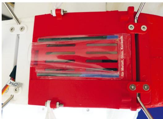
Zwischen den Fahrwerksbeinen sitzt die Klappe mit Zugang zum Akkufach. Im Wasserflugbetrieb wird diese von einer Eigenbau-Abdeckung vor Spritzwasser geschützt (siehe oben)
