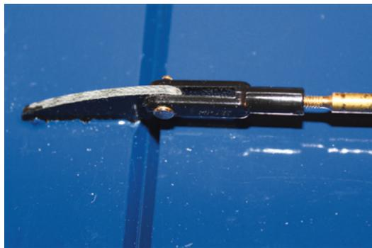
Die Querruderanschlüsse sind schnell hergestellt und das Gestänge mit der Löthülse verlötet. Das führt zu einem robusten Rudergestänge
