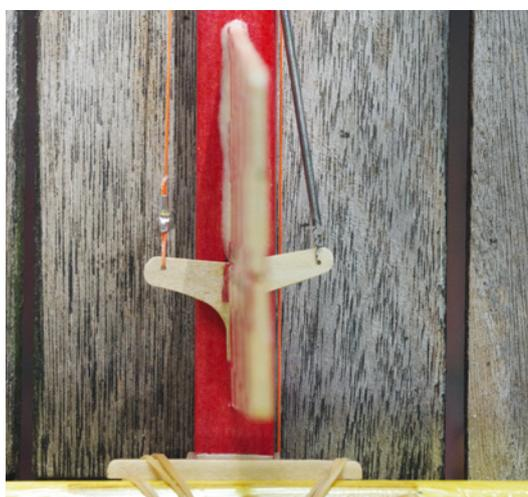
Die Zugfeder stammt aus dem Modelleisenbahn-Zubehör. Die geflochtene Angelschnur wird mit Stücken von Aluröhrchen in der richtigen Länge fixiert
