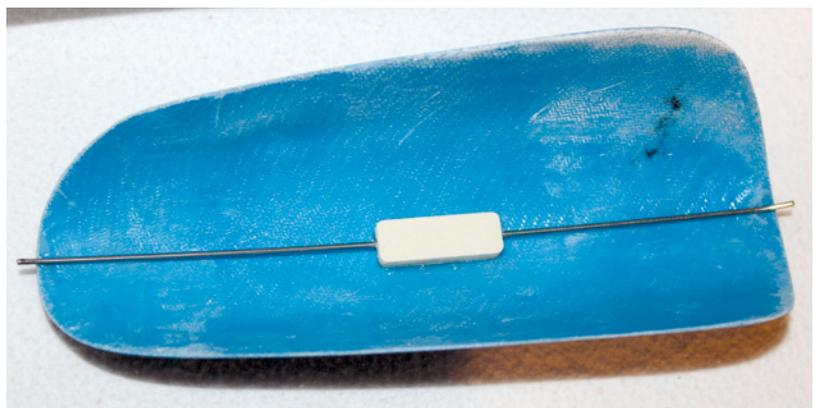
Die Kabinenhaube ist ab Werk schon mit einem guten Haubenverschluss ausgerüstet, der die Haube sicher am Rumpf befestigt
