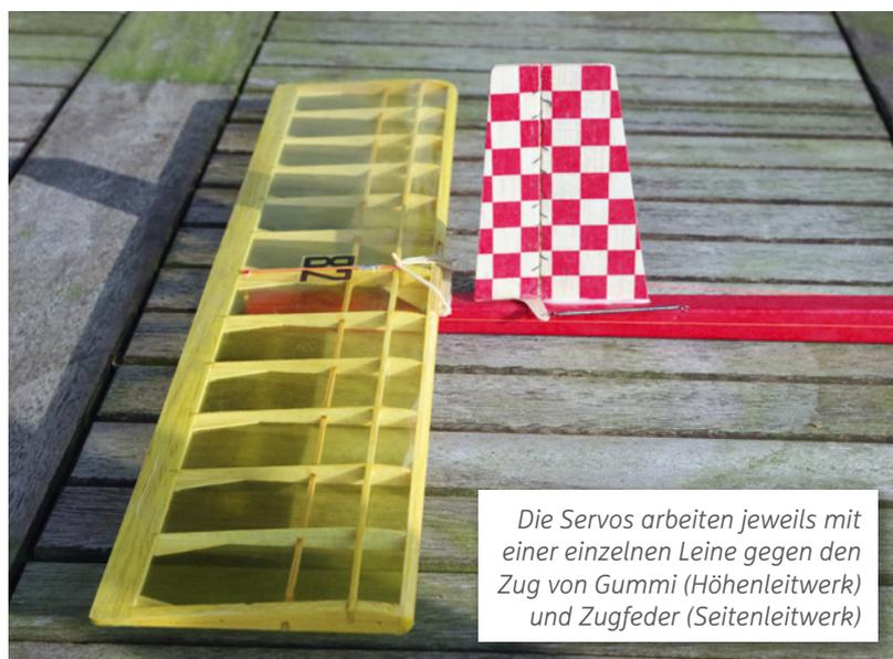
Die Servos arbeiten jeweils mit einer einzelnen Leine gegen den Zug von Gummi (Höhenleitwerk) und Zugfeder (Seitenleitwerk)
