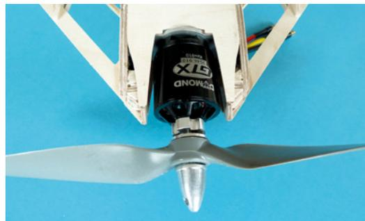
Der Motor wurde probenhalber am Rohbau montiert
