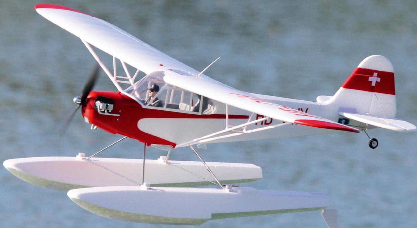
*Idealerweise wird die Wasseroberfläche bei Landungen möglichst flach und mit geringer Sinkrate angeflogen, damit die Schwimmer sanft und möglichst parallel aufsetzen*
