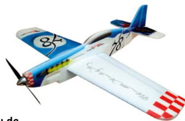
Mit 780 Millimeter Spannweite gesellt sich die **Nemesis** in die Reihe der EPP-Modelle von Pichler. Im Freien als auch in der Halle kann die 720 Millimeter lange und 230 Gramm wiegende Nemesis geflogen werden. Das Combo-Set bestehend aus Modellbausatz, Brushlessmotor, Luftschraube, Regler, drei Servos und LiPo-Akku kostet 149,- Euro, der reine Schnellbausatz 69,- Euro. Geflogen wird sie über drei Achsen, Seiten-, Höhen- und Querruder.
