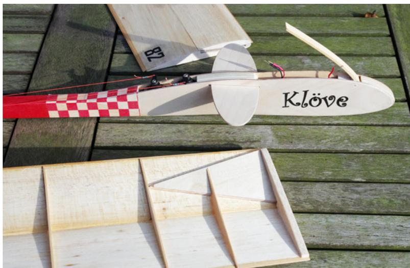
Steckverbindung der Flügel und Klappe für Batterie und Empfänger
