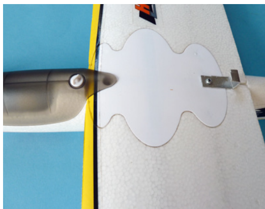
Der Wow...! noch mit Elektromotor in der Nase. Auf der Tragfläche ist die hintere Befestigung bereits angeschraubt
