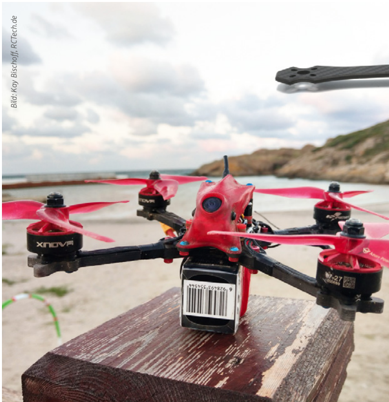
Ein fertig aufgebauter Racer mit einer Haube aus dem 3D-Drucker. Solche Modelle wiegen teilweise unter 500 Gramm abflugfertig, Freestylers bringen häufig 100 bis 150 Gramm mehr auf die Waage
