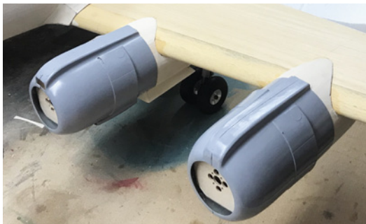
Die Motorgondeln mit den Motorhauben und Übergängen aus Balsaholz
