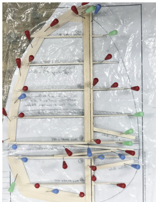
Das Seitenruder ohne Beplankung. Davon mussten je zwei linke und zwei rechte pro Modell angefertigt werden
