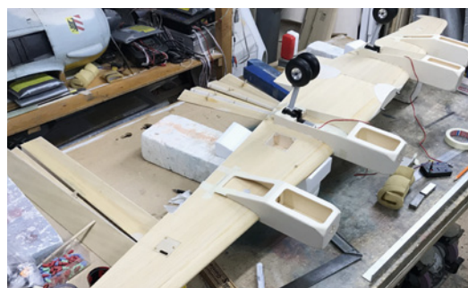
Die Tragfläche ohne Querruder und Landeklappen. Die inneren Motorträger nehmen auch die Hauptfahrwerke auf
