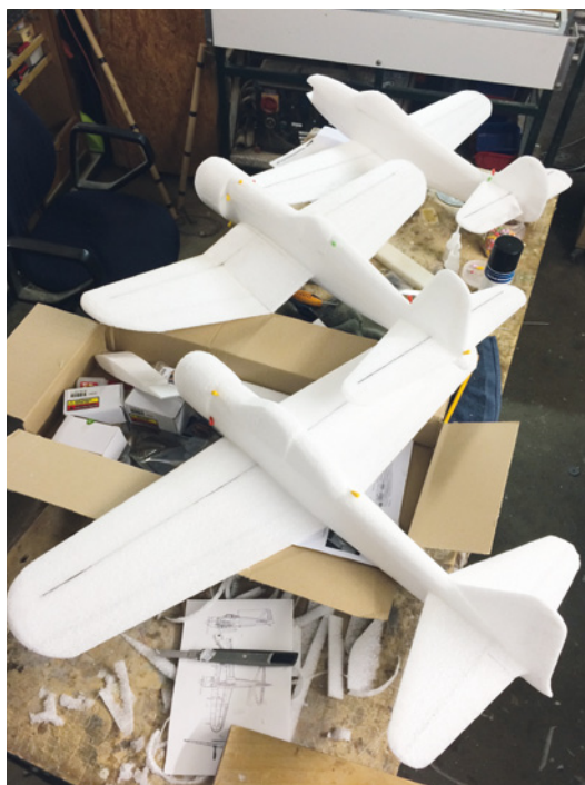
Airacobra, Corsair und Zero im Rohbau
