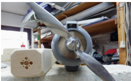
Der Motorträger mit der aufgesteckten Motorhaube, Brushlessmotor, Luftschraube und Spinner. Damit die Motorhaube sauber über die Motorträger geht, mussten die Ecken im vorderen Bereich abgerundet werden
