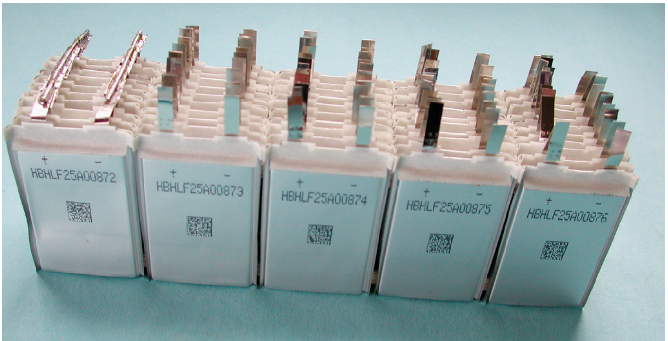
Belastbare LiPos waren anfangs kaum erhältlich. Es waren zahlreiche Parallelschaltungen nötig
