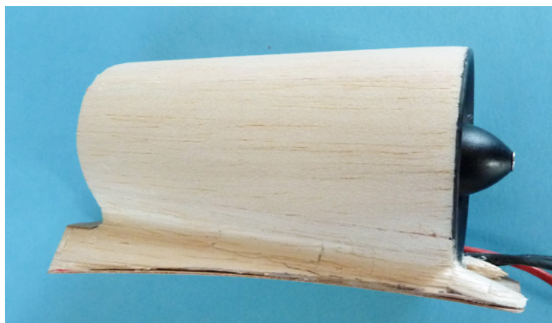
Das fertig verkleidete Aufsatz-Triebwerk, bereit zum Bespannen
