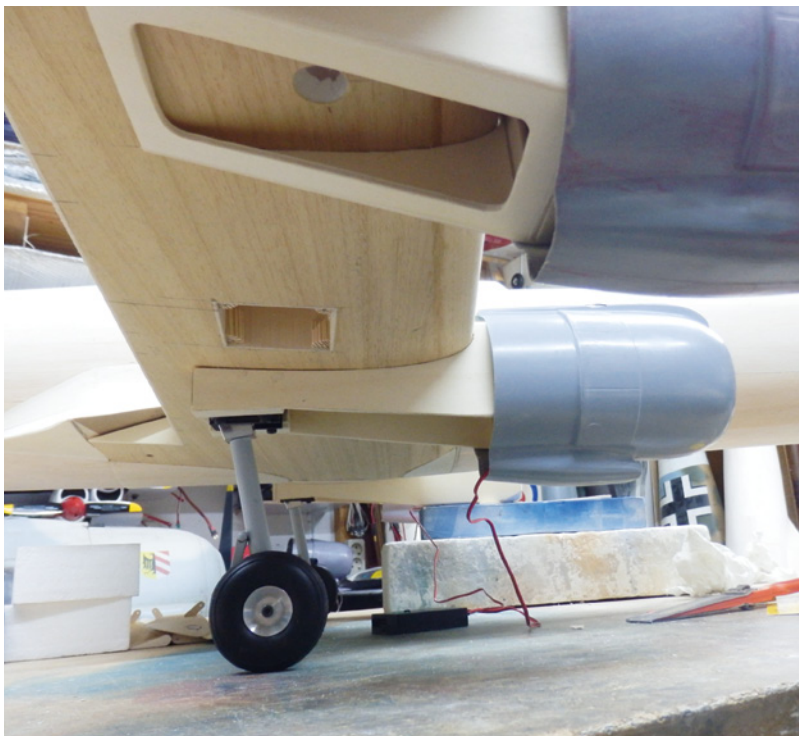
Das Hauptfahrwerk fährt nur bis zu einem Winkel von rund 80 Grad aus. Dadurch stehen die Fahrwerksbeine wie beim Original leicht nach vorne
