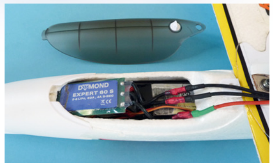
Unter der Haube wird es ganz schön eng, gerade bei Verwendung des 4s-LiPo-Akkus
