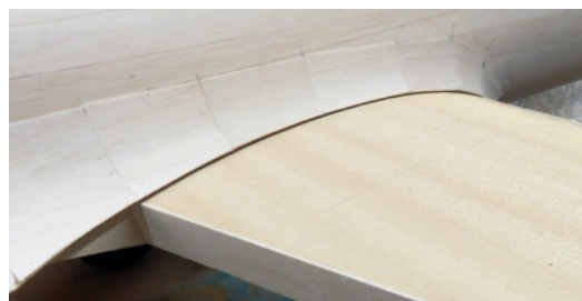
Ein fertiger Tragflächen-Übergang. Die 1,5-Millimeter-Bepunktung ist im Rohbau sehr druckempfindlich, nach dem Bespannen mit Bügelfolie entschärfte sich dieses Problem
