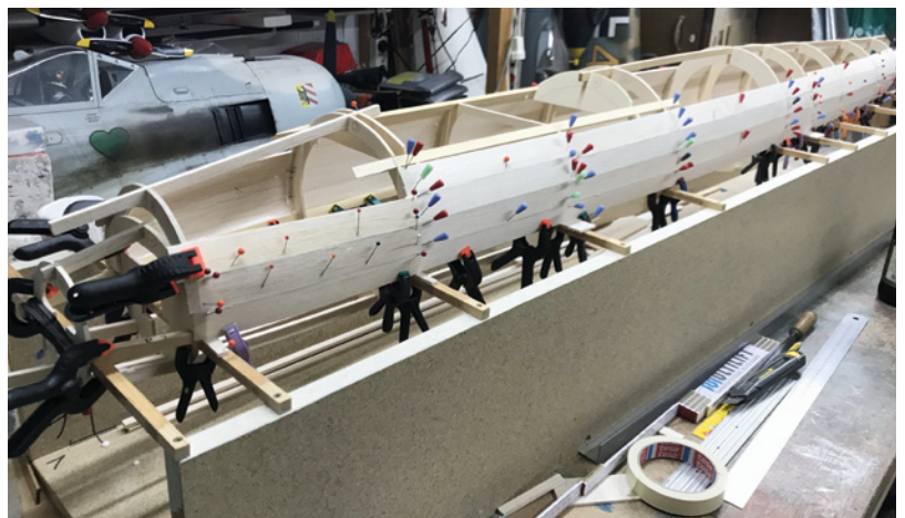
Der erste Rumpf ist in der Helling und ein Teil der Rumpfbepunktung wurde ausgeführt
