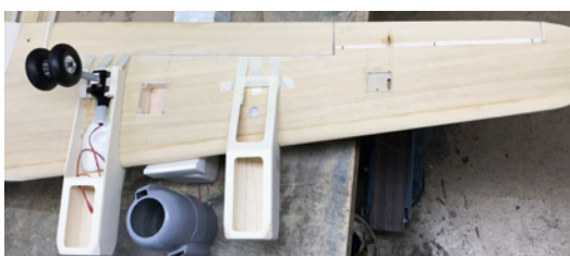
Tragflächenhälfte mit den eingesetzten Rudern und Servoschächten
