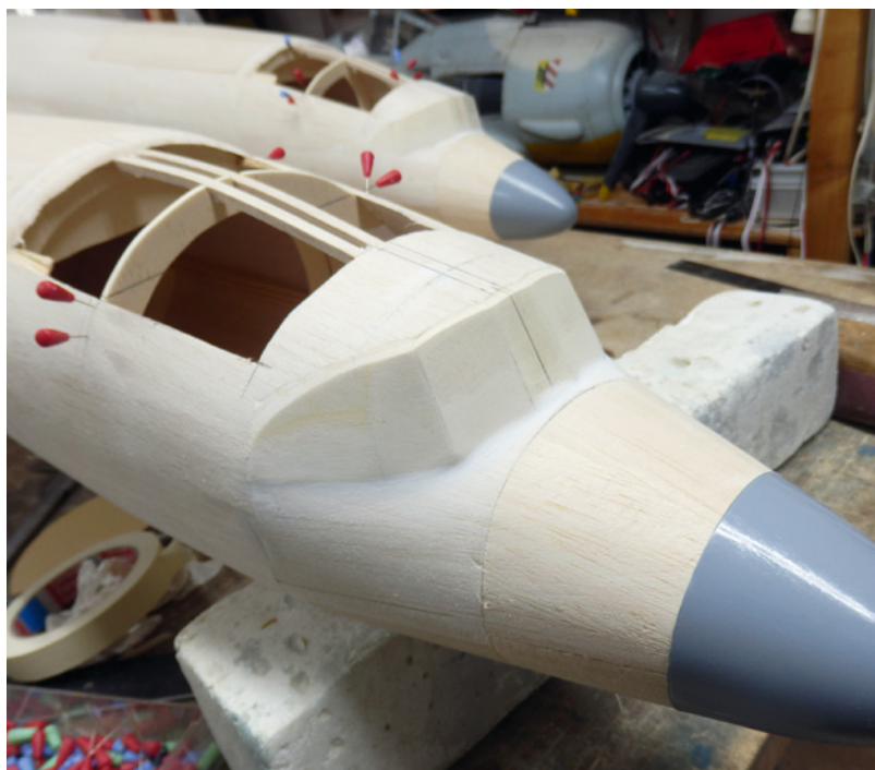
Das fertige Cockpit mit Rumpfspitze. Der obere Rumpfbereich wurde aufgeschnitten und der Zwischenspannt eingesetzt
