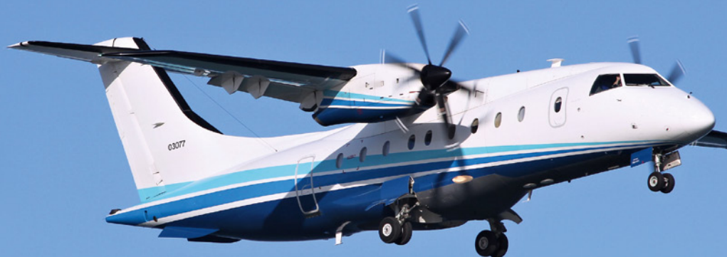
Bild 3: Die DO 328, eine Maschine mit 30+2 Sitzplätzen. Dieses Passagiervolumen ist für die Betrachtungen des elektrischen Linienflugs mit der e-BigTop beziehungsweise MaxTop vorgesehen. Sie erreicht bei einem Gewicht von 13.990 Kilogramm eine Flugweite von 1.310 Kilometern
