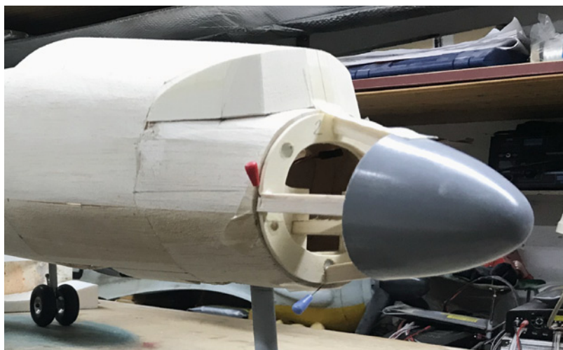
Die Rumpfspitze mit der geraden Oberseite und der noch nicht fertigen Rumpfspitze. Diese sollte zur Wartung des Bugfahrwerksmechanik abnehmbar sein und wird mit Zentrierstiften und Doppelmagneten gehalten
