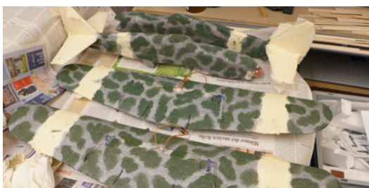
Eine Ki-61 während des Lackierens. Was hell bleiben soll, wird zuvor abgeklebt
