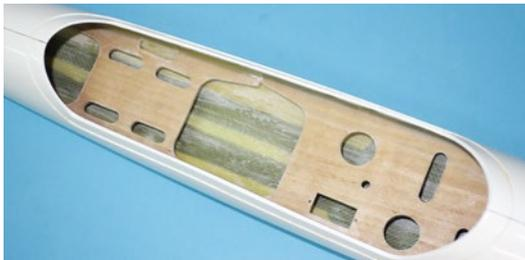
Die Sperrholzspanten werden zuerst mit Sekundenkleber im Rumpf fixiert und dann mit Langzeitharz und Gewebe satt mit den Rumpfsseitenwänden verklebt
