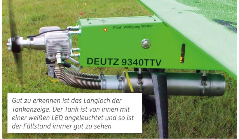
Gut zu erkennen ist das Langloch der Tankanzeige. Der Tank ist von innen mit einer weißen LED angeleuchtet und so ist der Füllstand immer gut zu sehen
