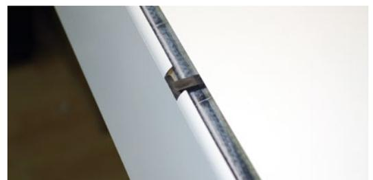
*Um die Ruderhebel einzubauen, muss die Dichtlippe unterbrochen werden. Hier ist auch bereits die Anlenkung zum Servo hin montiert*
