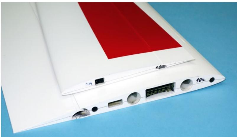
*In den Wurzelrippen sind die Steckungen fertig eingearbeitet. Sehr gut sichtbar sind auch die beiden Ballastrohre vor und hinter der Tragflächensteckung*
