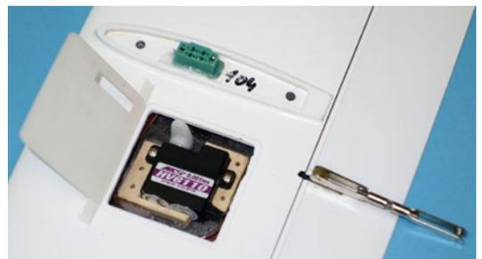
Ein hochwertiges 10-Millimeter-Servo von MKS übernimmt die Ansteuerung des Höhenruders. Der Stecker wurde direkt in das Leitwerk eingeklebt, sodass die elektrische Verbindung automatisch beim Aufsetzen des Leitwerks erfolgt
