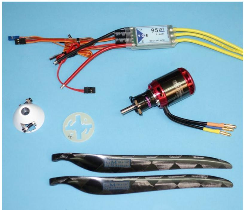
Der Antrieb besteht aus einem Außenläufer mit Getriebe, dem YGE-Regler mit einem kräftigen BEC, sowie einem RFM-Spezialspinner mit GM-CFK-Luftschraube
