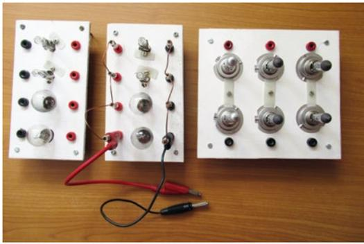
Bild 10: Durch unterschiedliche Kombinationen verschiedener Lampen können beliebige Lastwiderstände erzeugt werden
