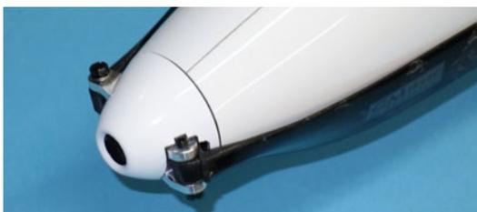
Der RFM-Spinner passt sehr gut zur Rumpfkontur und die GM-Luftschraube liegt perfekt am Rumpf an
