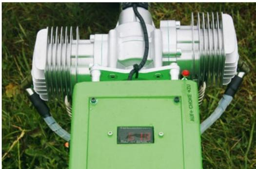
Unter der Abdeckplatte, hinter dem Motor, sind Zündung, Gasservo und Empfängerakku untergebracht
