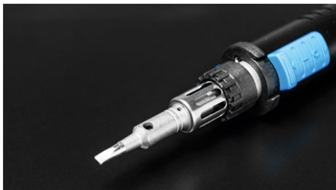
Um die Spitze zu wechseln, wird die schwarze Überwurfmutter gelöst, die gewünschte Spitze in den Haltekäfig gesetzt und alles zusammen wieder verschraubt
