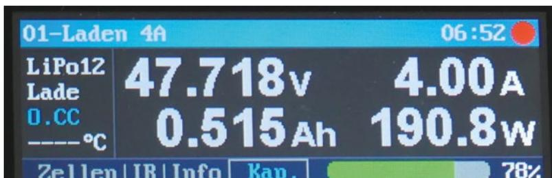
Im oberen Bereich des Displays signalisiert der iCharger in großen Ziffern gut sichtbar die Gesamtspannung, den Ladestrom, die eingeladene Kapazität und die Ladeleistung
