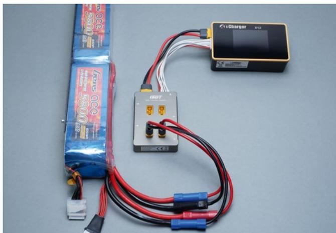
Bei der Parallelschaltung von Akkus verdoppelt sich die Kapazität – in diesem Fall von 5.000 auf 10.000 Milliamperestunden
