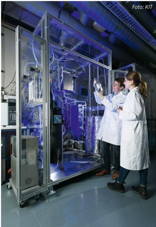
Bild 3: Herstellung von Treibstoff nach der Fischer-Tropsch-Synthese im Karlsruher Institut für Technologie KIT
