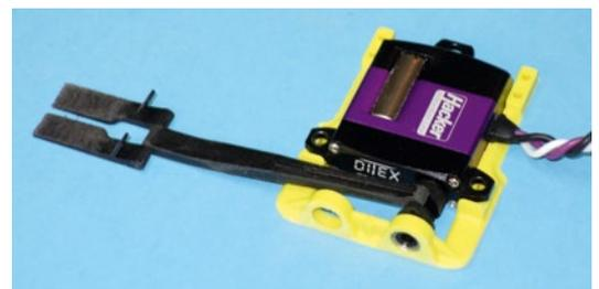
*Bei den Querrudern und Wölbklappen kommen IDS-Anlenkungen von Servorahmen.de zum Einsatz. Die Ruder werden von Ditex-Servos von Hacker angetrieben*
