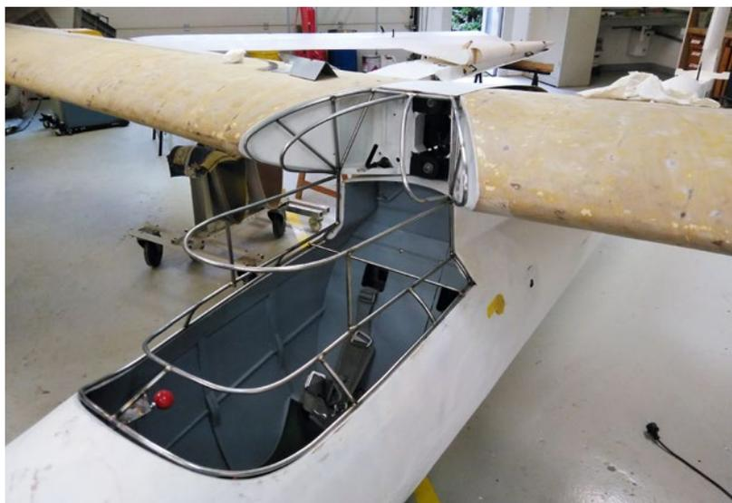
Mit einer alten Kabinenhaube als Vorbild entstand zunächst ein passendes Grundgerüst aus 10-Millimeter-Edelstahlrohr. Die Einzelteile des Gerüsts wurden dann direkt am Flugzeug hartverlötet
