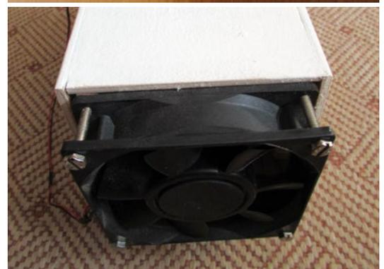
Bild 8/9: In diesem LiPo-Schacht werden die Akkus während des Test zur Kühlung künstlichem „Fahrtwind“ ausgesetzt
