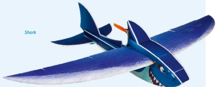
Die 1.000 Millimeter spannende **Shark** von arkai fällt durch das Hai-Design auf. Das aus EPP gefertigte Modell kostet als Kit 55,90 Euro, als PNP-Version 89,90 Euro. Beide Varianten sind mit einem 6 x 4-Zoll-Propeller ausgestattet. Als Akku wird ein 2s-LiPo mit einer Kapazität von 1.500 Milliamperestunden empfohlen.
