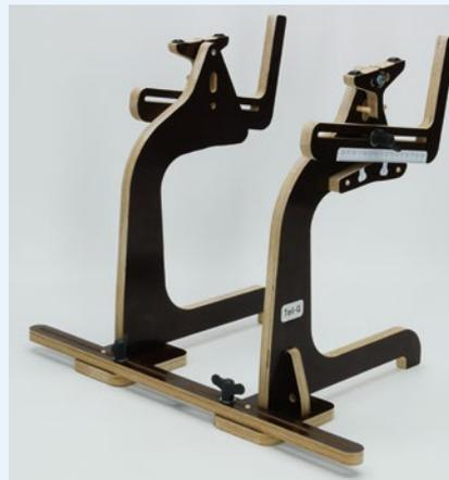
Die **Teil-Q-Schwerpunktwaage** beim Himmlischen Höllein gibt es jetzt auch in Größe L. Damit soll es jetzt möglich sein, auch Motormodelle mit Fahrwerk und Flächenstreben auszuwiegen. Und zwar, in dem der Anschlag um 180 Grad gedreht wird. Mit einem zweiten Zeiger kann der genaue Schwerpunkt im Anschluss eingestellt werden. Der Preis: 75,- Euro
