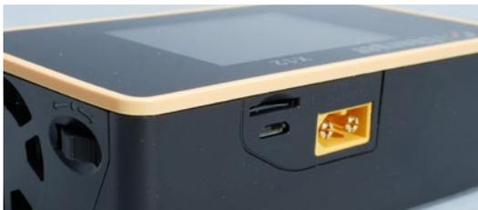
Auf der Oberseite des Geräts befinden sich der XT60-Stecker für die Eingangsspannung sowie ein Micro-SD-Karten-Slot und ein Mini-USB-Anschluss
