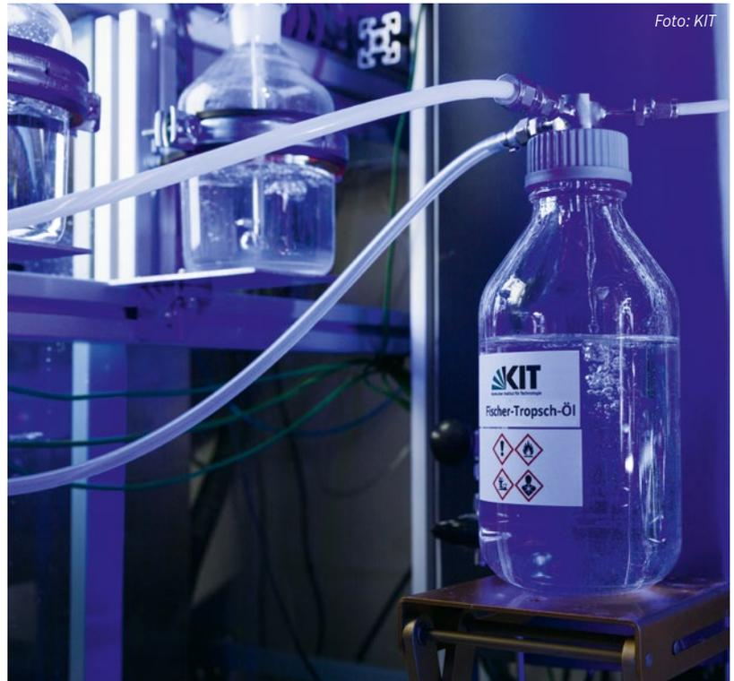
Bild 4: Treibstoff aus CO<sub>2</sub> und Wasser. Das Fischer-Tropsch-Öl stellt eine Mischung verschiedener Kohlenwasserstoffketten dar. Durch Cracking und Destillation kann man daraus DIN-gerechten Treibstoff herstellen
