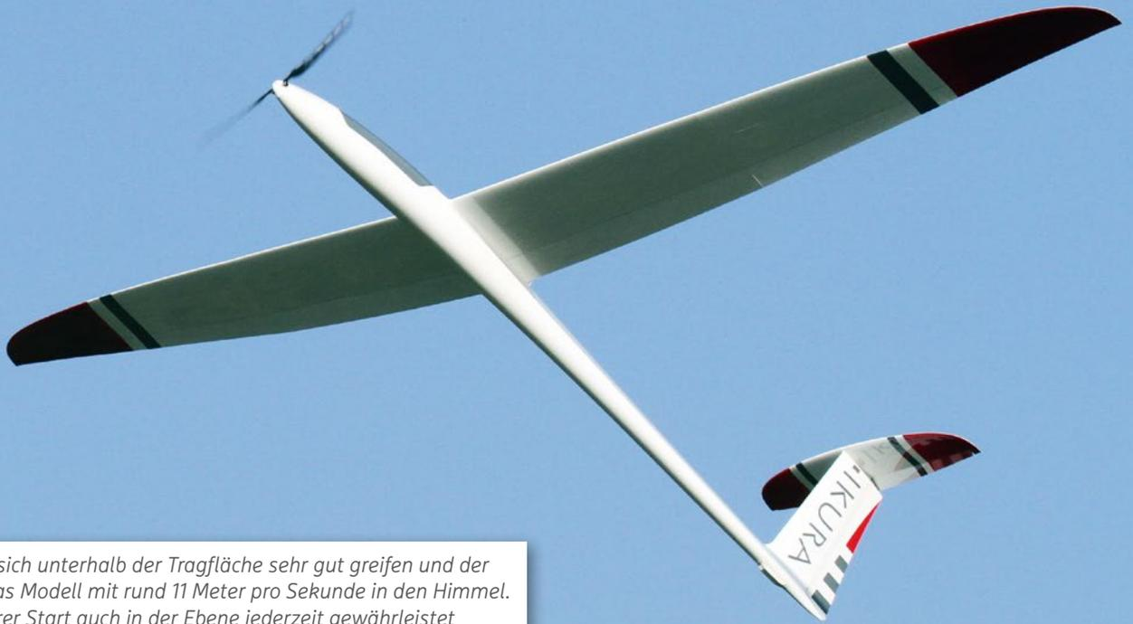
Die Ikura lässt sich unterhalb der Tragfläche sehr gut greifen und der Antrieb zieht das Modell mit rund 11 Meter pro Sekunde in den Himmel. So ist ein sicherer Start auch in der Ebene jederzeit gewährleistet
