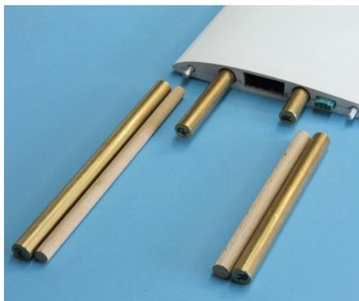
Durch die Ballastiermöglichkeit können bis zu 1.800 Gramm zugeladen werden. Die Flächenbelastung kann damit von 56 bis 80 Gramm pro Quadratdezimeter variiert werden
