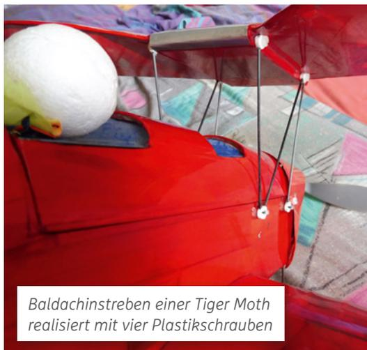
Baldachinstreben einer Tiger Moth realisiert mit vier Plastikschrauben
