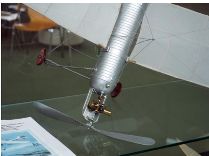
*Hier dient der Rumpf als Drucktank, der den Dreizylinder-Pressluftmotor mit seinem „Treibstoff“ versorgt*
