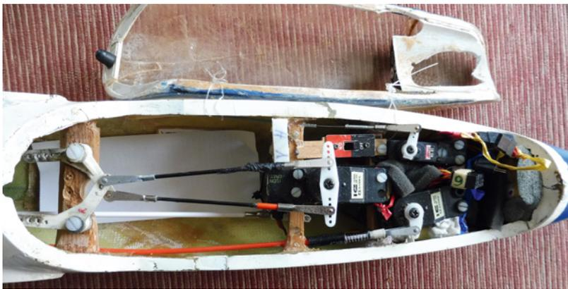
Hier dienen Kunststoffschrauben als Drehachsen für die Umlenkhebel des Querruderservos
