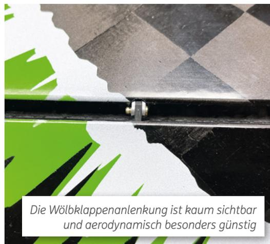
Die Wölbklappenanlenkung ist kaum sichtbar und aerodynamisch besonders günstig
