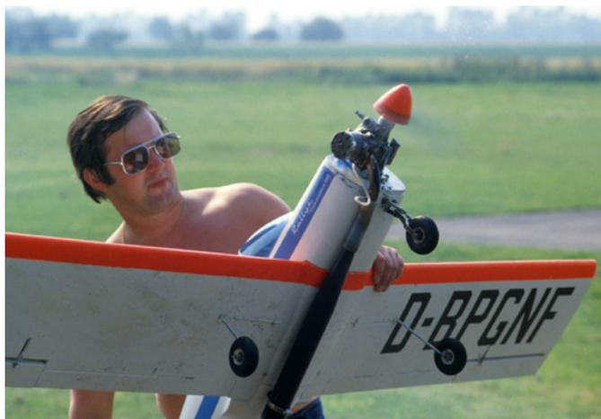
*Lange Resonanz-Rohre an Methanol-Motoren waren für Flugmodelle mit viel Leistung unerlässlich*
