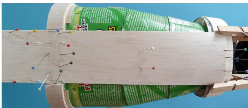
Beim Beplanken der Luftführung wird gleichzeitig der Rumpfboden mitgebaut
