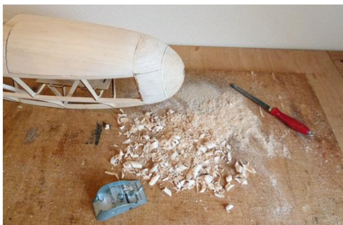
Bis die Nase schön rund ist, muss einiges an Material weggehobelt und -geschliffen werden
