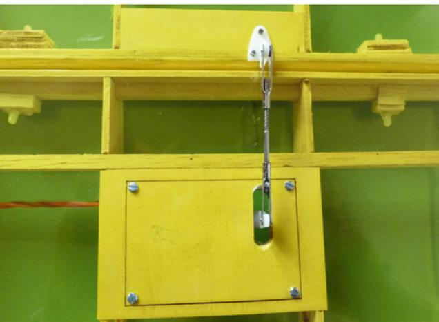
Die Anlenkung der Querruder erfolgt mit einer kleinen Schubstange, auf der ein verstellbarer Gabelkopf sitzt
