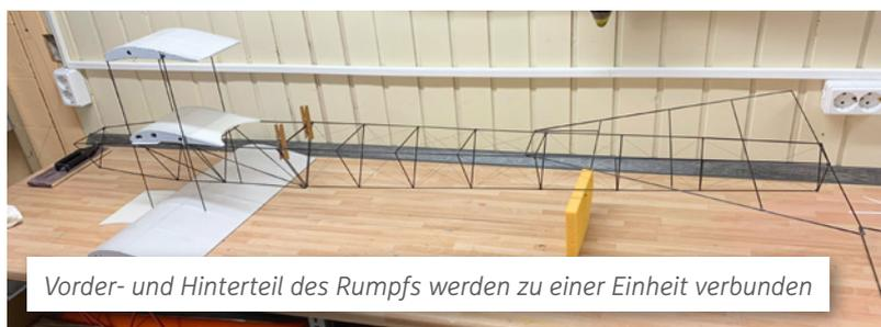
Vorder- und Hinterteil des Rumpfs werden zu einer Einheit verbunden
