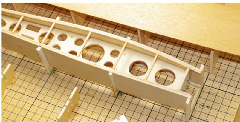
Die kleinen Querträger sind montiert, die Oberseiten-Beplankung wartet schon
