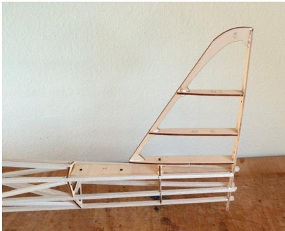
Das Seitenleitwerk wurde ausgerichtet und ist bereit zum Verleimen
