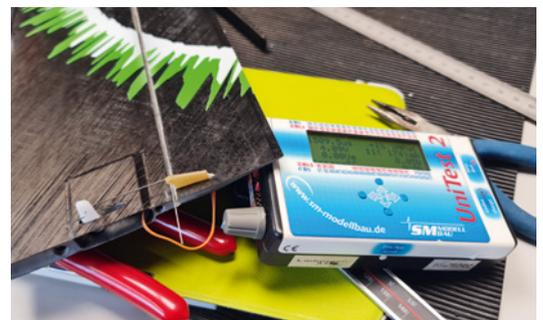
Per Servo-Tester wurden die Ruder genau justiert, danach konnten die Anlenkungen finalisiert werden
