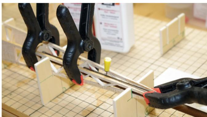
Der Leitwerksträger, ein konisches GFK-Rohr, wird mit Epoxi in die Bohrungen zweier Spanten geklebt
