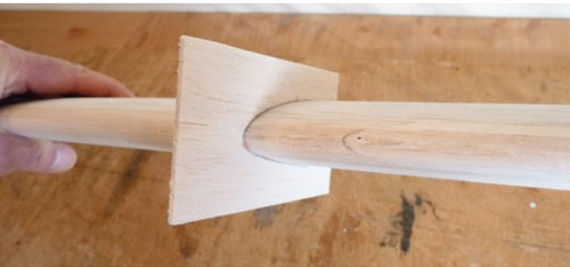
Eine selbst angefertigte Schablone leistet gute Dienste beim Verschleifen der Nasenleiste
