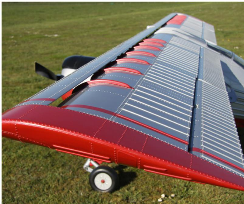
Damit die Nieten und andere Details nicht unter Lackschichten verschwinden, werden die Modelle in der Form lackiert
