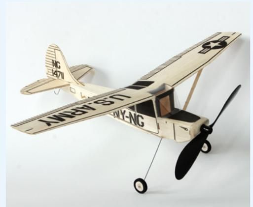
Der **Puri XL** ist ein Holzbausatz konstruiert von Tim Weißbach. Der VTH veröffentlicht mit diesem Modell eine neue Variante des kleinen Vorbilds. Deutlich größer ist der Puri XL auch ruhiger in der Luft als das Vorgängermodell. Er spannt 1.300 Millimeter, hat eine Länge von 520 Millimeter und je nach Version ein Fluggewicht von 500 bis 650 Gramm. Er kostet 134,95 Euro.
