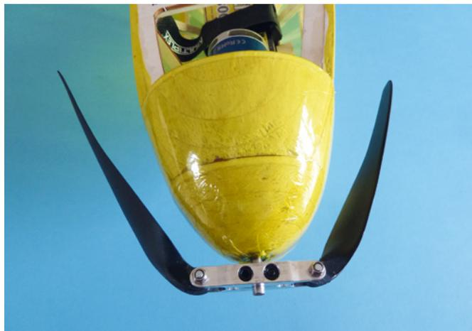
*Die Klappflugschraube wird an der vorne überstehenden, langen Motorwelle befestigt*
