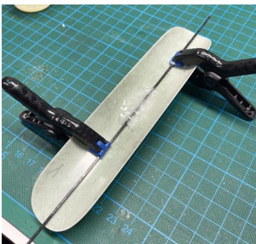
Mit angedicktem Harz ist die Befestigung der Kabinenhaube verklebt
