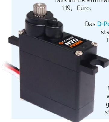
Das **D-Power HVS-140BB MG** ist ein leistungsstarkes HV-Micro-Servo mit 9 Millimeter Dicke. Es verfügt über eine Stellkraft von 4 Kilogramm bei 6 Volt, bei 8,4 Volt von 4,8 Kilogramm. Die Stellgeschwindigkeit beträgt dabei jeweils 0,12 Sekunden oder 0,10 Sekunden auf 60 Grad. Das 23 x 9 x 23 Millimeter messende und 8,5 Gramm wiegende Servo verfügt über ein Metallgetriebe sowie ein staubdichtes Kunststoffgehäuse. Der Preis: 24,90 Euro.
