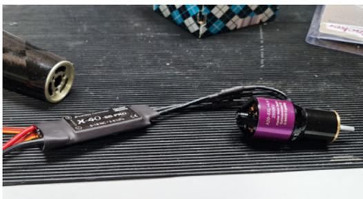
Ein Hacker-Außenläufermotor mit Getriebe sorgt für den Vortrieb des Modells
