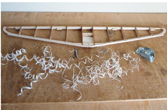
*Die Nasenleiste des Höhenleitwerks wird mit dem kleinen Balsahobel in Form gebracht*
