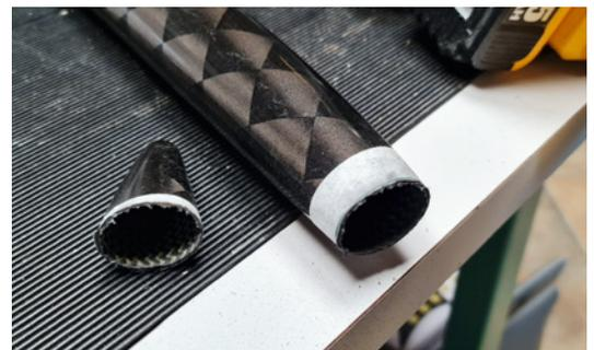
Für den Einbau des Motorspants musste die Nase abgesägt werden
