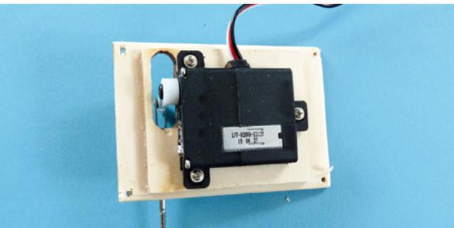
Das Querruder-Servo passt saugend in den Rahmen und wird mit drei Schrauben befestigt
