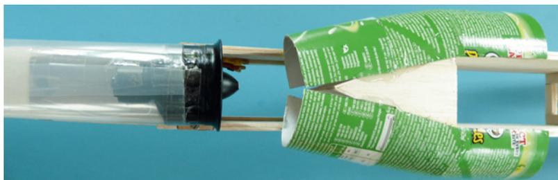
Die Luftführung ist weitgehend fertiggestellt, das Triebwerk wurde angeschraubt
