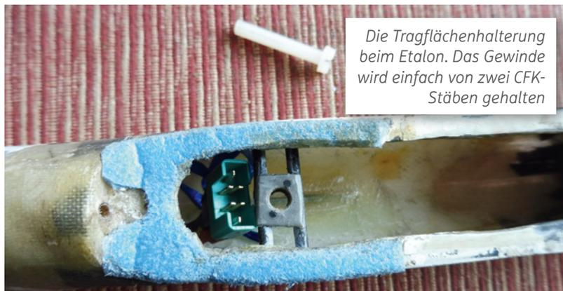
Die Tragflächenhalterung beim Etalon. Das Gewinde wird einfach von zwei CFK-Stäben gehalten
