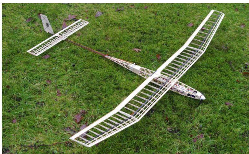
„Lightning“ heißt der neue E-Segler. Rohbaugewicht mitsamt Technik und Akku 125 Gramm bei 1.200 Millimeter Spannweite
