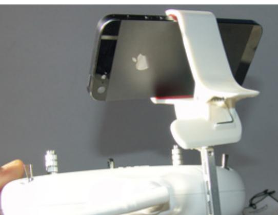
Das Smartphone wird in einer schwenkbaren Halterung am Sender fixiert
