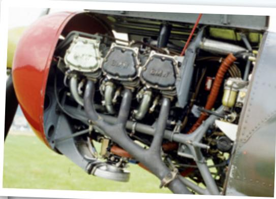
Unter der geöffneten Cowling-Klappe zeigt sich der Lycoming GO-480-B1 A6 mit 274 PS Leistung, ein luftgekühlter Boxermotor mit sechs Zylindern (Foto: Gerhard Lang)
