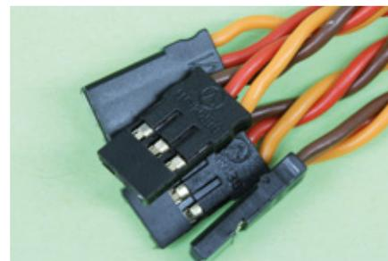
*Auf der Empfängerseite kommen hochwertige Goldkontakte und Kunststoffgehäuse zum Einsatz. Die Servokabel werden angecrimpt*
