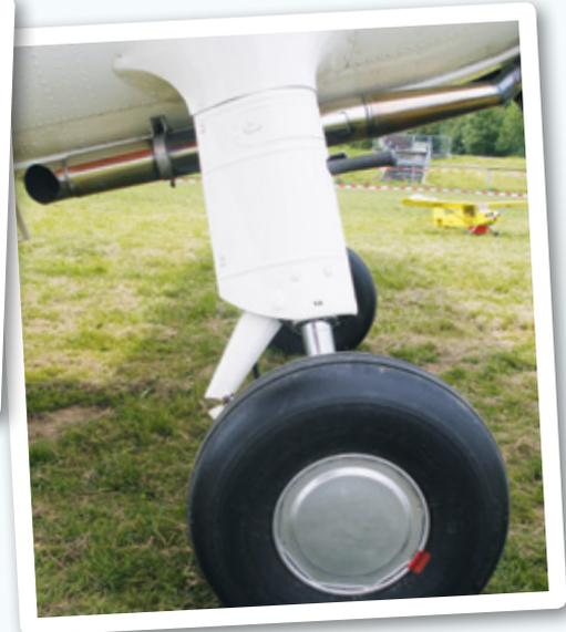
*Das feste Fahrwerk der Do 27 mit den großen Schalldämpfer-Rohren unter dem Rumpf, auch „Frankfurter Topf“ genannt*
