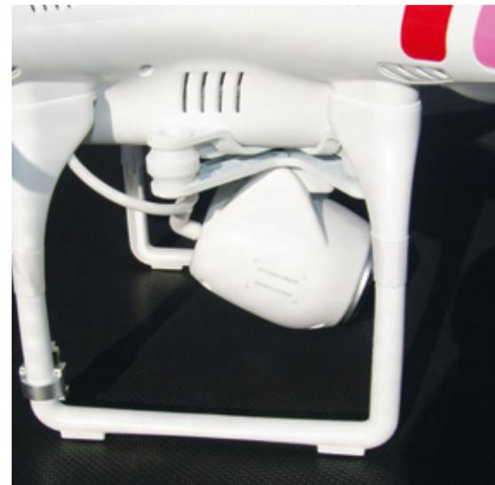
Deutlich zu erkennen die gedämpfte Aufhängung der Kamera. Die Neigung (Tilt) übernimmt ein versteckt eingebauter Motor
