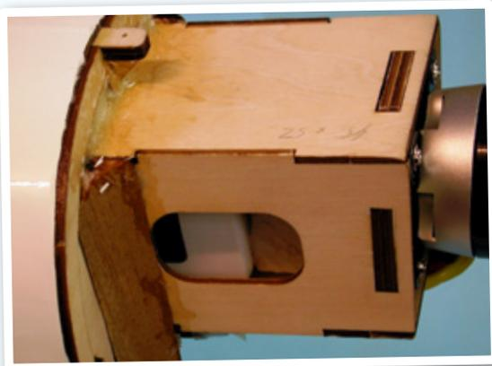
*Nach dem Umbau kann der Akku bis in den Motorraum nach vorne geschoben werden. Weil innen Material entfernt wurde, kamen außen einige Verstärkungselemente dazu.*
