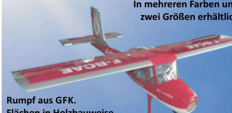
Rumpf aus GFK. Flächen in Holzbauweise, mit Oracover bespannt. mit Schleppkupplung (CNC)
