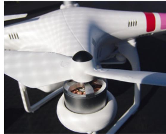
*Beim Phantom 2 Vision kommen größere Luftschrauben zum Einsatz, die selbstanziehend sind. Schwarze Spinnerkappen haben Linksgewinde*
