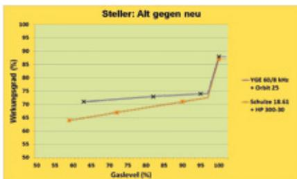
Bild 11: Zu seiner Zeit galt der Steller 18.61 von Schulze als sehr gut. Heutige Steller weisen aber bei mittlerer Gas-Aussteuerung einen bereits 6 Prozentpunkte besseren Wirkungsgrad auf. In den letzten 10 Jahren hat sich also etwas getan
