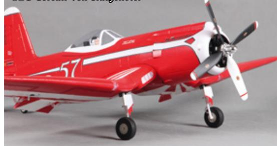
Aus EPO ist die F2G Corsair von Staufenbiel gefertigt. Das Modell verfügt über eine Spannweite von 1.100 Millimeter, ist 900 Millimeter lang und wiegt 1.400 Gramm. Ausgeliefert wird sie als Fertigmodell inklusive einer verbauten Brushless-Combo, den erforderlichen Servos sowie einem elektrischen Einziehfahrwerk. Für den Betrieb des Reno-Race-Modells wird ein 4S-LiPo benötigt. Es kostet 179,- Euro, im Set mit einem 3S-Flugmodellkreislauf beträgt der Preis 199,- Euro.
