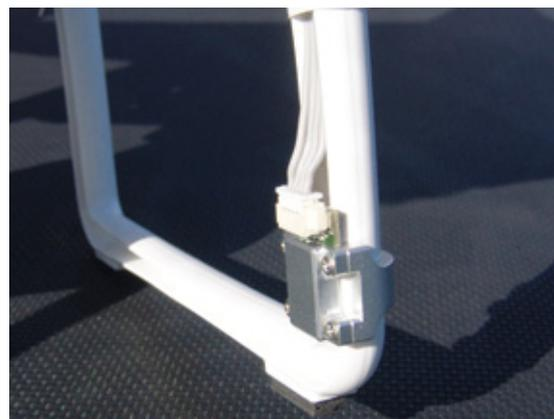
*Der digitale Magnetkompass ist am Landebein montiert*
