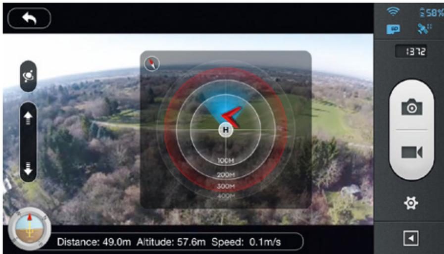
Drückt man auf das Symbol unten links, wird das Flight-Radar in der Bildmitte eingeblendet
