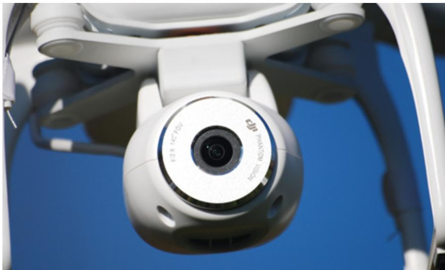
*Die serienmäßig montierte DJI-HD-Kamera FC200 hat integriertes WiFi, eine Tilt-Steuerung und liefert gute Bildergebnisse*
