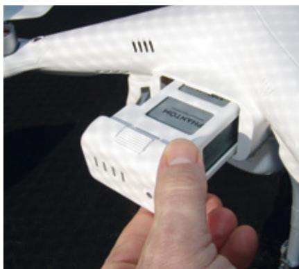
*Das Einschieben in den Akku-Schacht ist sehr bequem – es müssen keine Steckverbindungen hergestellt werden*
