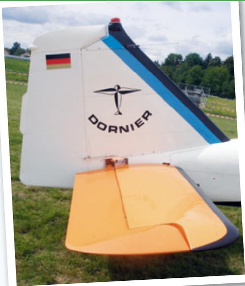
Das Leitwerk der D-EGAO mit den großen Ruderhornausgleichen. Die Ruderflächen sind stoffbespannt ausgeführt (Foto: Thomas Brückelt)
