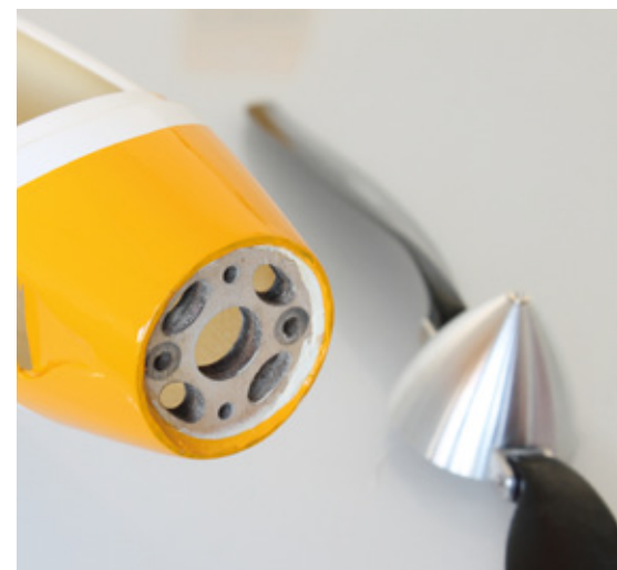
Der Motorspant ist bereits werksseitig sauber eingeklebt. Die Klappflugschraube schließt bündig mit der Rumpfkantur ab
