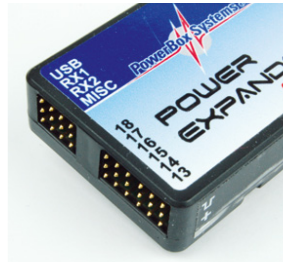
Auf der linken Schmalseite des PowerExpander SRS sind die Anschlüsse für USB, zweimal Empfänger sowie der S-Bus-Ausgang untergebracht, daneben die Servoausgänge 13 bis 18
