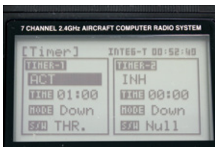
Der Timer des Senders kann zum Beispiel an den Gas-Stick gekoppelt werden. In diesem Beispiel beginnt der Timer bei Gas > Null, 60 Sekunden lang herunterzuzählen
