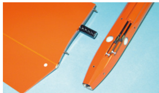
Die V-Leitwerkshälften werden an den Rumpf gesteckt und durch den Rumpf hindurch mit einer kleinen Schraube gesichert
