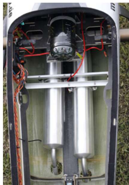
Hier ist der Innenausbau einer CARF EA330SC mit Resonanzrohren zu sehen. Im Vergleich zu normalen Schalldämpfern ist eine Steigerung der Leistung möglich
