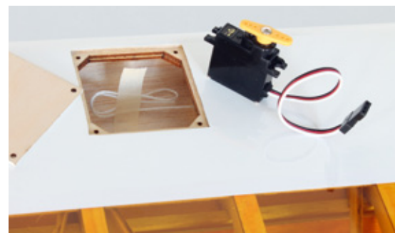
Die Dymond DS-60-Servos haben mit 2 Kilogramm Stellkraft genügend Power, die Störklappen auszufahren
