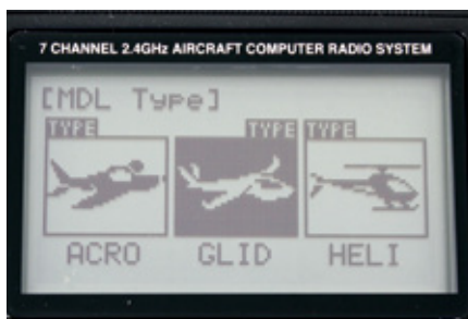
Für Segler-, Motormodell- und Heli-Piloten stellt die Flash 7 eigene Menüs zur Verfügung und bietet weitreichende Einstellmöglichkeiten
