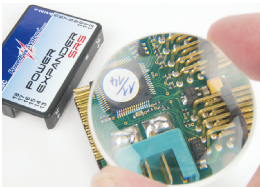
Das Innenleben des PowerExpander SRS offenbart eine sehr gute Verarbeitung mit modernen Bauteilen
