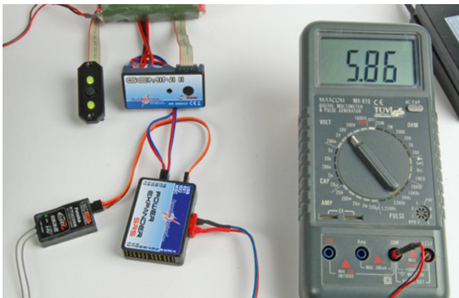
Am MPX-Stecker des PowerExpander SRS messen wir die vom Gemini II ausgegebene Spannung
