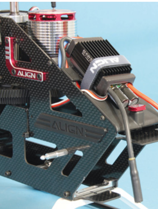
Der 70-Ampere-Align-Regler ist Bestandteil der Super Combo
