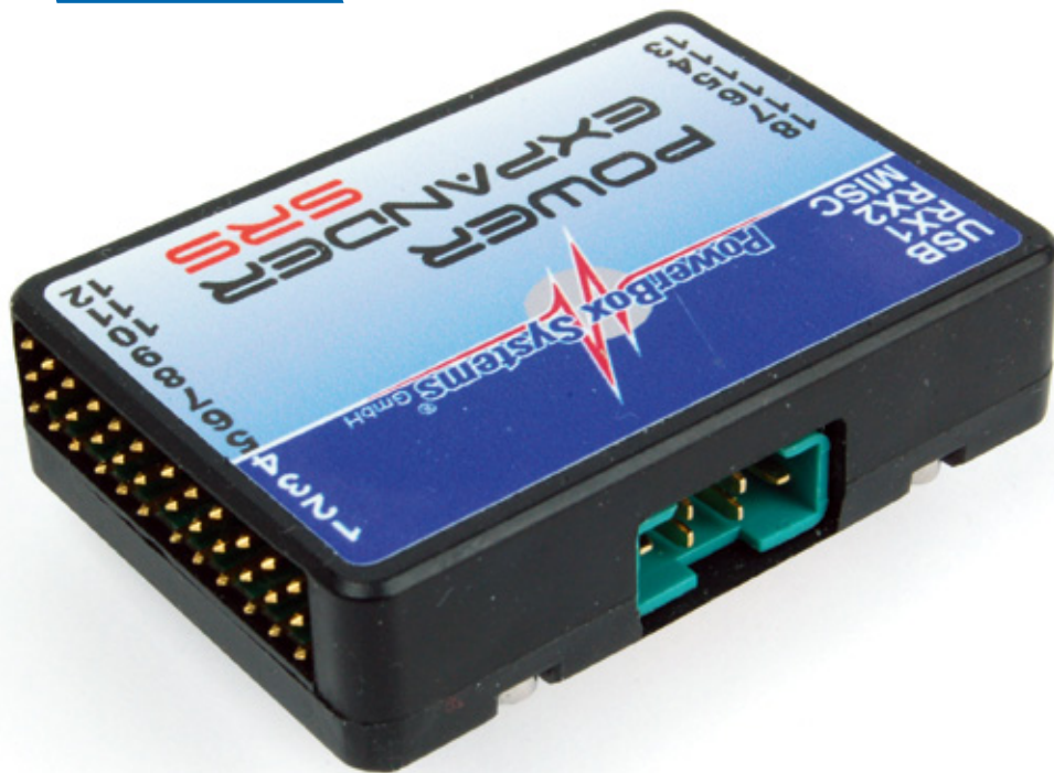
Der Anschluss zur direkten Stromspeisung kann als MPX- oder Deans Stecker geordert werden
