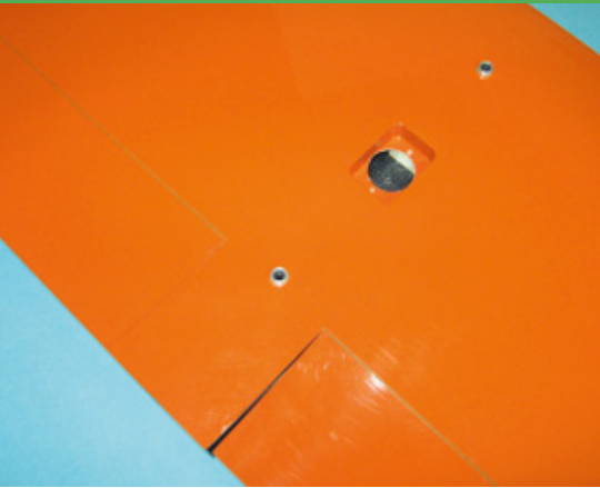
Die Flügelaufnahme im Tragflächenmittelstück ist ebenso weit vorgefertigt wie der Rest des Modells. Hier sieht man die Aufnahme des Steckverbinders zu den Flächenservos
