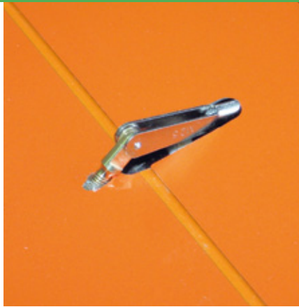
Bei den Wölbklappen sind sowohl die Bohrungen für die Augschrauben der Ruder als auch die Durchbrüche für die Anlenkungsgestänge ab Werk erstellt
