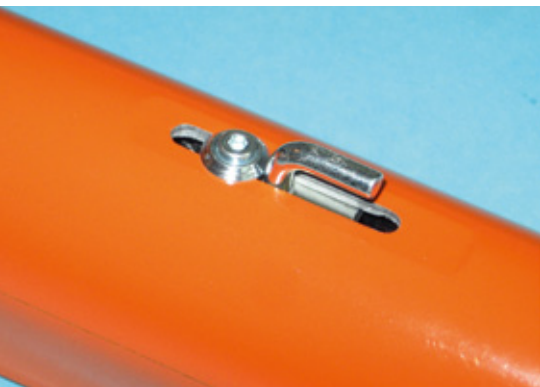
Ein verstellbarer Hochstarthaken darf bei einem F3J-Modell nicht fehlen. Dieser hier ist flugfertig eingebaut
