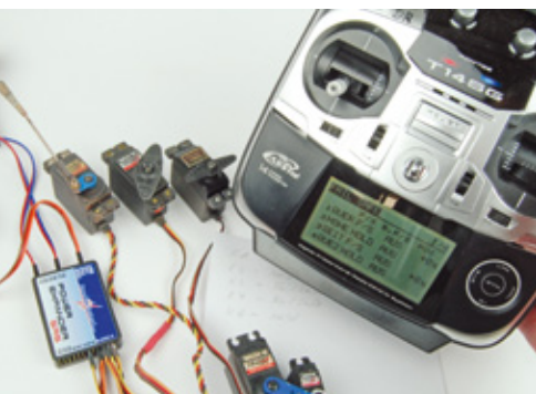
Das Fail-Safe-Verhalten wird senderseitig und empfängerseitig überprüft, ...
