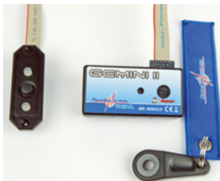
Die Gemini II kann entweder mit dem Sensor-Switch oder dem Magneten geschaltet werden
