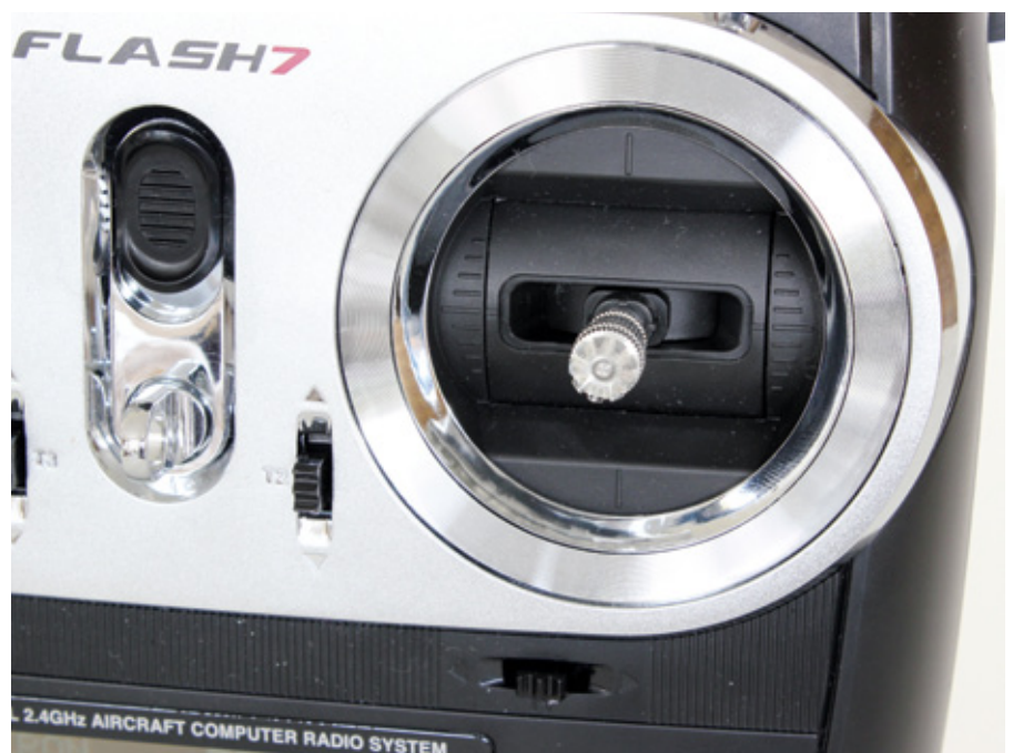
Die Kreuzknüppel sind gut verarbeitet, lassen sich in der Länge verstellen und ermöglichen durch eine Auflösung von 4.096 Schritten eine sehr feinfühligke Steuerung
