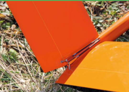
Die V-Leitwerksanlenkung erfolgt auf der Oberseite
