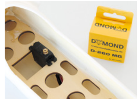
Der Ausschnitt im Rumpf ist für Servos der 13-Millimeter-Klasse ausgelegt. Im Testmodell kamen D-260 MG von Staufenbiel mit Metallgetriebe zum Einsatz
