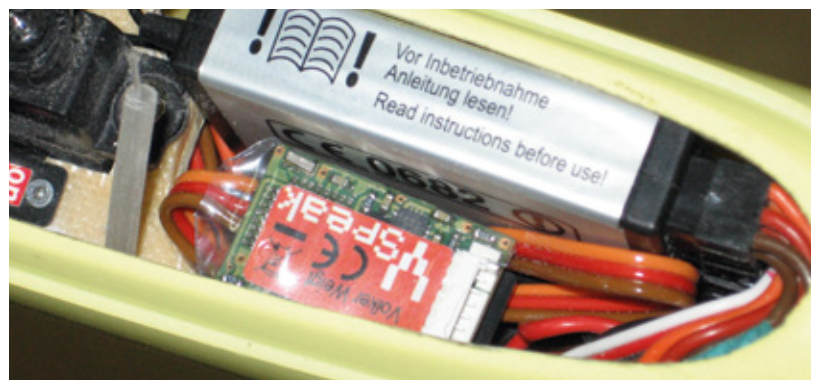
Kleine und kompakte Telemetriesensoren, wie hier das VSpeak Vario, passen selbst in die schlanksten Zwecksegler Rümpfe
