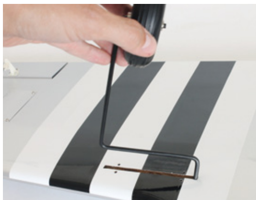
Obwohl es den Eindruck eines Einziehfahrwerks erweckt, ist das Landegestell bei der Mustang starr
