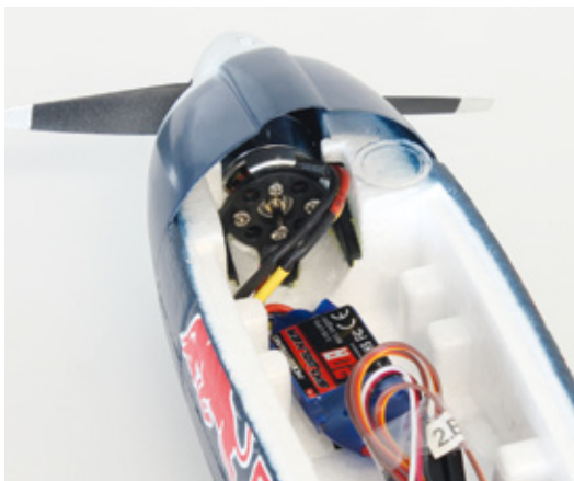
Angesteuert wird der Motor von einem 20-Ampere-Regler von Hobbywing
