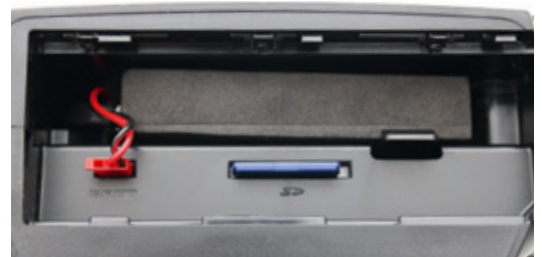
Im Akkufach des Senders wird der Sender-Akku untergebracht und die Stromversorgung hergestellt. Die SD-Karte findet ihren Platz im Kartenschacht
