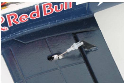
Die Anlenkung der Ruder befindet sich auf der Oberseite der Tragfläche. Der Grund dafür liegt im nicht vorhandenen Fahrwerk
