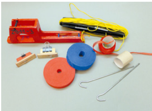
Streamerschneidemaschine mit Schneideeinsätzen für zwei- oder dreifaches Schneiden
