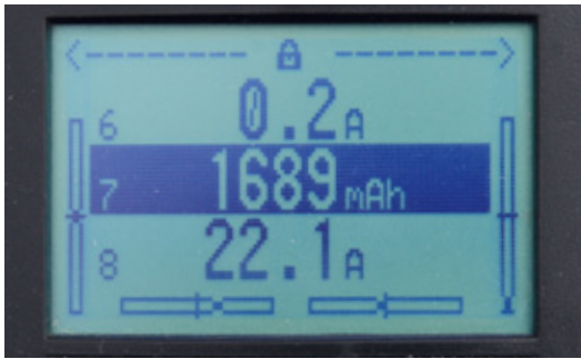
Die Telemetriedaten wandern vom HF-Modul auf das Senderdisplay und werden dort angezeigt
