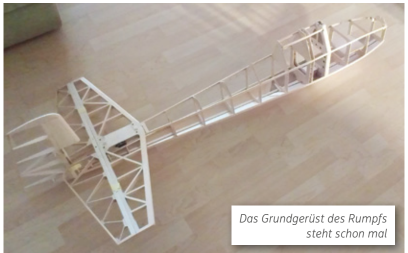
Das Leitwerk wurde besonders leicht konstruiert
