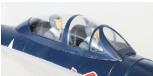
Das Cockpit ist mit zwei Piloten besetzt. Um das Bauteil aufsetzen zu können, muss es gekürzt werden
