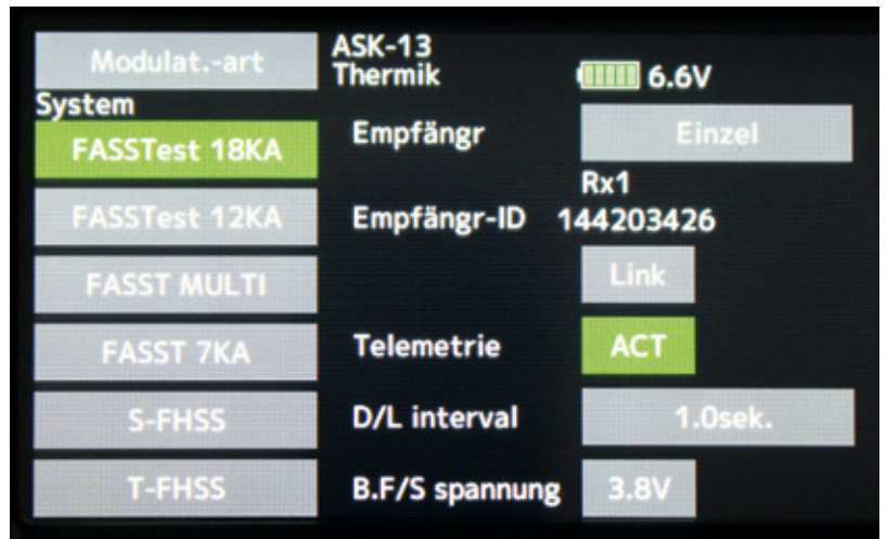
Im Menüpunkt Modulationsart werden alle Futaba-Modulationsarten angeboten. Neu dazu gekommen ist T-FHSS
