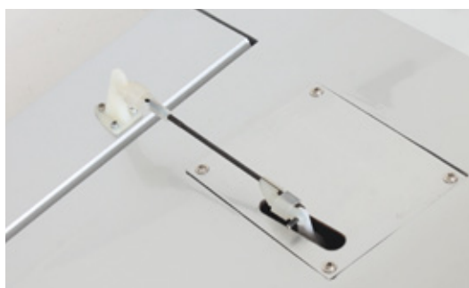
Die werkseitig fertiggestellten Ruderanlenkungen sind von durchweg guter Qualität
