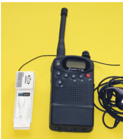
Die Anfänge der Telemetrie: Das Picolar ist ein äußerst leistungsfähiges Variometer im 433-Megahertz-Band. Das Sprechfunkgerät dient dabei als Empfänger
