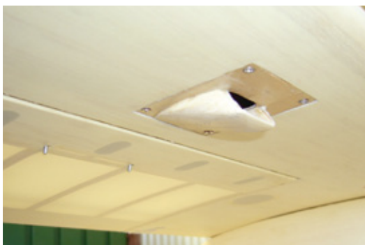
Über eine kleine Hutze auf der Flächenunterseite erhalten die Motoren Kühlluft
