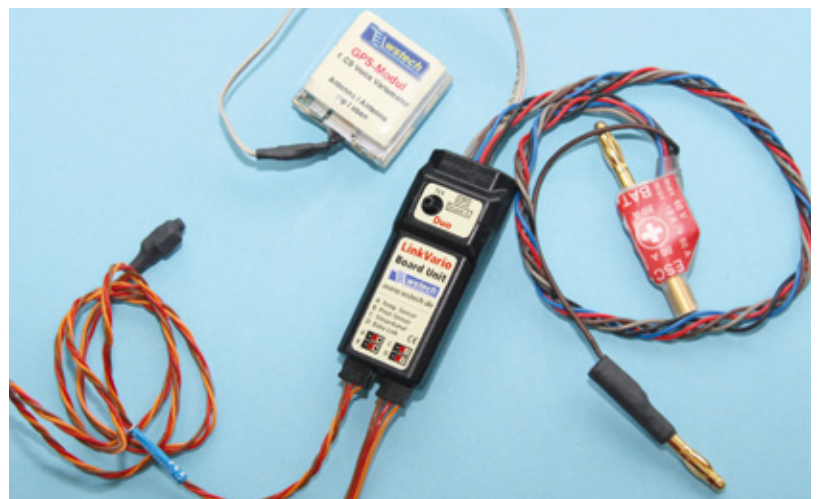
Hier nochmal das Konzept des LinkVarios mit den anzuschließenden Sensoren für Temperatur, Strom-/Spannung und GPS-Position
