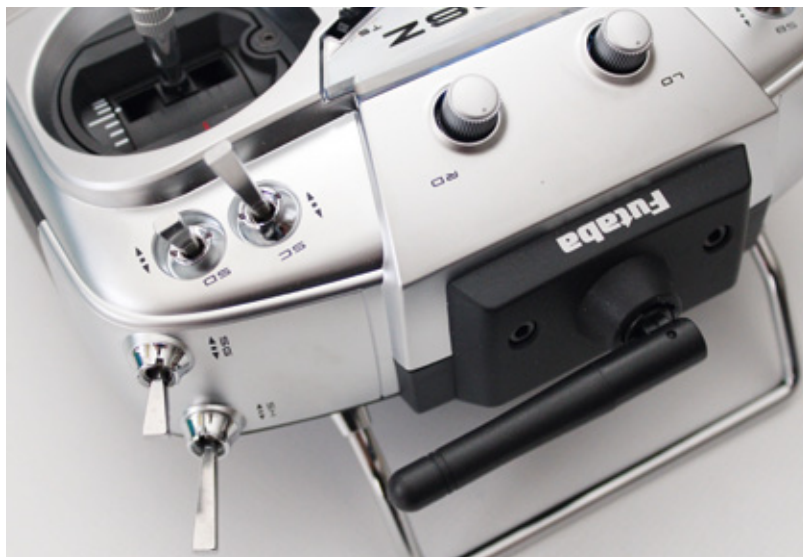
Der Schalter SH ist ein Momentschalter und könnte für den Lehrer-Schüler-Betrieb genutzt werden
