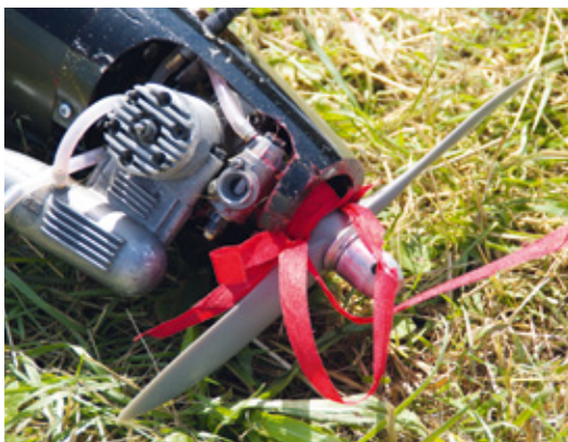
Fest auf der Motorwelle aufgewickelter Propeller-cut
