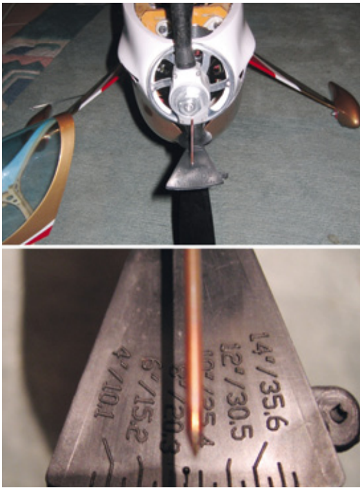
Bild 4: Die Einstellung der Blattsteigung erfolgt mit einer kleinen Lehre
