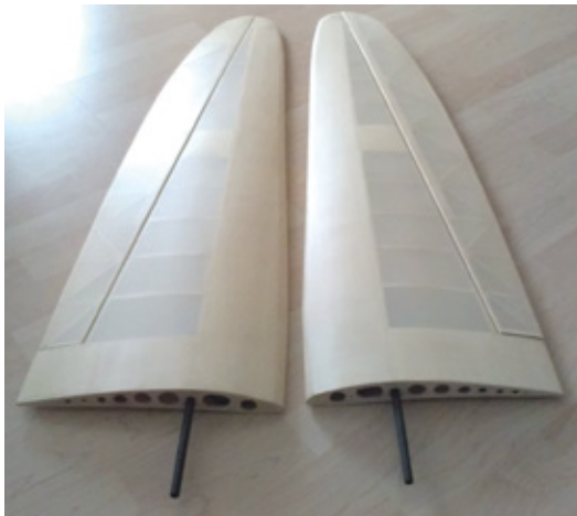
Durch die Bespannung mit Oratex ergibt sich ein klassischer Oldtimer-Look
