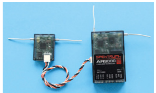
Empfänger mit Stummelantennen und Satelliten bieten viele Möglichkeiten, die Empfangsqualität zu optimieren
