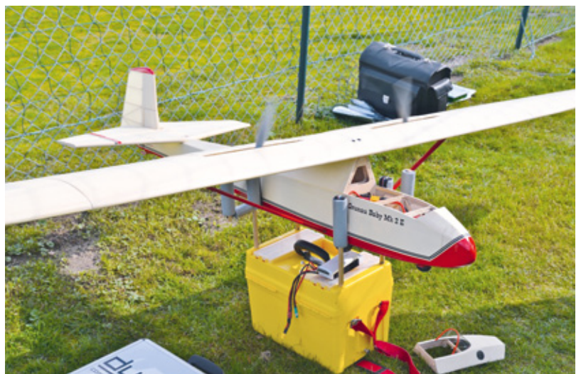
Der Antrieb betriebsbereit. Durch die Schlitze können die Propeller rotieren
