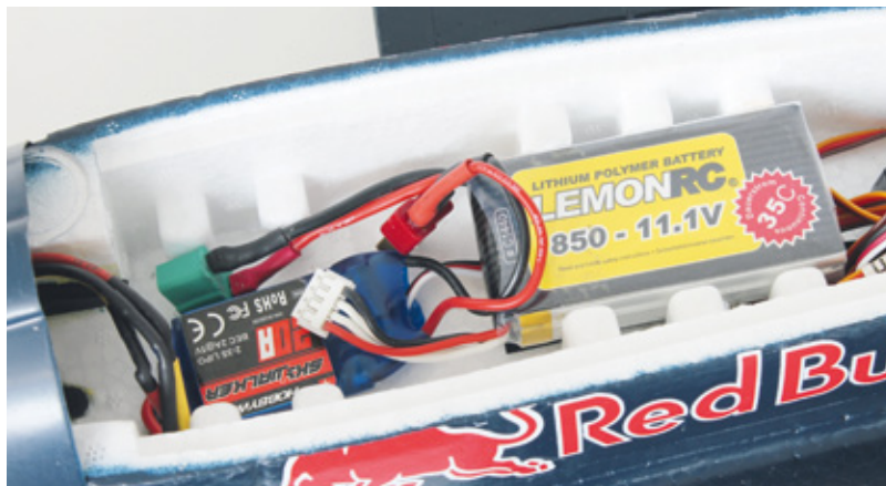
Der Akku, empfohlen wird ein 3s-LiPo mit 850 Milliamperestunden Kapazität, findet im gerippten Rumpfmittelteil Platz
