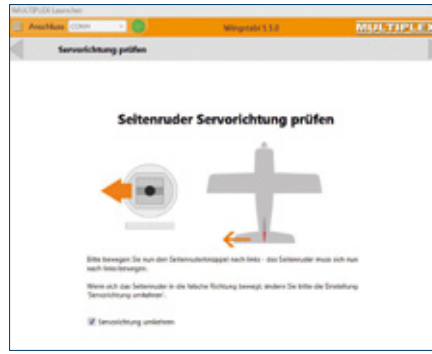
Der Einrichtungsassistent sorgt auch dafür, dass die Wirkrichtungen der Ruder nochmal überprüft werden. Anschließend werden noch einmal alle Kanaluweisungen im Überblick dargestellt
