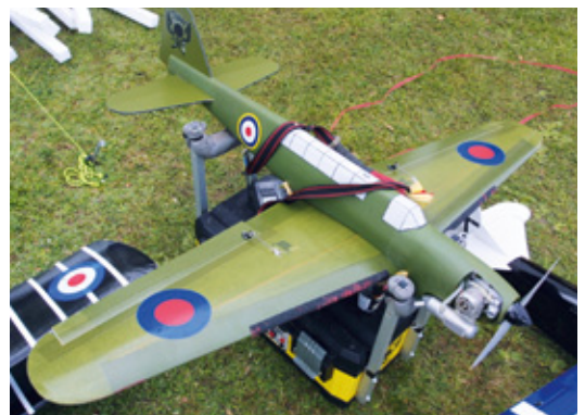
Ein Modell im Vorbereitungsraum. Gut zu sehen sind die Schleifpapierstreifen an den Nasenleisten der Flächen
