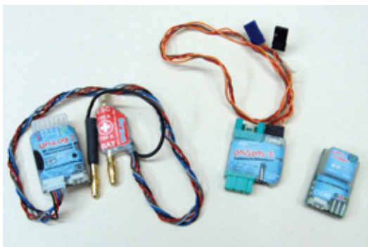
Unilog2, Unisens-E und GPS-Logger2 sind weit verbreitete Telemetriesensoren, die mit vielen verschiedenen 2,4-Gigahertz-Systemen zusammenarbeiten
