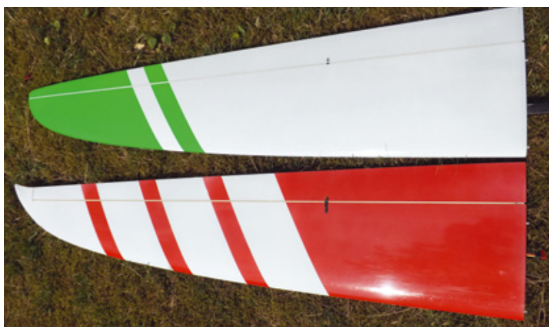
Am XPLOER 3 sind die Randbögen bei Fläche und Leitwerk deutlich runder geworden. Hierdurch versprechen sich die Entwickler schnellere Startzeiten
