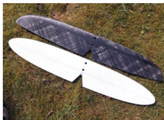
Am XPLOER 3 sind die Randbögen bei Fläche und Leitwerk deutlich runder geworden. Hierdurch versprechen sich die Entwickler schnellere Startzeiten
