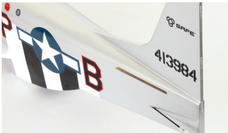
Durch den Schlitz im Rumpf wird das Höhenleitwerk eingeschoben und verklebt
