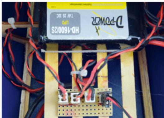
Die kleine Verteilerplatine mit zwei Steckern für die Tragflächen, Schalter und Akku. In der „Small-Version“ genügt auch ein 1.000-Milliamperestunden-Akku voll und ganz
