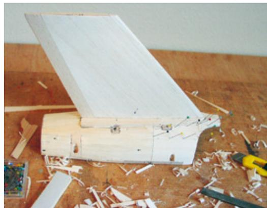
Stück für Stück wird am Einlauf beplankt. Die zahlreichen kleinen Arbeiten am Deckel des Impellertriebwerks sind zwar nicht schwierig, aber recht zeitaufwändig
