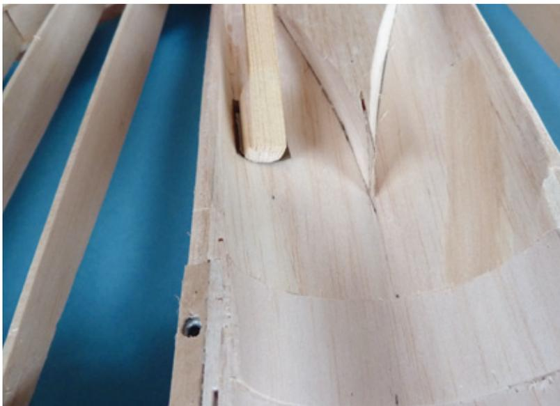
Der Einlaufbereich wird mit einer gerundeten kleinen Schleiffeile geschliffen
