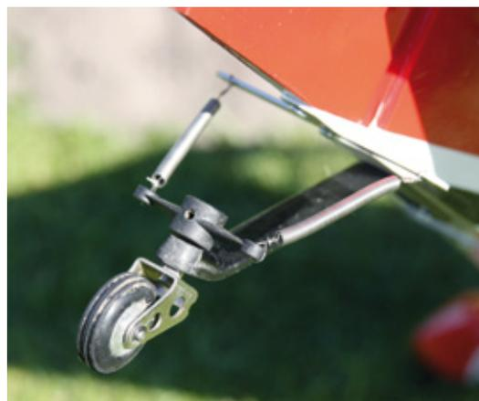
Viele Spornräder sind gefedert mit dem Seitenruder verbunden, um die Mechanik zu entlasten. Dadurch werden Steuerbefehle am Boden jedoch mit einer gewissen Verzögerung umgesetzt. Spornradpiloten müssen daher vorausschauend rollen
