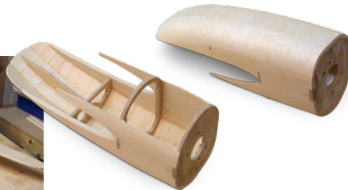
Aufbau der Motorgondel der Me 410
