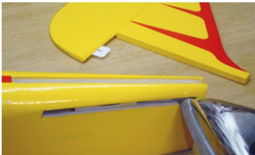
Die zunächst mit Folie verdeckten Schlitz für die Leitwerke werden mit leichtem Überstand freigelegt und der Saum eingebügelt
