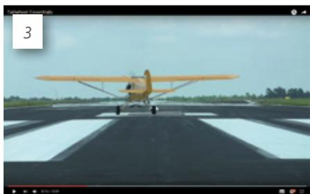
1. Ein Youtube-Video zeigt bei dieser manntragenden Piper den Start. Die Maschine rollt an und es sind nur leichte Korrekturen notwendig. Das Höhenruder ist leicht gezogen, damit das Spornrad möglichst fest auf den Boden gedrückt wird
