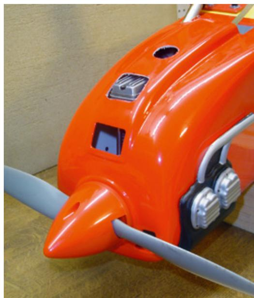
Von dem hängend eingebauten Viertakter ragt kaum etwas aus der großen Cowling heraus. Die Zylinderattrappen entfalten ihre volle Wirkung
