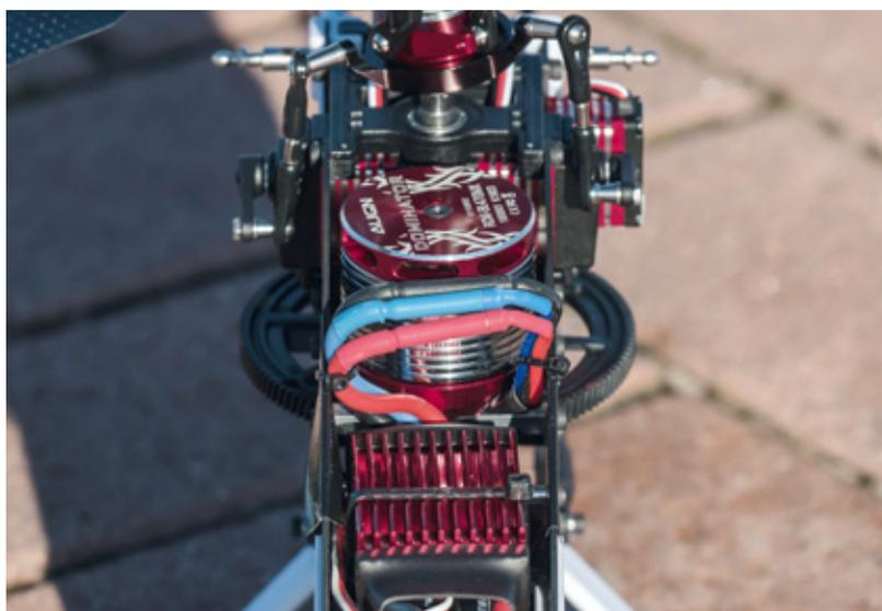
Der Align 470MX-Brushlessmotor sorgt an 6s mit dem 11-Zähne-Ritzel für eine theoretische maximale Hauptrotor-Drehzahl von etwa 3.400 Umdrehungen pro Minute
