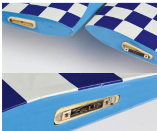
Sind die Sperrholzteile angepasst, können sie verklebt werden
