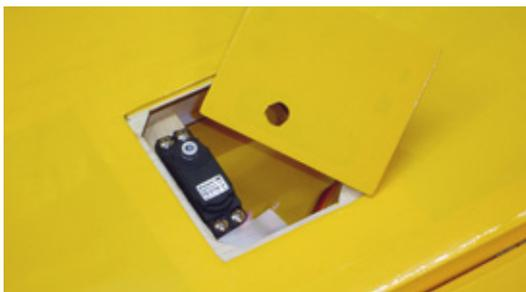
Korrekt vorbereitet, muss in die Folie der Schachtabdeckungen lediglich ein kleines Loch für den Servoantrieb
