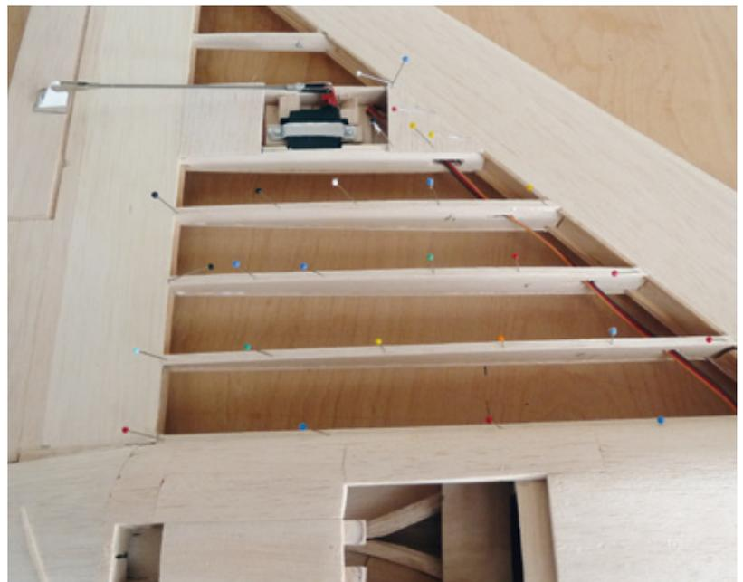
Auf der Unterseite der Tragfläche werden die Rippenaufleimer aufgeklebt. Durch das größere Loch im Rumpf wird später der Regler eingesetzt, durch das kleinere entweicht die Abluft
