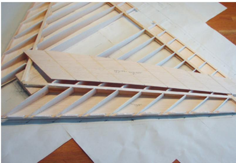
Die Beplankung ist vorbereitet: Im Rippenbereich wurde beidseitig Kontaktkleber aufgebracht, Holm und Balsastücke wurden mit Leim bestrichen
