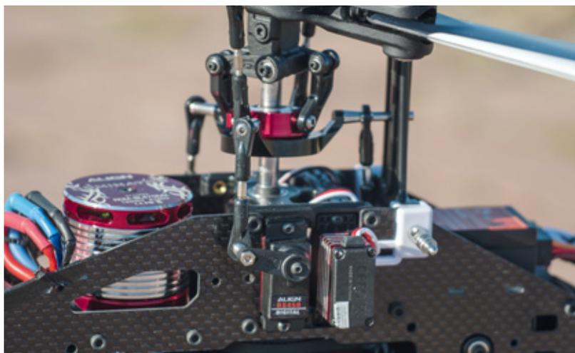
Die drei DS450-Servos steuern die Taumelscheibe in 120-Grad-Konfiguration an
