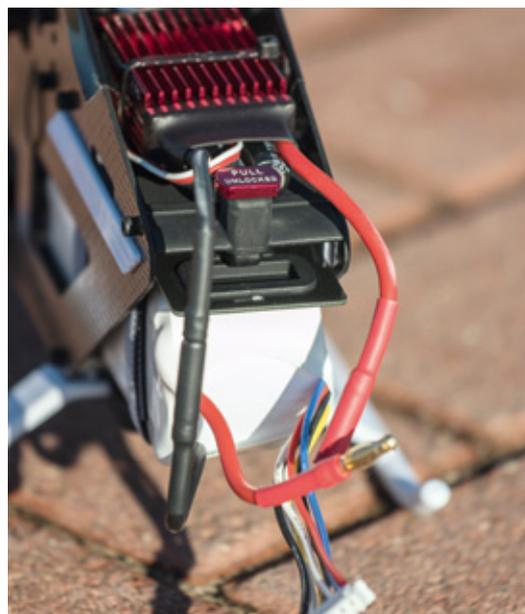
Zieht man den roten „Pull Unlocked“ Hebel nach oben, kann man den Akku vorne aus dem Chassis herausnehmen
