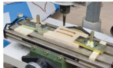
Zum Biegen der Bleche müssen diese fixiert werden. Anschließend werden Aufnahmen für die kleinen Träger hergestellt
