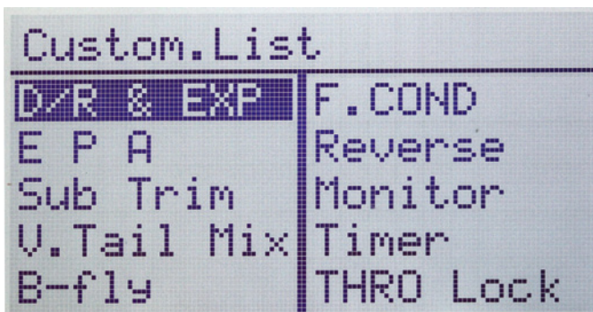
Die Custom.LIST kann sich jeder Anwender selber zusammenstellen mit denjenigen Menüpunkten, die oft benutzt werden
