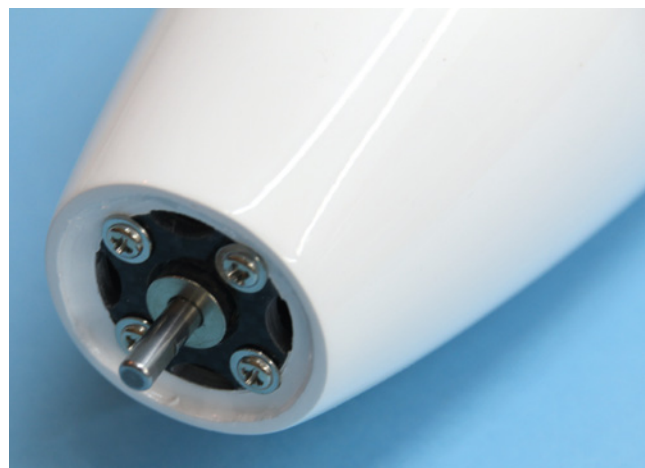
Bei der PNP-Version sitzt der Motor bereits an seinem Arbeitsplatz und wird mit einem stabilen Spant am Rumpf befestigt
