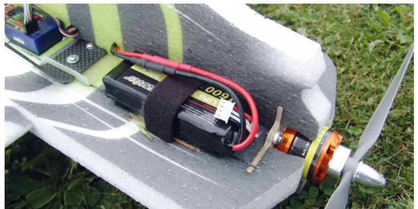
Die Positionierung für den ursprünglich angegebenen Schwerpunkt sah den Antriebsakku möglichst weit vorne
