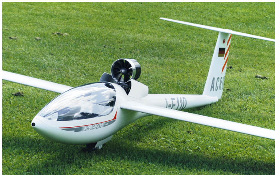
Trotz der großen Klappe für das Triebwerk gibt es keine Festigkeitsprobleme im Rumpf
