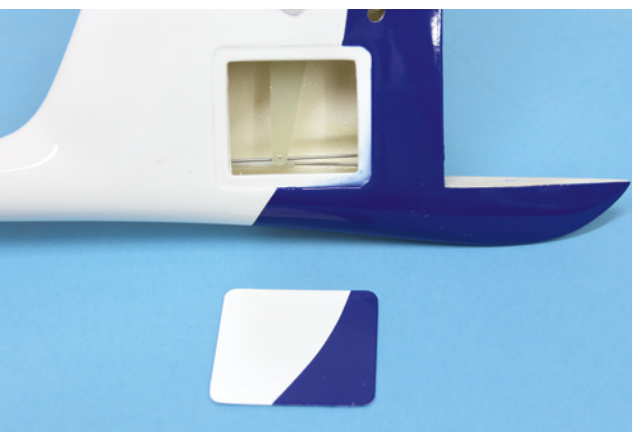
Über einen extra Rumpfdeckel gibt es Zugang zur Höhenleitwerksanlenkung
