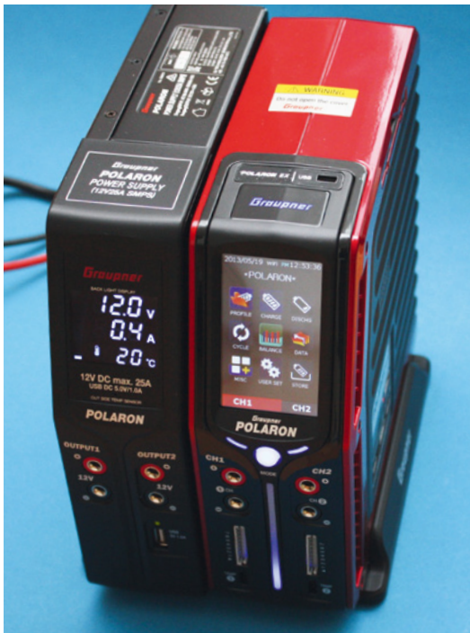
Kann denn Schönheit Sünde sein? Polaron EX-Lader mit angekoppeltem Netzgerät. Ladbar sind zwei 7s-LiPos mit maximal 25 Ampere. Das Gerät nutzt ein modernes Touch-Display
