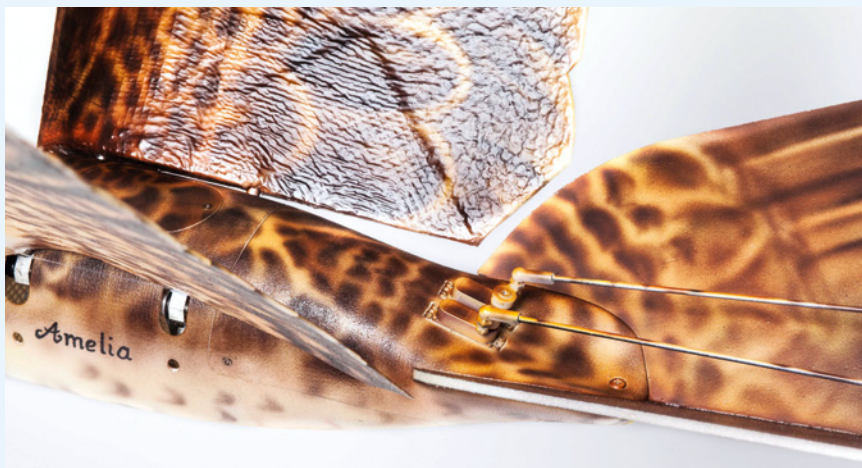
Zwei Servos am Heck bedienen das V-Leitwerk in Vogelschwanz-Form
