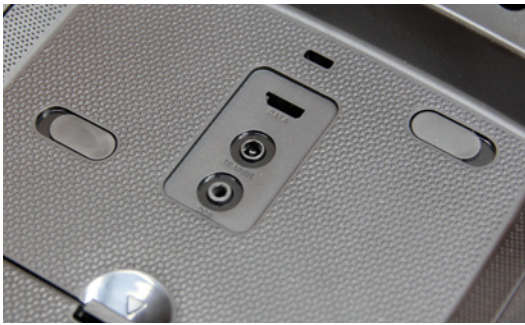
Rückseitig finden wir eine Data-Buchse für etwaige Software-Updates sowie eine Trainer- und eine DSC-Buchse vor, mit der man zum Beispiel eine FPV-Brille mit Spannung versorgen kann
