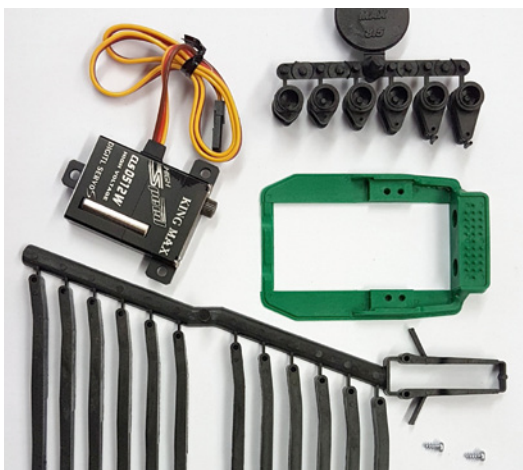
Starkes, 8 Millimeter dünnes HV-Flächenservo von King Max mit passendem Einbausatz von servorahmen.de
