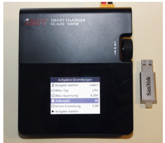
Außen klein, innen ganz groß: der ISDT-Charger SC-620 mit immerhin 0,5 Kilowatt Ladeleistung; dazuhin mit geradezu vorbildlichem Bedienungskomfort
