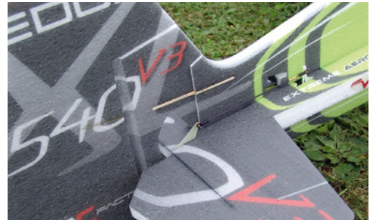
Eine Sperrholzverstärkung dient zum Aussteifen des kritischen Übergangsbereichs zum Seitenrunder
