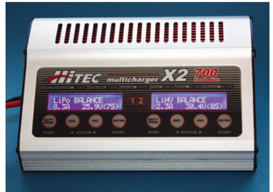
Der HiTec multicharger X2 im Vertrieb von Multiplex schafft zwei 8s-LiPo-Batterien mit maximal 30 Ampere Ladestrom
