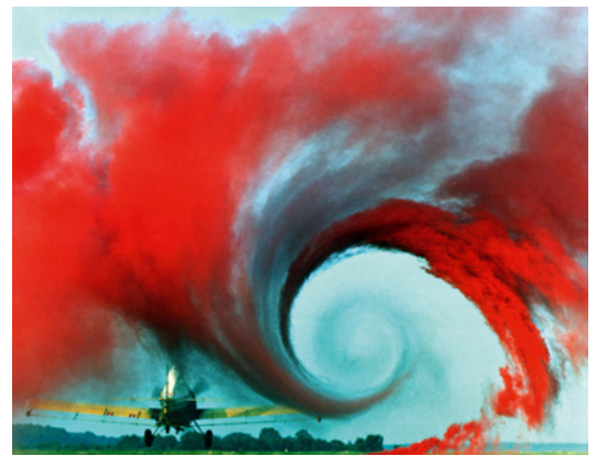
Bild 2: Sichtbarmachung der Wirbelschleppe hinter einer kleinen Sportmaschine mittels gefärbten Nebels
