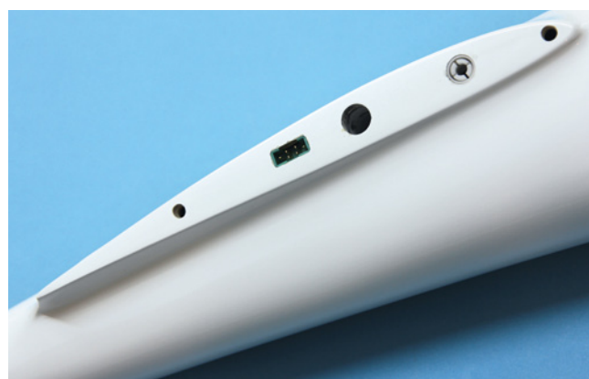
Der Flügelanschluss zeigt die hohe Vorfertigung, die Flügelsteckung und die Servostecker sind eingeklebt, und auch der Multilock um den Flügel am Rumpf zu sichern, befindet sich an Ort und Stelle
