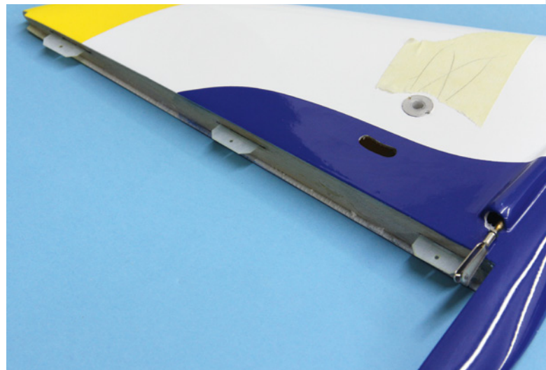
Das Seitenruder wird mittels Vliesscharniere am Rumpf befestigt. Dies ist vom Erbauer noch selbst auszuführen
