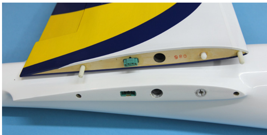
Sämtliche Steckungen sind sauber und passgenau ausgeführt
