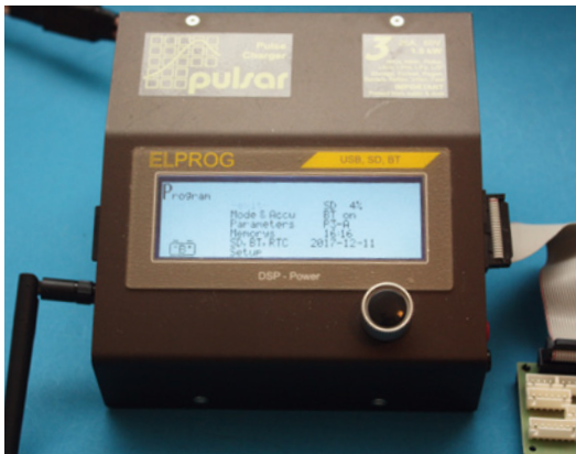
Ein Gerät der Superlative ist das pulsar 3 von pp-rc Modellbau. Es lädt bis zu 14 LiPo oder 16 LiFe-Batterien „am Stück“ mit bis zu 25 Ampere (1,5 Kilowatt). Die Variante pulsar 3+ legt noch etwas nach: 40 Ampere bei 2,5 Kilowatt
