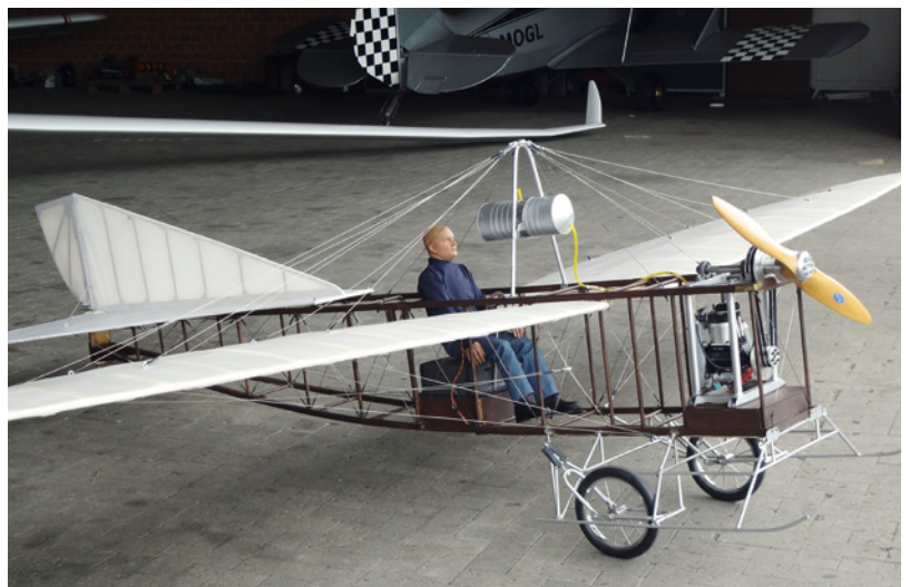
Dieser noch recht junge Nachbau der Krumsiek Nr. 1 fliegt inzwischen mit einem Dreizylinder-Sternmotor
