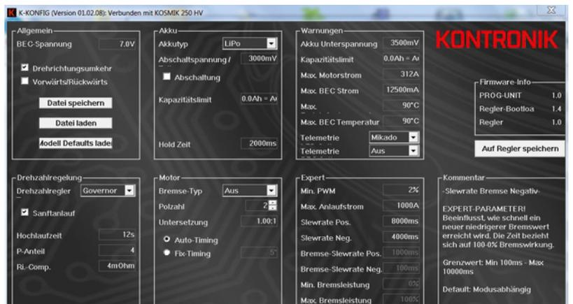
Wird der Kosmik über die ProgUnit an den PC angeschlossen und konfiguriert, erhält man Zugriff auf einen Reihe zusätzlicher Einstellmöglichkeiten, zum Beispiel im Heli-Betrieb auf den Governor-Store-Mode oder die internen Regler-Parameter
