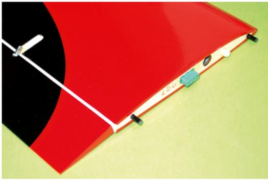
Die Tragflächen besitzen eingebaute Torsionsbolzen, Servostecker und auch der Flächenschnapp sitzt an Ort und Stelle
