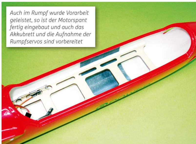
Auch im Rumpf wurde Vorarbeit geleistet, so ist der Motorspant fertig eingebaut und auch das Akkubrett und die Aufnahme der Rumpfservos sind vorbereitet
