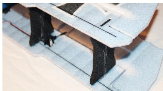
Die vorbereiteten Streben werden aufgeklebt und die untere Tragfläche ebenfalls befestigt. Deutlich sind die Verstärkungen aus Kohlefaserstäben zu sehen
