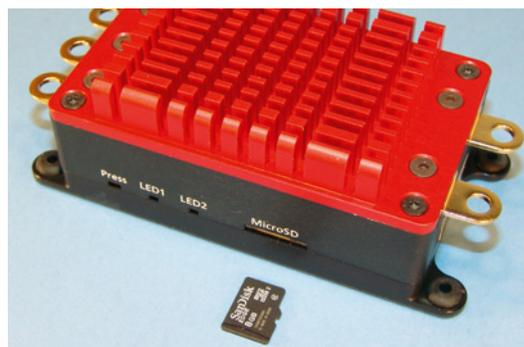
Mit dem Micro-Taster wird die Modus-Programmierung eingeleitet, die LED dienen als Diagnose-Interface im Fehlerfall. Die Micro SD-Karte loggt sämtliche Flugdaten zur späteren Auswertung auf dem PC
