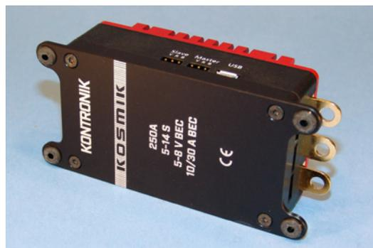
Die Befestigung im Modell kann über die vier Anschraubfüße mit Gummitüllen erfolgen
