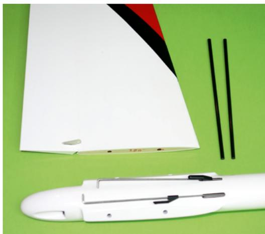
Das Leitwerk wird mit zwei CFK-Bolzen am Rumpf fixiert und muss nur noch eingeklipst werden. Anlenkungsdrähte und Ruderhorn hat der Hersteller schon fertig eingebaut
