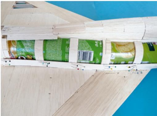
Der Rumpf wird im Bereich der Luftkanäle streifenweise beplankt
