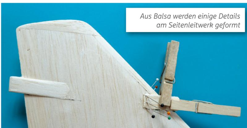
Aus Balsa werden einige Details am Seitenleitwerk geformt
