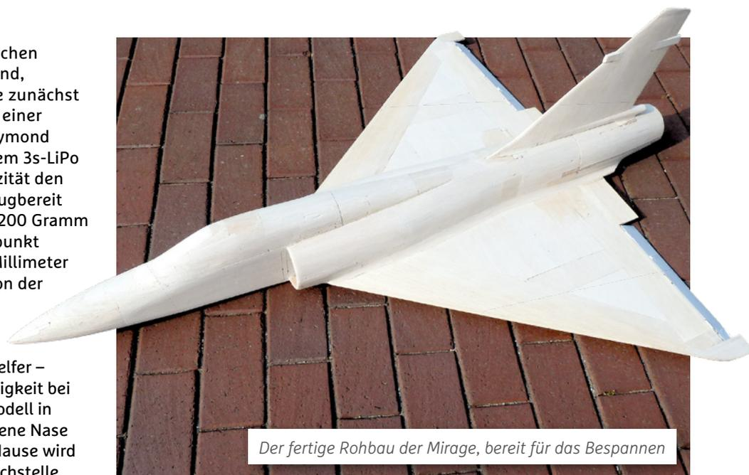
Der fertige Rohbau der Mirage, bereit für das Bespannen
