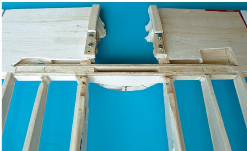
Nun wurden beidseitig des alten Holmverbinders neue Sperrholzteile angeklebt
