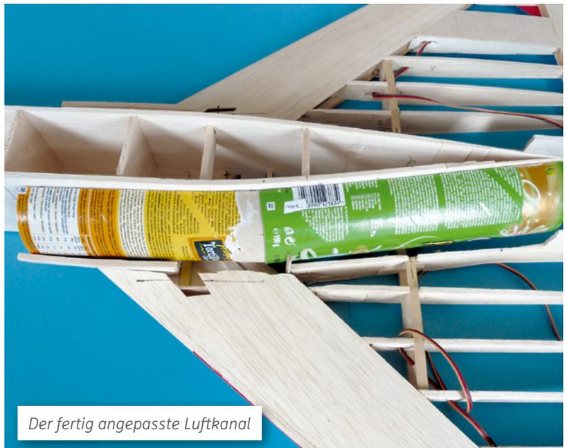
Der fertig angepasste Luftkanal
