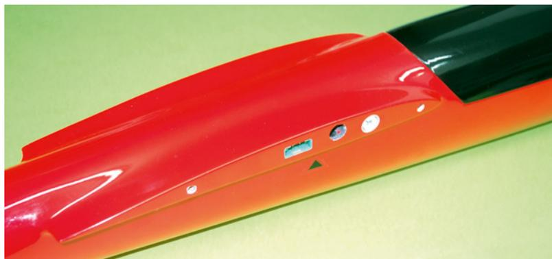
Beim Flügelanschluss gibt es nichts mehr zu tun und auch die Kabinenhaube wurde passgenau zugeschnitten und mit einer CFK-Feder versehen
