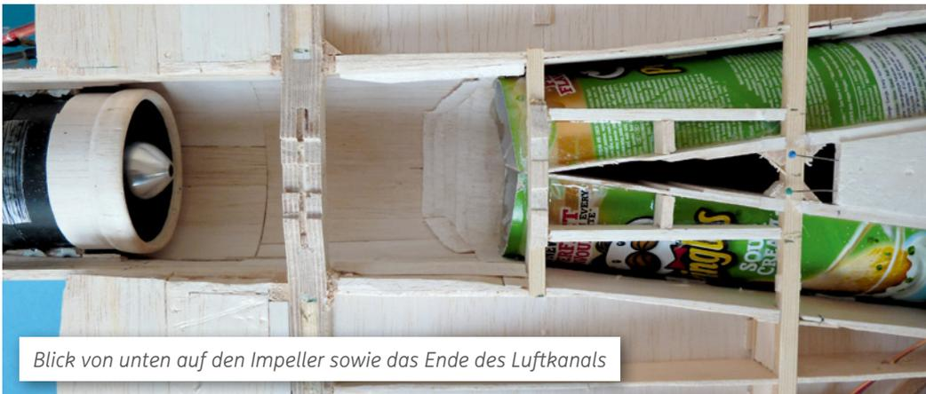
Blick von unten auf den Impeller sowie das Ende des Luftkanals
