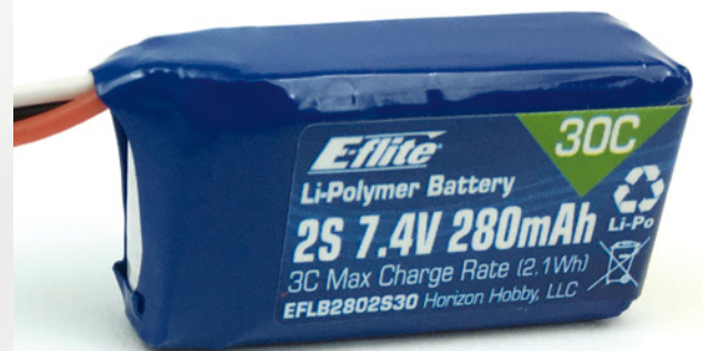
Im Testmodell kam ein 2s-LiPo mit 280 Milliamperestunden Kapazität zum Einsatz
