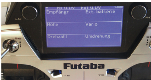
Das zweite Display ist kein Touchdisplay und wird über das Hauptdisplay eingestellt. Es zeigt Telemetriedaten und Timer an. Eine tolle und sinnvolle Ergänzung
