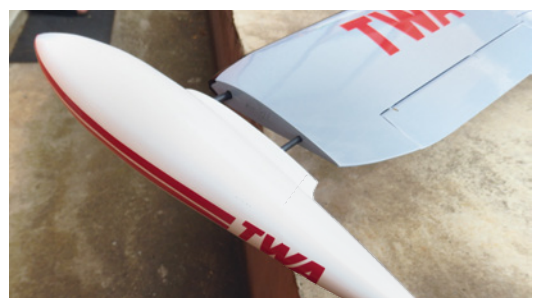
Der Tiptank an der rechten Tragfläche ist angepasst und aufgesteckt. Gehalten wird er nur über zwei GFK-Steckungen und einen Rundmagneten
