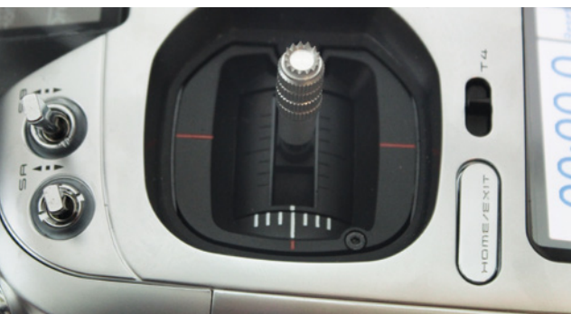
Die neuen Kreuzknüppel sind sehr elegant und können vielfältig verstellt werden. Über die kleine Schraube, wird die Federspannung beeinflusst. Die Federkraft und die Bremse werden mit Schrauben auf der Senderrückseite verstellt. Die größere Stellschraube verändert die Neigung des Steuerknüppels selbst
