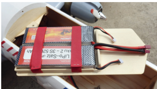
Die Akkurutsche ist mit den Akkus über der Tragfläche im oberen Rumpfteil eingeschoben
