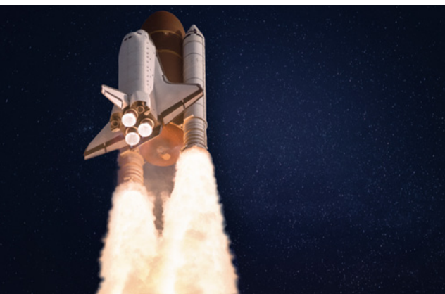
Bild 2: Das amerikanische Space Shuttle. Gegenüber den gewaltigen Abgasschweifern der beiden Startraketen fallen die drei Haupttriebwerke des Shuttles selbst kaum auf. Dies liegt an ihrer sauberen Verbrennung. Da sie mit Wasserstoff und Sauerstoff, also Knallgas betrieben werden, erzeugen sie als Abgas reinen Wasserdampf. Die Zusatzraketen arbeiten dagegen mit einem Festbrennstoff. Allerdings leisten diese auch den fünffachen Schub (24,9 gegenüber 5,3 MN) (Foto: NASA elen31)
