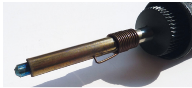
Die verschiedenen Lötspitzen werden einfach vorne auf das Heizelement aufgeschoben
