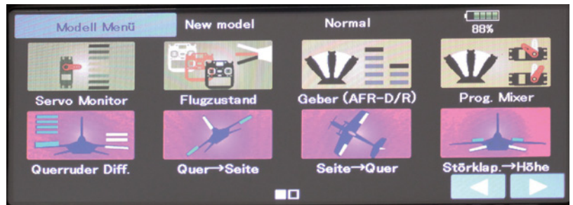
Im Modell-Menü werden unter anderem Daten wie Flugzustand, Querruderdifferenzierung, Gebereinstellungen, zehn freie Mixer, vorgegebene Mixer und Kreiselwerte eingegeben
