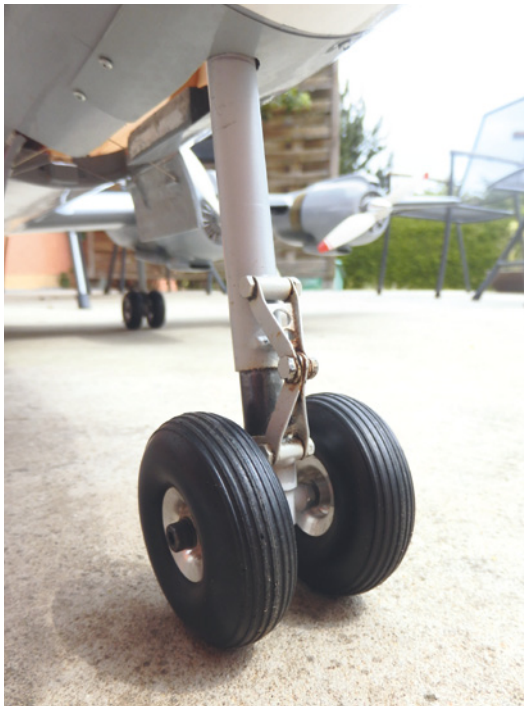
Bug- und Hauptfahrwerksbeine mit der Zwillingbereifung und ihrer Scale-Anmutung passen gut zu den Connys
