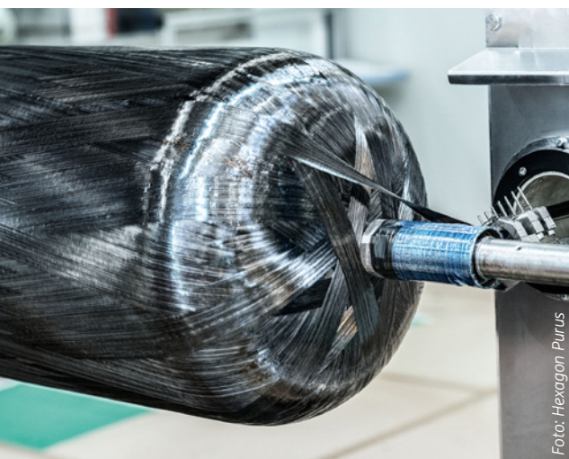
Bild 8: Wasserstofftank für einen Druck von 700 bar. Der hier mit Kohlefaser bewickelte Körper des Composite-Hochdruckbehälters besteht aus hochverdichtetem Polymermaterial, es stellt eine hinreichende Barriere gegenüber den hochflüchtigen Wasserstoffgasmolekülen dar
