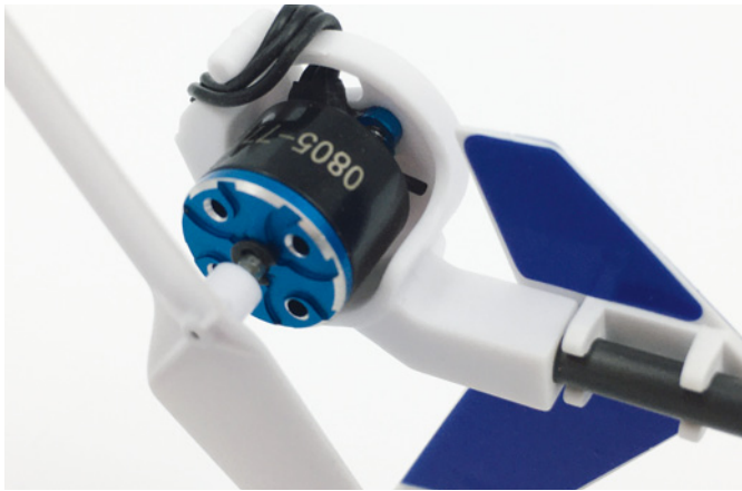
Der Heckrotor wird direkt von einem eigenen Brushlessmotor angetrieben
