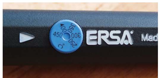
Über das blaue Drehrad lässt sich die Temperatur zwischen 250 und 450 Grad Celsius einstellen
