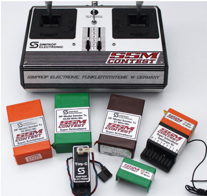
Für diesen Sender konnten Module in den Frequenzbändern 27, 35 und 40 Megahertz geliefert werden. Ebenso standen diese Module auch für den Achtekanal-Empfänger zur Verfügung
