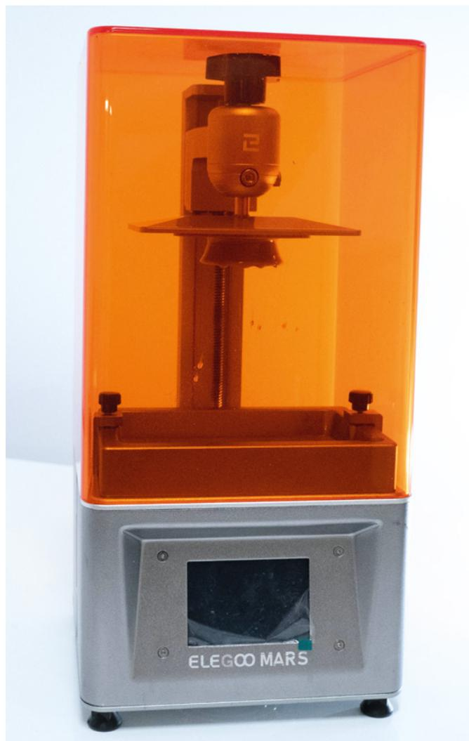
Der Elegoo Mars war einer der ersten, bezahlbaren MSLA-Drucker. Die orange Haube ist mehr als nur Deko, da sie UV-Licht blockiert. So wird verhindert, dass das Harz im Becken durch Tageslicht aushärtet und den Druck versaut
