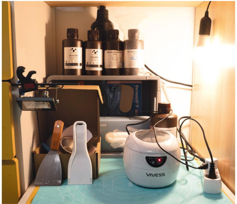
Für MSLA-Drucke ist etwas mehr Nacharbeit nötig. Eine Unterlage verhindert, dass Harz auf der Arbeitsfläche landet. Die Spachtel helfen, fertige Teile vom Druckbett zu lösen. Der Ultraschallreiniger ist mit Isopropanol gefüllt und spült flüssige Harzreste auch aus kleinsten Lücken. Handschuhe sind bei der Arbeit mit dem Harz Pflicht, um klebrige Finger zu vermeiden. Eine UV-Lampe beschleunigt die Aushärtphase um ein Vielfaches
