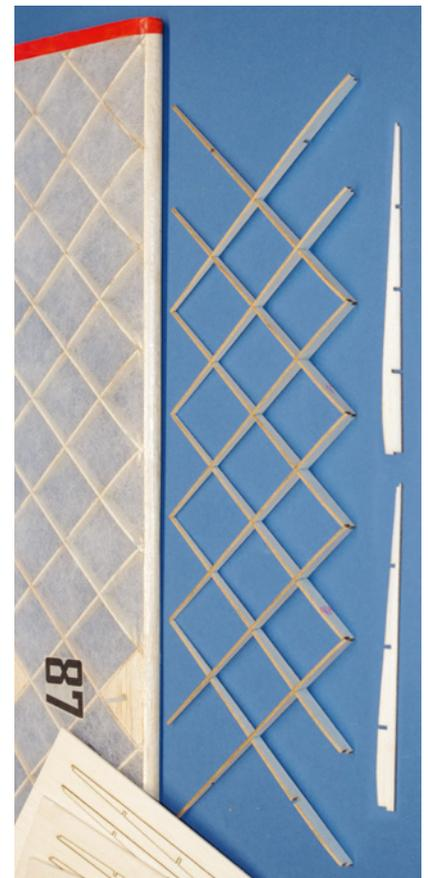
Die mit einem CAD-Programm entwickelten geodätischen Rippen werden zusammengesteckt und mit Sekundenkleber verbunden. Man braucht solche mit Einschnitten oben und solche mit Einschnitten unten (rechts)
