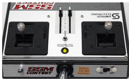
Die Simprop SSM-Contest hatte eine grünes Blinkklämpchen, um den Ladezustand des Senders anzuzeigen, und eine Kugelantenne
