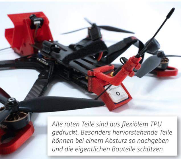
Alle roten Teile sind aus flexiblem TPU gedruckt. Besonders hervorstehende Teile können bei einem Absturz so nachgeben und die eigentlichen Bauteile schützen
