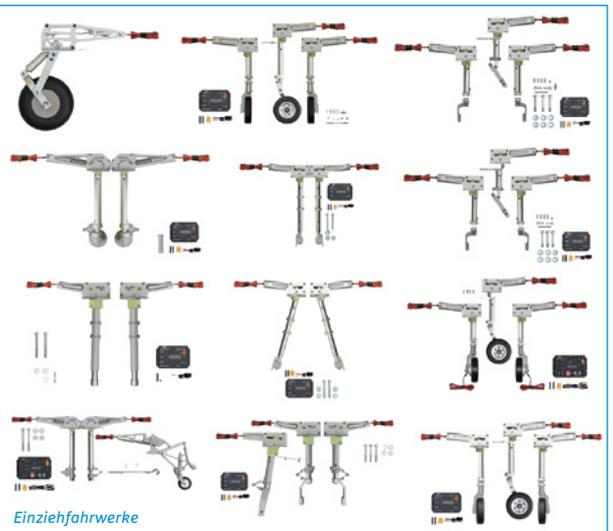
D-Power hat jetzt **Einziehfahrwerke** aus Aluminium von Phoenix Model im Angebot. Die elektrischen Varianten sind mit einer Radbremse ausgestattet, der Servomotor ist im Fahrwerk integriert. Angeschlossen werden sie mit der Control-Box direkt am Empfänger. Erhältlich sind die Fahrwerke in verschiedenen Größen, teilweise inklusive Räder. Die Betriebsspannung liegt zwischen 4,8 und 6 Volt. Preise: ab 119,90 Euro.
