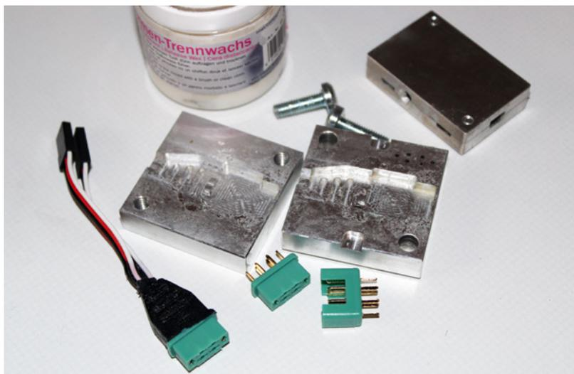
Um MPX-Stecker zu isolieren, kann man mit Hilfe spezieller Formen Heißkleber an den Stecker angießen. Das isoliert nicht nur gut, sondern sieht auch noch schön aus
