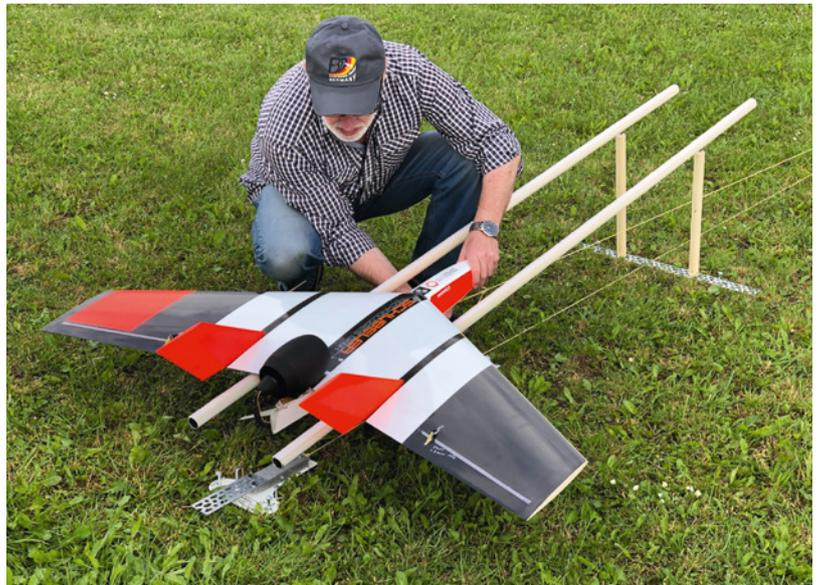
Eine selbstgebaute Startrampe aus zwei Besenstielen und ein Flitschengummi sind für einen sicheren Start unabdingbar
