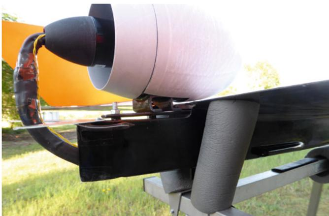
Der Impeller ist auf einer Wippe montiert und lässt sich hinten hoch- und runterschrauben. Dadurch kann der Strahlwinkel zum Flügel optimiert werden
