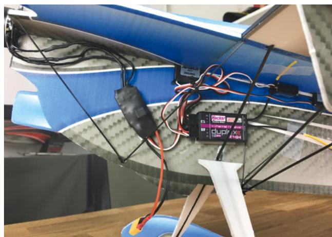
Die Elektronikkomponenten werden per Klettband am Rumpf befestigt, sodass sie jederzeit gut zugänglich und im Zweifel austauschbar sind
