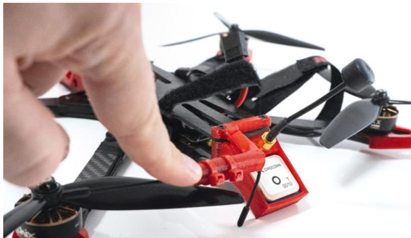
Im Falle eines Crashes kann die hervorstehende Antenne wegbiegen und so vor schlimmeren Schäden bewahren. Auch lassen sich Komponenten ohne eigene Befestigungsmöglichkeit so einfach „einklemmen“, wie in diesem Fall das GPS
