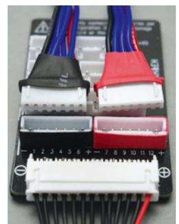
*Auf der Platine ist genau beschrieben, welche Kombinationen beim Laden von zwei Akkus gleichzeitig erlaubt sind*
