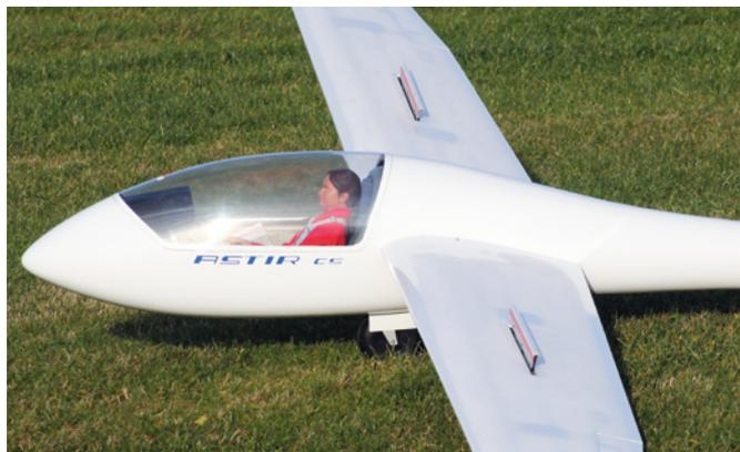
Die doppelstöckigen Störklappen befinden sich nur auf der Oberseite und fahren recht weit aus. So kann Höhe schnell abgebaut werden. Das FEMA-Fahrwerk erhebt den Rumpf etwas höher als im Original, was zum Schutz der Fahrwerksklappen kein Nachteil ist
