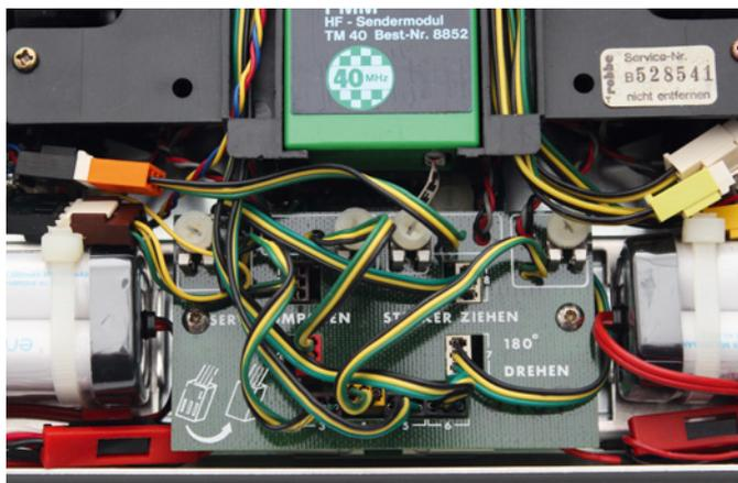
Durch drehen der Stecker um 180 Grad war eine Servoumkehr möglich. Durch Verstellen der Drehpotis der Kanäle eins bis vier konnte der Servoweg beeinflusst werden
