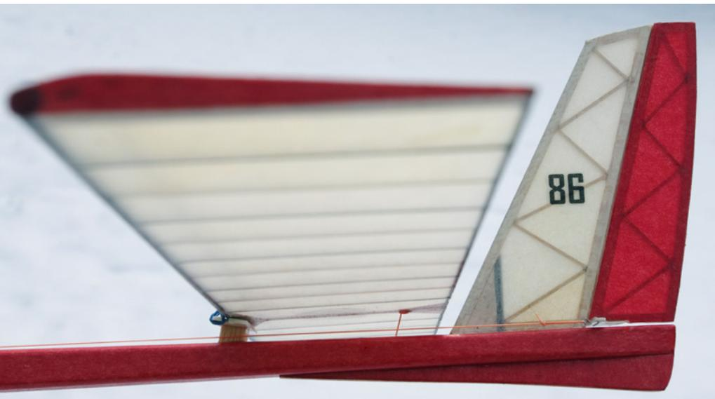
Die Warren-Truss-Struktur im Leitwerk hilft, an entscheidender Stelle Gewicht zu sparen
