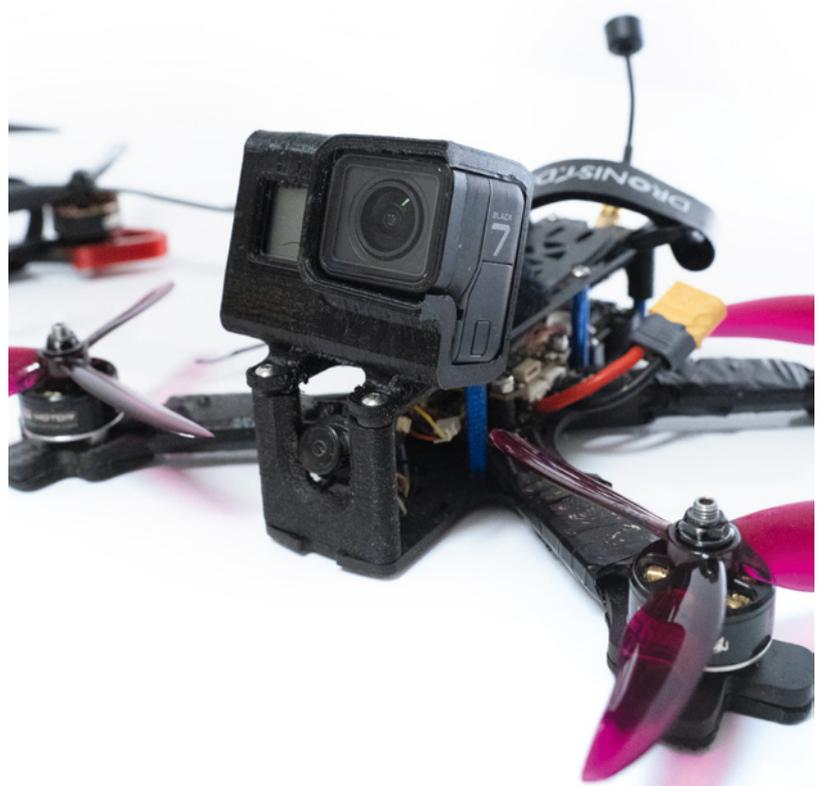
Bei FPV-Coptern wird viel flexibles TPU gedruckt. In diesem Fall sowohl die Halterung für die FPV-Kamera als auch die Halterung für die GoPro. Durch das flexible Material sitzt die Kamera straff in der Halterung
