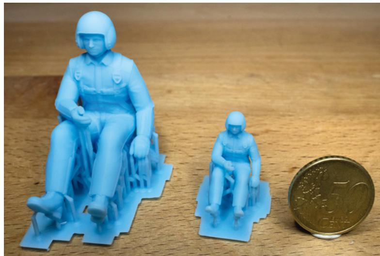
*Selbst bei sehr kleinen Modellen bleiben im MSLA-Verfahren viele Details erhalten. Diese beiden Piloten sitzen noch auf dem Support. Dieser wird am besten direkt nach dem Druck entfernt*
