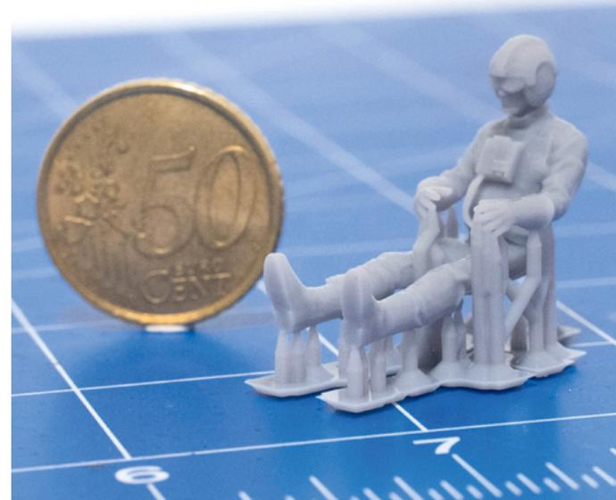
Die Stützen, auf denen dieser Pilot sitzt, sind die Supportgeometrien eines MSLA-Druckers. Diese müssen gewissenhaft platziert werden, um Fehlstellen am Modell möglichst zu vermeiden oder zu verstecken
