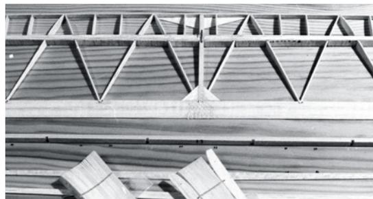
Nummer 17 und 18, F1A-Wettbewerbsmodelle von 1982/1984, waren die aufwändigsten Flugmodelle des Autors. Alle Holme waren nach außen hin verjüngt, kein Rippeneinschnitt gleich dem anderen. Wo immer sinnvoll, wurden Zwischenräume ausgekreuzt (Warren Truss), um besonders die Flügel verdrehsteif zu machen. Nachbauten des Modells schafften es zur WM
