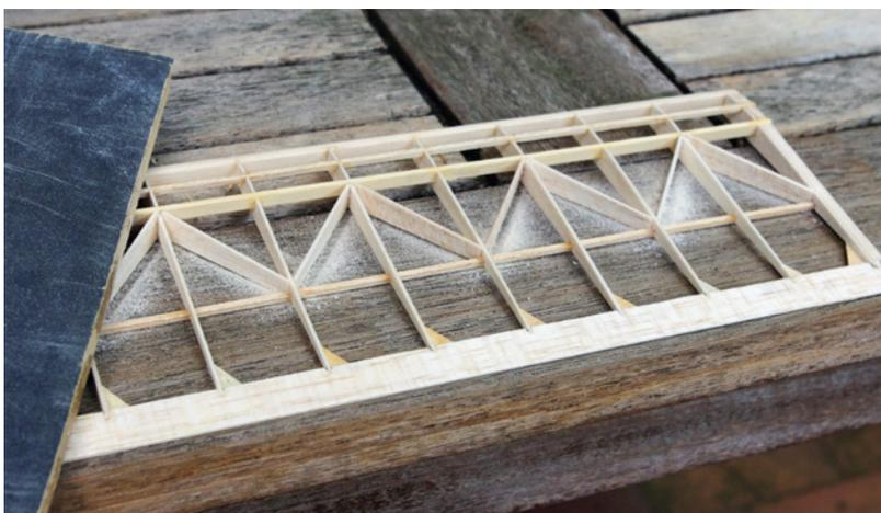
Leitwerke für Magnetsegler müssen mit ihrem Gewicht ausgleichen, wenn der Magnet vorne am Rumpfkopf einen großen Hebelarm braucht. Der von oben eingesetzte Hauptholm des Leitwerks ist aus Kiefer. Balsa-Auskreuzungen zwischen den Holmen werden als Rechtecke eingesetzt und auf Profil geschliffen
