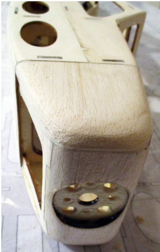
Der Motorspant musste später noch mit GFK verstärkt werden, da er zu schwach dimensioniert ist
