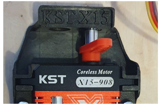
Die Servorahmen verfügen über Gegenlager, um die Servogetriebe zu entlasten
