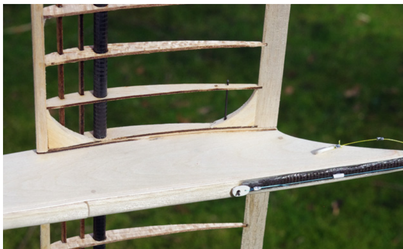
Die auslaufenden Sperrholz-Rumpfsseiten sollen Kerbbruch verhindern
