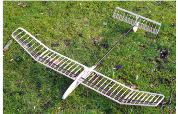
36-Zoll-Segler „Hi-Start“ mit RC-Empfänger für die Thermikbremse. Mit kleinen Plastikschrauben werden EWD, Hochstart und Flugkurve eingestellt
