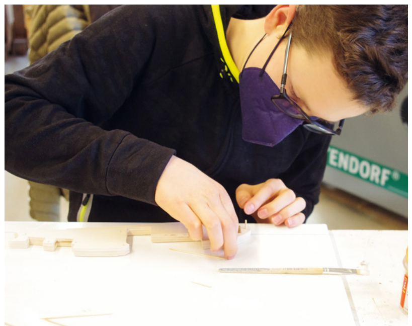
Pit und Tom Yo kleben Rumpfe ihrer „Klöve“-Schulmodelle. Zahnstocher in passgenau gebohrten Löchern verhindern, dass sich die drei Schichten gegeneinander verschieben
