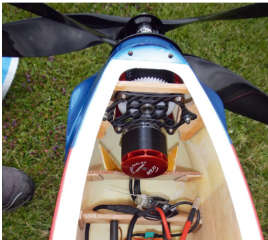
Ein Blick auf den gegenläufigen Antrieb Advrerrun
