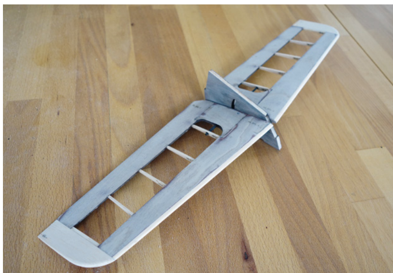
Das Pendelhöhenruder des Rock4K-X ist nahezu spielfrei innenseitig angelenkt
