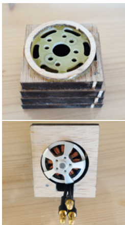
Der Außenläufer Joker verschwindet vollständig im Nasenblock des Rock4K-X
