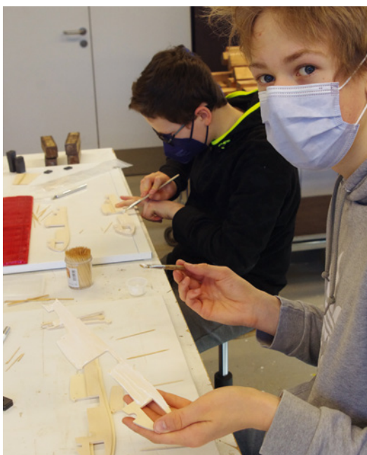
Pit und Tom Yo kleben Rumpfe ihrer „Klöve“-Schulmodelle. Zahnstocher in passgenau gebohrten Löchern verhindern, dass sich die drei Schichten gegeneinander verschieben
