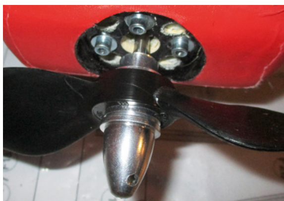
Die untere Motorgondelbeplankung wurde weggelassen und stattdessen ein Alugitter eingebaut. Das sorgt für gute Kühlung am Motor und Regler
