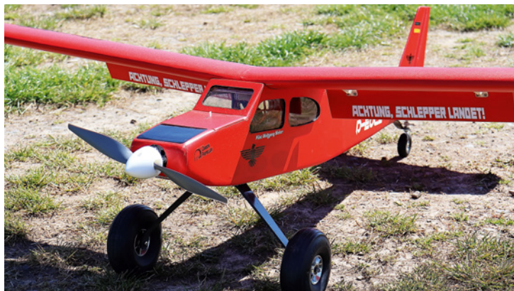
Die Landeklappen sind mit je zwei Scharnieren angeschlagen und können weit nach unten ausgefahren werden
