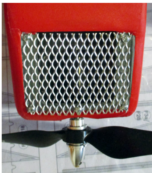
Die untere Motorgondelbeplankung wurde weggelassen und stattdessen ein Alugitter eingebaut. Das sorgt für gute Kühlung am Motor und Regler
