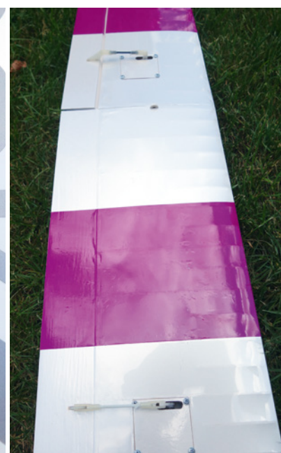
Die Wölbklappen des Rock4K-X sind oben angelenkt, im Gegensatz zum Modell von Höllein
