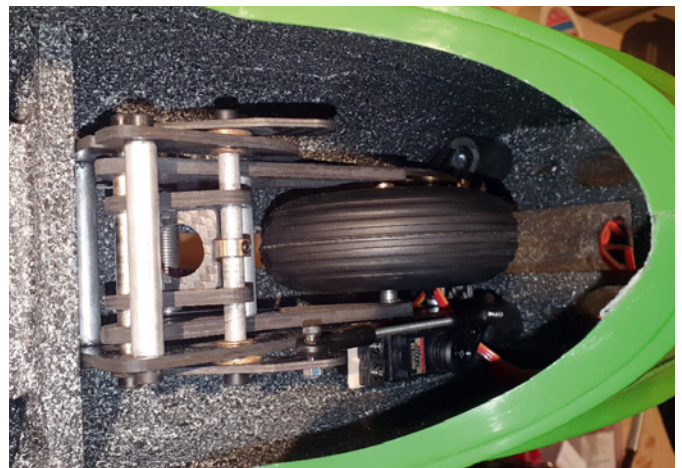
Das Einziehfahrwerk ist fertig eingebaut, der Innenraum wurde mit Effektlack verschönert
