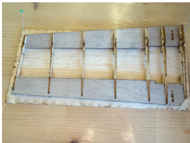
Höhen- und Seitenrunder des Rock4K-X sind profiliert und werden in einer Art Helling aufgebaut
