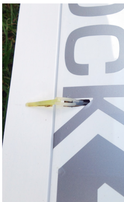
Die Wölbklappen des Rock4K-X sind oben angelenkt, im Gegensatz zum Modell von Höllein
