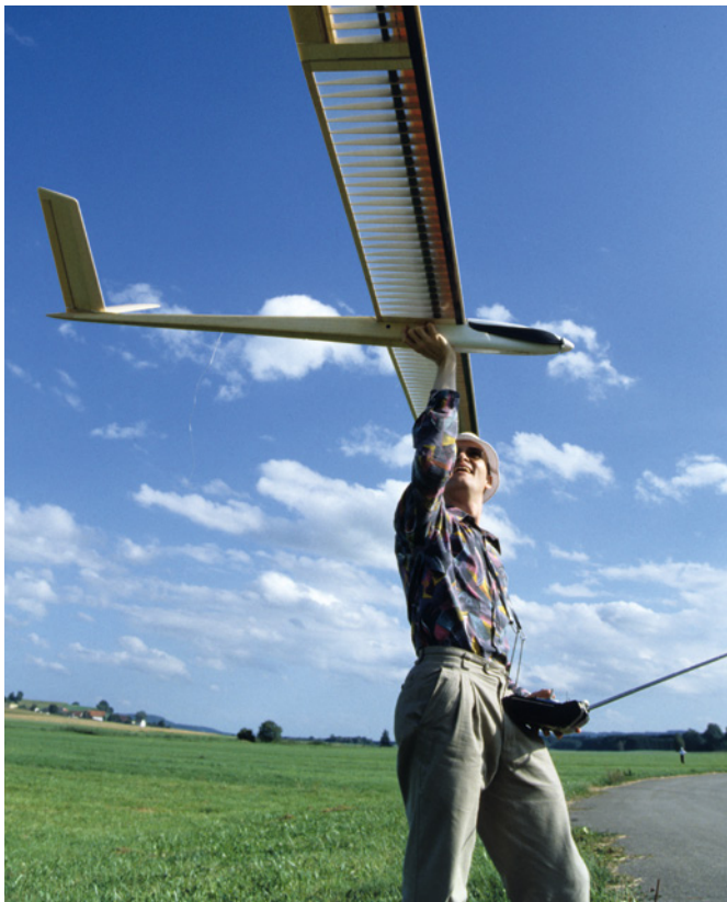
Die Holzbauweise, die schönen Rippenflügel, wurden durch GFK nicht verdrängt. Mit ihnen war ebenso Hochleistung möglich, wenn auch nach anderen Kriterien
