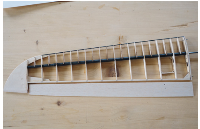
Der Slope Infusion geht beim Aufbau der Tragfläche einen anderen Weg. Hier übernimmt der Kohlefaserholm alle auftretenden Kräfte. Eine Beplankung ist nicht nötig
