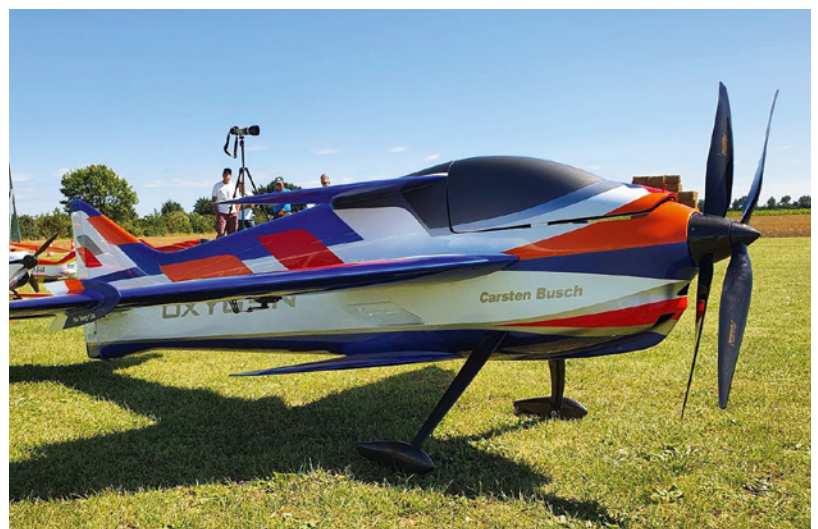
Die Oxygen von Carsten Busch hat einen typischen Antrieb mit zwei gegenläufigen Propellern
