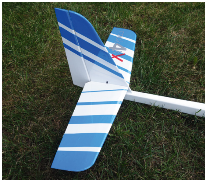
Profilierte Leitwerke beim Rock4K-X mit Pendelhöhenruder ...
