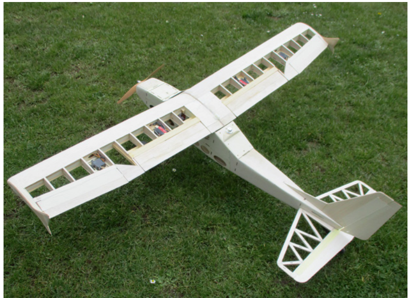
Am rohbaufertigen Charter kann man den Einbau der Klappen-Servos gut erkennen
