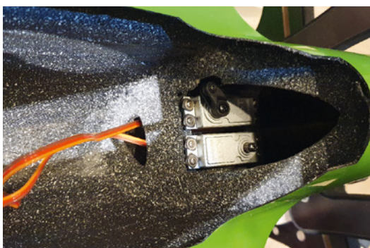
Die Leitwerksservos sitzen direkt hinter der Behausung des Impellers
