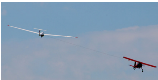
Das Segelflugzeug sollte immer etwas über der Schleppmaschine fliegen
