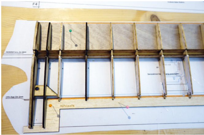
Die Tragfläche des Rock4K-X ist konventionell mit Holm, Verkastung und D-Box erstellt. Die Beplankung besteht aus sehr dünnem 0,4-mm-Sperrholz
