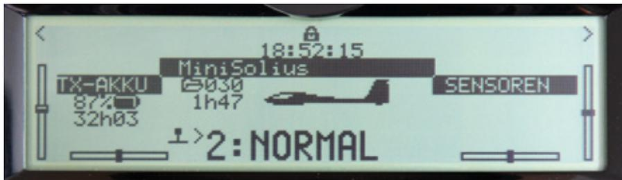
Das Hauptmenü zeigt links den Zustand des Senderakkus, in der Mitte wird das Modell samt Speichernummer und Betriebszeit angezeigt und links sind die beiden wichtigsten Sensorwerte, die Empfängerakkuspannung und der LQI zu sehen
