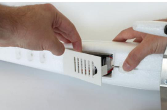
*Der 3s-Flugakku findet im Rumpfboden Platz und wird über eine arretierbare Klappe fixiert*
