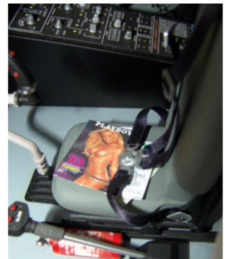
Blick ins vorbildgetreu gestaltete Cockpit. Der Instrumentenpilot sowie der Blendschutz und die Mittelkonsole wurden aus Holz gefertigt, das Instrumentenpanel besteht aus 0,5-Millimeter-Aluminium
