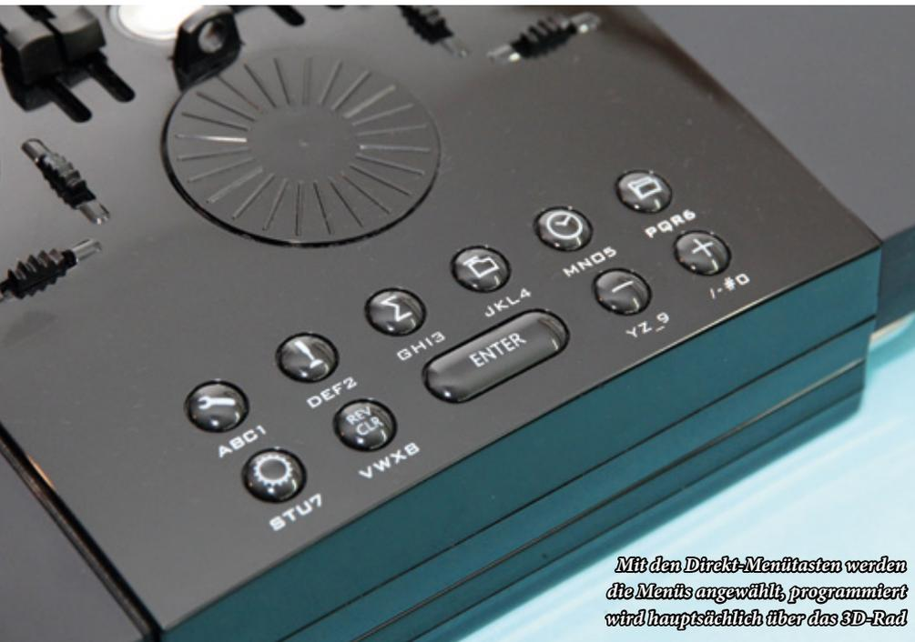
*Mit den Direkt-Menütasten werden die Menüs ausgewählt, programmiert wird hauptsächlich über das 3D-Rad*
