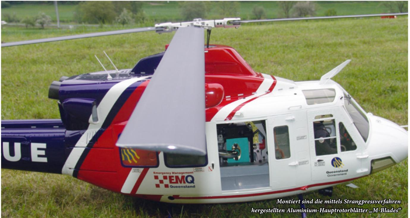
Montiert sind die mittels Strangpressverfahren hergestellten Aluminium-Hauptrotorblätter „M-Blades“
