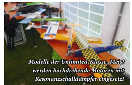
*Modelle der Unlimited-Klasse. Meist werden hochdrehende Motoren mit Resonanzschalldämpfer eingesetzt*
