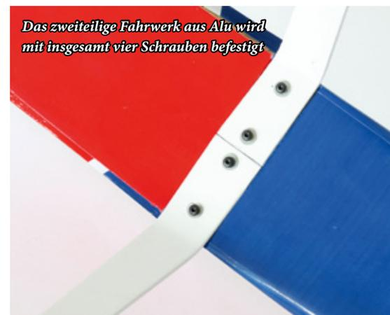
*Das zweiteilige Fahrwerk aus Alu wird mit insgesamt vier Schrauben befestigt*
