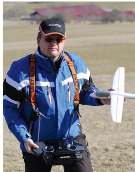
Der Sender ist in Verbindung mit dem Tragebügelssystem optimal ausbalanciert. Als ideale Ergänzung dazu gibt es einen Kreuztragegurt
