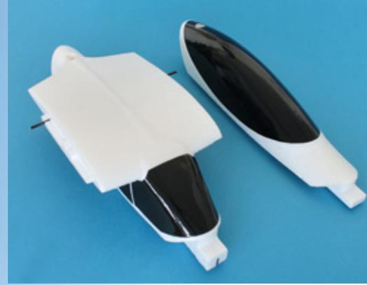
Innerhalb weniger Minuten kann man den Mini Switch von einem Hochdecker in einen Tiefdecker verwandeln. Dazu liegen verschiedene Rumpfabchlüsse bei
