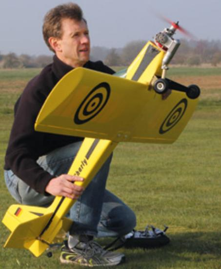
Ein gewohntes Bild für Verbrenner-Flieger: Das Modell wird vor dem Start bei Vollgas Richtung Himmel gehalten, um sicherzugehen, dass der Motor richtig läuft
