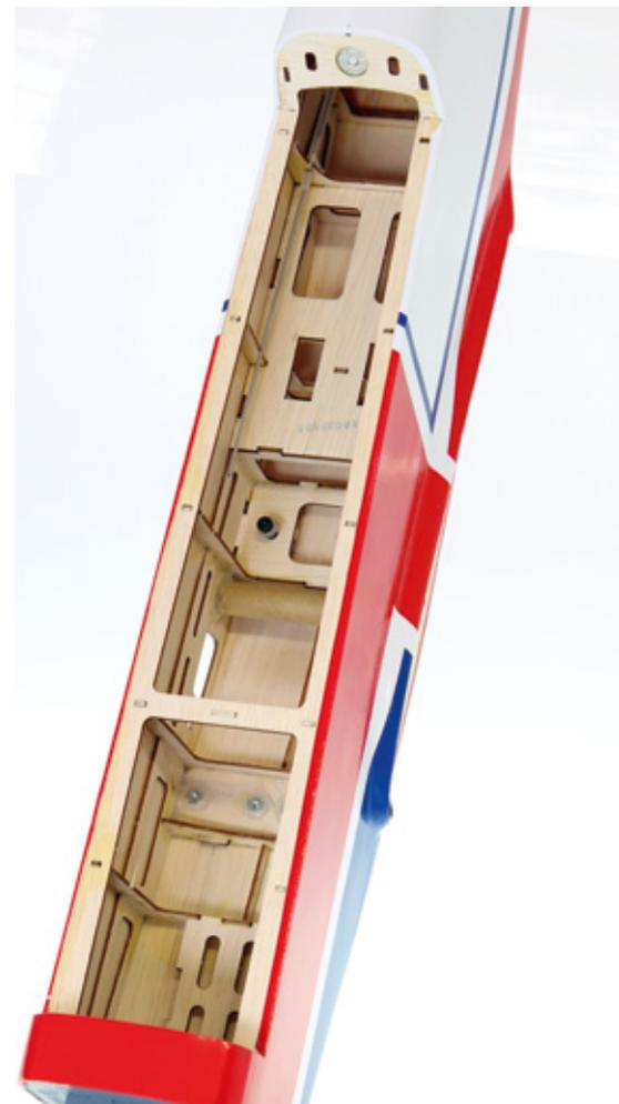
Blick in das Rumpfinnere offenbart eine durchdachte Konstruktion, größtenteils bestehend aus Balsaholz. Bis auf die tragenden Elemente, wie beispielsweise der Motorbereich, kommt kein Hartholz zum Einsatz. Das tut der Stabilität der Konstruktion jedoch
