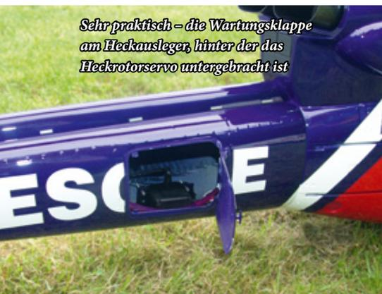
*Sehr praktisch – die Wartungsklappe am Heckausleger, hinter der das Heckrotorservo untergebracht ist*
