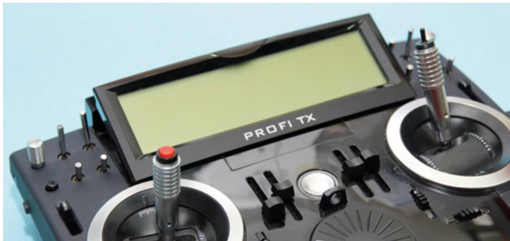
Das 5,8 Zoll breite LC-Display der Profi TX sitzt optimal ablesbar im vorderen Bereich des Senders und ist zudem noch schwenkbar gelagert
