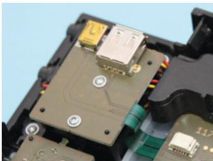
Über die USB-Schnittstelle wird der Sender geladen, es können Softwareupdates aufgespielt werden und selbstverständlich lassen sich auch die Modellspeicher am heimischen PC sichern. Auch im Simulatorbetrieb kommuniziert der Sender über USB mit dem PC
