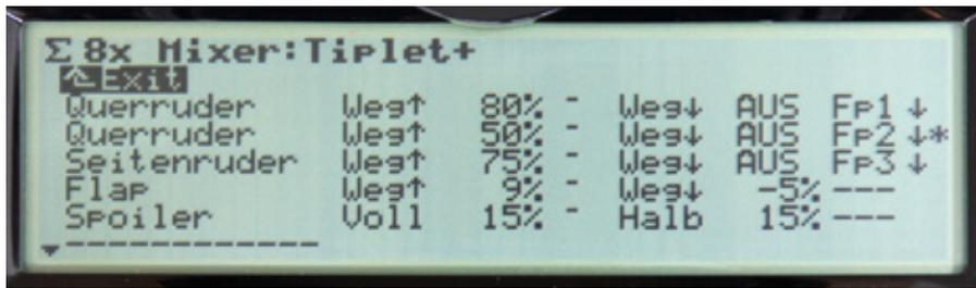
Hier werden die Mischanteile des Mixers „TIPILET“ programmiert. Die Buchstaben „Fp“ in der letzten Spalte sagen aus, dass die Mischanteile flugphasenspezifisch ein- und ausgeschaltet werden. In der Flugphase 3 werden die Tiplets zum Seitenruder zugemischt, um in der Thermikstellung flach kreisen zu können. In den Flugphasen 1 und 2 werden die Tiplets zu den Querrudern hinzu gemischt für schnelle Kurvenwechsel und Rollen
