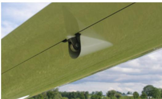
Der Querruderantrieb wird sehr schön durch eine aerodynamische Hutzte abgedeckt
