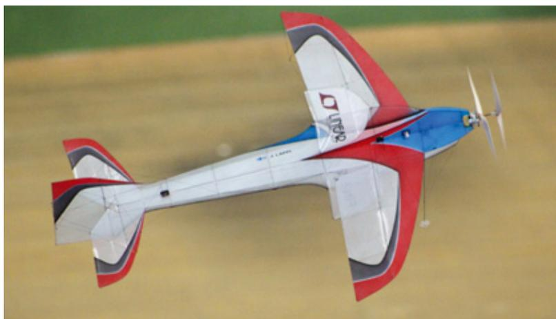
Das Modell von Janne Lappi in CFK-Folienbauweise ohne aerodynamische Hilfsflächen – sozusagen im ‚Clean‘-Design. Angetrieben von einem Coaxialsystem von Kimmo Kaukoranta
