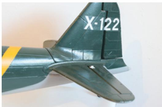
Das Leitwerk ist passgenau gefertigt und lässt sich gut mit dem Rumpf verbinden. Das Spornrad wird über das Seitenruder angelenkt
