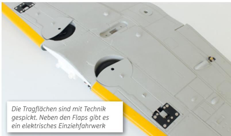
Die Tragflächen sind mit Technik gespickt. Neben den Flaps gibt es ein elektrisches Einziehfahrwerk
