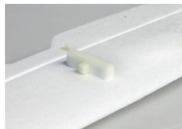
Nur einen einzigen Arbeitsschritt umfasst die Montage des Modells: das Höhenruder anschrauben und mit dem Bowdenzug verbinden
