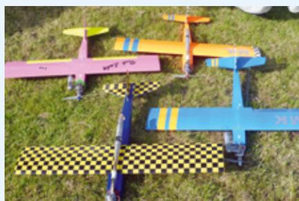
Vier typische Club-Pylon-Modelle. Die erkennbare Einfachheit der Gesamtkonstruktion ermöglicht auch Neulingen ohne großen Aufwand die Herstellung eines konkurrenzfähigen Modells
