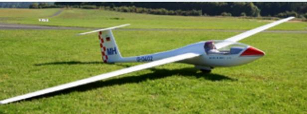
Mit 6.000 Millimeter Spannweite und ab 16 Kilogramm Gewicht gehört die neue **Astir CS-77** von MH-Flugmodellbau zu den ausgewachsenen Modellen.
