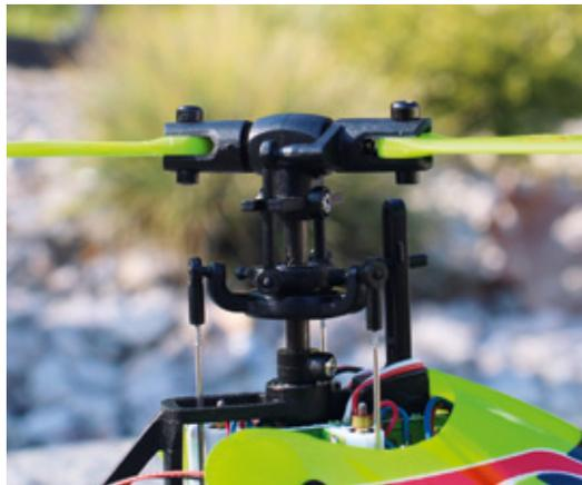
Der Kunststoff-Rotorkopf arbeitet sehr präzise und erlaubt somit ein sauberes Flugverhalten
