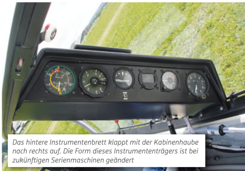
Das hintere Instrumentenbrett klappt mit der Kabinenhaube nach rechts auf. Die Form dieses Instrumententrägers ist bei zukünftigen Serienmaschinen geändert
