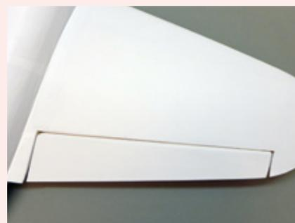
Sitzt alles korrekt, erfolgt die Verklebung mit ein paar Tropfen Sekundenkleber, die man direkt auf das Scharnier gibt
