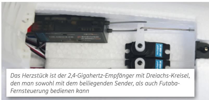
Das Herzstück ist der 2,4-Gigahertz-Empfänger mit Dreiachs-Kreisler, den man sowohl mit dem beiliegenden Sender, als auch Futaba-Fernsteuerung bedienen kann
