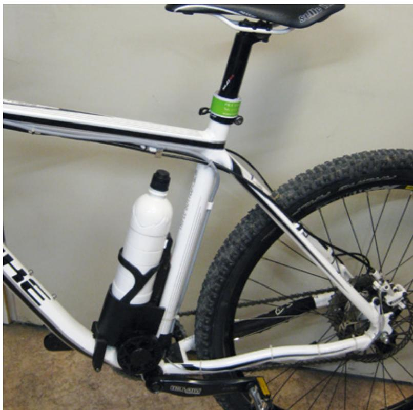
*Zu einem Pedelec umgebautes Mountain-Bike. Der Antrieb besteht aus Elektroflug-Komponenten. Der Akku (6s-6,6-Amperestunden-LiPo) versteckt sich in der Trinkflasche*
