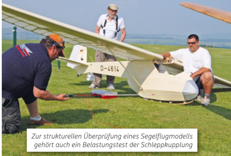
Zur strukturellen Überprüfung eines Segelflugmodells gehört auch ein Belastungstest der Schleppkupplung
