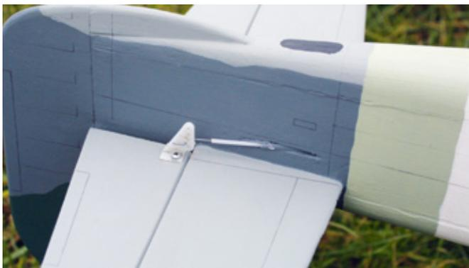
Die Enden der Rudergestänge möglichst kurz zu halten, ist genauso wichtig, wie solides Anlenkungsmaterial zu verwenden
