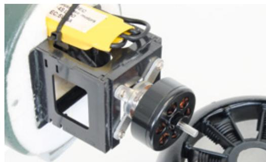
Unter der mit Magneten gehaltenen Cowling befinden sich der Brushlessmotor mit 1.000 kv sowie der 40-Ampere-Regler
