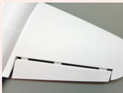
Hat man die Schlitz für die Scharniere in Ruder und Fläche eingebracht, kann es zur ersten Anprobe gehen
