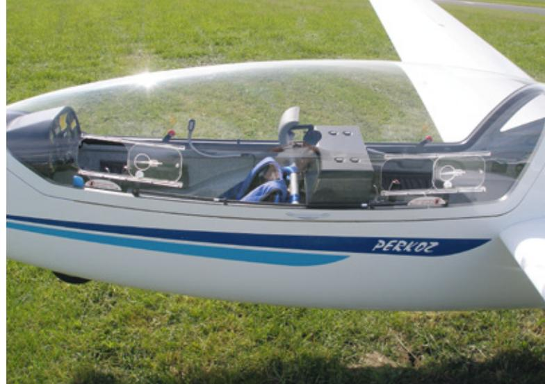
Links an der Kabinenhaube sind zwei kleine Schiebefenster angebracht. Ein Handgriff erleichtert das Öffnen der großen Haube
