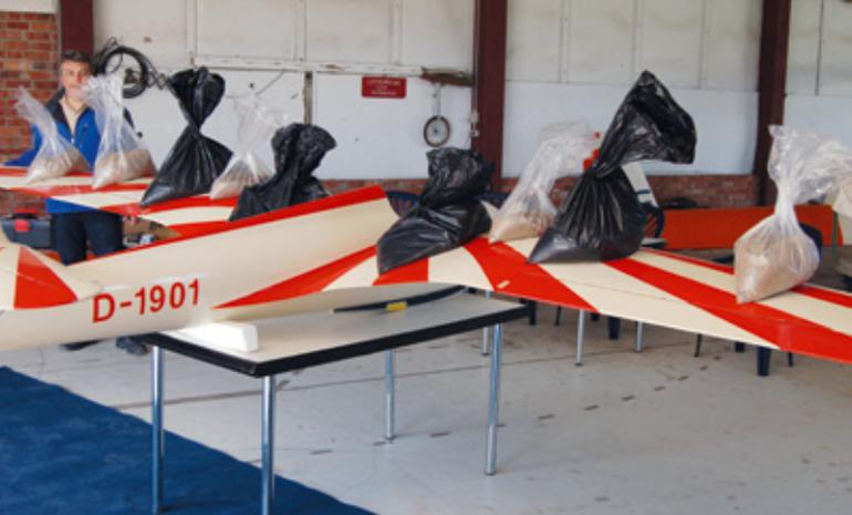
Ein Belastungstest bei einem Habicht mit dem vierfachen Modellgewicht in negativer Richtung
