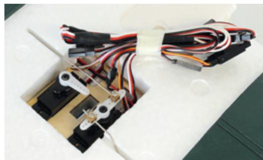
Eine Menge Kabel müssen bei der Montage der Tragfläche am Rumpf im Modell platziert werden. Um alle Funktionen des Modells nutzen zu können, ist wenigstens ein Siebenkanal-Empfänger erforderlich
