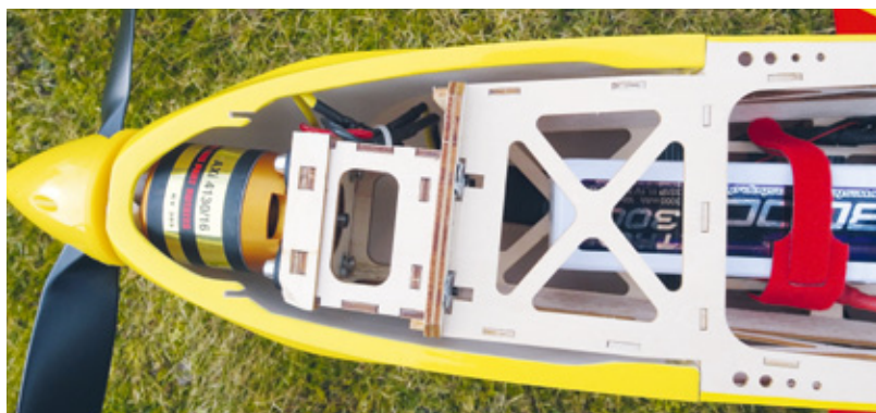
Motorzug und -sturz sind ab Werk korrekt vorgegeben
