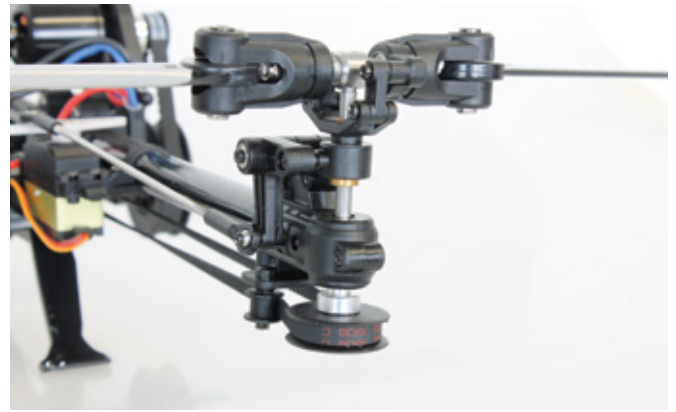
Die präzise gefertigten Rotormechaniken entsprechen der Bauweise von Heckrotoren
