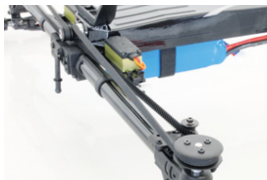
Die Antriebsriemen der Rotoren beschreiben auf ihrem Weg eine 90-Grad-Drehung
