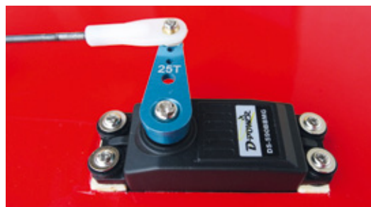
Damit die Querruderservos in die für sie vorgesehenen Aufnahmen passen, müssen zwei kleine Sperrholzplättchen mit einer Stärke von etwa 2 Millimetern untergelegt werden
