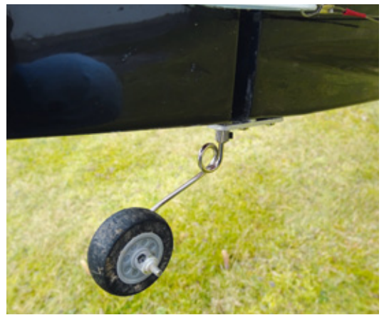
Das angelenkte Spornrad ist stabil ausgeführt und von entscheidender Bedeutung für die Manövrierfähigkeit der MythoS auf dem Rollfeld
