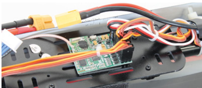
Dieser kleine Baustein ist nicht nur der Empfänger, sondern auch die Stabilisierungselektronik
