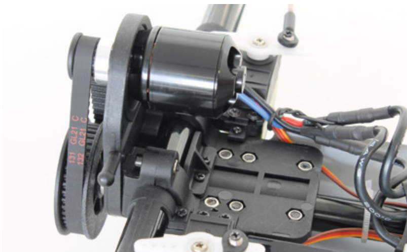
Formteile aus Spritzgusskunststoff verbinden das zentrale Alurohr mit den beiden Querrohren, die die Rotoren aufnehmen
