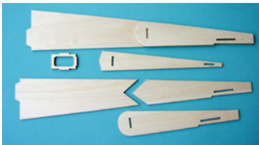
Die beiden hinteren Rumpfseiten werden aus jeweils drei Einzelteilen vorgefertigt
