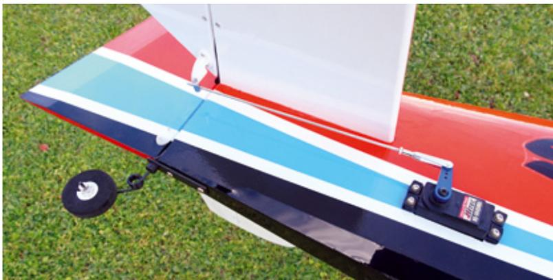
Das Leitwerk ist schnell fertiggestellt. Die Servos wurden später nach vorne in den Rumpf verlegt
