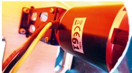
Der 410-kv-Motor von Ripmax sorgt mit der richtigen Luftschaube für reichlich Schub
