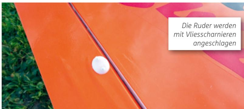
Die Ruder werden mit Vliesscharnieren angeschlagen
