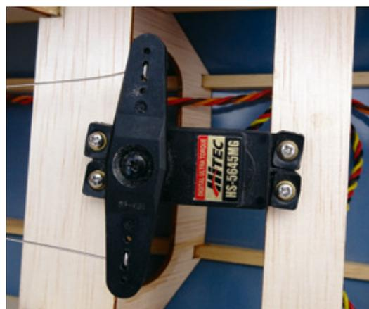
Dass das Seitenruderservo nach vorne in den Rumpf verlegt wurde, konnte leider auch nicht maßgeblich etwas am Gewicht des Trimmbleis unter der Motorhaube ändern
