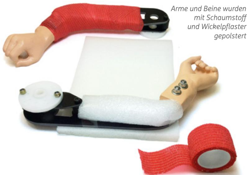
Arme und Beine wurden mit Schaumstoff und Wickelpflaster gepolstert
