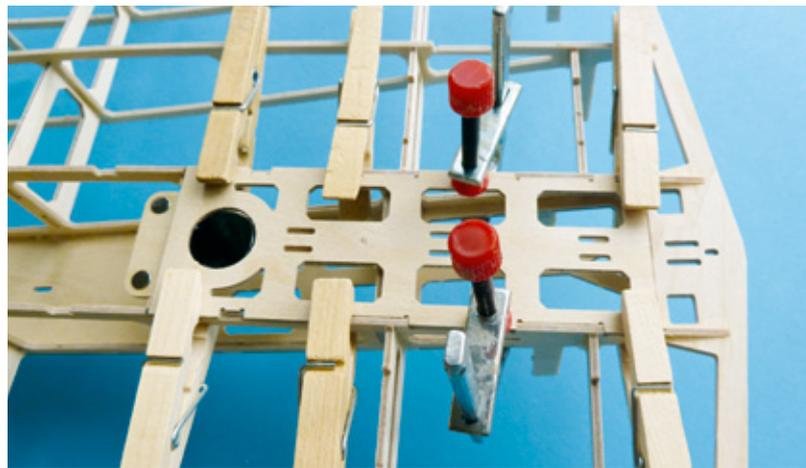
Das hintere Rumpfberteil mitsamt des Magnetverschlusses wird aufgeklebt
