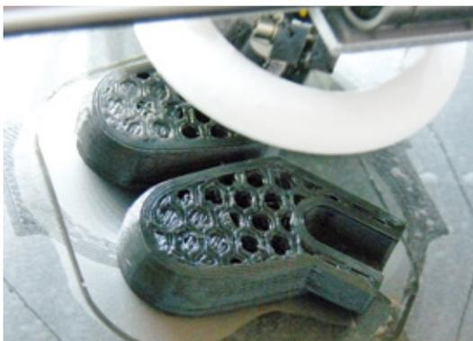
Neben der zur Materialverringern typischen Wabenstruktur im Inneren eines Bauteils kann man auch die geringe Schichtdicke von nur 0,2 Millimeter erkennen. Je feiner die Schichtdicke, desto besser kommen Details zutage, mit dem Nachteil einer mitunter erheblich längeren Druckzeit
