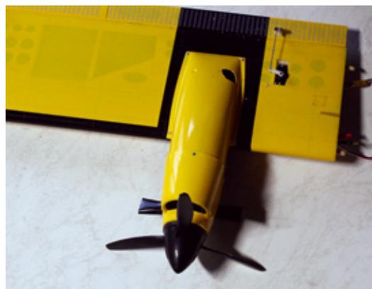
Fertig verbaute Motoreinheit mit verschraubter Abdeckung
