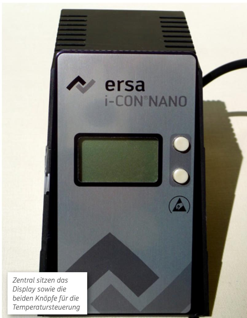
Zentral sitzen das Display sowie die beiden Knöpfe für die Temperatursteuerung
