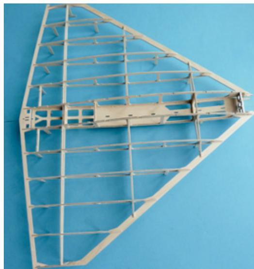
Nun sind alle Bauteile aufgesteckt und ausgerichtet. Es kann mit dem Kleben begonnen werden
