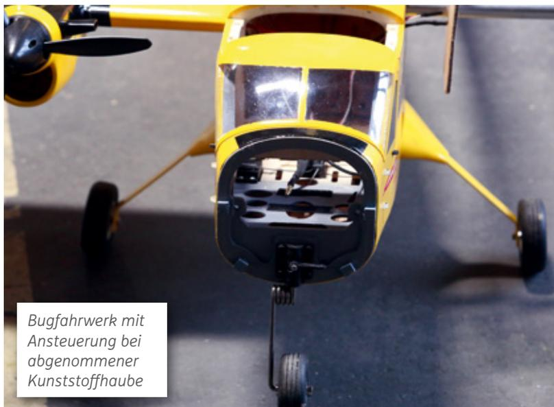
Bugfahrwerk mit Ansteuerung bei abgenommener Kunststoffhaube
