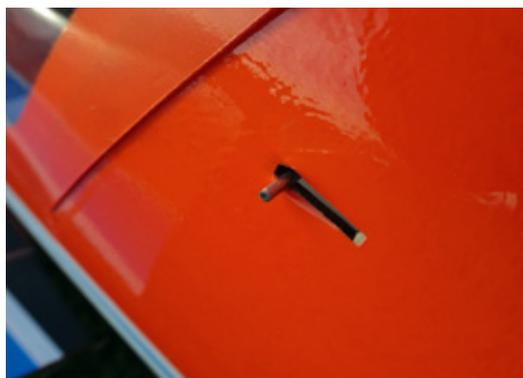
Die große Kabinenhaube wird vorne eingehängt und hinten mit Schiebeverschlüssen gesichert
