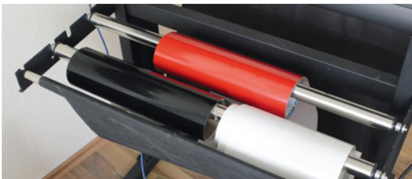
Auf der Rückseite des Plotter-Gestells lassen sich die Folienrollen bevorraten und von dort aus auch direkt dem Plotter zuführen
