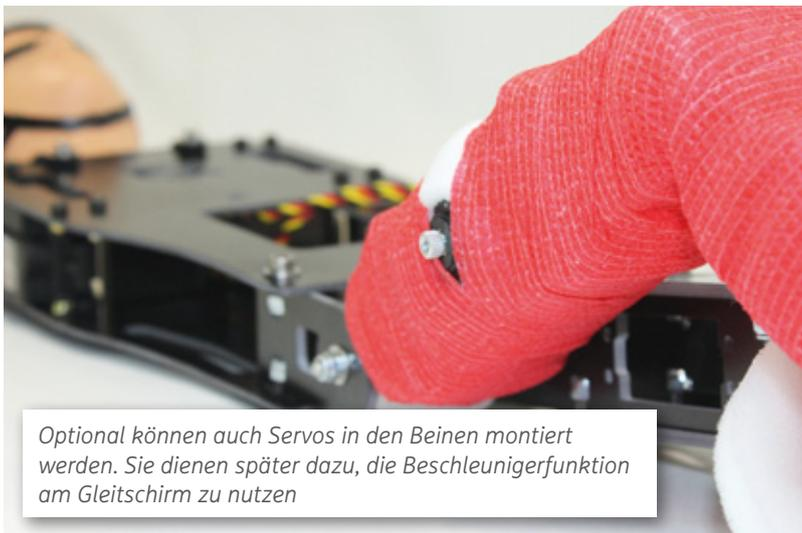
Optional können auch Servos in den Beinen montiert werden. Sie dienen später dazu, die Beschleunigerfunktion am Gleitschirm zu nutzen
