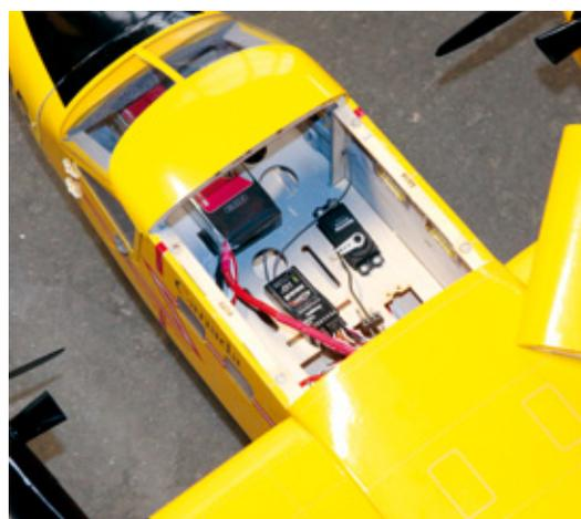
die breite Öffnung auf der Rumpfoberseite ist ideal zum Akkuwechsel. Die vier Magnete halten den Deckel optimal
