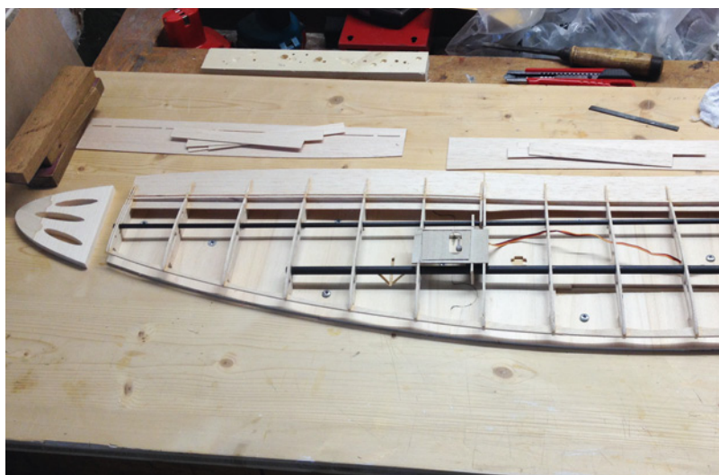
Ein Materialmix aus harten und weichen Hölzern sowie CFK sorgt für eine sehr stabile Konstruktion
