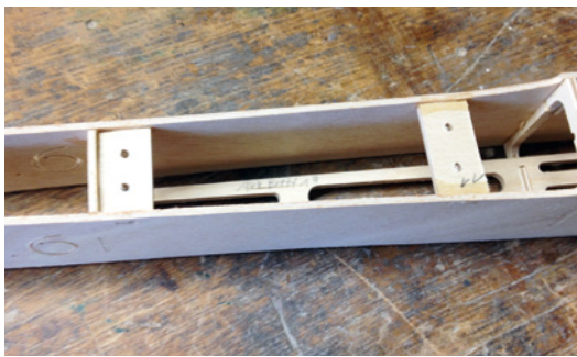
Unterhalb der Flächenaufnahme ist Platz für den Flugakku
