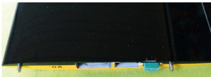
Dank der verklebten Multiplexstecker wird die Verbindung zwischen Rumpf und Flächen automatisch hergestellt
