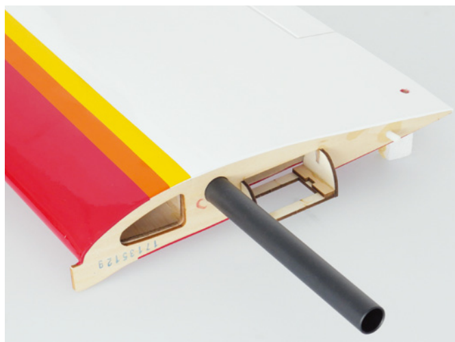
Beim Wot 4 Pro werden die Flächenhälften mit einem Holzverbinder verklebt, während beim Wot Trainer ein ummanteltes Alurohr zum Einsatz kommt. Die Fläche kann dadurch jederzeit getrennt werden
