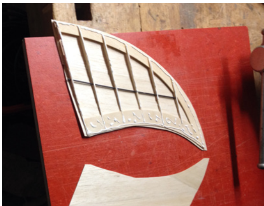
Das Seitenleitwerk sieht massiv aus, ist aber innen hohl
