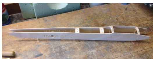
Der Rumpf entsteht in klassischer Spantenbauweise
