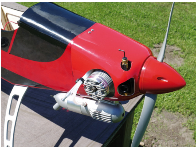
Der Irvine-Motor passt gut unter die Haube – sofern man sie sauber bearbeitet
