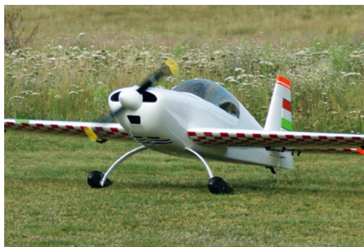
Gut zu sehen sind die großen Austrittsöffnungen für die Kühlluft unten in der Motorhaube
