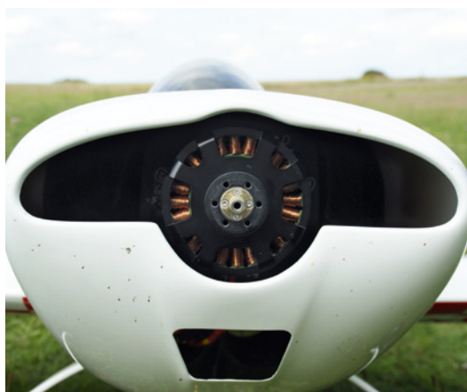
Unter der Haube ist viel Platz für vorbeiströmende Kühlluft. Entsprechende Öffnungen sind im Rumpf vorhanden
