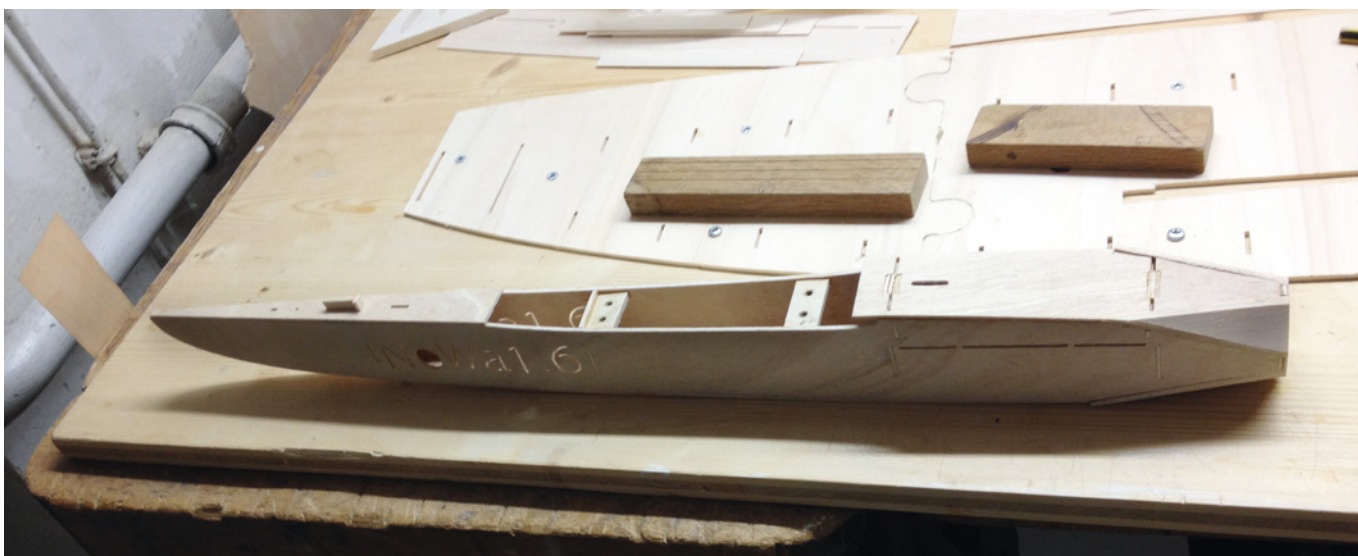
Wenn die letzten Beplankungsteile am Rumpf ausgehärtet sind, kann alles verschliffen werden
