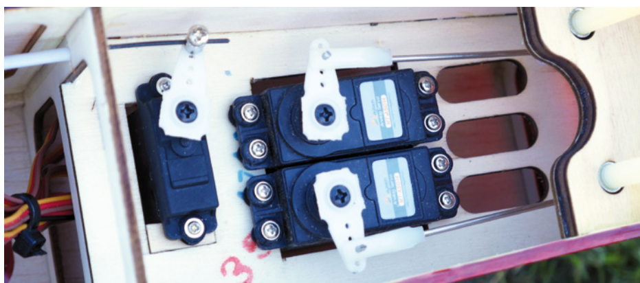
Ein Blick in den Rumpf des Verbrenner-Modells: Für die Betätigung der Gasdrossel reicht ein kleines Mini-Servo
