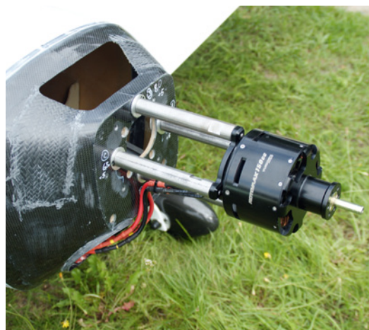
Der Motor hat eine Leistung von rund 500 Watt pro Kilogramm – mehr als genug
