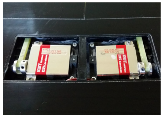
Pro Flächenhälfte kommen zwei Servos zum Einsatz. Beide sitzen jeweils direkt nebeneinander an der Trennstelle zwischen Quer- und Wölbklappe
