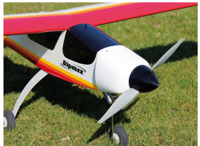
Der Spinner des Wot Trainer wirkt sehr wuchtig und eiert – man kann ihn auch einfach weglassen
