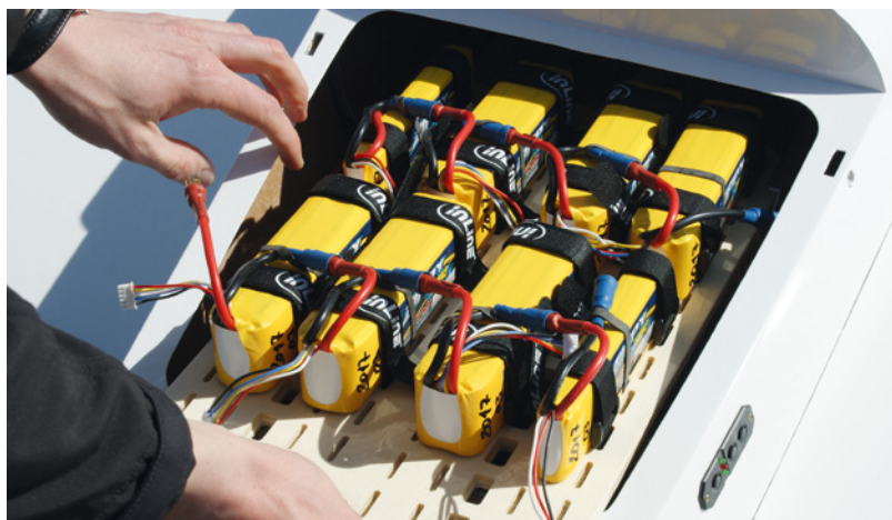
Zwei mal 14s-LiPos mit einer Kapazität von 5.000 Milliamperestunden sorgen für Flugzeiten von rund 8 Minuten
