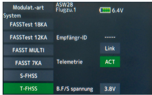
Entscheidend bei den Programmiermöglichkeiten der FX-36 ist die Modulationsart. Aufgrund der Futaba-typischen Vielfalt sind auch mehrere Modi möglich
