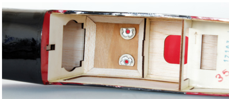
Im Bereich der Fahrwerksaufnahme ist der Rumpf des Verbrennermodells ordentlich verstärkt. Ansonsten wurde hier eher Wert auf Leichtbau gelegt
