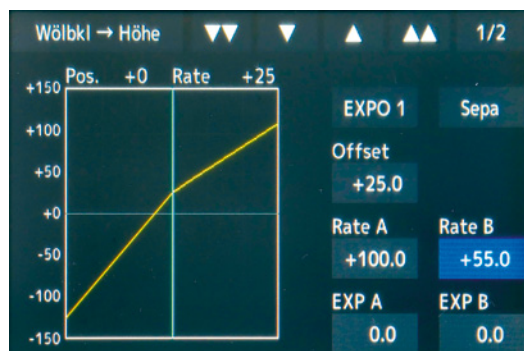
Ob Offset, unterschiedliche Ausschlagwerte, Mehrpunktkurve, Expo-Funktion oder vieles mehr – die FX-36 bietet etliche Einstelloptionen
