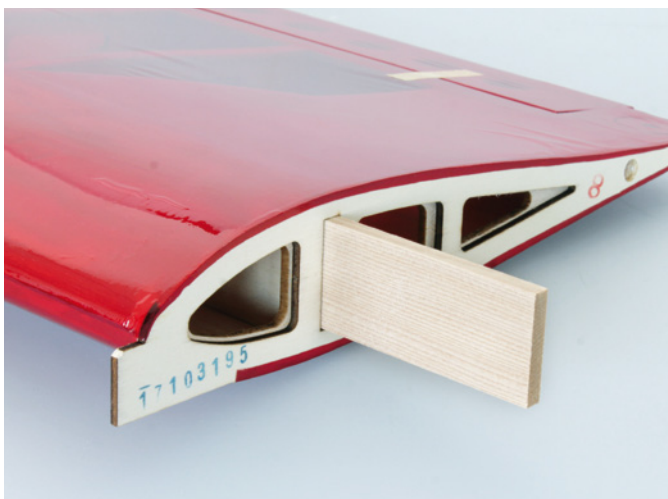
Beim Wot 4 Pro werden die Flächenhälften mit einem Holzverbinder verklebt, während beim Wot Trainer ein ummanteltes Alurohr zum Einsatz kommt. Die Fläche kann dadurch jederzeit getrennt werden
