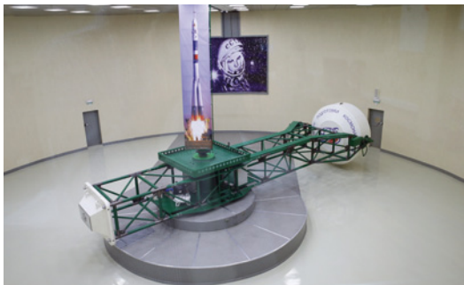
In der Zentrifuge werden die hohen G-Belastungen beim Start simuliert
