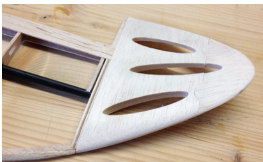
Aus zwei massiven Balsateilen entsteht jedes Flächenohr
