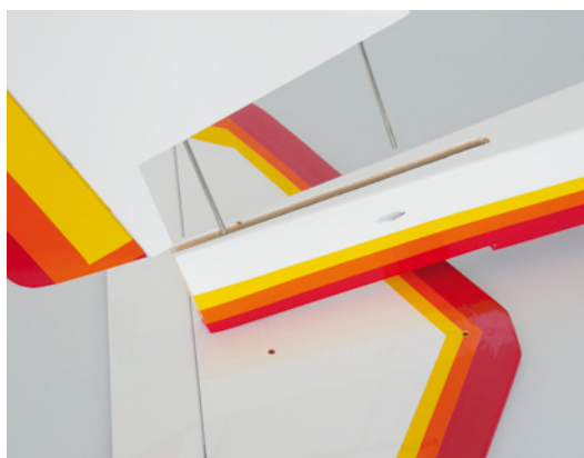
Das Leitwerk des Wot Trainer wird nur mit zwei Muttern zusammengehalten. Leider war das hintere Gewinde beim Testmodell beschädigt
