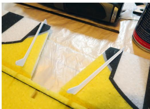
Die Ruderhörner für die unteren Querruder gehen über die volle Tiefe und haben die Mitnahme für die oberen Querruder gleich mit integriert
