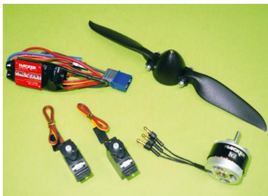
Zur Ansteuerung der Ruder kommen 9-Gramm-Servos zum Einsatz. Ein Außenläufermotor samt 22-Ampere-Regler und 8 × 6-Zoll-Luftschraube bildet den Antriebsstrang
