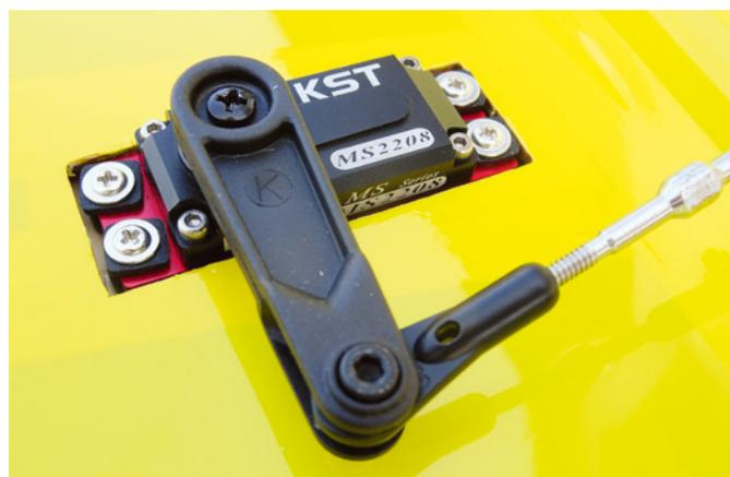
Die Kompatibilität zwischen den beiliegenden Anlenkungsgestängen und Servos lässt sich am praktikabelsten durch die leichten und stabilen Gabriel-Servohebel herstellen
