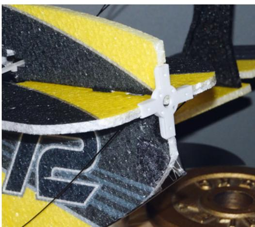
Die Motoraufnahme besteht aus einem Kunststoff-Spritzgussteil, das genau an die Rumpfnase passt
