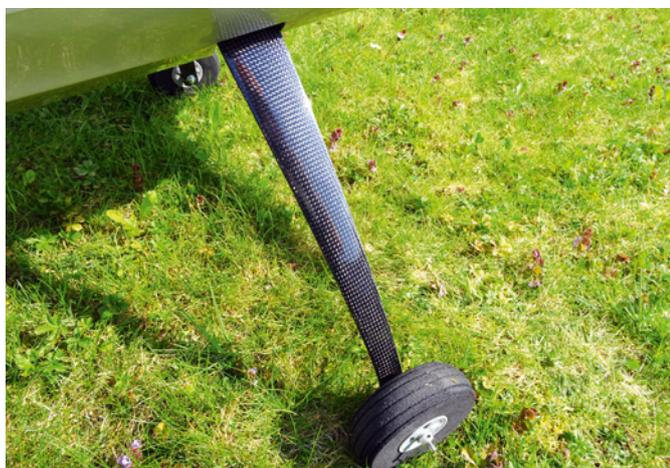
Das Elster-CFK-Fahrwerk bringt das Potenzial mit sich, gegenüber dem originalen Alu-Fahrwerksbügel auf unkomplizierte Weise gut 100 Gramm an Gewicht einzusparen
