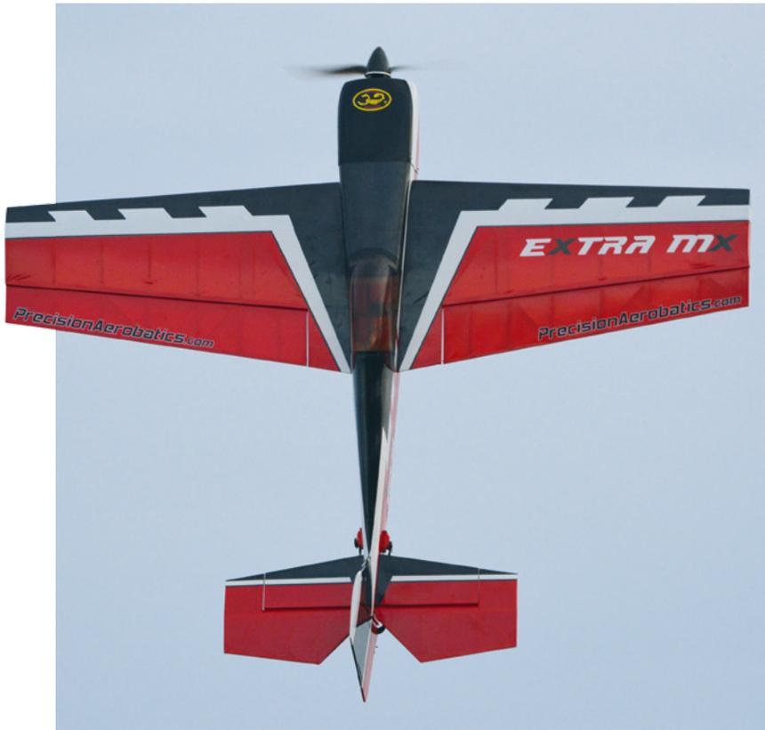
Eine klassische Flugfigur für Flugmodelle ist die Torque-Rolle. Theoretisch und unter Optimalbedingungen betrachtet, erzeugt der Motor in diesem Moment exakt so viel Schub wie das Flugzeug wiegt
