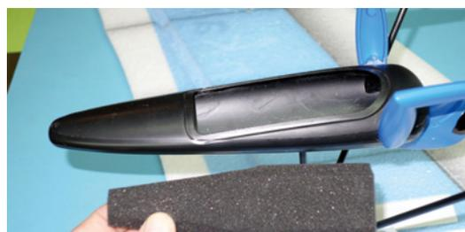
Den Antriebsakku kann man einfach mittels Schaumstoff im Pilotenbauch festklemmen
