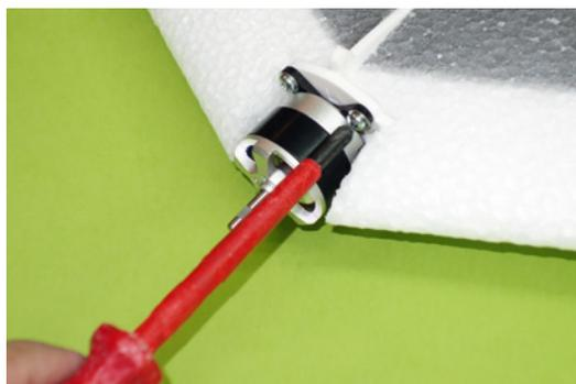
Der Motor wird mit vier Schrauben an seinem Spant befestigt
