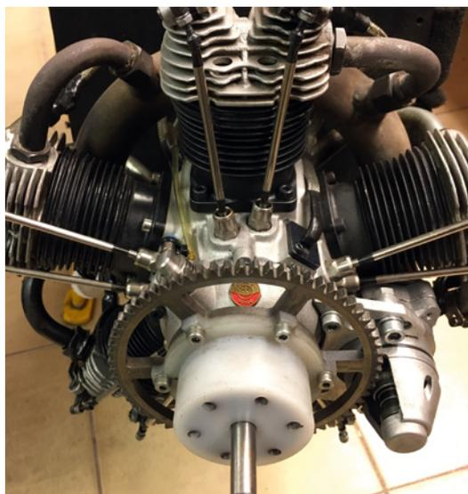
Der sogenannte Auswurfstarter ist in Ruheposition vom Zahnkranz auf der Kurbelwelle entkoppelt. Beim Startvorgang schnell das Starterritzel nach vorne und spurt in den Kranz ein. Läuft der Motor, wandert das Ritzel wieder zurück
