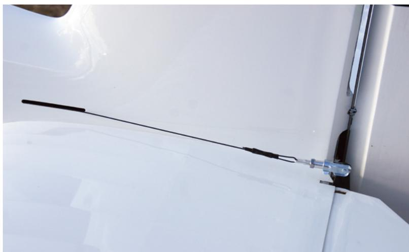
Leichte Stahlseile lenken die Leitwerksrudder an
