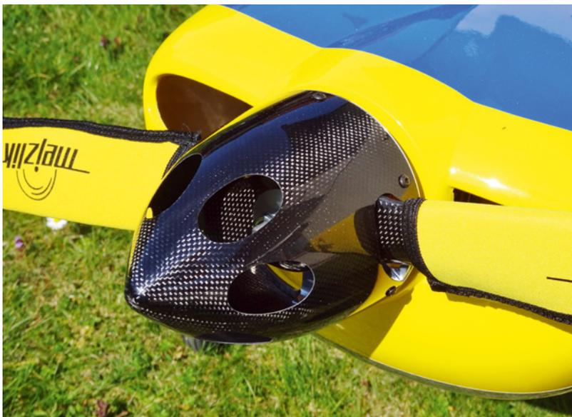
Der Mejzlik Cooling-Spinner ermöglicht das Optimum an Leistung aus dem Antriebssetup herauszukitzeln
