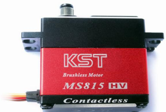
An den beiden Höhenrudern arbeitet jeweils ein KST MS 815-Servo, das an 8,4 Volt über eine Stellkraft von 22 Kilogramm bei 0,07 Sekunden Stellzeit verfügt
