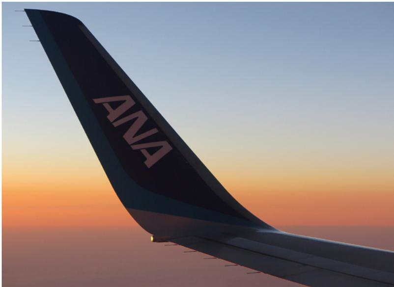
Mehr Leistung bedeutet auch mehr Sprit- beziehungsweise Stromverbrauch. In der Großfliegerei versuchen die Hersteller daher zum Beispiel mit solchen Winglets, den Widerstand zu minimieren, wodurch auch weniger Leistung nötig ist
