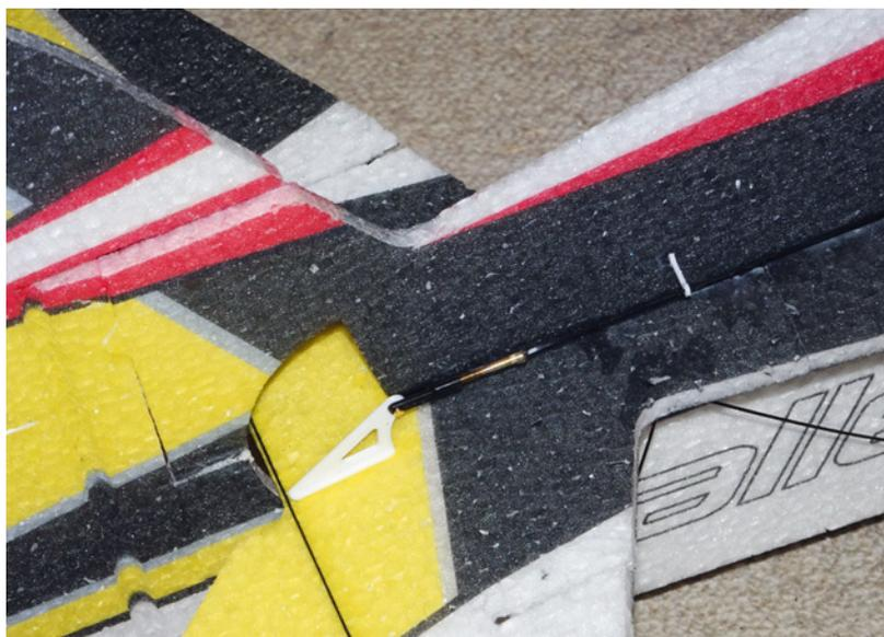
Das Höhenruder wird mit einer Schubstange angelenkt
