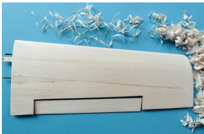
Bei der Fläche kommt einiges an Hobelspänen zusammen, bis Nasenleiste und Randbögen in Form gebracht wurden
