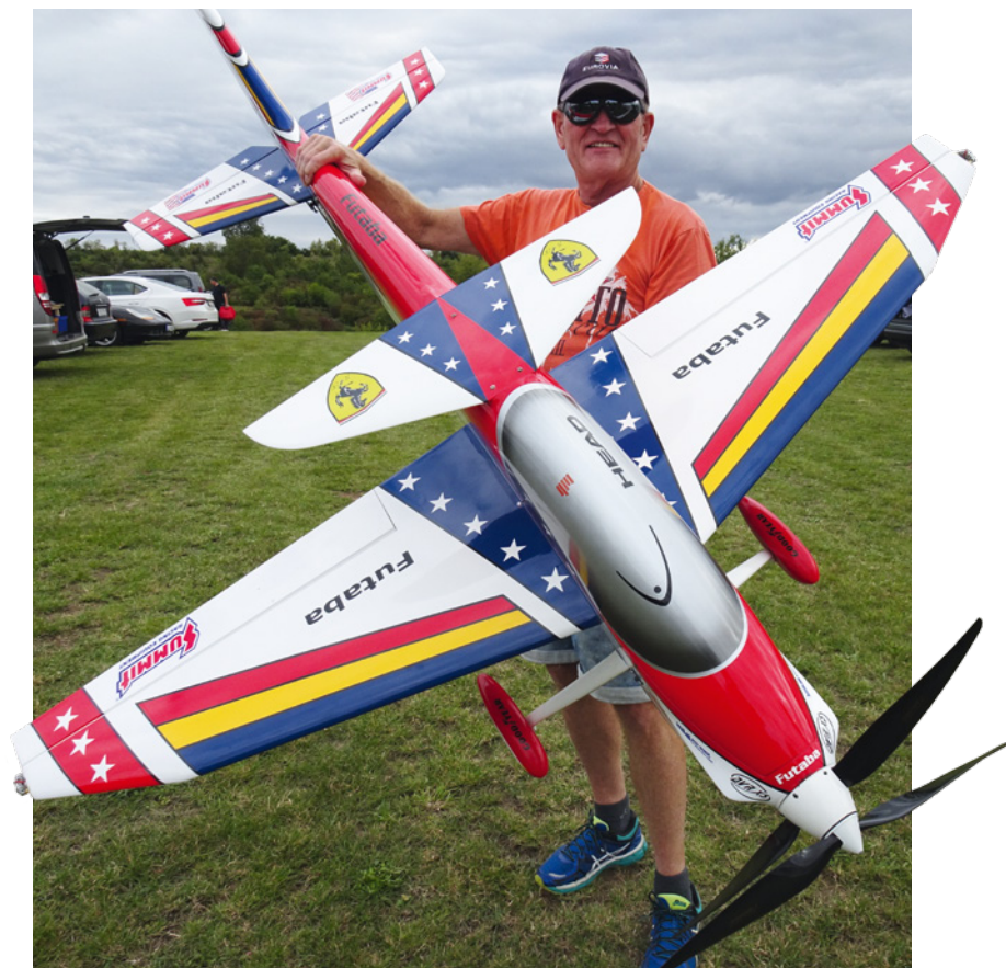
Am Modell „Element“ von Reinhard Bockholt kann man sehr gut die moderne Auslegung des Modells sehen: hohes Rumpfvolumen, Canalyzer, Kontra-Drive-Antrieb
