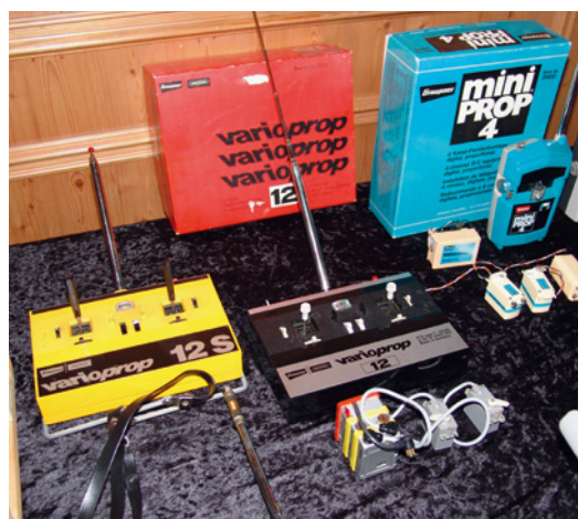
Diese RC-Anlagen kennen viele Modellflieger: die Graupner/Grundig Varioprop schwarz (1969) und gelb (1973). Sie waren die ersten bezahlbaren Großserienfernsteuerungen und ab 1975 für das damals neue 35-Megahertz-Band erhältlich. Die kleine, blaue Mini-prop 4 als Einsteigeranlage bot zwei proportionale Steuerfunktionen
