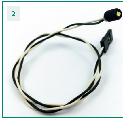
1. Der kompakte Expander macht aus einem SLC-Ausgang zwei. Die können dann jedoch nur gleich angesteuert werden. 2. Die 5-Millimeter-LED sind extrem hell und haben ab Werk ein 30-Zentimeter-Kabel. 3. Über die USB-Buchse wird der Light Driver programmiert. Beim LD5.0 kann man entscheiden, ob er seinen Strom direkt vom Empfänger oder über eine externe Stromquelle erhalten soll
