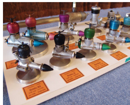
Dieselmotoren waren der Standardantrieb in den 1950er- und 1960er-Jahren für Flugmodelle. Hier ein Ausschnitt von Graupners Taifun-Serie. Mit der Kompressionschraube am Kopf wurde der Zündzeitpunkt des ätherhaltigen Treibstoffs eingestellt
