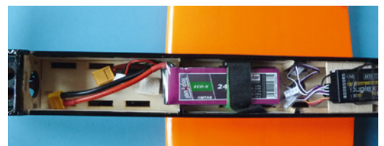
Der Regler ist beim Testmodell unter dem Zwischenboden platziert, wo er durch eine zusätzliche Öffnung auch gut gekühlt wird
