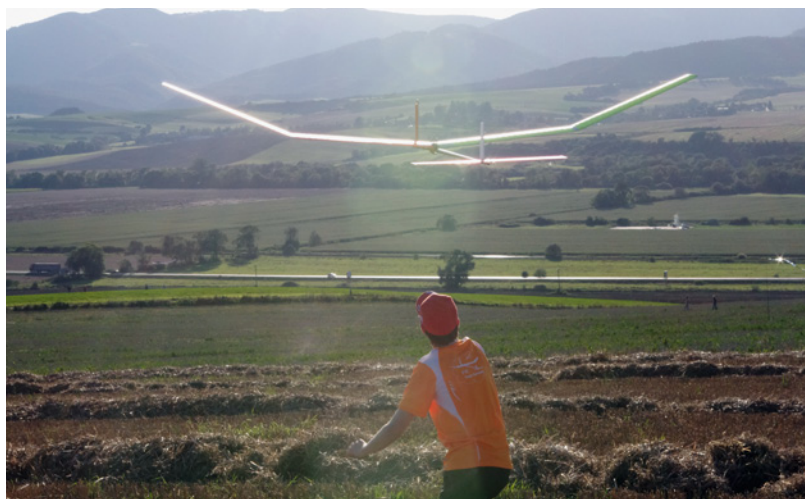
WM-Zweiter Florian Winker mit F1E und großer dreifacher V-Form, die Richtung steuert ein Magnet über ein Kopfruder
