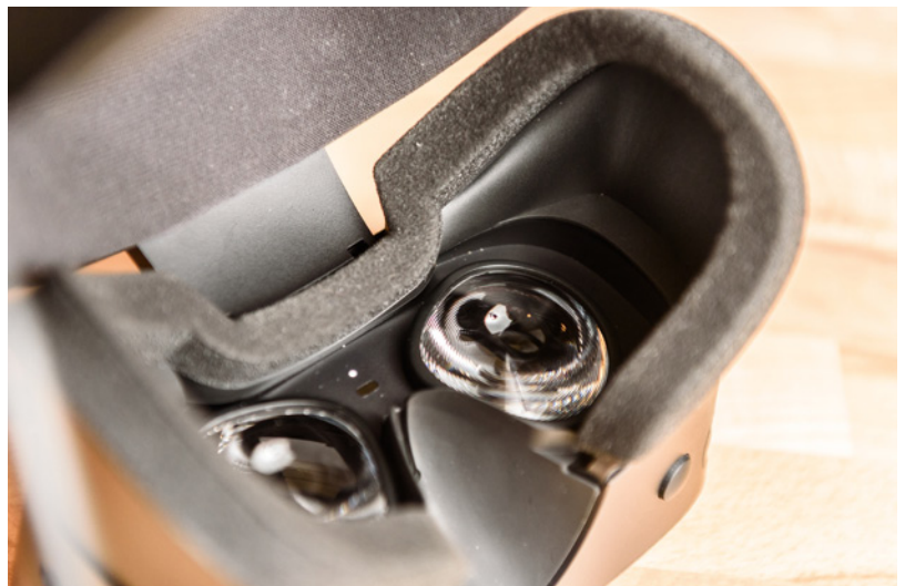
In der Brille sind – je nach Modell – ein oder zwei Displays verbaut. Linsen sorgen dafür, dass die Augen auf die kurze Distanz scharf stellen können
