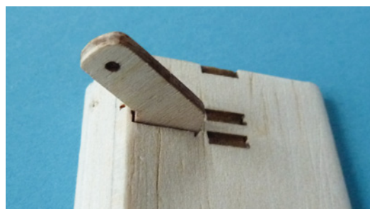
Das Ruderhorn wird an der Unterseite des Querruders zwischen zwei Rippchen eingeklebt
