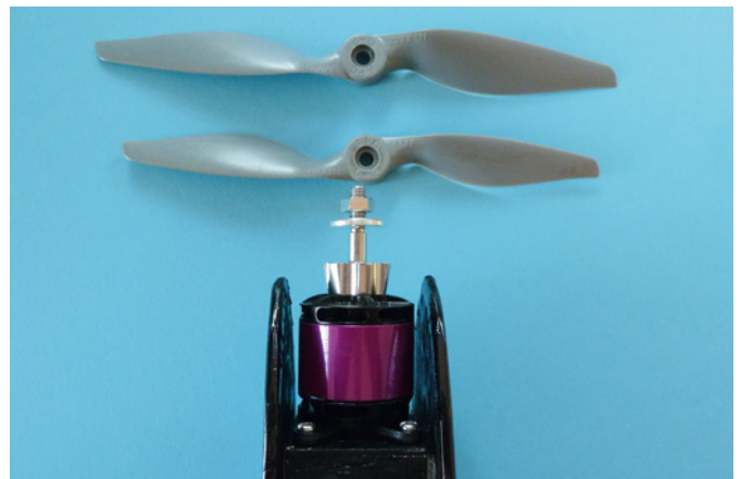
Der Motor an seinem Arbeitsplatz in der Rumpfspitze, davor die bei den Testflügen verwendeten Luftschauben mit 9 x 7,5 und 8 x 8 Zoll
