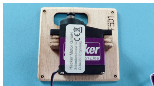
Die Hacker DiteX-Servos passen saugend zwischen die Befestigungspunkte
