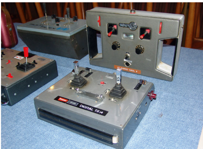
Mit fast 2.000,- D-Mark Kaufpreis waren diese beiden Highend-Anlagen nahezu unerschwinglich: die amplitudenmodulierte Simprop Digi 4 (1966) und die Graupner/Grundig Digital TX14 (1967). Die Bezeichnung „digital“ hat jedoch nichts mit dem heute darunter zu verstehenden Begriff zu tun
