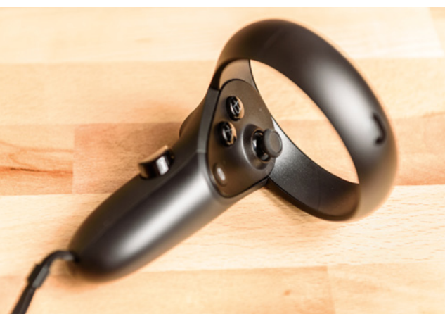
Zwei solcher Controller dienen zum Greifen, Klicken und Bewegen in der Virtual Reality. Bei den getesteten Modellflugsimulatoren fehlt jedoch leider noch die Anbindung
