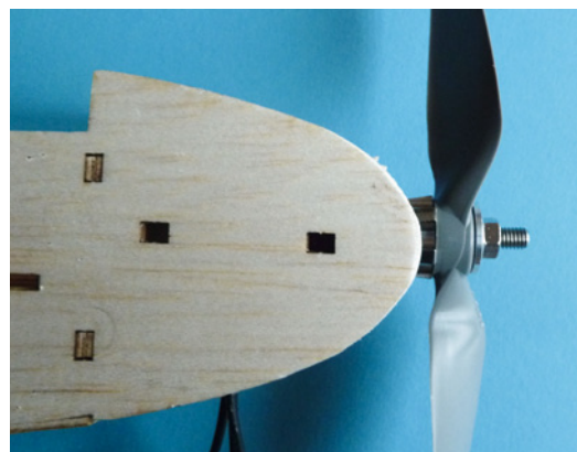
Die Seitenteile müssen für den Einsatz des Elektromotors etwas gekürzt werden – so sieht es dann aus
