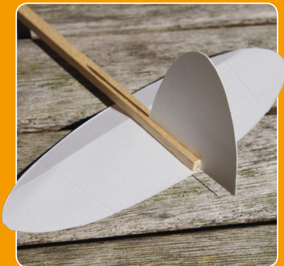
Durch Verbiegen der Höhenleitwerksvorderkante kann man die EWD beeinflussen und damit das Modell für guten Geradeausflug austrimmen
