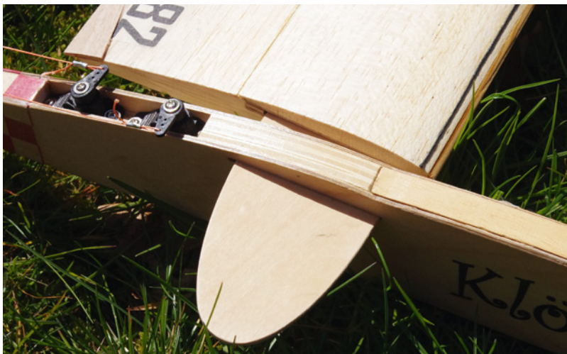
Flügelsteckung mit Sperrholzzunge beim Schulmodell „Klöve“
