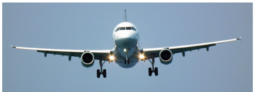
Der Airbus A 320 hat trotz Querrudern eine auffällige V-Form
