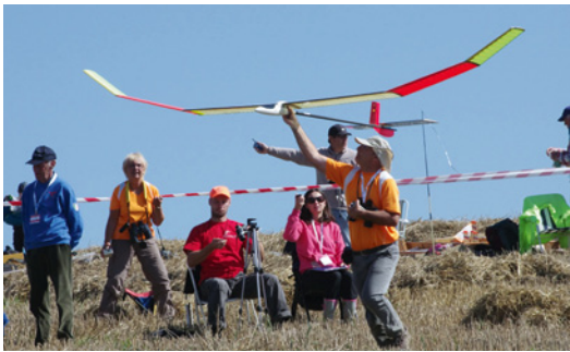
Freifliegendes Hangflugmodell F1E mit elektronischer Richtungssteuerung von Werner Ackermann – V-Form für Geradeausflug
