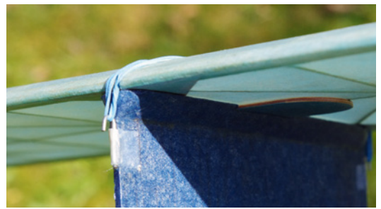
Gummibefestigung des Flügels bei einem kleinen RC-Motorsegler
