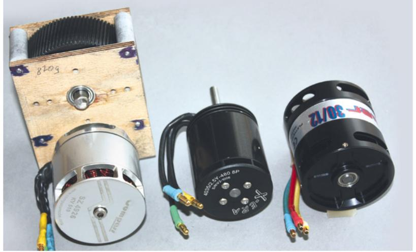
Ursprünglich für große Helis konzipierte Maschinen eignen sich bei entsprechender Getriebeuntersetzung auch für den Antrieb großer Flächenmodelle (Second Life)
