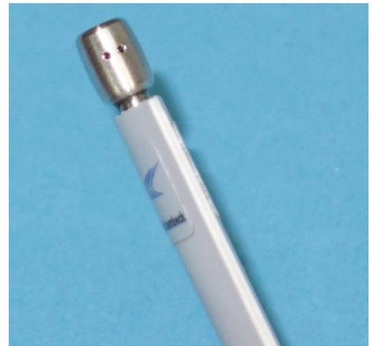
Die TEK-Sport-Aero-Düse besitzt auf der Rückseite zwei Kompensationsbohrungen
