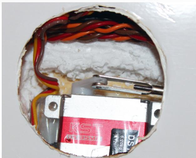
Die KST-Landeklappenservos wurden einfach mit Schrumpfschlauch eingeschumpft und in der Tragfläche verklebt
