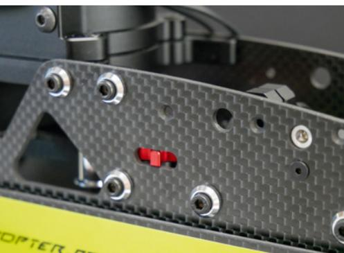
Eine kleine Öffnung im Chassis ermöglicht eine schnelle Kontrolle der Spannung des Antriebsriemens
