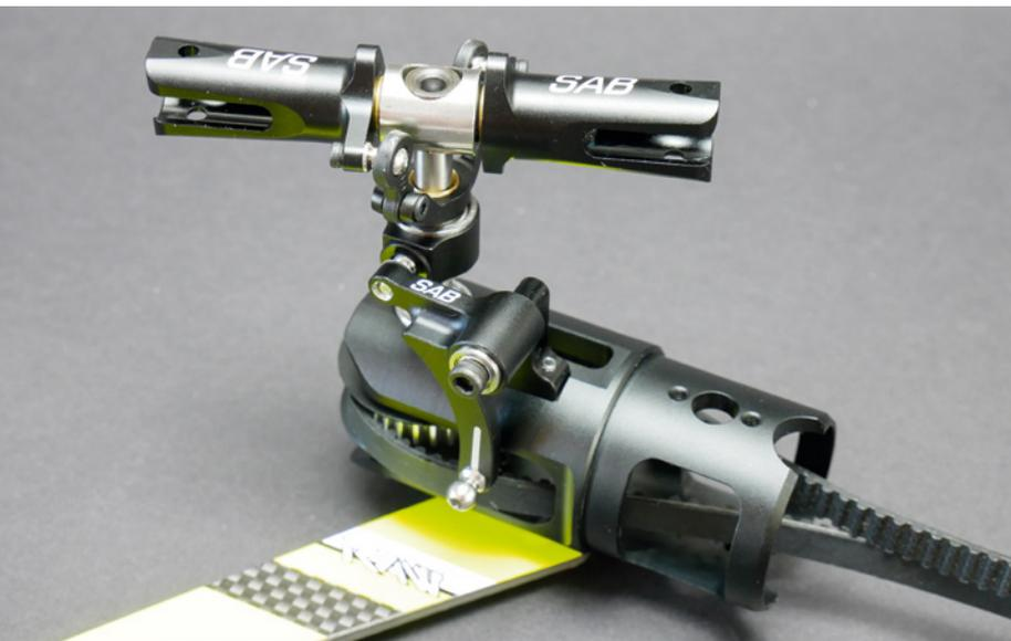
*Auch der Heckrotor musste an die neuen Gegebenheiten des Heckrohrs angepasst werden*
