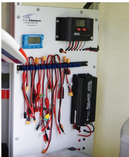
An der Elektrozentrale können nicht nur Akkus geladen, sondern auch 230-Volt-Verbraucher autark angeschlossen werden
