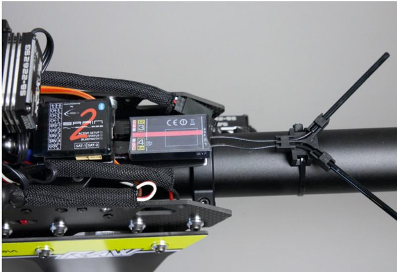
Das MSH Brain-Flybarless-System und der Empfänger befinden sich an gewohnter Stelle hinter dem Hauptrotor
