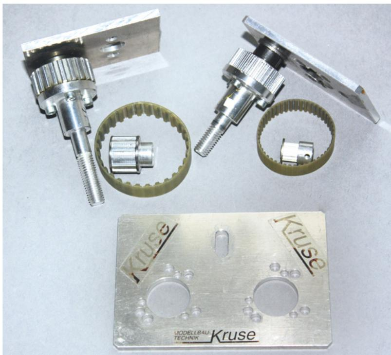
Linkes Bild: Das Introgear aus den 1990er Jahren – heute wohl nur wenigen noch ein Begriff. Rechtes Bild: Kruse-Getriebe halfen vor mehr als 20 Jahren schon, drehmomentschwache, kohlekommutierte Motoren mit großen Propellern zu versöhnen. Es gab auch Doppelmotorlösungen (rechts unten). Das Langloch war zur Anpassung an die verfügbare Riemenlänge gut
