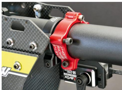
Die praktische Einstellhilfe (rot) erlaubt ein stufenloses Justieren der Heckriemenspannung
