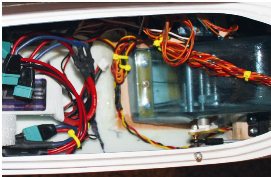
Im vorderen Bereich sind das Schleppkupplungs servo und das Trimmblei untergebracht
