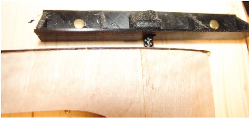
Der Rohrholm kann einfach durch den selbst hergestellten Wurzelrippenhalter gesteckt werden und so ist die Tragfläche direkt sicher fixiert
