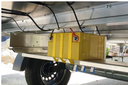
Eine Batterie ist schwerpunktgünstig tief platziert. Sie sorgt in Verbindung mit der Photovoltaik-Anlage für Strom im Anhänger
