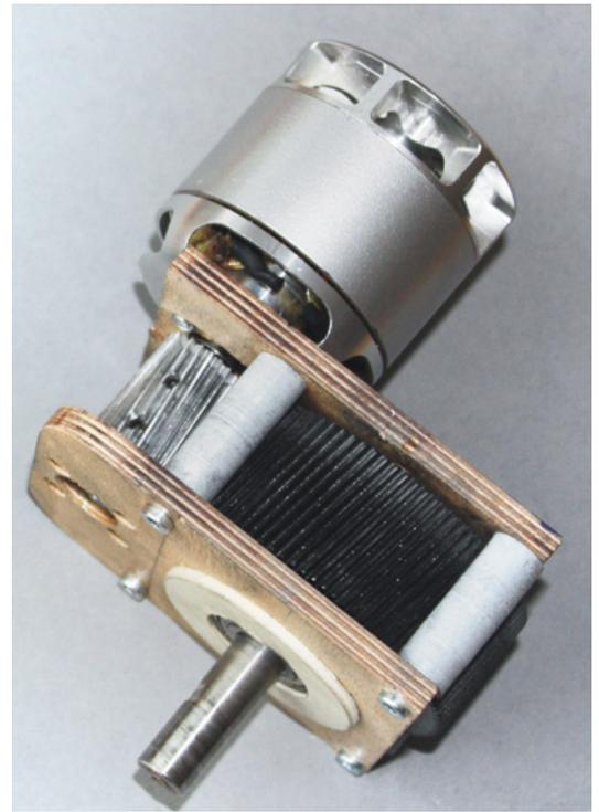
Eigenbaugetriebe mit Stirnradsatz von Kontronik. Verkräftet aufgrund der großen Zahnbreite von 30 Millimeter einen Leistungsdurchsatz von mehreren Kilowatt
