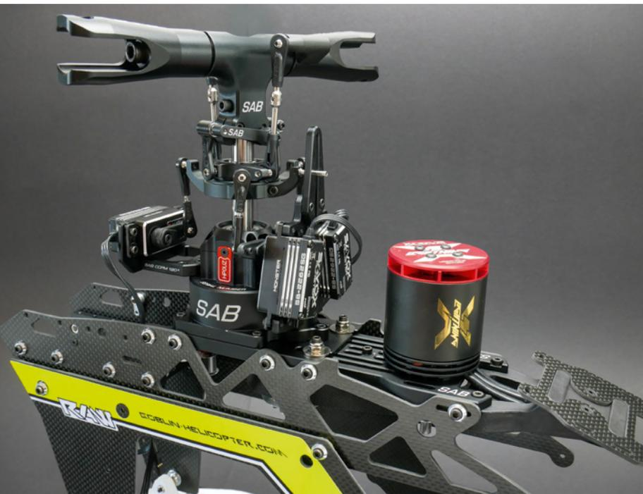
Die Taumelscheibenservos sind direkt am Hauptrotorgetriebe montiert
