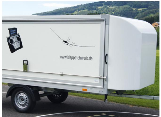
Dank der langen Deichsel, der schmalen Bauform und der aerodynamischen Frontpartie verhält sich der Hänger auch bei 100 Kilometer pro Stunde noch völlig unkritisch
