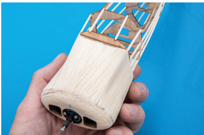
Durch die Klebeband-Schablonen-Methode ist es möglich, auch solche schwierigen Bereiche passgenau und flächig zu beplanken
