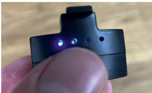
Der Akkustand kann jederzeit über die eingebaute Kontrollanzeige geprüft werden
