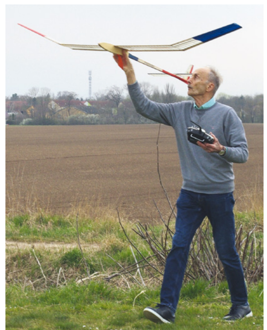
Das Modell wird im flachen Winkel gehalten, während die Winde es aus der Hand zieht
