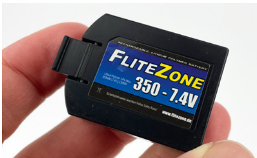
Der 2s-LiPo ist in einem Kunststoffgehäuse untergebracht und hat eine Kapazität von 350 Milliamperestunden
