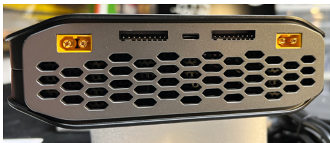
XT-60-Anschlüsse für die Akkus und XH-Balancerleisten sind inzwischen Standard. Zusätzlich bietet das K4 Duo eine USB-C-Buchse, um Smartphones oder andere Geräte zu laden
