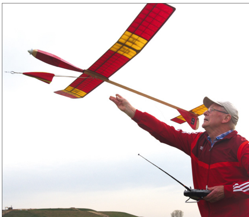
Oldtimer H 9. 1953 galt für die FAI-Formel A2 noch ein Rumpfquerschnitt von 1/100 der Gesamtfläche
