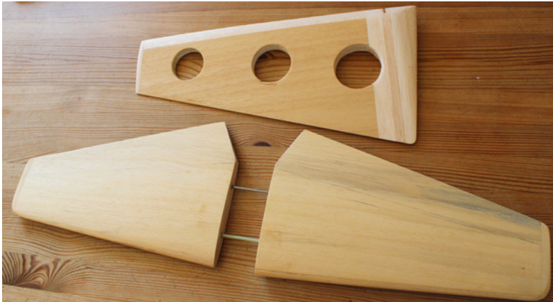
Im Seitenruder wurden runde Aussparungen eingebracht, um Gewicht zu sparen
