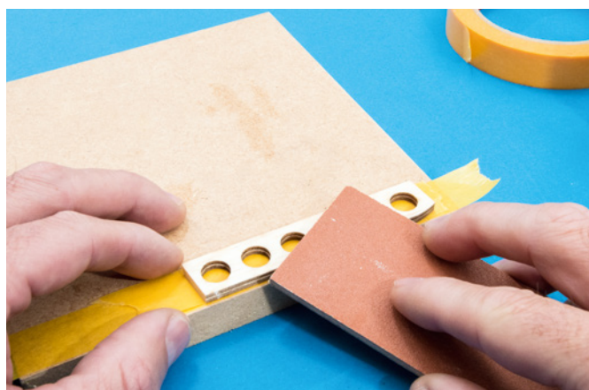
Die Querruder müssen spitz ausgeschliffen werden, wozu eine scharfe, handliche Schleifplatte mit 120er Körnung ein geeignetes Werkzeug ist
