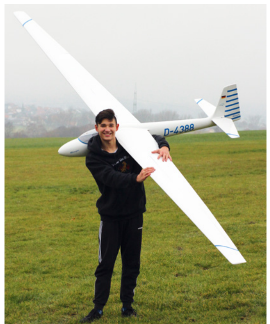
Mit 4.200 Millimeter Spannweite zählt das Modell schon zu den Großseglern. Der dicke Rumpf und die große Flächentiefe lassen das Flugzeug recht groß erscheinen
