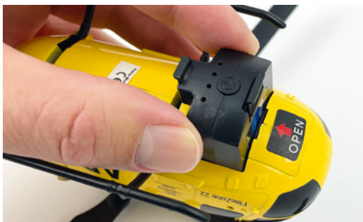
Der Akku wird von unten ins Modell eingeschoben
