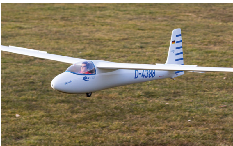
Durch das etwas höhere Landerad kann das Modell auch bei höherem Gras noch gut ausrollen
