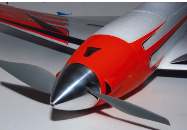
Gezielt platzierte Lufthutzen können helfen, kalte Luft zum und warme Luft vom Motor weg zu transportieren
