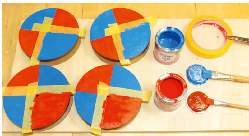
Fürs Lackieren in Fächerform jedes Segment abkleben
