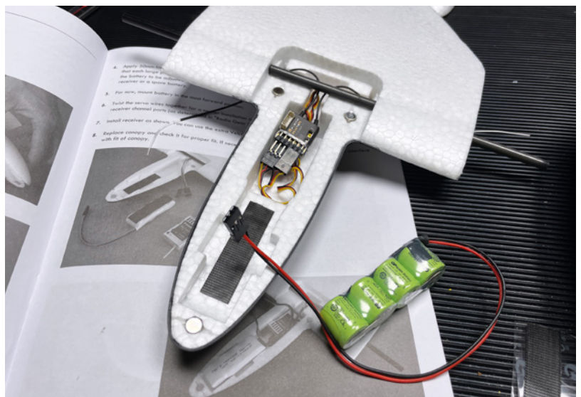
Der Akku wird von Klettband gehalten. So kann man ihn später verschieben, um den Schwerpunkt genau einzustellen
