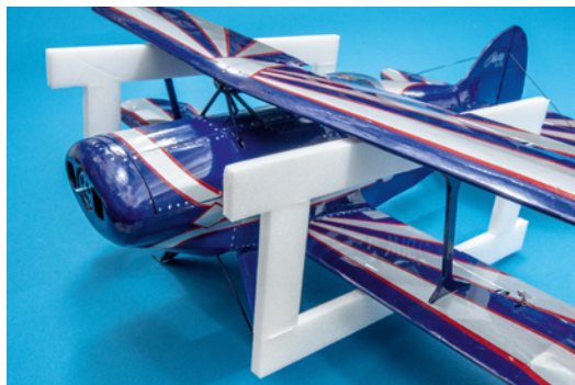
Es sollte ebenfalls überprüft werden, ob die Flügel zueinander parallel stehen. Für solche Kontroll-Lehren ist Depron ein praktisches und geeignetes Material
