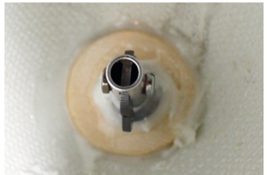
Mit einem Ring aus Multiplex-Sperrholz wird die Schleppkupplung in der Rumpfnase eingeharzt
