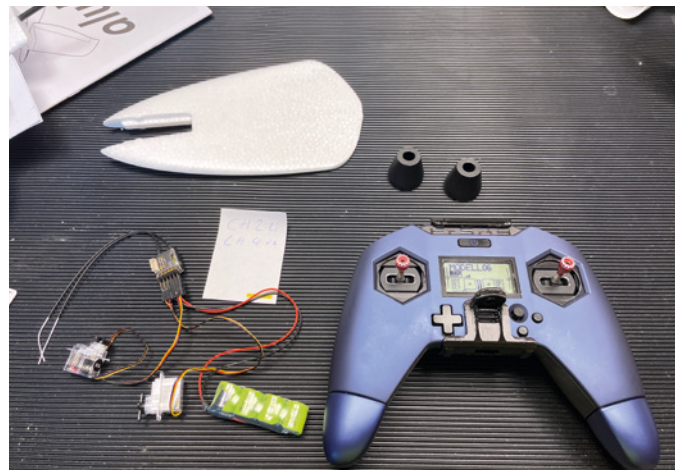
Bevor die Servos ins Modell eingebaut werden, sollte man sie in Neutralstellung bringen und die Laufrichtung korrekt einstellen
