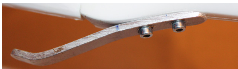
Der Sporn ist auch aus Aluminium gefertigt und entspricht in Etwa dem Original
