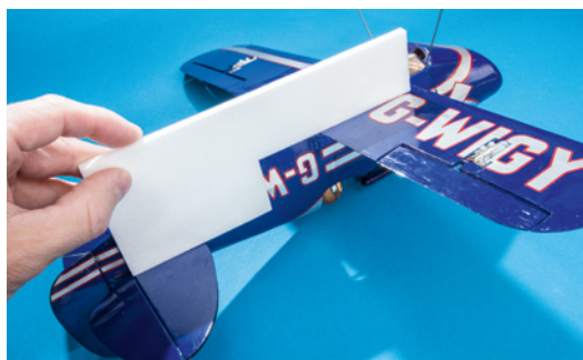
Wer hier nicht prüft, geht ein großes Risiko ein: die EWD von ca. 1,5° ist dann korrekt, wenn die Flügel-Unterseite parallel zum Höhenleitwerk steht
