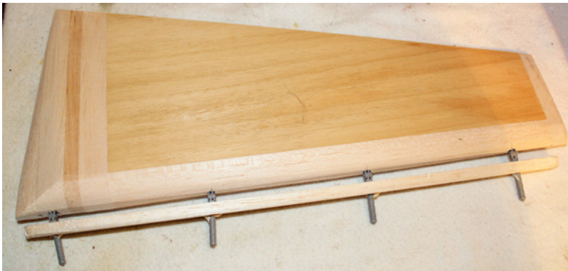
Das Seitenruder ist sauber gefertigt und wird mit vier kräftigen Scharnieren befestigt
