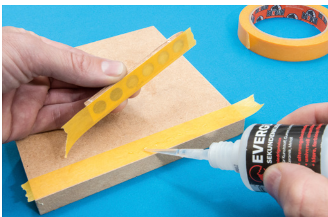
Für das temporäre Fixieren empfindlicher Bauteile verwende ich Lackiererkrepp, das mit Sekundenkleber aufeinander geklebt wird. Das Krepp-Band kann man später wieder gut vom Bauteil ablösen
