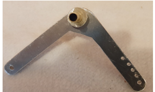
Für das Pendelhöhenruder wurde ein Umlenkhebel aus Aluminium angefertigt
