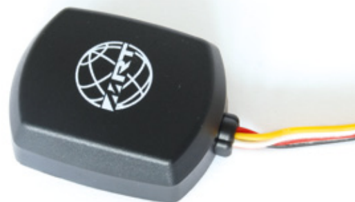
Das GPS-Modul wird am GU-INS-Board angeschlossen und anschließend auf der Haube des Kopters platziert
