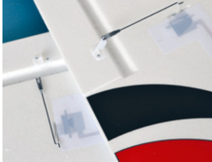
Die Querruderservos sind ab Werk eingebaut und lediglich die Lenkstangen am Ruderhorn einzuhängen
