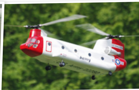
Der mit Dreiblattrotoren und Pyro 800 ausgestattete Tandemhubschrauber Chinook von Stefan Reusch, der ins Vario-Programm aufgenommen wurde
