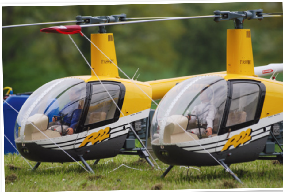
Die beiden identisch gebauten und lackierten Robinson R22 von Guy Vanderschelden und Francis Paduwat aus Belgien, die Synchronflug zelebrierten. Zum Einsatz kommen jeweils Vario-Elektromechaniken (Bell 47, modifiziert), die von einem Pyro 750-45 mit 12s/5.000 LiPos angetrieben werden. Das Abfluggewicht beträgt 12 Kilogramm bei einem Rotordurchmesser von 2.160 Millimeter
