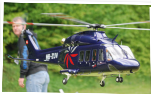
Sowohl für Turbine als auch Elektro-Antrieb ausgelegt – die Vario Agusta AW 139 im Maßstab 1:7 mit einem Rotordurchmesser von 1.970 Millimeter
