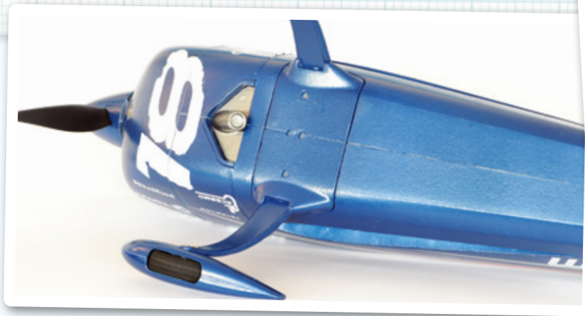
Details wie die Auspuffattrappe und die formschönen Fahrwerksverkleidungen dürfen bei einer Extra natürlich nicht fehlen
