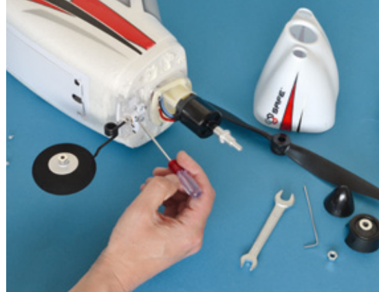
Spinner ab und Haube runter, dann erst lässt sich das Bugrad befestigen
