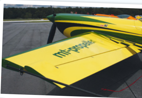
Die großen Querruder verhelfen der EA 330SX zu einer hervorragenden Rollrate von 430 Grad pro Sekunde (Foto: Hans-Jürgen Fischer)
