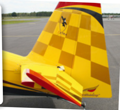
Wie die anderen Ruder der Extra 330SC ist auch das Seitenruder mit der großen Gewichtsausgleich-Fläche versehen
