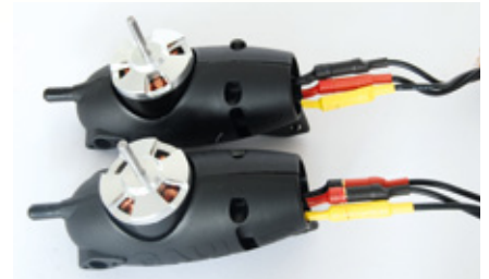
Für den Betrieb des Kopters werden jeweils drei rechts- und drei linksdrehende Motoren benötigt. Die Entscheidung über die Drehrichtung wird durch die Verkabelung getroffen
