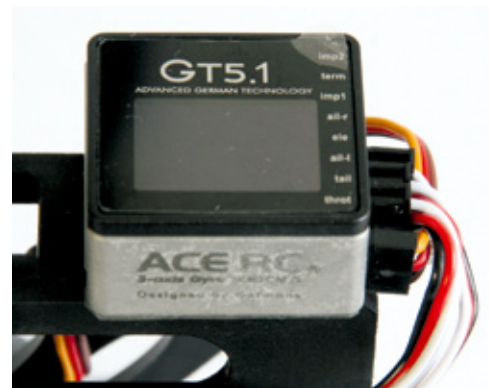
Das GT5.1 ist bereits angebracht und verkabelt
