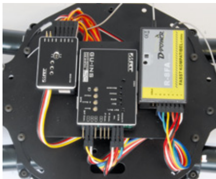
Die Platzierung und Verkabelung der Elektronik ist in der Anleitung ausführlich dargestellt. Die zentrale Steuereinheit, das GU-INS-Board, wird hier vom Hexa-/Oktokopter-Adapter (links) und dem Empfänger flankiert
