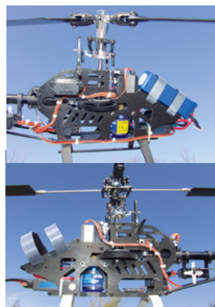
Die Chassis- und Getriebe-Konstruktion der beiden Probanden sind weitgehend identisch, wobei der Blade 500 X (oben) durch seinen Flybarless-Hauptrotor etwas niedriger baut
