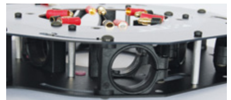
Die Arretierung der Ausleger erfolgt über Abstandhalter aus Kunststoff. Auf diese Weise lassen sich die Ausleger im korrekten Winkel und mit passendem Abstand montieren
