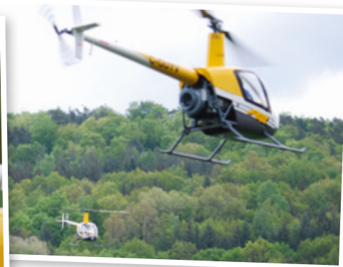
Die beiden identisch gebauten und lackierten Robinson R22 von Guy Vanderschelden und Francis Paduwat aus Belgien, die Synchronflug zelebrierten. Zum Einsatz kommen jeweils Vario-Elektromechaniken (Bell 47, modifiziert), die von einem Pyro 750-45 mit 12s/5.000 LiPos angetrieben werden. Das Abfluggewicht beträgt 12 Kilogramm bei einem Rotordurchmesser von 2.160 Millimeter
