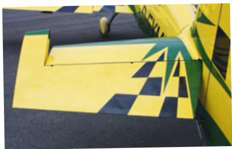
Blick über das Höhenleitwerk mit dem großen Ruderausgleich der D-EXMT (Foto: Hans-Jürgen Fischer)
