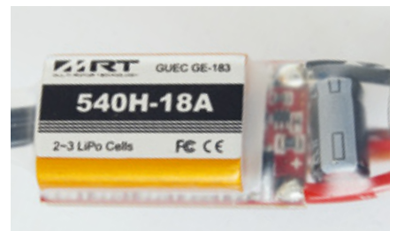
Angesteuert werden die Motoren von jeweils einem 18-Ampere-Controller. Diese sind für den Betrieb an 3s-LiPos ausgelegt
