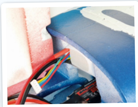
Clever gemacht: Die Kabinenhaube fixiert gleichzeitig den Akku. Dazu muss man lediglich eine kleine Ecke für die Kabel aussparen
