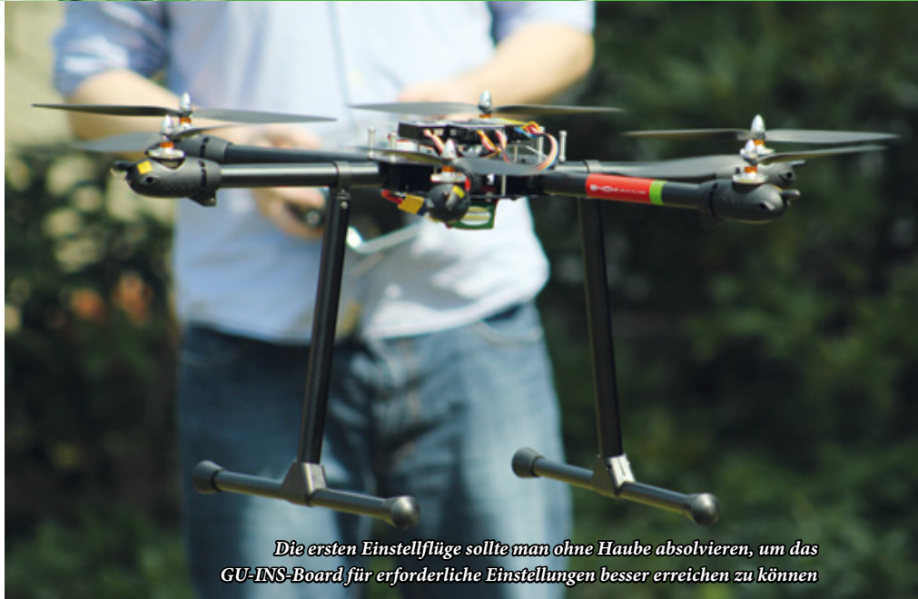
Die sechs Motorgondeln werden jeweils mit einem Gaui-Brushlessmotor mit einer spezifischen Drehzahl von 960 Umdrehungen pro Minute und Volt bestückt
