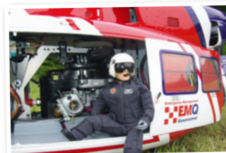
Der Pilot ist fertig mit dem Check des Antriebs – gleich steht der Take-Off an. Diese Bell 412 im Maßstab 1:7,6 gehört Herbert Rümer, deren bemanntes Vorbild ein in den USA stationierter Rettungshubschrauber ist. Der Antrieb des Modells erfolgt mit einer Vario-Benzinmechanik
