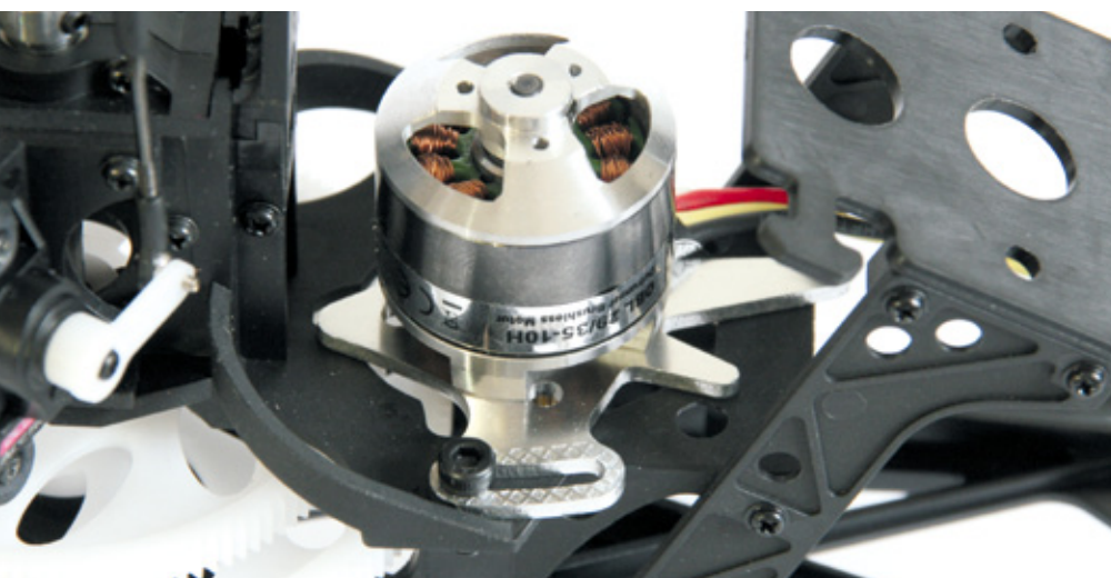
Durch das Langloch im Motorträger lässt sich das Zahnflankenspiel sehr fein justieren
