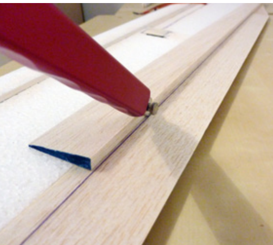
Eine Endleiste dient als Lineal, um den richtigen Winkel zu finden
