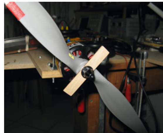
Bild 4: Für die Bestimmung der Betriebswerte des Motors mit dem ProeMax-Checker sind Propellermessungen ausreichend. Es werden nur Spannungen, Ströme und Drehzahlen benötigt
