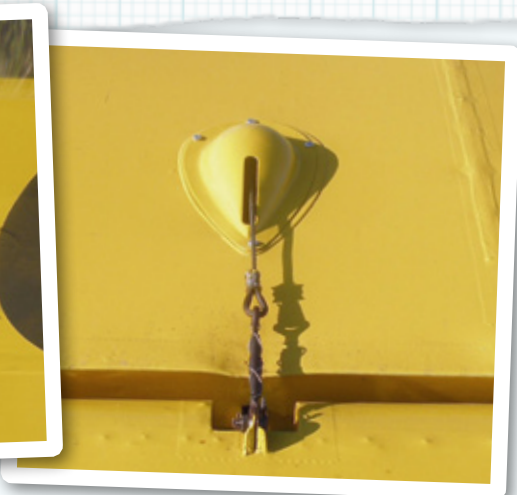
Unter einer wohlgeformten Abdeckung führt das obere Querruder kabel in die Tragfläche (Foto: Thomas Brückelt)
