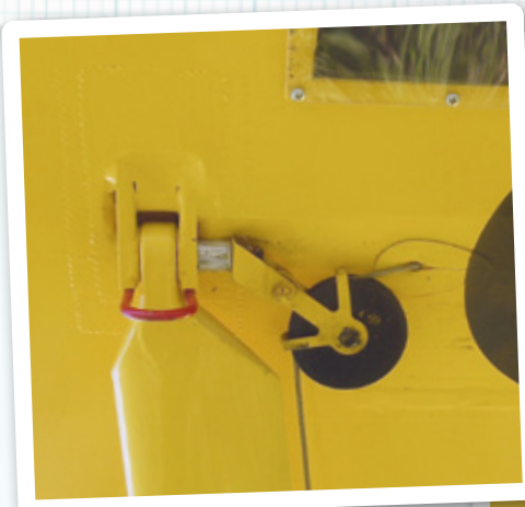
An allen Cub-Baureihen identisch: die Querruder kabel Umlenkrolle an der vorderen Tragflächen-Profilstrebe (Foto: Thomas Brückelt)
