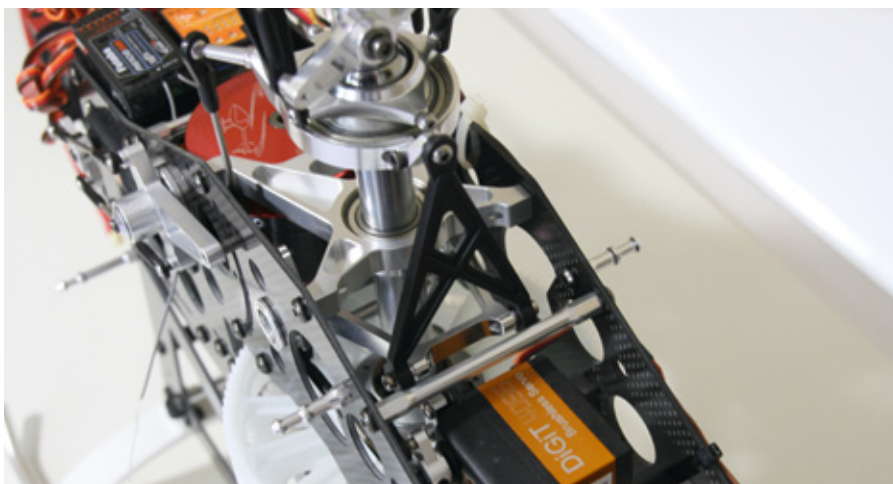
Hier der obere Lagerbock der Hauptrotorwelle. Eine zweifache Abstützung genügt vollkommen
