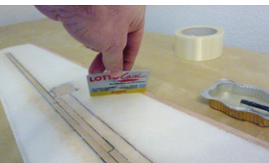
Eine Mischung aus Waschbenzin und UHU Por dient als Vorbehandlung der EPP-Oberfläche, damit die Bespannung später auch hält
