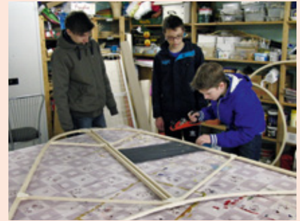
Die vorgefertigten Holzbaugruppen mussten noch gehobelt, verschliffen und Lackiert werden
