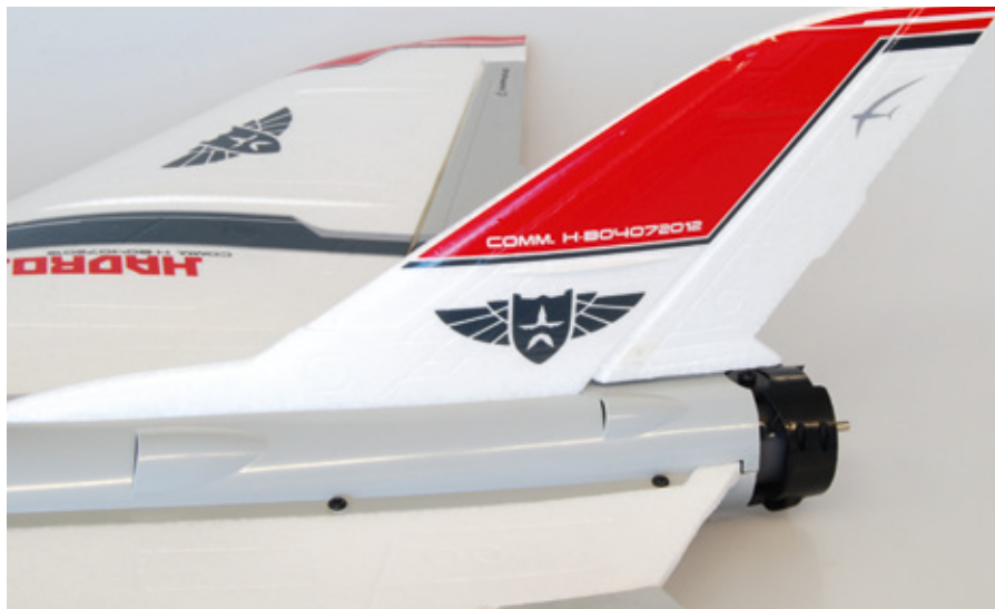
Das Seitenleitwerk ist an der hinteren Rumpfabdeckung verschraubt. Danach wird die Einheit am Modell fixiert
