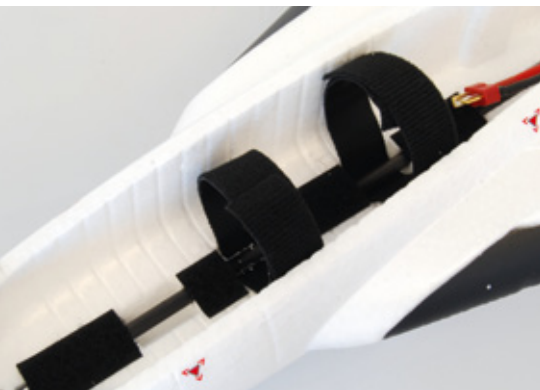
Zwei neue Kanäle müssen in den Rumpf geschnitten werden. Durch diese werden die Klettbänder zur Akkubefestigung gezogen
