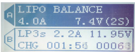
Während ein Akku lädt (unten) kann man alle Parameter für den zweiten Ladeausgang verändern
