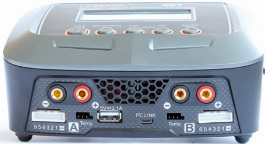
Die beiden Ladeanschlüsse rechts und links sowie ein Vielzweck-USB-Ladeport und eine PC-Link-Schnittstelle befinden sich auf der Vorderseite des Geräts
