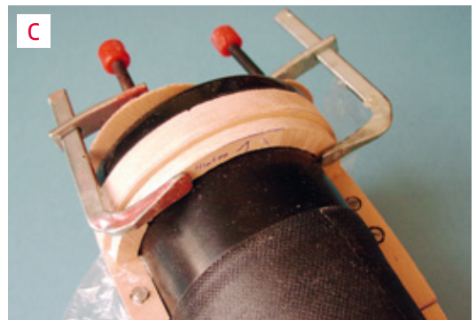
A) Die untere Impellerverkleidung ist rohbaufertig, auch die Verstärkungen im Auflagebereich sind bereits eingebaut
