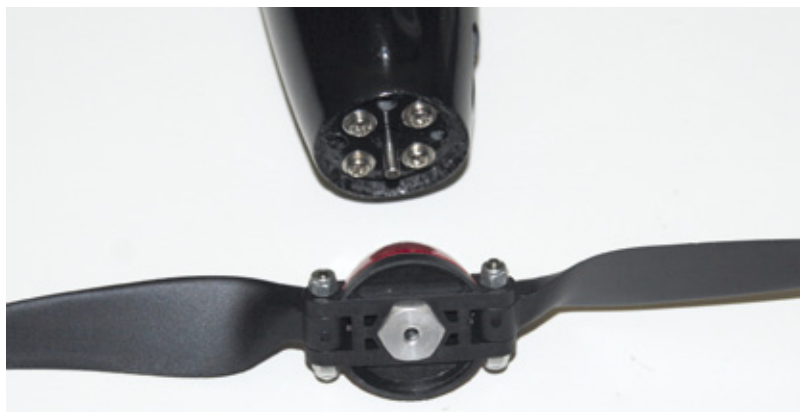
Der Motor ist bereits verbaut und die Propeller-Mitnehmer-Spinner-Einheit montiert
