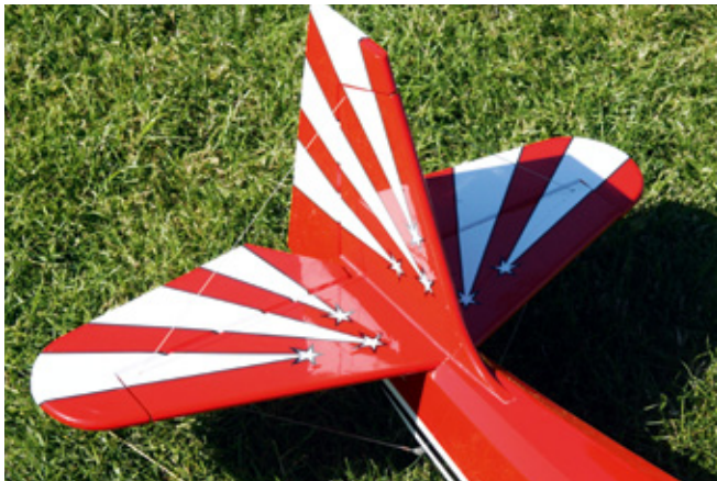
Das Leitwerk wird mit dem Rumpf verklebt. Die Verspannung ist durchgängig und kann über einen Gabelkopf nachgespannt werden
