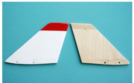
Das Winglet einmal im Rohbau und einmal bespannt
