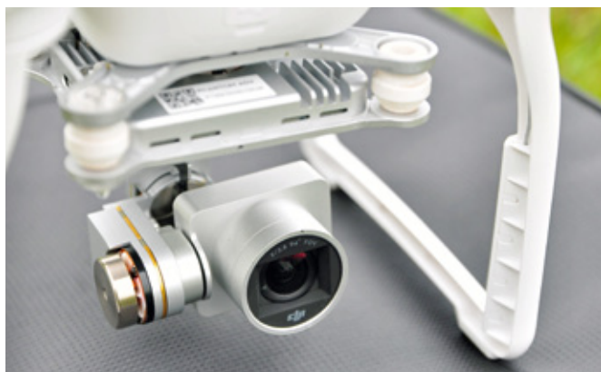
Die sehr effektiv arbeitende Einheit aus Kamera und Dreiachs-Gimbal. Der dritte Motor ist in der Platte oben versteckt
