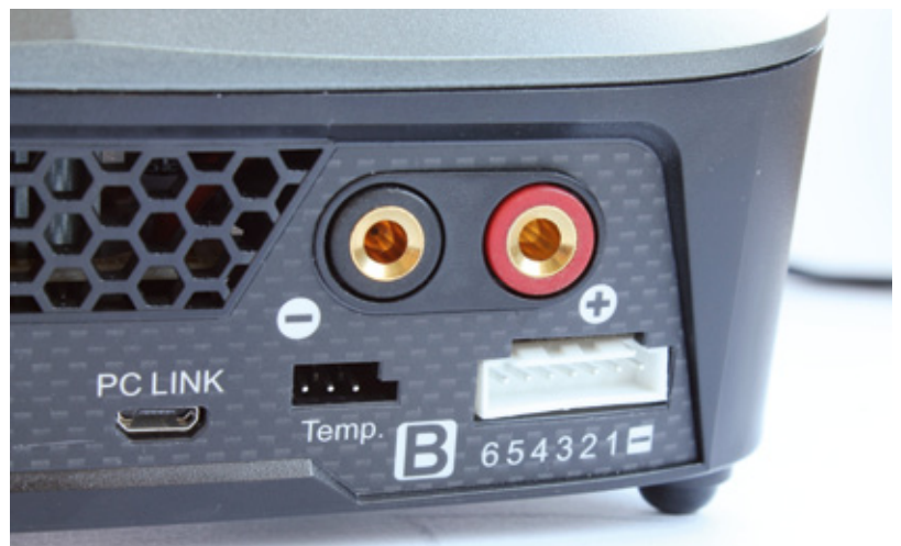
Der Balancer verrät es: Maximal 6s-LiPos können geladen werden. Der Temperaturport bleibt leider ungenutzt, da kein Sensorkabel dafür beiliegt
