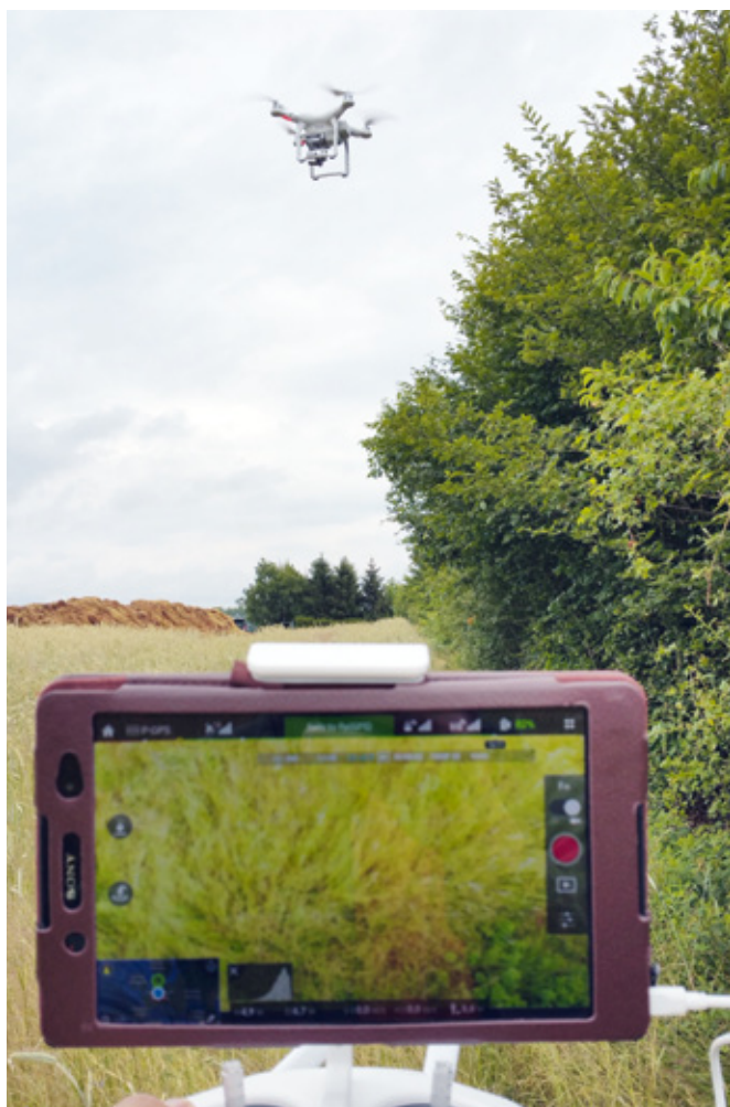
Hier ist die Kamera zur Aufnahme auf den Boden gerichtet und das Modell nähert sich einem Hindernis. Daher muss man nach der Aufnahme genau hinschauen beziehungsweise die Kamera erst wieder nach vorne richten, bevor man weiterfliegt
