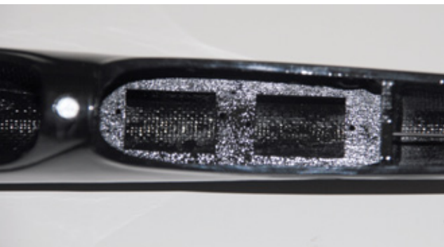
In der ARF-Version ist alles für den Einbau der Servos vorbereitet
