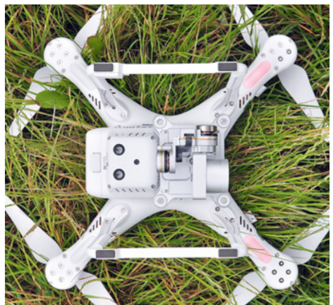
Nicht abgestürzt sondern Ansicht von unten: Mitte links Ultraschallsensoren und Kamera des VPS, in den Beinen des Landesgestells die Antennen der Lightbridge, am Bein links oben der Kompass
