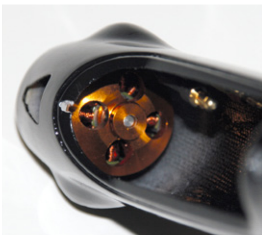
Der dicke Außenläufer ist zwar schwer, sorgt jedoch für ordentliche Flugleistungen
