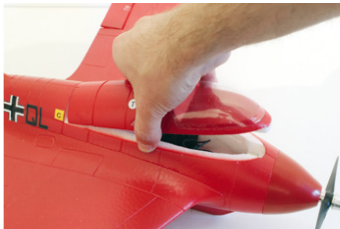
Die Kabinenhaube wird von einem starken Neodym-Magneten gehalten
