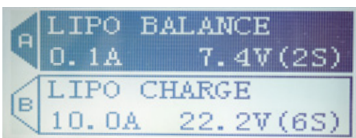
Maximal schafft es der D100 6s-LiPos mit 10 Ampere zu befüllen
