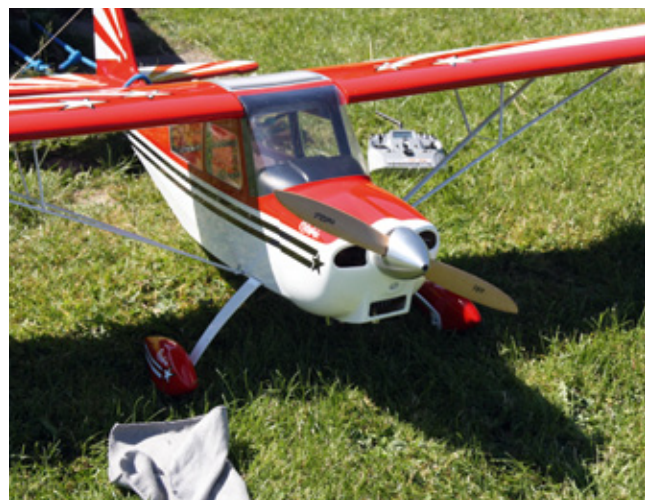
So sollte man den Motor nicht starten: Die Fernsteuerung liegt viel zu weit weg, um schnell eingreifen zu können und der Putzlappen kann im schlimmsten Fall in den Propeller geraten
