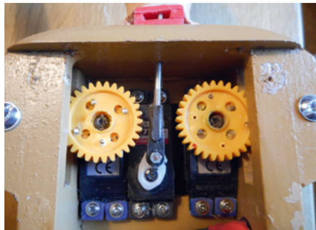
Anlenkung des Springers Obifix 3 erfolgt über Zahnräder auf den Servos, die die Starrarme bewegen
