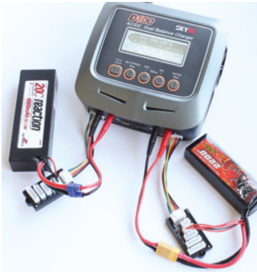
Zwei Akkus gleichzeitig laden, und das am besten mit 200 Watt – kein Problem mit dem Sky RC D100
