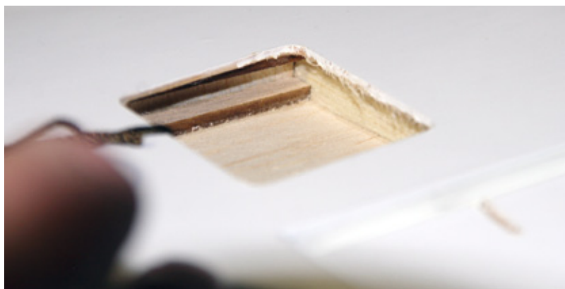
Die Beplankung, Rippen und Holm mit Absperrung: wozu High-Tech?
