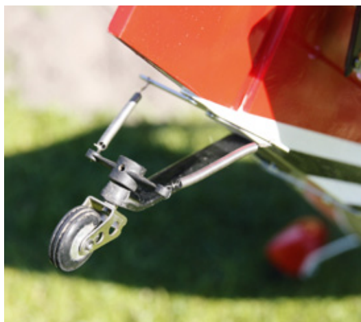
Das Spornrad ist über lange Federn angelenkt, damit keine Schläge an das Servo übertragen werden
