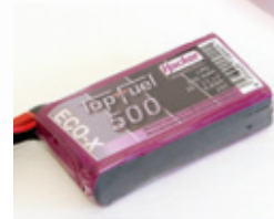
Der von Hacker empfohlene Antriebs-Akku des Typs Top-Fuel Eco-X mit einer Kapazität von 500 Milliamperestunden
