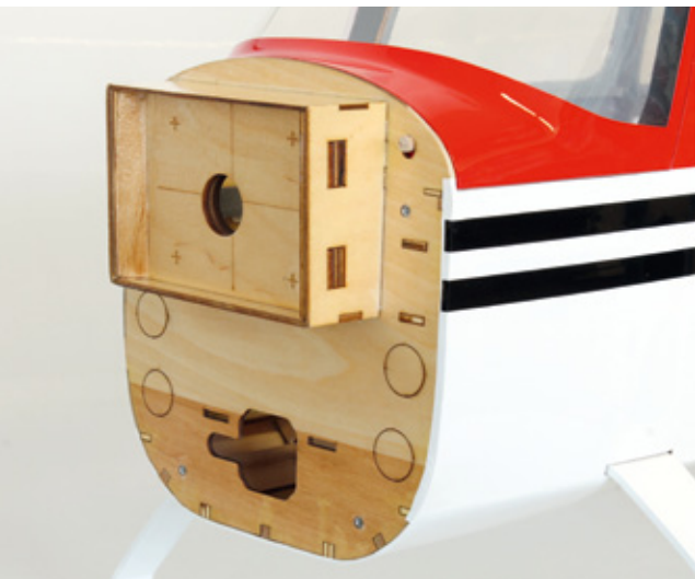
Der Motorspant ist ordentlich gebaut und sogar schon mit Klarlack vor Sprit geschützt
