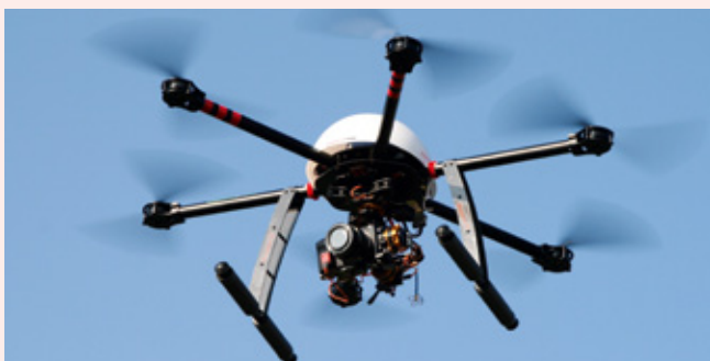
Bei einer Senderstörung sollte der Kopter die Return-to-Home-Funktion aktivieren, um sicher zum Startplatz zurückzukehren
