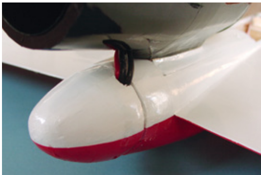
Zuletzt wird der Regler samt Kabel nach vorne gezogen und das Kabel durch die neue Heckverkleidung in den Rumpf geführt
