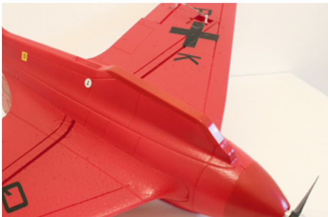
Um den EPO-Rumpf bei Landungen zu schonen, sind vorne sowie im Spornbereich Kunststoffprofile angebracht
