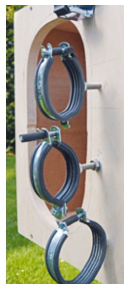
Als Rumpfhalter sind Rohrschellen bestens geeignet
