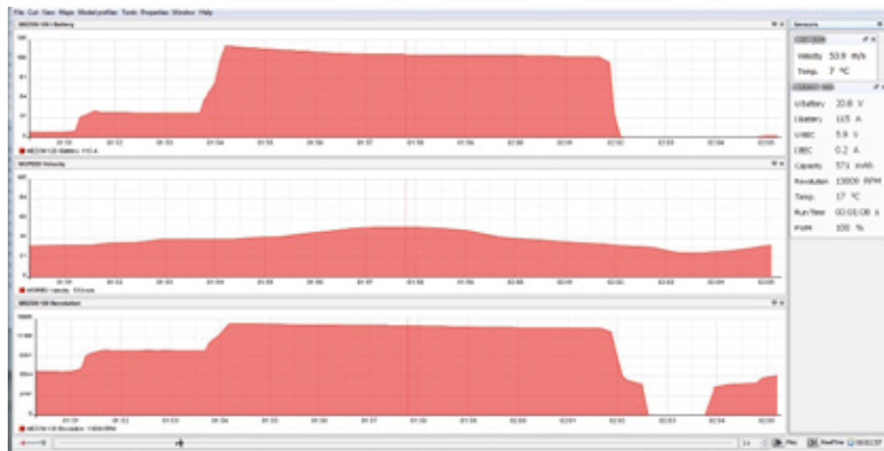
Datenübersicht: 2.392 Watt bringen rund 13.000 Umdrehungen und knapp 200 Kilometer pro Stunde. Der Regler liegt nach zwei Minuten Flugzeit 10 Grad Celsius über der Außentemperatur
