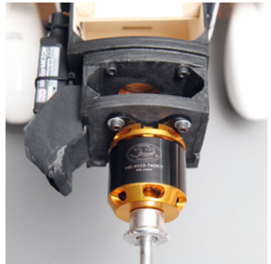
Der montierte Motor und die Kühlluftführung des Reglers
