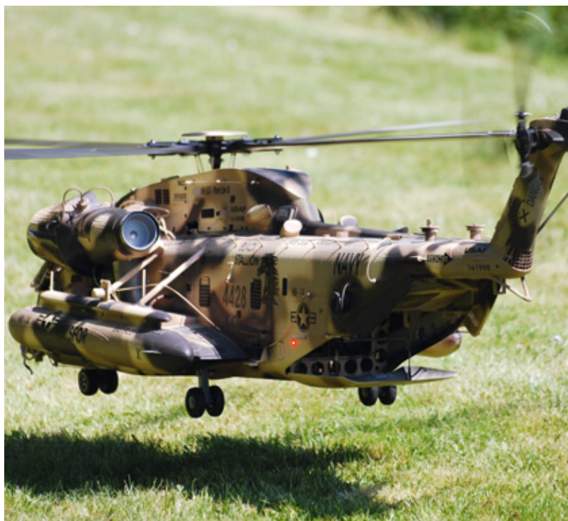
Die Pave Low II MH53J von Reto Marbach aus der Schweiz (flugbox.ch) gehörte mit zu den beeindruckendsten Scale-Nachbauten, die es zu sehen gab. Zum Einsatz kommt ein Kontronik Pyro 850, der in Verbindung mit 12s-LiPos mit einer Kapazität von 5.000 Milliamperestunden und einem Controller Kosmik Cool 200 knapp zwei Meter großen Sechsstab-Hauptrotor antreibt
