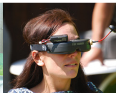
Mittels einer FPV-Kamera Fatshark 700 TVL nebst 25-Milliwatt-Sender und Senderantenne von Immersion RC lässt sich aus der Cockpit-Perspektive der Flug der Bell 412 verfolgen, was hier von Firmenchefin Kirsten Zodtner ausprobiert wurde, während der Pilot tief über das Rapsfeld flog
