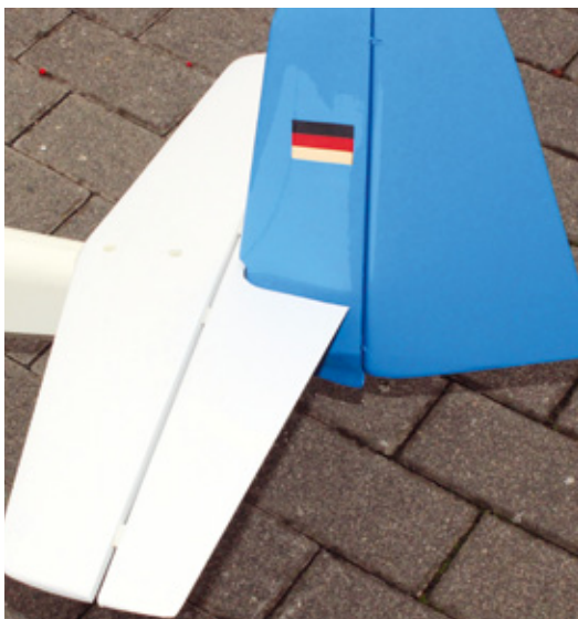
Die Leitwerke sind in Styro-Abachi-Bauweise erstellt und schnell angefertigt. Das Seitenruder ist in Hohlkehle angeschlagen. So wie beim Original auch
