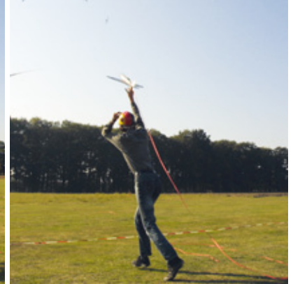
Start der MiG-3 nach Methode 1 (Griff von oben am Rumpf), Werfer ist Daniel Lux
