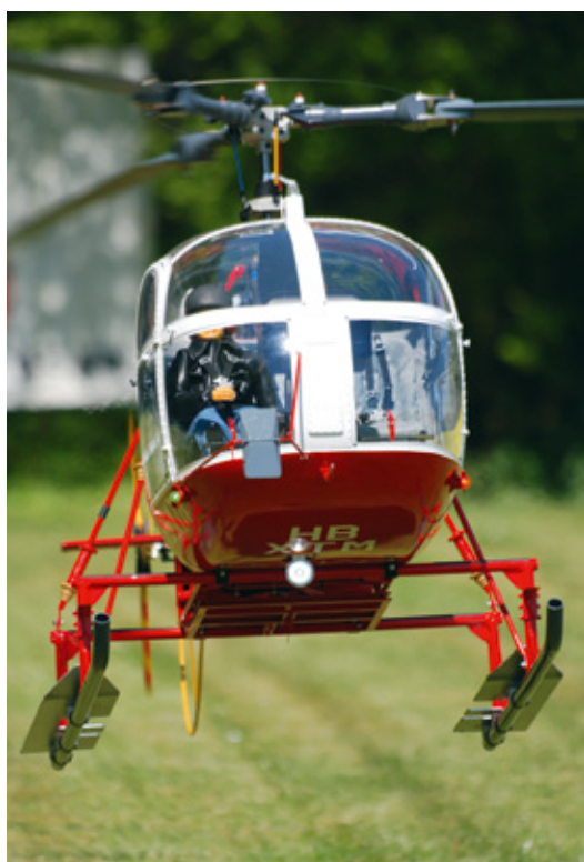
Die VARIO Lama SA 315 von Dennis Engel wiegt etwa 22 Kilogramm, ist mit einer Jakadofsky-Turbine Pro Edition ausgerüstet und wurde Vorbildgetreu in Szene gesetzt
