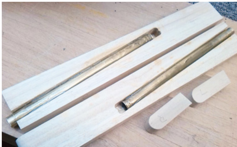
Mit den vorgearbeiteten Holmstummeln ist es sehr einfach, eine feste Flächensteckung herzustellen. Ebenso wird hier die V-Form vorgegeben
