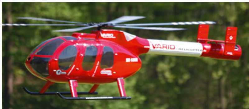
Die mit Notar-System ausgerüstete MD 600N, die von Stefan Reusch, der auch das VARIO Event moderierte, gebaut und vorgeflogen wurde. Die komplette Endkappe kann gedreht werden, um eine Umlenkung des Luftstroms (Hochachsendrehung) zu bewirken
