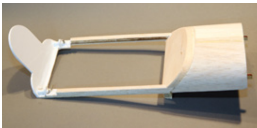
Die Haube nach erfolgter Modifizierung: Eine 10-Millimeter-Balsa-Aufdickung schafft geschlossene Verhältnisse
