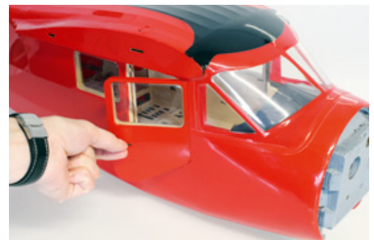
Die Tür ist über einen Schieberiegel zu öffnen. Die gesamte Montage im oberen Kabinenbereich muss durch hierdurch erfolgen
