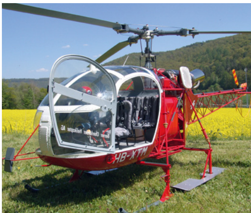
Die VARIO Lama SA 315 von Dennis Engel wiegt etwa 22 Kilogramm, ist mit einer Jakadofsky-Turbine Pro Edition ausgerüstet und wurde Vorbildgetreu in Szene gesetzt
