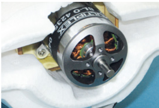
Ein Permax BL-0 4235 mit 480 Umdrehungen pro Minute und Volt treibt die FunCub XL an
