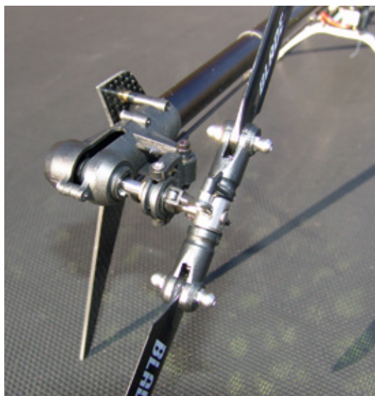
Der Heckrotor im typischen Blade-Design mit Propeller-Momentgewichten an den Blatthaltern und Riemenantrieb
