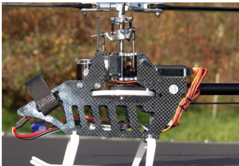
Das Hauptzahnrad ist schrägverzahnt und die Rotorwelle zusätzlich unterhalb des Zahnrads gelagert – beides keine Selbstverständlichkeiten in dieser Größenklasse
