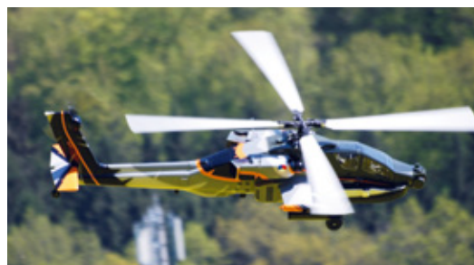
Sogar der Anstellwinkel des Höhenleitwerks der VARIO Apache AH-64 ist wie beim bemannten Vorbild im Flug verstellbar
