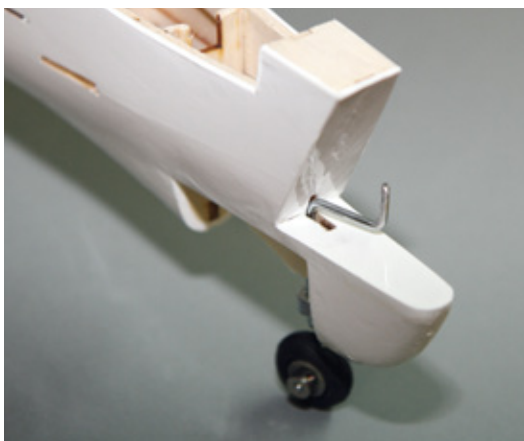
Modifikation notwendig: die Mitnahme des Spornrades
