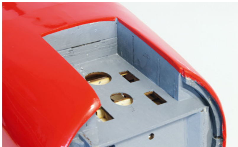
In dieser Aussparung auf der Rumpfunterseite kann man den Antriebsakku in der Elektroversion oder den Auspuff beim Verbrenner unterbringen
