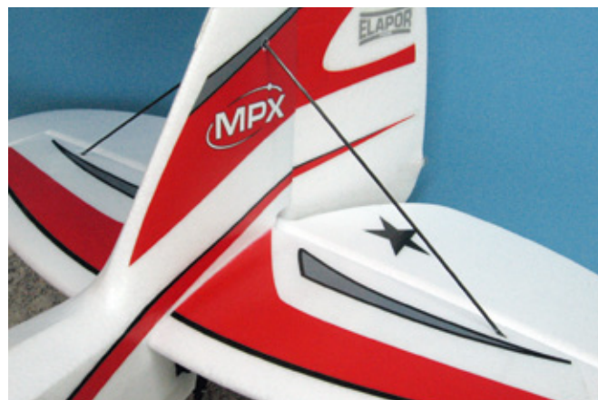
Die Leitwerkspartie wird mittels Kohlefaserstäben abgestützt
