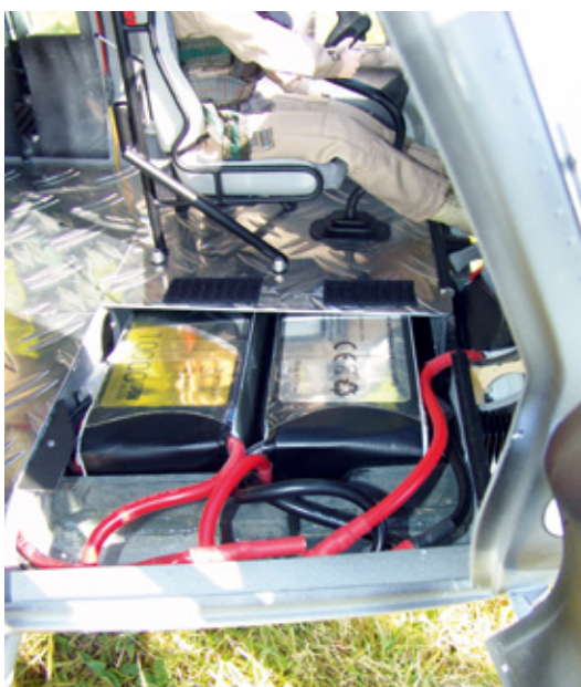
Unter dem rechten, herausnehmbaren Pilotensitz befinden sich zwei GensAce 4s-LiPos mit einer Kapazität von jeweils 5.000 Milliamperestunden, ein weiteres Pack sitzt in der Nase (also 12s-LiPo insgesamt)
