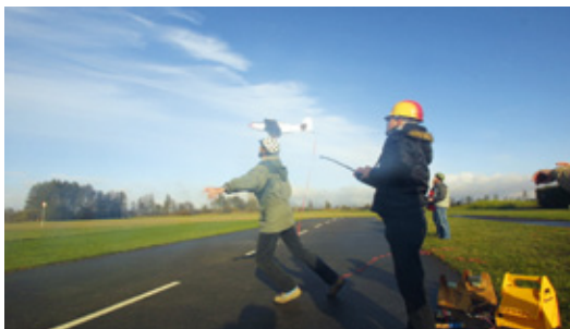
Start der MiG-3 nach Methode 1 (Griff von oben am Rumpf), Werfer ist Daniel Lux
