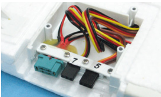
Hier nochmal der Verteilerkasten mit den Steck-Verbindungen zwischen Fläche und Rumpf geöffnet
