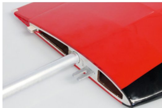
Ein Aluminiumrohr sorgt für Stabilität. Hinten die Verdrehsicherung zu sehen, vor dem Rohr die Aluminium-Lasche, die zur Fixierung am Rumpf dient
