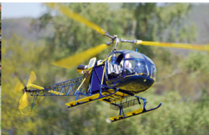
Die im Maßstab 1:4 ausgeführte VARIO Lama SA 315 im „Sud Aviation“-Outfit des Franzosen Nicolas Aubert. Daten: Rotordurchmesser 2.500 Millimeter, Abfluggewicht 19 Kilogramm, Turbine Jakadofsky Pro 5000
