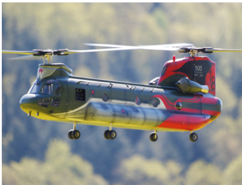
Das VARIO Chinook hat einen Rotordurchmesser von 2 \times 1.540 Millimeter und wiegt abflugbereit etwa 11,5 Kilogramm. Für den Antrieb empfohlen werden ein Kontronik Pyro 850 in Verbindung mit einem Kosmik 160 HV und einem 12s LiPo-Pack mit 4.500 Milliamperestunden Kapazität. Das Bavarian Demon 3SX übernimmt die bordseitige Flugregelung
