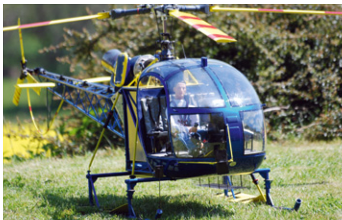
Die im Maßstab 1:4 ausgeführte VARIO Lama SA 315 im „Sud Aviation“-Outfit des Franzosen Nicolas Aubert. Daten: Rotordurchmesser 2.500 Millimeter, Abfluggewicht 19 Kilogramm, Turbine Jakadofsky Pro 5000
