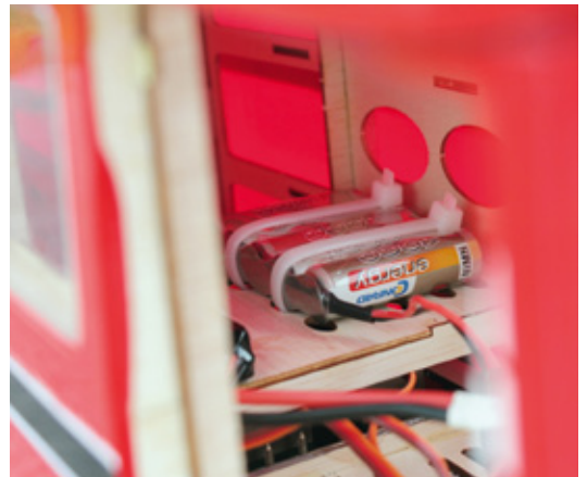
Oberhalb der Rumpfservos sind die beiden Akkus für Zündung beziehungsweise Empfängerstrom untergebracht
