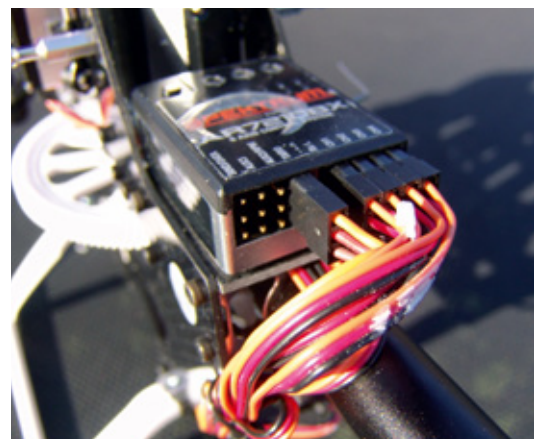
Das AR7210BX-Flybarlesssystem ist gut zugänglich positioniert und sauber verkabelt
