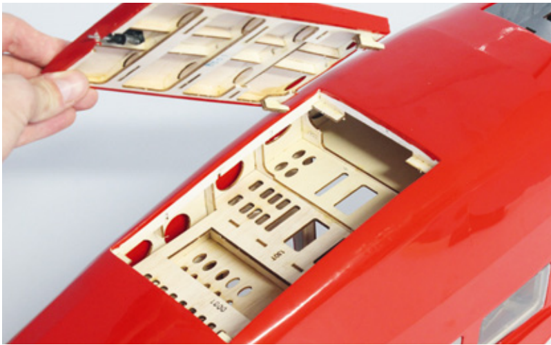
Auf der Rumpfunterseite ist eine große Abdeckung, unter der Platz für den Einbau von Servos und Empfänger ist
