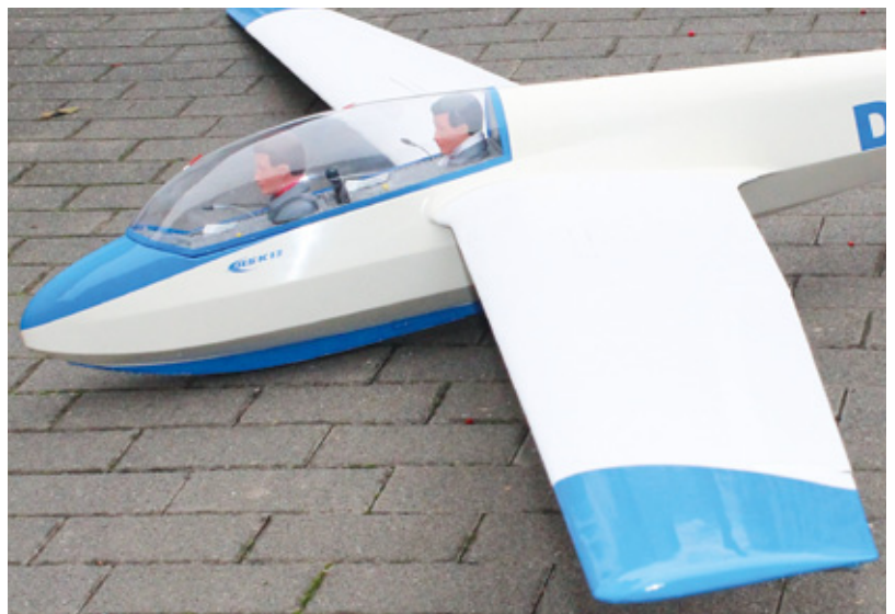
Bei der Jung-ASK 13 ist der Flächenübergang zum Rumpf mit einer Verdickung erstellt worden. Diese Verdickung und die Vorpfeilung von minus 6 Grad geben dem Flugzeug seinen Charakter
