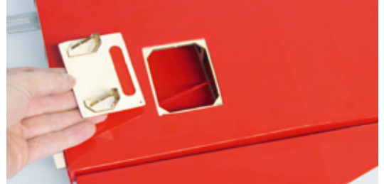
Die Rudermaschinen in den Flächen werden direkt auf die Abdeckungen der Servo-Schächte geschraubt
