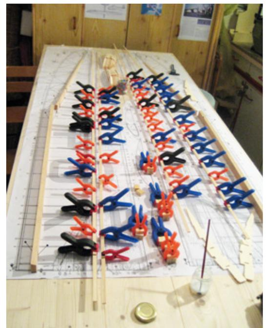
Die Hauptholme werden mittels Schäftung hergestellt. Beide Flächen wurden parallel und auf einem Baubrett montiert
