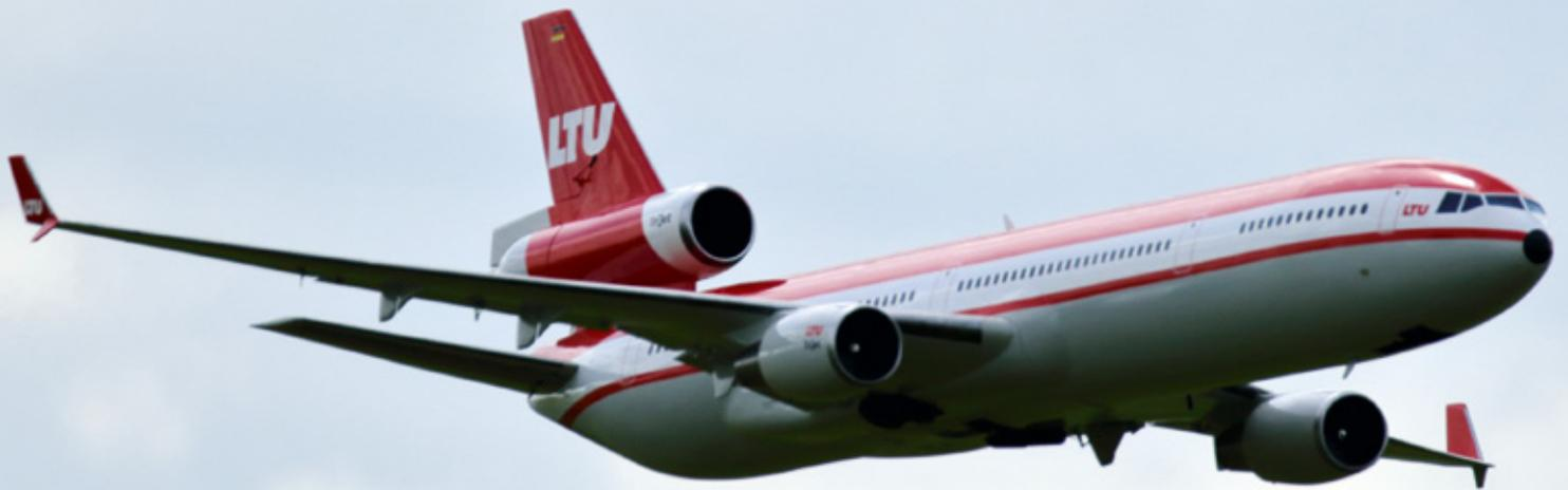
*Das Großraumflugzeug MD-11 von Norbert Hesse, der mit seinem Sohn Dennis aus Rietberg gekommen war. 700 Stunden investierten Vater und Sohn in die perfekte Nachbildung des 3.8500 Millimeter langen und 24,3 Kilo schweren Passagierflugzeugs im Maßstab 1:16 mit einer Spannweite von 3.500 Millimeter und angetrieben von nur einer Turbine. Norbert Hesse ist bereits seit 1975 jährlich beim Luftzirkus in Harsewinkel dabei*
