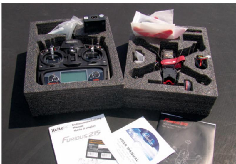
Das RTF-Set beinhaltet neben dem betriebsfertigen Race-Kopter inklusive Kamera, Motoren, Regler und Empfänger auch den vorprogrammierten Walkera-Sender DEVO7. Eine deutsche Bedienungsanleitung liefert XciteRC ebenfalls mit
