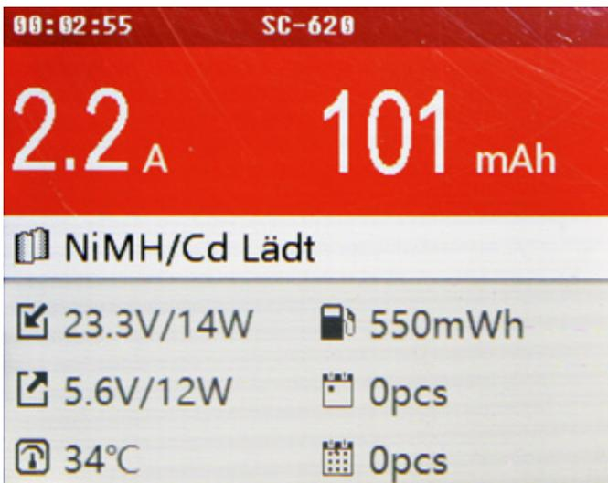
Wenn – wie bei NiMH/Cd-Ladung – die Einzelzellen-Überwachung entfällt, werden Ein- und Ausgangsleistung (recht grob) angezeigt
