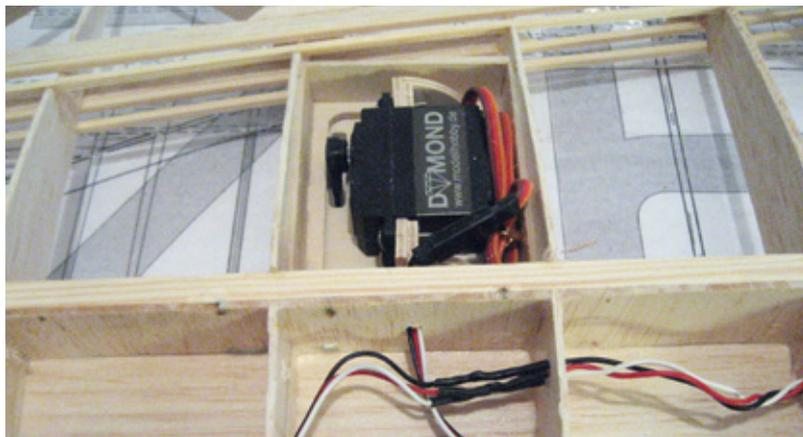
Die Servos der Querruder sind in zuvor erstellten Servorahmen gelagert und in die Flächen eingebaut
