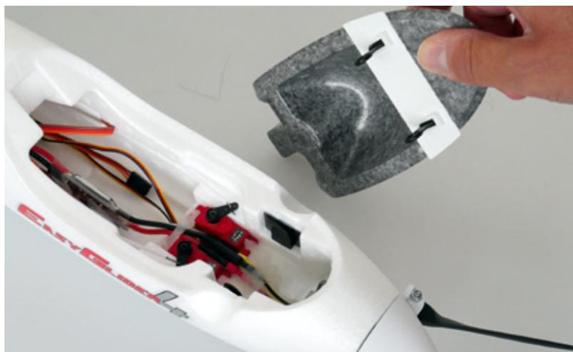
Die Cockpithaube ist leicht demontierbar. Servos, Regler und Motor sind betriebsbereit eingebaut
