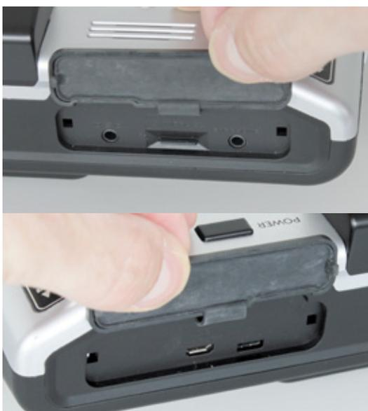
Unter zwei Abdeckklappen an der Senderfront finden sich verschiedene Anschlussmöglichkeiten sowie ein Micro-SD-Karten-Slot
