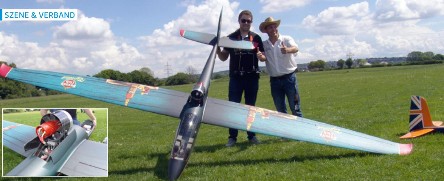
Der achtfache Deutsche Jugendmeister Alexander Schiegg (links) flog gekonnt diesen 19 Kilogramm schweren Puls von Paritech vor. Neben ihm Paritech-Firmenboss Uwe Rihm. Für den kraftvollen Antrieb des Puls sorgt ein Ausfahr-Impeller Jet-Flex 130 von Moses Modellbau, der über einen 14s-LiPo mit einer Kapazität von 5.000 Milliamperestunden versorgt wird
