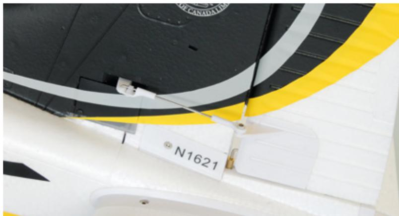
Das Seitenruder wird direkt über ein Servo in der Dämpfungsflosse angelenkt
