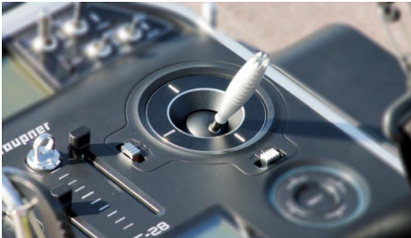
Die super sanft arbeitenden Kreuzknüppelaggregate sind in Aluminium eingefasst. Neben den langen Aluknüppeln liegen auch noch kürzere Exemplare bei
