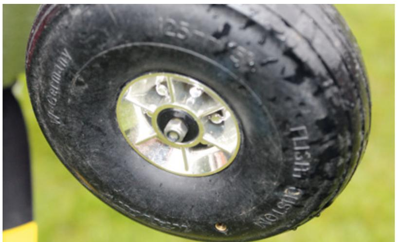
M4-Edelstahlschrauben und Sicherungsmuttern dienen den Kavan-Rädern als Radachsen
