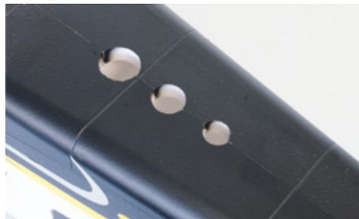
Drei Lüftungsöffnungen auf der Rumpfunterseite ermöglichen der Kühlluft zu entweichen
