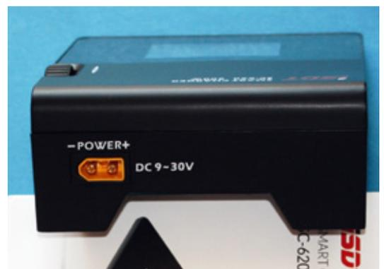
Auch die Spannungsversorgung geschieht über einen handelsüblichen XT60-Stecker. Somit lassen sich auch passende LiPo-Akkus von 3s bis 7s dort anschließen
