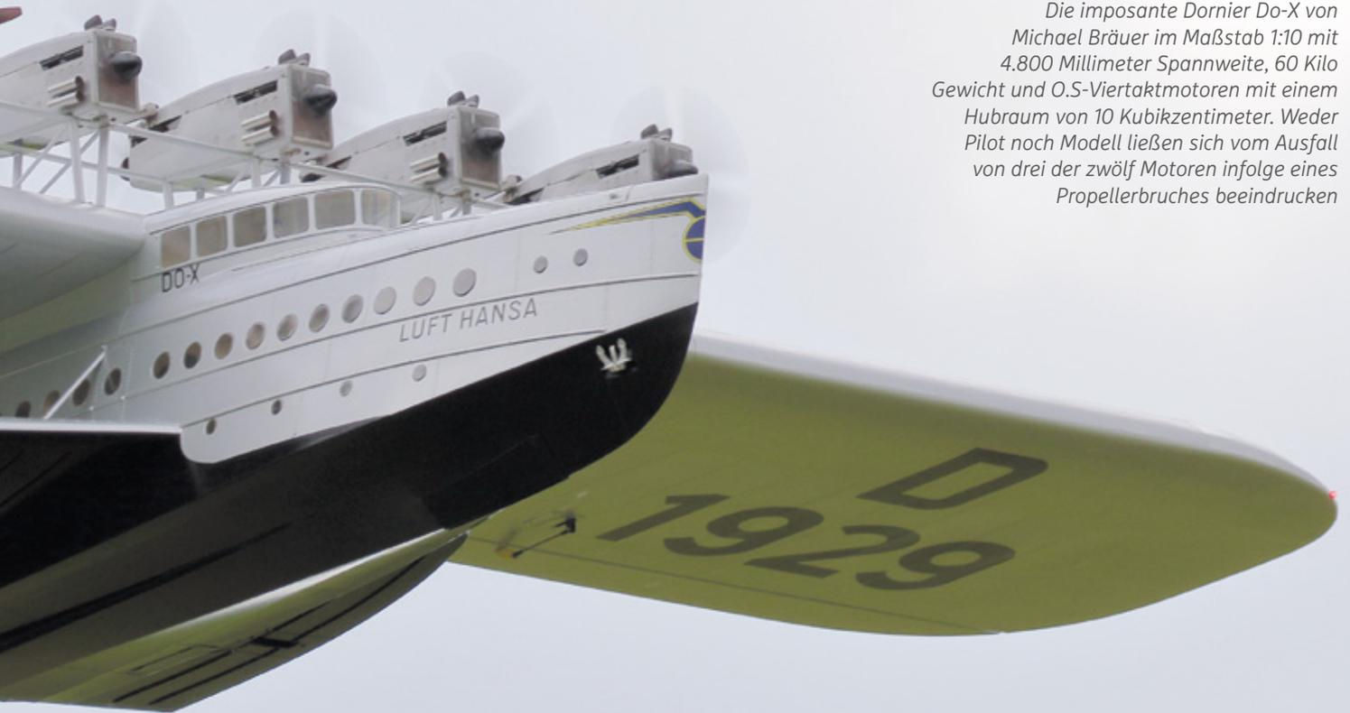
Die imposante Dornier Do-X von Michael Bräuer im Maßstab 1:10 mit 4.800 Millimeter Spannweite, 60 Kilo Gewicht und O.S-Viertaktmotoren mit einem Hubraum von 10 Kubikzentimeter. Weder Pilot noch Modell ließen sich vom Ausfall von drei der zwölf Motoren infolge eines Propellerbruches beeindrucken
