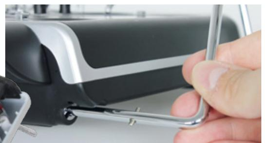
Die Metallbügel für den Trageriemen werden von hinten eingeschoben und durch Drehen und Drücken arretiert
