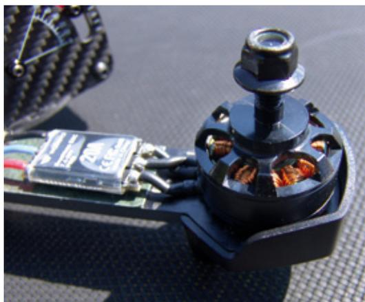
Die kraftvollen Außenläufer sowie unmittelbar davor montierten Controller sind serienmäßig für 4s-Setup ausgelegt
