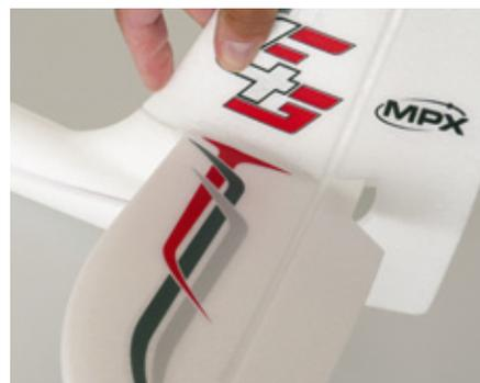
Am Höhen- und Seitenleitwerk sind die Ruder fertig anscharniert und mit Ruderhebel versehen. Beide Teile sind nur noch zusammenzustecken und mit einer Nylonschraube auf dem Rumpf zu fixieren – das ist wunderbar transportfreundlich durchdacht
