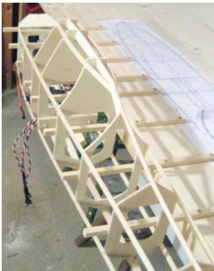
Die Rumpfgurte geben den Spanten Stabilität und lassen die spätere Form erahnen
