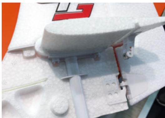
Das Schnittbild im Multiplex-Messmuster verdeutlicht die Befestigung der Leitwerke
