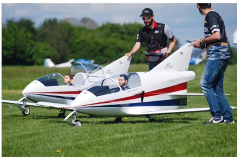
James Bond-Agent 007 lässt grüßen – und das gleich doppelt. Gernot Bruckmann und Hannes Lutzenberger zeigten mit ihren turbinenbetriebenen BD5J Microjet einen beeindruckenden Synchronflug. Die Voll-GFK-Modelle mit Einziehfahrwerk haben jeweils eine Spannweite von 3.480 Millimeter, was einem Nachbau-Maßstab von 1:1,5 entspricht. Das Gewicht beträgt jeweils 20 Kilogramm
