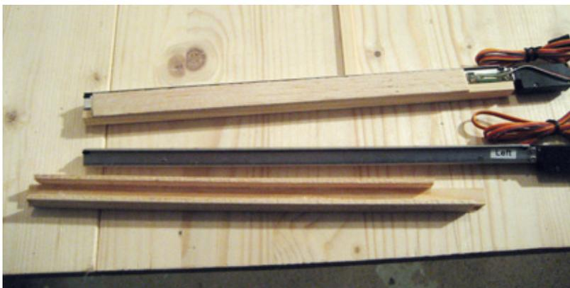
Für die elektrischen Störklappen wurden Verkastungen erstellt. In diesen sind die Klappen jeweils mit zwei Schrauben befestigt
