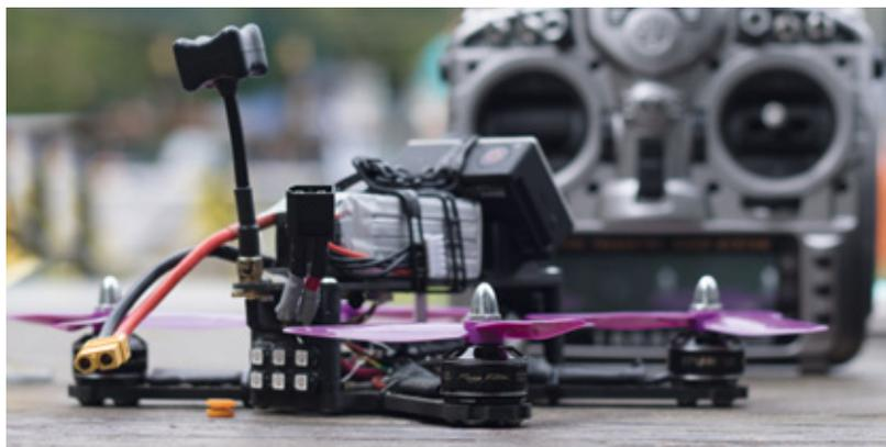
Die eingesetzten Race-Kopter sind entsprechend mit FPV-Equipment ausgestattet und werden über 3s/4s-LiPos angetrieben
