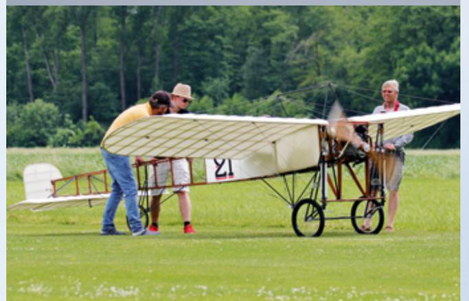
Mit dem Modell der Blériot XI „La Manche“ hat der Erbauer Henk van Hoorn wie 100 Jahre zuvor das Original den Kanal überquert. Das Großmodell im Maßstab 1:2 mit Dreizylinder-Anzani V-Motor (Hubraum 480 Kubikzentimeter) hat 5.500 Millimeter Spannweite und wiegt 65 Kilogramm
