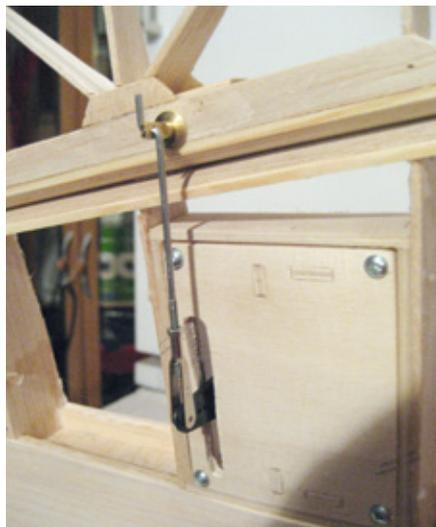
Die Querruderservos sind automatisch durch den Servorahmen abgedeckt. Die Anlenkung erfolgt direkt über einen Stahldraht und Ruderhörner von Gromotec
